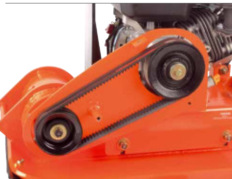
Per doppeltem Riementrieb gelangt die Kraft vom Motor auf die Rüttelplatte
