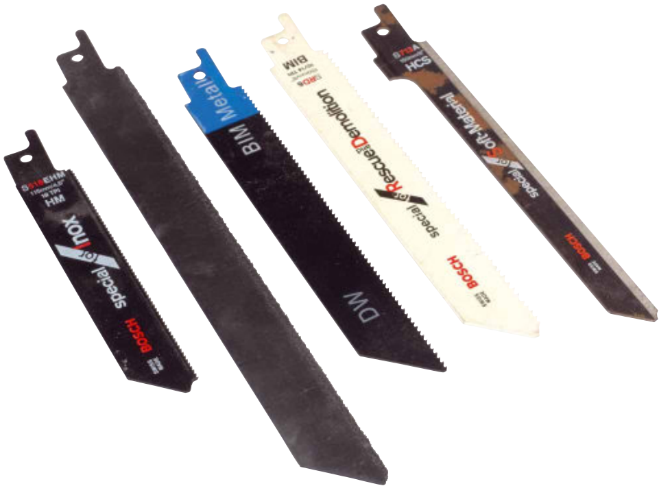
Abgesehen von unterschiedlichen Längen bietet der Handel Blätter für unterschiedlichste Werkstoffe an. (von L nach R) Metall (für Edelstahl), Stein, Metall (biegbar für wandnahe Schnitte) Rescue Universalblatt (für Rettungsdienst), für Dämmstoffe
