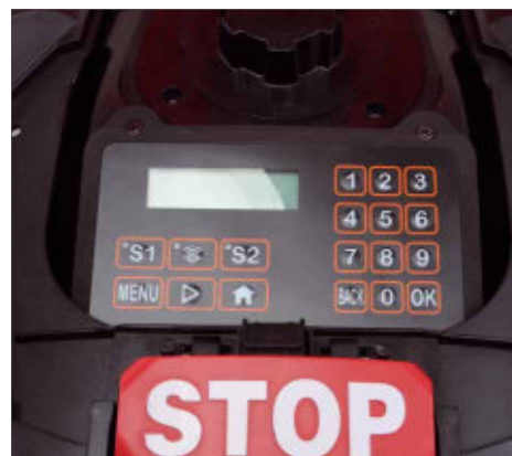
Am Display unter der Klappe werden alle nötigen Einstellungen vorgenommen
