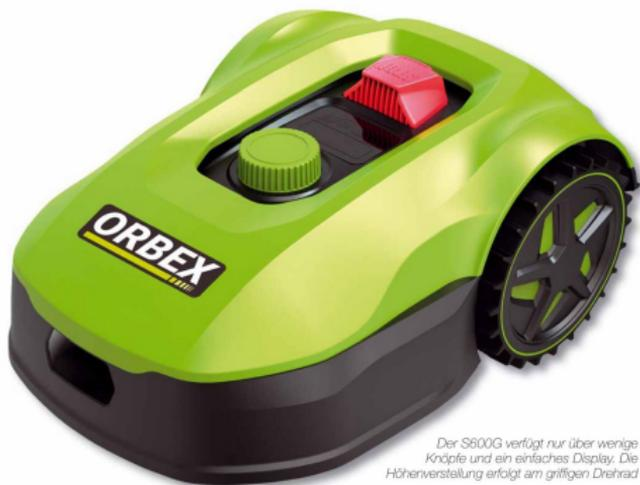
Der S600G verfügt nur über wenige Knöpfe und ein einfaches Display. Die Höhenverstellung erfolgt am griffigen Drehrad
