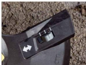
Der Arbeitsdurchmesser des Kärcher lässt sich, wie bei einigen anderen Geräten, verstellen, in dem man das Messer, das den Faden kürzt, versetzt
