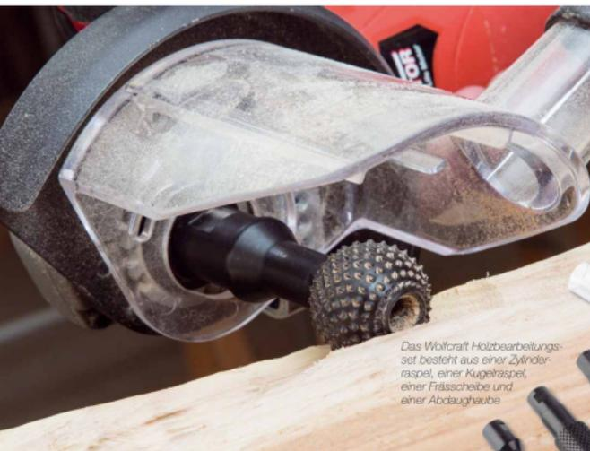
Das Wolfcraft Holzbearbeitungsset besteht aus einer Zylinderraspel, einer Kugelraspel, einer Frässscheibe und einer Abstaughaube
