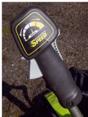
Der Ryobi RBC36X26B ist das einzige Gerät im Test, bei dem sich die Drehzahl über den Schalter regeln lässt
