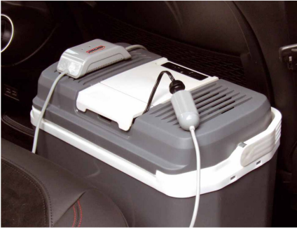
Der Batteriewächter von Dino Kraftpaket schützt die Fahrzeugbatterie im Stand vor Tiefentladung wenn energiehungrige Verbraucher angeschlossen über die 12V-Steckdose angeschlossen sind
