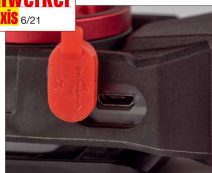
Auf jeder Seite ein USB-Stecker einer (Micro-) USB dient zum Laden des Akkus, der andere USB(1.0) dient zum Versorgen anderer Geräte
