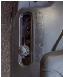
Bei der 5-stufigen Schnitthöhenverstellung hat man sogar an den Aufdruck der Schnitthöhe in Millimeter gedacht
