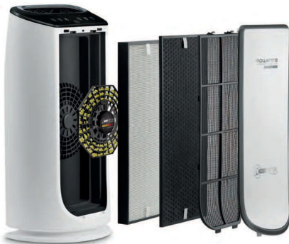
Die meisten Luftreiniger arbeiten mit einem dreistufigen Filter: Vorfilter, HEPA Filter und Aktivkohlefilter (Bild: Rowenta)
