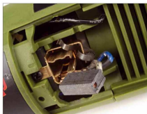
Kohlebürsten wie bei dieser Maschine finden sich immer seltener in Akku-Werkzeugen
