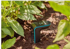
Intelligent gesteuerte Bewässerungsanlagen können auch in Abhängigkeit von der Bodenfeuchtigkeit gesteuert werden. Gardena zum Beispiel bietet dazu smarte Sensoren an, die dem Smart Garden die notwendigen Daten liefern (Bild: Gardena)
