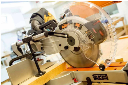
Die Hülzen auf den Führungsschienen laufen spielfrei, so dass der Sägekopf präzise geführt wird
