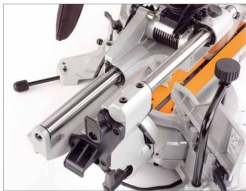
Die Hülzen auf den Führungsschienen laufen spielfrei, so dass der Sägekopf präzise geführt wird
