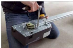
Bevor der Antrieb unter die Ecke gehängt wird, wird der Motorkopf mit dem Antriebsritzen an die Schiene geschraubt
