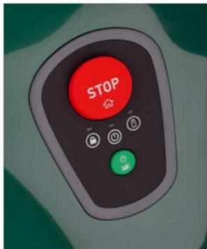
Zwei Knöpfe und drei LEDs reichen dem Robomow, da die Programmierung über die App erfolgt. Für die Höhenverstellung ist das kleine Drehrad an der Seite zuständig. Die eingestellte Höhe ist schlecht ablesbar.
