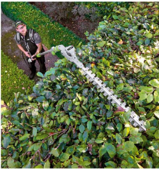
*Mit dem neuen Teleskop-System von Ego sind Arbeitshöhen von 4m problemlos erreichbar*
