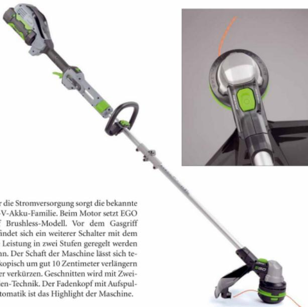
Für die Stromversorgung sorgt die bekannte 56-V-Akku-Familie. Beim Motor setzt EGO auf Brushless-Modell. Vor dem Gasgriff befindet sich ein weiterer Schalter mit dem die Leistung in zwei Stufen geregelt werden kann. Der Schaft der Maschine lässt sich teleskopisch um gut 10 Zentimeter verlängern oder verkürzen. Geschnitten wird mit Zweifaden-Technik. Der Fadenkopf mit Aufspulautomatik ist das Highlight der Maschine.
