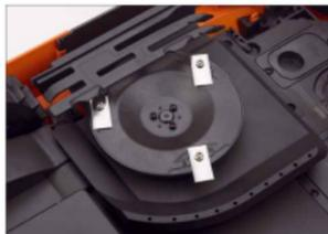
*Als einziges Gerät im Testfeld ist das Mähwerk des Landroids seitlich versetzt montiert, sodass das Gerät recht präzise am Rand entlang mähen kann*
