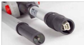
Beim Direktantrieb verläuft im Schaft nur ein Kabel, mit den zugehörigen Steckverbindern. Mechanische Antriebe haben im Schaft eine Antriebswelle
