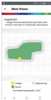
Der Bosch ist das einzige Gerät im Testfeld, dass den Rasen erst kartiert und dann systematisch in parallelen Bahnen mäht
