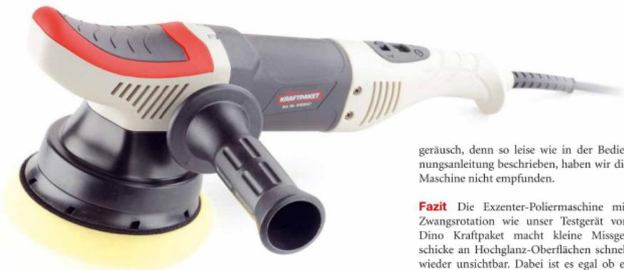
Die Maschine hat eine Aufnahmeleistung von 710 Watt. Die Klettaufnahme für die Polierpads ist für 125-Millimeter-Scheiben optimiert. Der Polierteller wird mit Zwangsrotation und einem exzentrischen Polierhub von 8 mm bewegt. Die Drehzahl wird auch unter Last elektronisch konstant gehalten, und lässt sich in 6 Stufen zwischen 800 und 4200 Umdrehungen einstellen. Das Zuleitungskabel ist 5 m lang.
