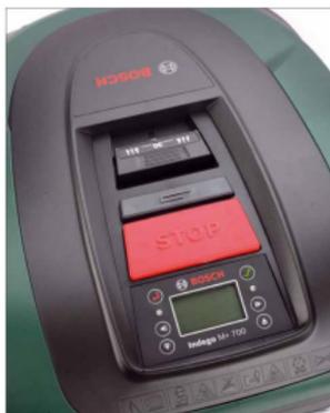
Die Höhenverstellung erfolgt bei Bosch durch Niederdrücken des Verstellmechanismus. Tasten und Display ermöglichen es, die wichtigsten Einstellungen unmittelbar am Gerät vorzunehmen
