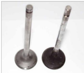
Auch Motorbauteile wie der Ventilttrieb zeigen sich nach dem Einsatz von Eco-Diesel deutlich sauberer. Für den Motor bedeutet das höhere Effektivität und längere Lebensdauer
