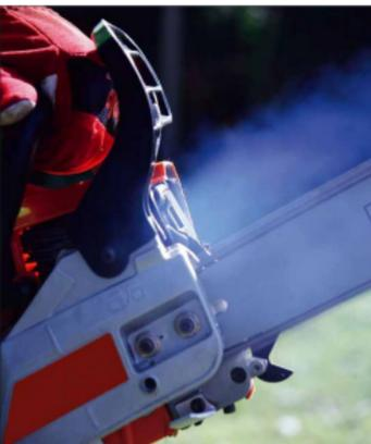
Auch die Abgabe von Gerätebenzin enthalten deutlich weniger Schadstoffe als die von PKW-Kraftstoffen. Dazu kommt, dass Zweitaktmotoren den Treibstoff nicht vollständig verbrennen. Ein Teil gelangt mit den Abgasen feinstaubig, als Aerosol, in die Umwelt. Gerätebenzin verbrennt vollständiger, d.h. das Aerosol ist nicht nur weniger schädlich, es wird auch grundsätzlich weniger davon freigesetzt.
