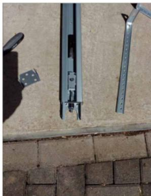
Vorn an der vormontierten Laufschiene befindet sich der federbelastete Kettenspanner. Rechts das vordere Lager für den Antrieb, das an Sturz oder Decke montiert wird. Links die beiliegenden Bügel für eine abgehängte Montage
