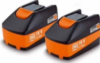
Dass schnelles Laden immer ein Thema ist, zeigt Fein mit dem neuen Ladegerät 80 und den neuen 12- und 18-Volt-Lithium-Ionen-Akkus. Ein komplett entladener 18-Volt-Lithium-Ionen-Akku mit sechs Amperestunden lädt in 38 Minuten. Das Ladegerät lädt den jeweiligen Akkupack nach dem sogenannten CCCV-Ladeverfahren (steht für: constant current constant voltage). Ein LED-Display informiert den Anwender dabei über den Ladestand
