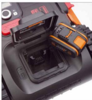
*Die Stromversorgung des Worx übernimmt ein Systemakku, der auch in anderen Worx-Akku-Werkzeugen eingesetzt werden kann. Ein weiterer Vorteil: Zum Überwintern lässt sich das Akku leicht herausnehmen und durch gelegentliches Laden fit halten*
