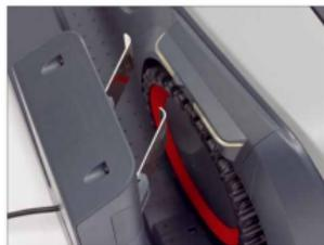
Der Robolinho ist ein „Seitenläder“, das heißt, die Ladekontakte finden sich an der Seite der Maschine, der Roboter kann zum Laden outside durch die Station fahren, die unmittelbar am Rand des Rasens stehen soll
