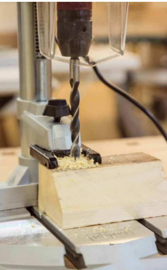
**Ausstattung** Die Maschine wird von einem 710 Watt starken Motor angetrieben, der auf ein manuell schaltbares Zweigang-Getriebe wirkt. Der Drehschalter für die Gangwahl sitzt auf der rechten Maschinenseite. Mit dem Drehknopf auf der Vorderseite lässt sich die benötigte Drehzahl im ersten Gang zwischen 170 und 880 1/min und im zweiten Gang zwischen 490 und 2.600 1/min
