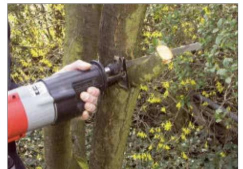
*Bei dickeren Ästen wird zuerst ein Schnitt ca. 15 cm vom Stamm entfernt ausgeführt, um die eigentliche Schnittstelle zu entlasten. Dadurch wird eine saubere, möglichst kleine Wunde erzielt*
