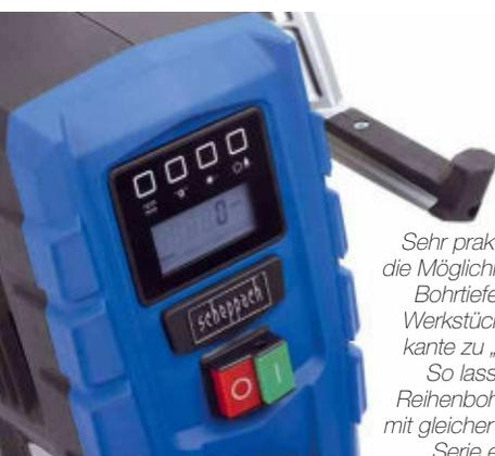
Sehr praktisch ist die Möglichkeit, die Bohrtiefe an der Werkstück-Oberkante zu „nullen“. So lassen sich Reihenbohrungen mit gleicher Tiefe in Serie erstellen
