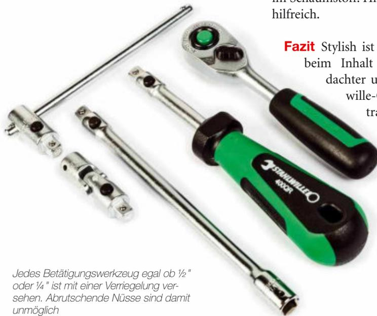
Jedes Betätigungswerkzeug egal ob 1/2" oder 1/4" ist mit einer Verriegelung versehen. Abrutschende Nüsse sind damit unmöglich
