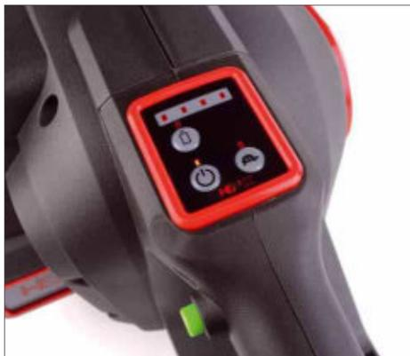
Die Knöpfe auf dem Griff dienen zum Einschalten, zum Umschalten der Kettengeschwindigkeit und zum Akku-Test
