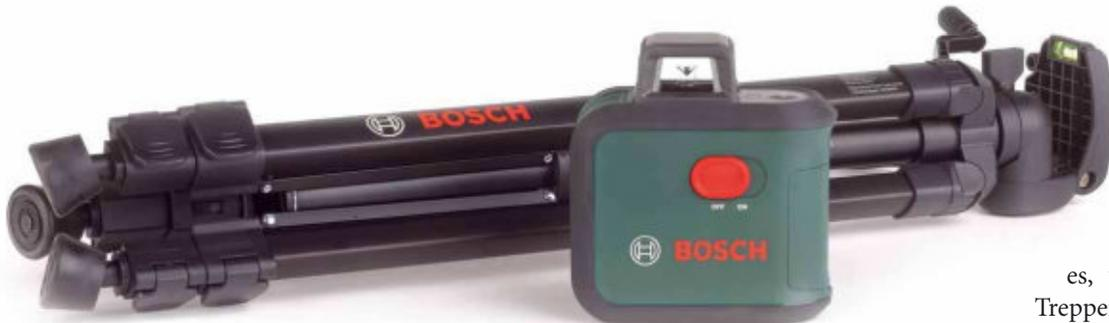
**Ausstattung** Bosch bietet das Gerät wahlweise ohne Stativ oder mit Stativ an. Da der Preisunterschied nur bei rund 30 Euro liegt, haben wir das Set mit Stativ geordert. Schauen wir uns diesen „Ständer“ doch gleich mal genauer an. Das Stativ lässt sich für Höhen bis ca. 150 Zentimeter nutzen. Dank der mittigen, stufenlos verstellbaren Führung
