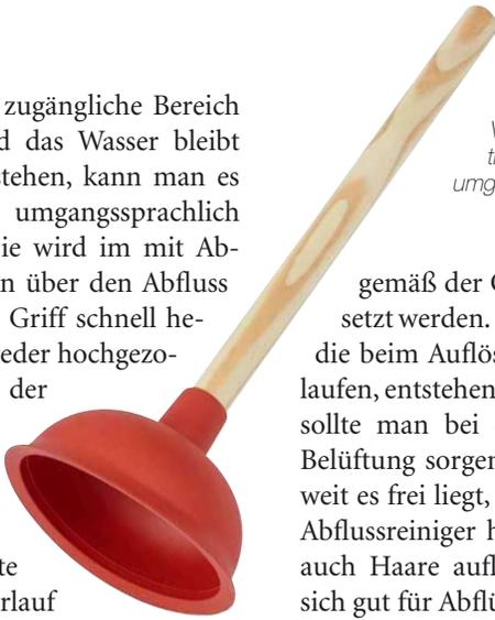
*Der erste Versuch um eine Verstopfung im Abfluss zu beseitigen ist der Griff zur Saugglocke, umgangssprachlich Pömpel genannt*
