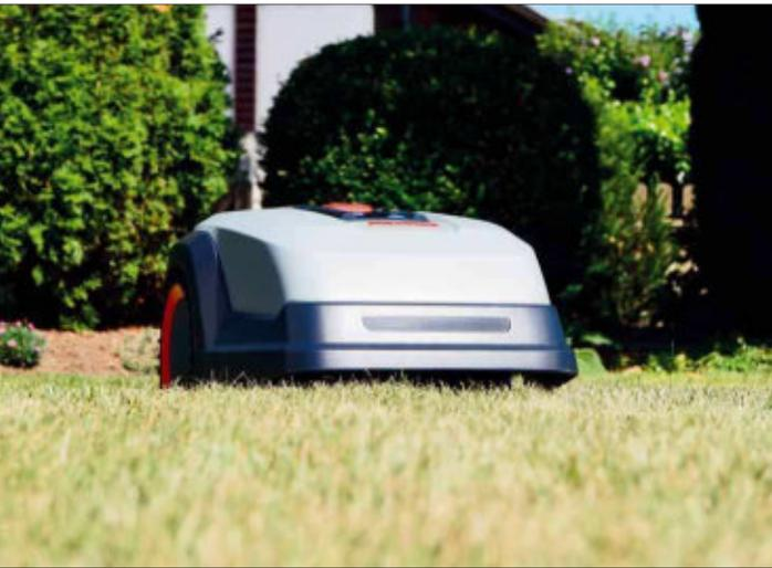
Der Begrenzungsdraht kann liegen bleiben. Um die eingebauten Akkus zu schützen, sollte man den Roboter frostfrei lagern. Das gilt übrigens für alle Akkus: frostfrei lagern und am besten vor der Winterpause noch einmal vollständig aufladen und anschließend noch einmal kurz teilladen, damit sie die Lagerung gut überstehen.
