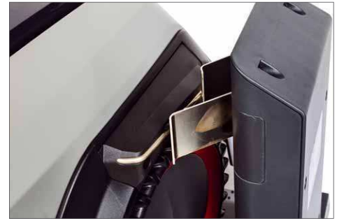
Damit der Robolinho die Ladekontakte in der Station zuverlässig trifft, sollte der letzte Meter Anfahrtsweg gerade auf die Station zuführen
