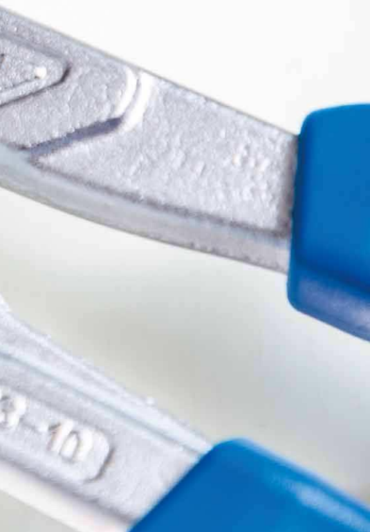
Links sieht man den arretierten Scharnierbolzen, zu erkennen am sichtbaren Querriegel. Jetzt kann man die Zange einfach auf das benötigte Maß einstellen. Durch Schließen der Zange, rechts im Bild löst die Arretierung und die Zange ist einsatzbereit
