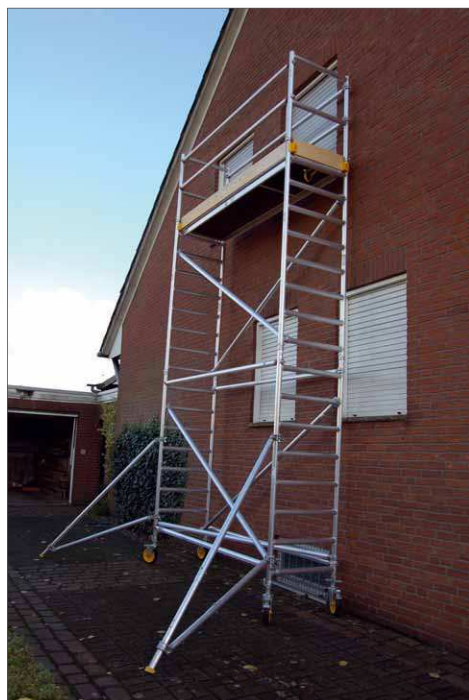
Befindet sich das Gerüst direkt an der Hauswand, reichen zwei Stützen zur Sicherung aus
