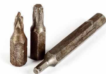
Bits mit solchen „Kampfspuren“ gehören in die Tonne
