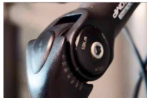
Wichtige Bauteile wie Lenkervorbau und -griffe sollten mit dem vorgeschriebenen Drehmoment angezogen werden. Meist ist das sogar aufgedruckt
