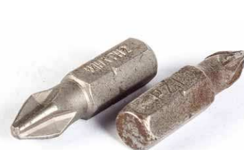
Der Qualitätshersteller steht mit seinem Namen auf dem Bit. „Schrott-Otto“ bleibt lieber ungenannt und kennzeichnet nur die Bitgröße
