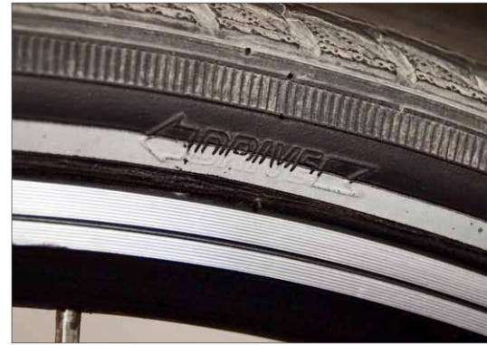
Neben dem Reflektorstreifen auf dem Reifen erkennt man hier noch den Laufrichtungs Pfeil der bei der Reifenmontage beachtet werden sollte
