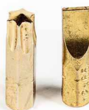
Billigbits oder Schraubendreher sind oft im Wortsinn Blender. Mangelnde Qualität wird durch glänzende Optik ersetzt
