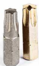
Der rechte Bit mit der runden Stirnfläche verschonkt Kontaktfläche zur Schraube weil er nicht tief genug im Profil sitzt. Der linke Bit macht es besser
