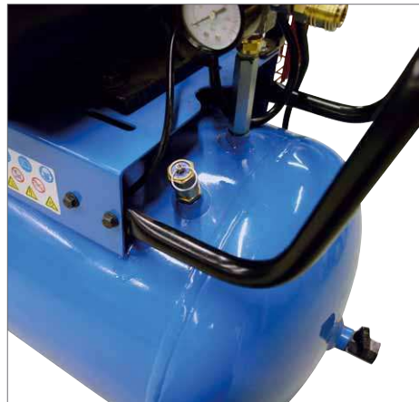
Hier ist das Überdruckventil des Güde-Kompressors gut zu erkennen
