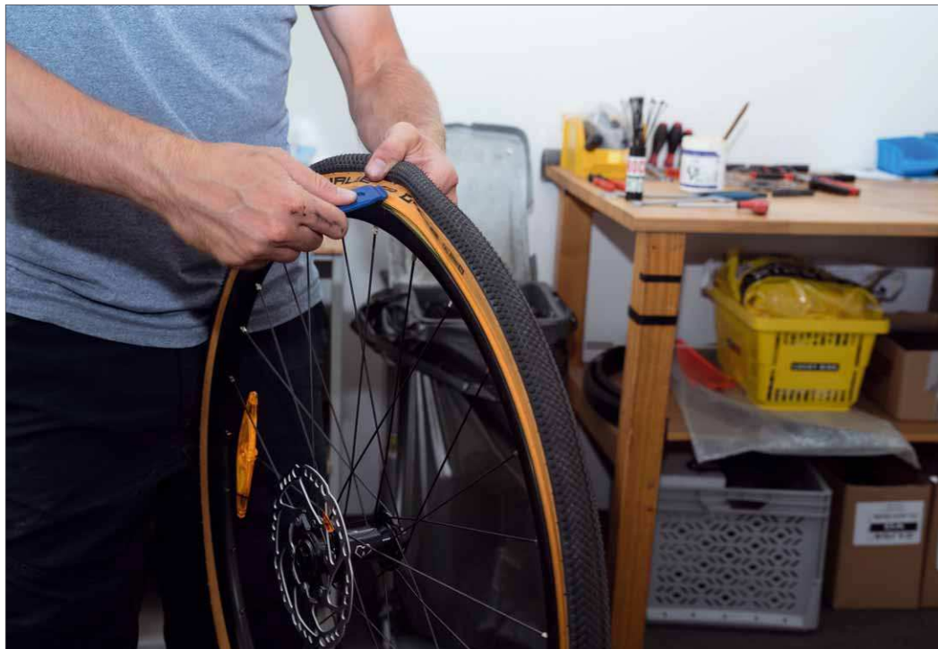
Ein Satz Reifenheber ist preiswert und verhindert Beschädigungen an Felge, Schlauch und Decke (Quelle Lucky Bike)
