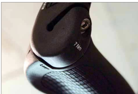
Wichtige Bauteile wie Lenkervorbau und -griffe sollten mit dem vorgeschriebenen Drehmoment angezogen werden. Meist ist das sogar aufgedruckt
