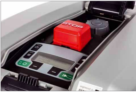
Alle Bedienelemente auf einen Blick: Display, Not-Aus-Schalter und Drehknopf für die Höhenverstellung
