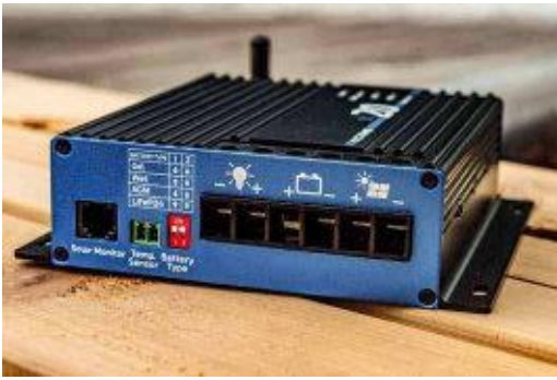
An dem Laderegler werden das Solarpanel und die Batterie angeschlossen, zudem gibt's einen 12-V-Hilfsausgang
