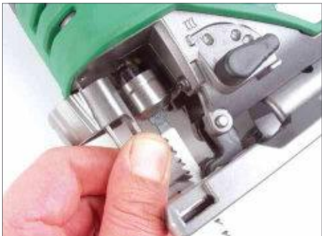
Gut gelöst: Die Aufnahme für das Sägeblatt ist werkzeuglos zu bedienen
