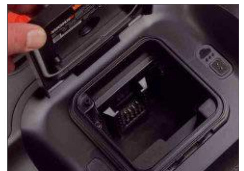
Bei diesem Modell befindet sich der Akkuschacht oben auf der Maschine
