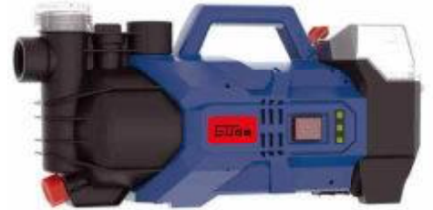
Die leistungsstarke Akku-Gartenpumpe GP 18-401-30 des Güde 18V E 3 -Systems fördert bis zu 2400 l/h auf eine Höhe von bis zu 20 m. Dabei kann sie Wasser aus bis zu 6 m Tiefe ansaugen
