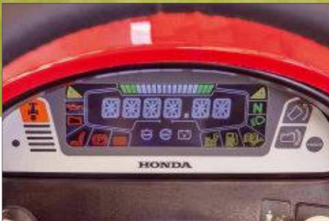
Die neuen Premiummodelle sind mit einem LCD-Farbdisplay ausgestattet, das den Überblick über alle wichtigen Gerätefunktionen auch bei schwierigen Lichtverhältnissen ermöglicht
