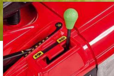
Geräte mit Versamow sind mit einer nützlichen Mulchklappe ausgestattet, die in einem intuitiven Handgriff über einen Hebel umgestellt werden kann
