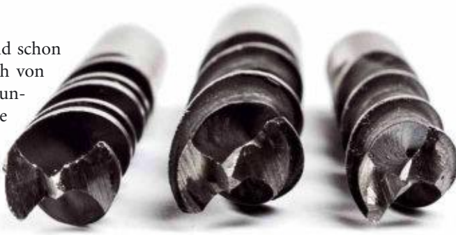
Der linke Bohrer ist in Ordnung, die beiden anderen zeigen deutliche Schleifspuren in den Schneiden. Damit ist kein gleichmäßiges Bohren möglich
