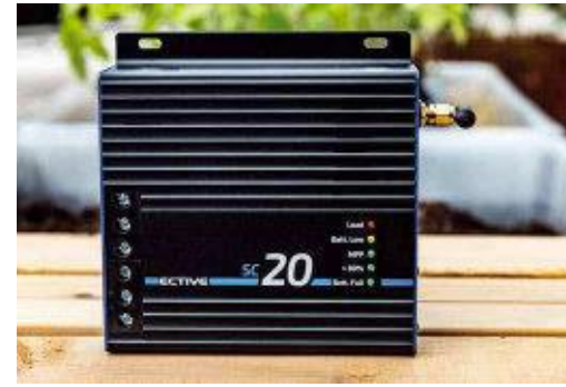
Der MPPT-Regler gibt auch per Leuchtdioden Auskunft über seinen Betriebszustand
