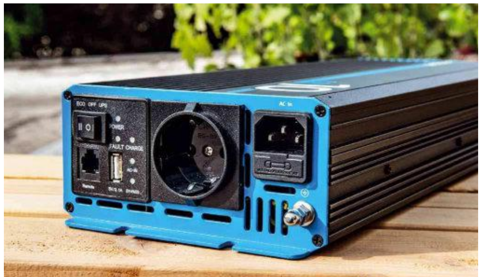
Der Wechselrichter kann sogar als Ladegerät verwendet werden und als unterbrechungsfreie Stromversorgung für den angeschlossenen Verbraucher dienen
