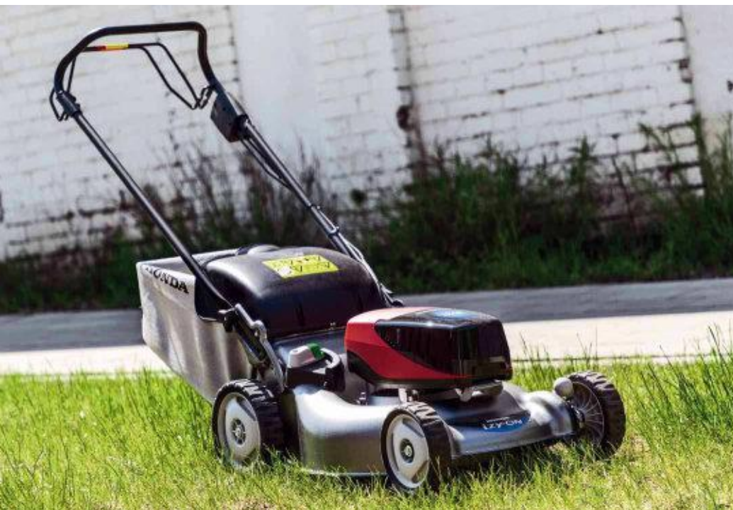
Der Akku findet direkt vor dem Motor unter einer Abdeckung seinen Platz
