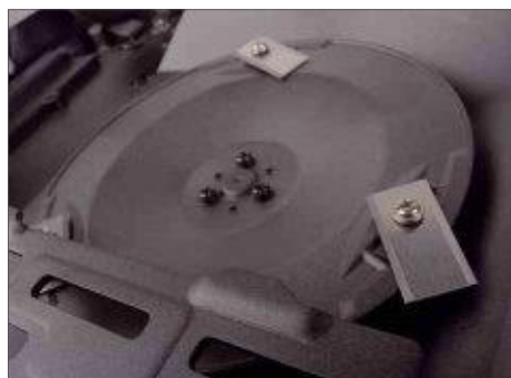
Die Scheibe auf der die Schleudermesser montiert sind ist beweglich gelagert, so dass sie sich den Bodengegebenheiten gut anpassen kann
