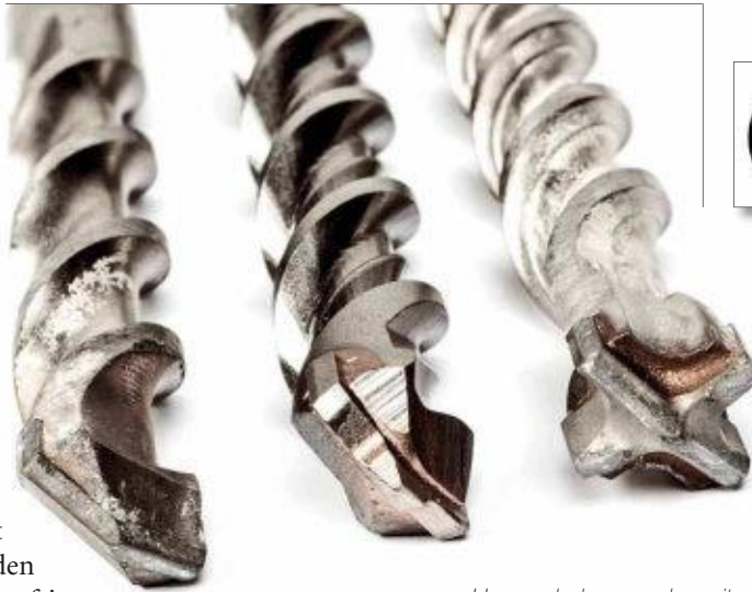
Hammerbohrer werden mit unterschiedlichsten Klingen-Geometrien angeboten
