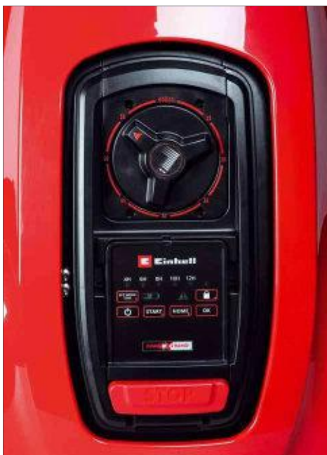
Das Bedienfeld kommt ohne Display aus, die verschiedenen Modi werden durch farbige LEDs angezeigt
