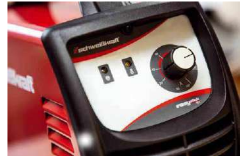
Da es für Heimwerker beim Schweißen nur bedingt auf die genaue Stromstärke ankommt, verfügen alle Geräte im Test nur über solche einfachen Einstellmöglichkeiten
