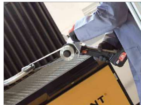
Die verschiedenen Schleifaufsätze ermöglichen auch das Polieren und Schleifen von Rundprofilen
