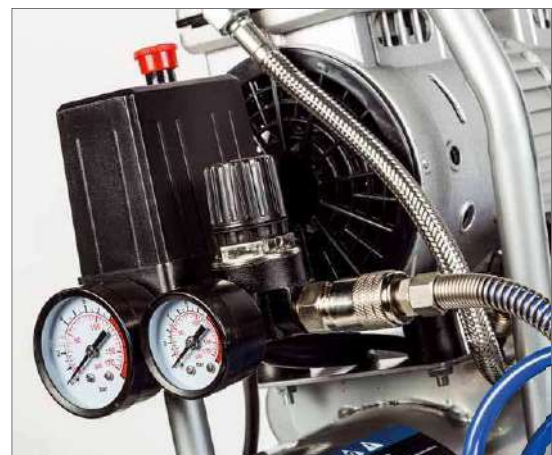
Das große Manometer zeigt den Kesseldruck, das kleinere den eingestellten Arbeitsdruck
