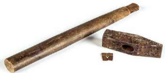
Um den Hammer in seine Einzelteile zu zerlegen, muss der Sicherheitskeil gezogen werden
