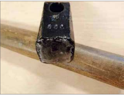
Nach dem Beschichten sind noch Farbreste auf der Schlagfläche, ...
