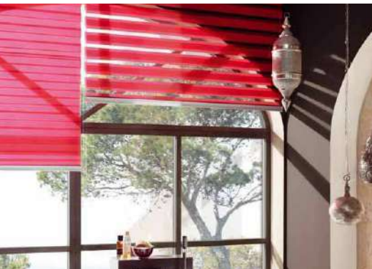
Viele Gestaltungsmöglichkeiten bieten auch sogenannte Doppelrolllos. Sie bestehen aus zwei Stofflagen, die unabhängig voneinander vor das Fenster gezogen werden können
