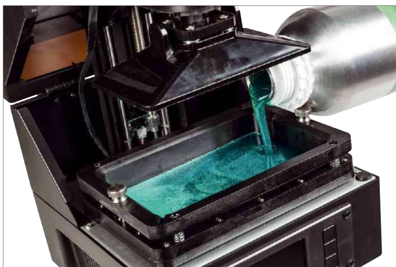
Damit der Drucker arbeiten kann, muss vor dem Start des Druckauftrages ein geeigneter lichtaushärtender Kunststoff in den Vorratsbehälter gefüllt werden
