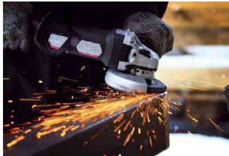
Nach dem Schweißen wird die Schweißnaht mit einem Winkelschleifer plan geschliffen
