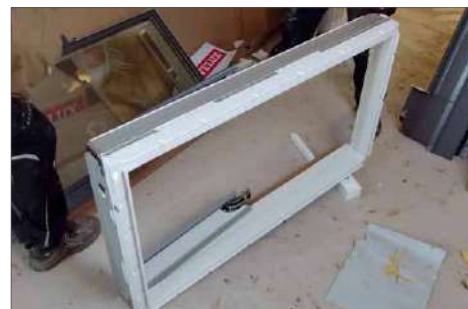
11 ... sodass nur der leere Fensterrahmen übrig bleibt
