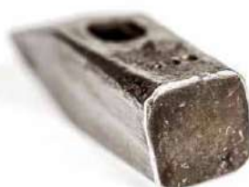
Um den Rost und die Verschmutzungen von Hammerkopf zu lösen wurde er in ein Bad aus Zitronensäure eingelegt
