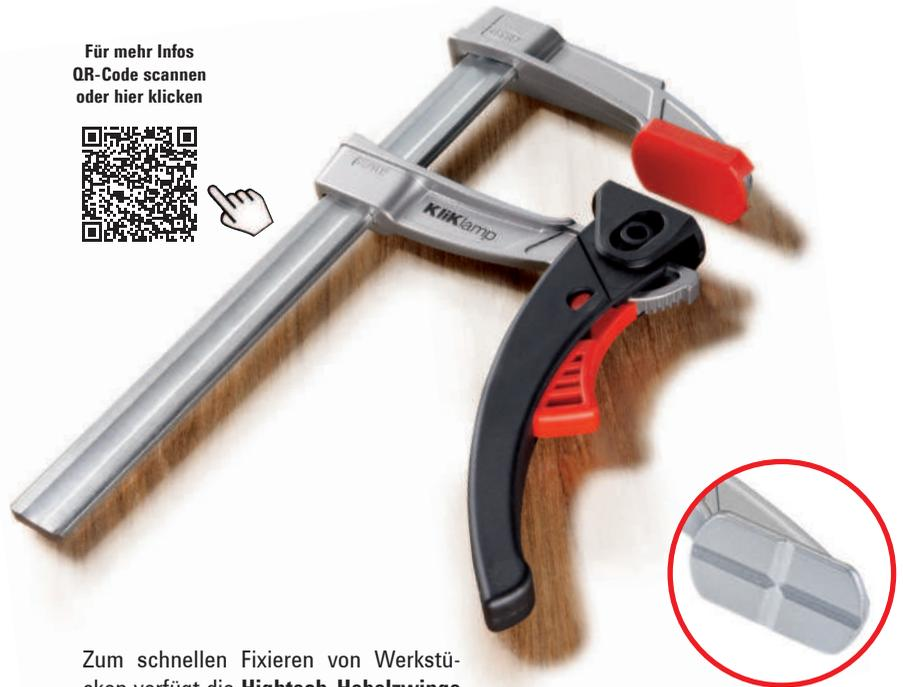
Zum schnellen Fixieren von Werkstücken verfügt die **Hightech-Hebelzwinge KliKlamp KLI** über einen Hebelgriff mit vielstufigem Rastmechanismus aus glasfaserverstärktem Kunststoff. Eine Sperrklinke gibt Ihnen Sicherheit, denn sie verhindert das selbständige Lösen der Zwinge auch bei Vibrationen. Zum schnellen Lösen der Zwinge wird die Sperrklinke dann einfach gedrückt.
