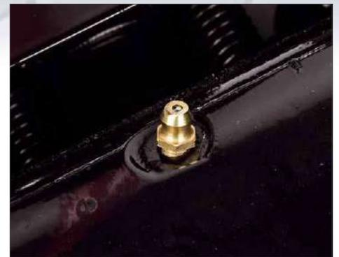
Ein Schmiernippel an der Drehachse des Hubarms sorgt für dauerhafte Leichtgängigkeit der Mechanik
