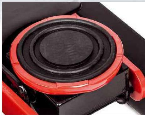
Die serienmäßige Gummieinlage im Hebeteller schützt den Fahrzeug-Unterboden
