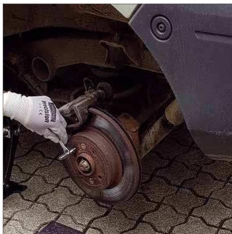
Defekte Radschrauben-Gewinde lassen sich mit den Bohrern aus dem Set schnell wieder gängig machen
