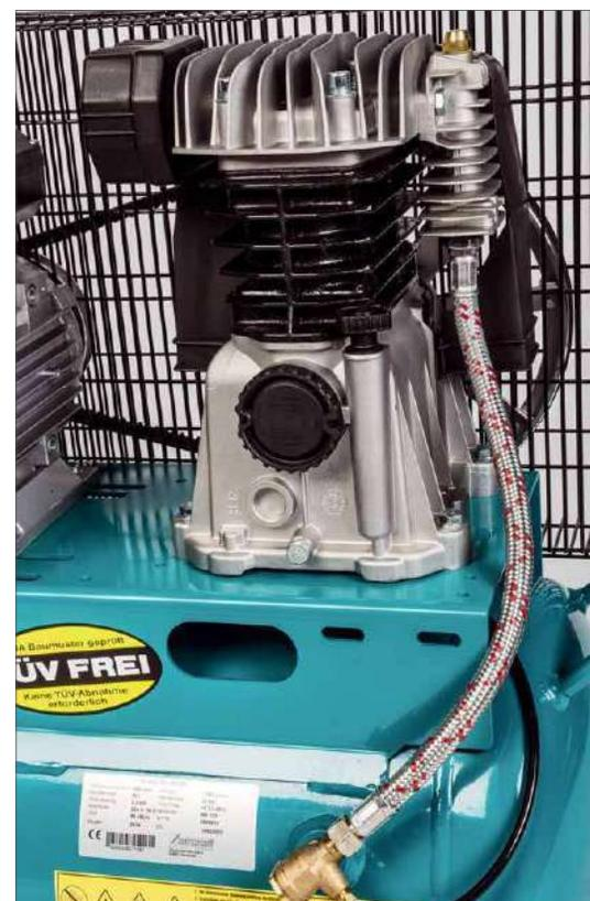
Beim Aircraft-Kompressor gelangt die komprimierte Luft über eine teure Stahlflex-Leitung in den Kessel
