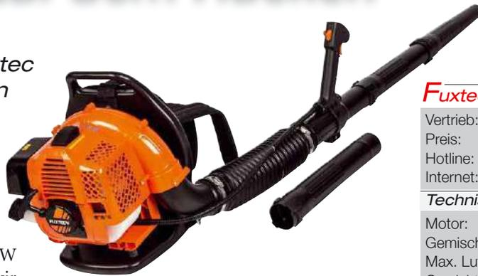
Bei unserem Testgerät müssen vor dem ersten Einsatz nur das Blasrohr und der Gasgriff montiert werden. Den 0,9 kW (1,2PS) starken Zweitakter betreiben wir wie immer mit Sonderkraftstoff. Wer selber mischen möchte, muss Benzin und Zweitaktöl im Verhältnis 40:1 mischen. Jetzt noch Ohrenschützer und Schutzbrille aufsetzen, und es geht los.
