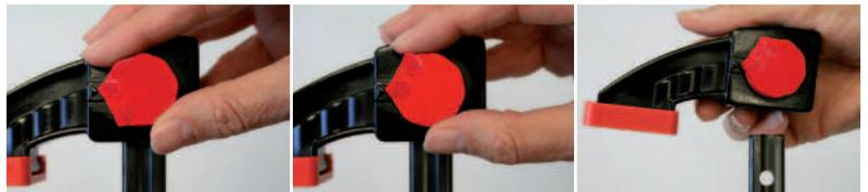
Die Einhandzwinge EZS von BESSEY ist in Spannweiten von 150 bis 900 mm und 80 mm Ausladung erhältlich und erzielt eine Spannkraft von bis zu 2.000 N.
