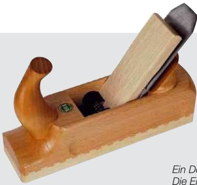
Ein Doppelhobel in traditioneller hölzerner Bauart. Die Eisen werden durch einen Keil im Hobelkörper fixiert. Das Keilwiderlager ist modern gebaut
