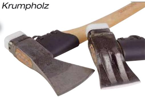
Während die Forstaxt einen schlanken Kopf hat, damit sie tief ins Holz eindringt, ist der Kopf der Spaltaxt mit einem Doppelkeil versehen, der das Holz beim Schlag spreizt und dadurch ein effektives Spalten bewirkt
