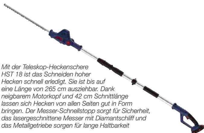
Mit der Teleskop-Heckenschere HST 18 ist das Schneiden hoher Hecken schnell erledigt. Sie ist bis auf eine Länge von 265 cm ausziehbar. Dank neigbarem Motorkopf und 42 cm Schnittlänge lassen sich Hecken von allen Seiten gut in Form bringen. Der Messer-Schnellstopp sorgt für Sicherheit, das lasergeschnittene Messer mit Diamantschliff und das Metallgetriebe sorgen für lange Haltbarkeit
