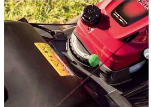
Beim variablen Mulchsystem Versamow kann der Auswurfkanal über einen Hebel stufenweise geöffnet oder geschlossen werden. So kann man wählen, wie viel Schnittgut aufgefangen oder gehäckselt wird
