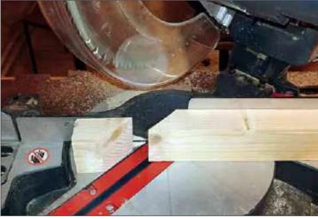
**1** Mit der Gehrungssäge werden 2 Dachlatten auf 197 cm gekürzt und mit einer 45°-Gehrung versehen. Die letzte Dachlatte wird zu 2 Stücken à 45 cm mit Gehrungen und 2 Stücken à 39,4 cm mit geraden Enden zugeschnitten. Aus den Resten werden noch 4 kleine Winkel gesägt – was die Reste eben hergeben
