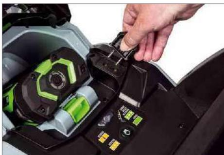
Der Sicherheitsstecker schützt vor unbefugtem Benutzen der Maschine
