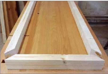
**2** Aus den Leisten werden zwei Rahmen, die späteren Sockel zusammengebaut – auf der einen Seite mit Gehrung, die andere Seite endet stumpf. Die Verbindungen sind die gleichen wie bei den Korpusen: zuerst geschraubt, um das Ganze zu fixieren, bis der Leim trocken ist, dann die Schrauben durch Holzdübel ersetzt
