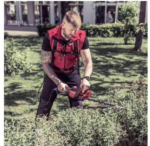
*Die Power Flex Akku-Heckenscheren sind mit einem drehbaren Handgriff ausgestattet. Zwei Arbeitsgeschwindigkeiten gewährleisten höchste Flexibilität: Der Normalbetrieb ECO-speed arbeitet mit 1.200 rpm, POWER-speed mit 1.500 rpm*
