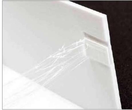
Mit den Werkzeugeinstellungen der Slicing-Software erzeugt der Drucker oft sogenannte Stützen, diese sind vielfach ohne Nutzen, da sie nichts stützen. Diese Funktion kann jedoch abgeschaltet und nur nach Bedarf wieder aktiviert werden
