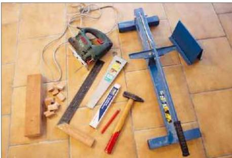
2 Zur Verlegung eines Laminatbodens werden nur wenige Werkzeuge benötigt. Wer keine Rücksicht auf Lautstärke nehmen muss, der kann den Laminatschneider durch eine Hand- oder kleine Tischkreissäge ersetzen
