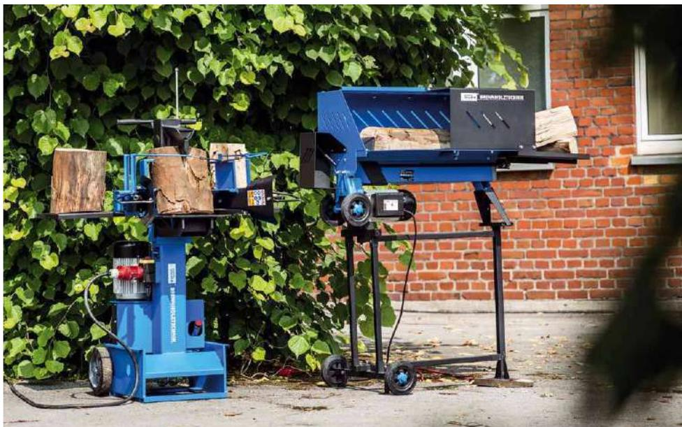
Im Fokus der neuen Sicherheitsbestimmungen standen konstruktive Maßnahmen, die vor allem Helfer schützen. Während die schon lange vorgeschriebene Zweihandbedienung den Bediener selber schützt, indem sie ihn dazu zwingt, seine Hände beim Spaltvorgang an den Bedienelementen zu haben, sodass sie nicht in die Nähe des Spaltkeils kommen, gab es vielfach Verletzungen von Helfern, die das Holzstück beim Spaltvorgang in Position gehalten haben.
