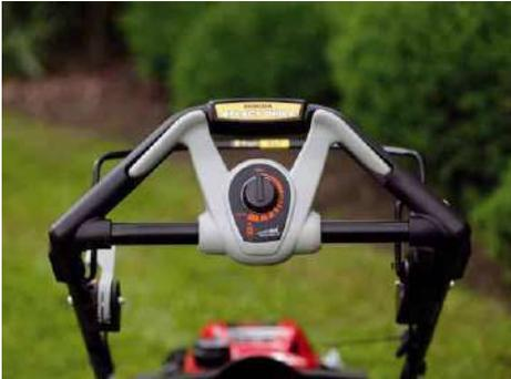
Die Geschwindigkeit des Randantriebes wird bei der Select-Drive-Steuerung über ein Einstellrad am Lenker geregelt
