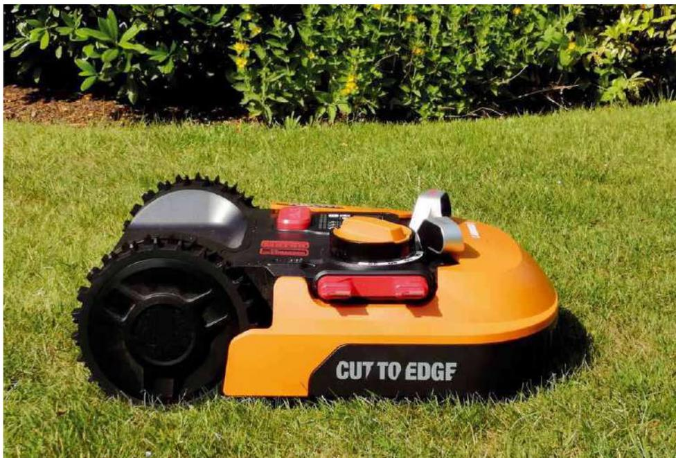
Auch wenn der Landroid mit einem ACS-Sensor versehen ist, benötigt er einen Begrenzungsdraht, der auf bzw. im Boden verlegt wird, um die Rasen- oder Mähbereiche zu erkennen
