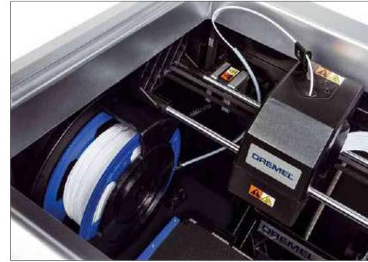
Mit der Innenraumgröße des 3D40 können schon mittelgroße Objekte in einem Rutsch gedruckt werden, allerdings ist die Filamentführung etwas unglücklich, sodass es in Einzelfällen zu Filamentbrüchen kommen kann
