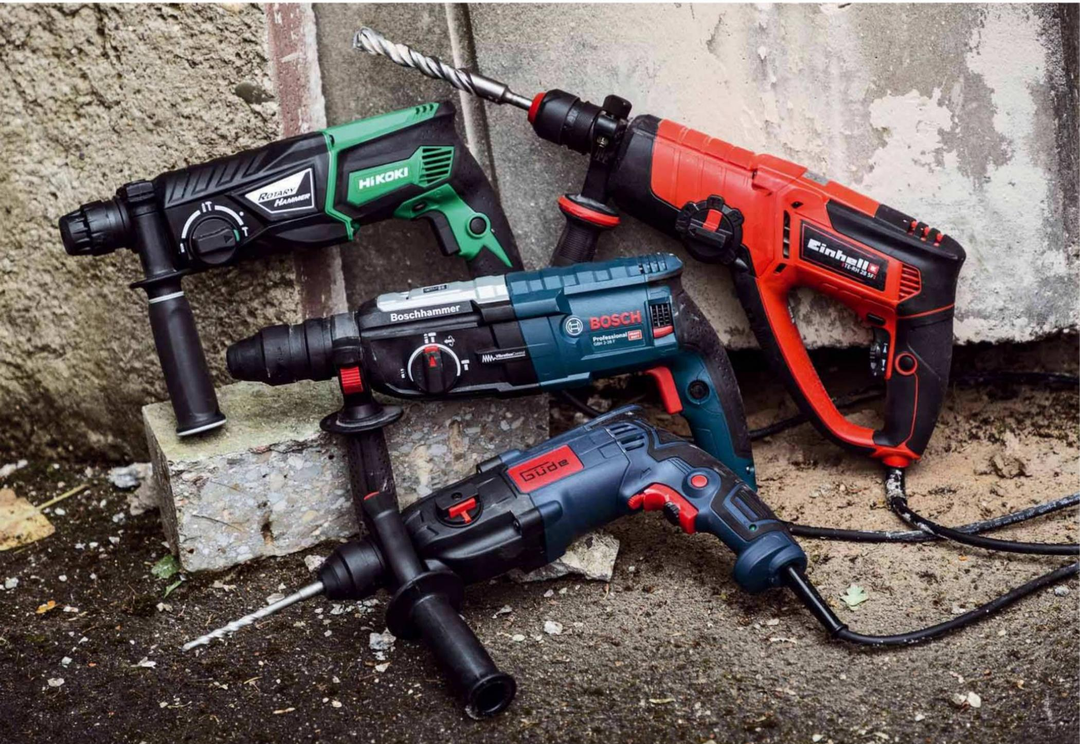
Heute sind gute Bohrhämmer schon für unter 100 Euro erhältlich. Sie sind die bessere Alternative zur Schlagbohrmaschine, um Löcher in Stein und Beton zu bohren.
