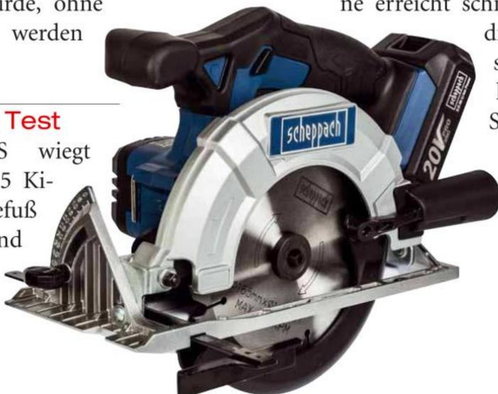
male Schnitttiefe von 55 mm. Beim Schnitt kann sie um bis zu 45 Grad gekippt werden. Vorn am Sägefuß ist der Parallelanschlag platziert. Die Einstellungen vor dem Schnitt sind schnell erledigt. Dabei fällt auf, dass die Arretierungsschraube des Parallelanschlages nur schwer erreichbar ist. Die Maschine erreicht schnell ihre Leerlaufdrehzahl und gibt sich beim Schnitt keine Blöße. Die Schnittkanten sind gut und winkelig, neigen jedoch auf der Oberseite zu Ausrissen.
