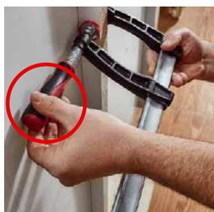
**Das Spannen vor einer geschlossenen Fläche** ist durch die Positionierung des Griffs bei klassischen Schraub- und Hebelzwingen nicht möglich, da der Griff nicht betätigt werden kann.
