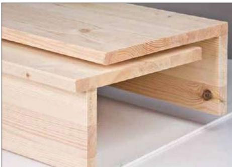
Eins der schmalen Bretter wird vorne unter einen Boden geleimt und bildet den Sockel. Er kann gerne ein wenig zurückspringen. Das andere wird hinten bündig mit dem Boden verleimt, der nachher den Deckel des Regals bildet. „Vorne“ eines Bodens ist immer die Seite, die nicht abgesägt wurde und noch mit Fasern versehen ist. Überquellenden Leim am besten sofort mit einem feuchten Tuch wegwischen
