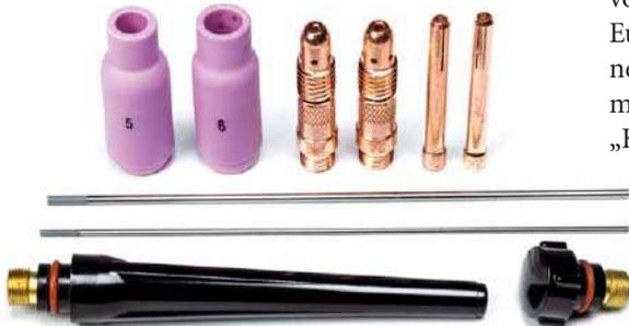
Der WIG-Brenner kann mit zwei verschiedenen Nadelstärken bestückt werden, auch Ansatzstücke für kurze bzw. lange Nadeln liegen bei
