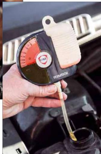
Auch wenn das Kühlsystem heutzutage beinahe keine Wartung mehr braucht, kann ein Check mit dem Frostschutzprüfer nicht schaden. Auch hier sind mindestens -25 °C angesagt. Frostschutzprüfer für Waschwasser und Kühlerfrostschutz werden im Zubehörhandel für wenige Euro angeboten
