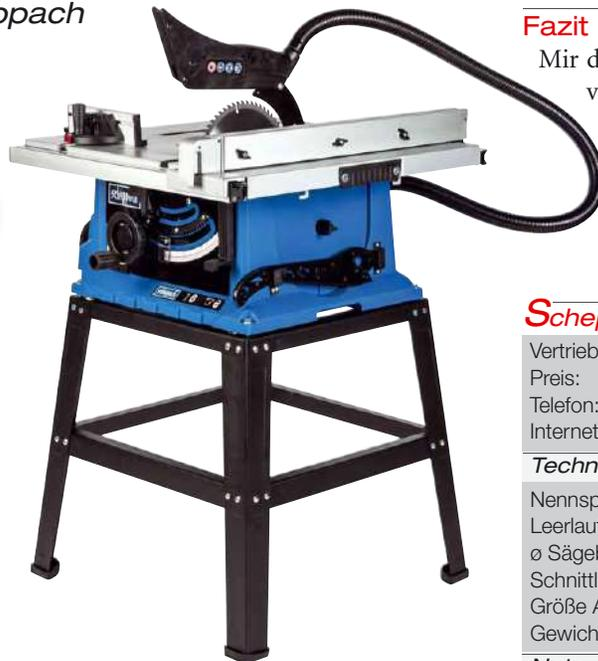
muss man zusammenbauen. Der Rest der Maschine ist schnell montiert. In der Praxis erweist sich die HS 105 als bärenstark. Das vergleichsweise fein verzahnte HM-Sägeblatt frisst sich beeindruckend aggressiv selbst durch dickes Birkenmultiplex. Anschläge und Skalen sind ausreichend präzise; wenn es auf höchste Maßgenauigkeit ankommt, empfiehlt sich eh immer, die Maschine mithilfe von Probeschnitten einzustellen.
