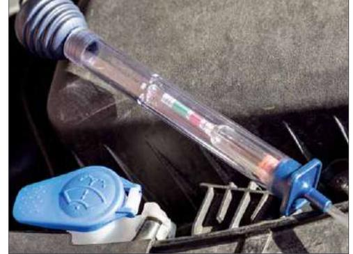
Auch im Winter ist gute Sicht wichtig, deshalb rechtzeitig ausreichend Frostschutz in die Waschanlage einfüllen. Die Konzentration des Mittels lässt sich mit einem Frostschutzprüfer für die Waschanlage leicht prüfen
