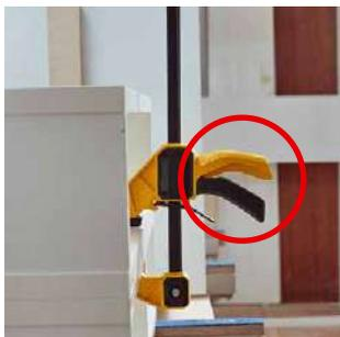
**Das Risiko einer Beschädigung des Werkstücks und einer Verletzung** erhöht sich in beengten Arbeitsbereichen, wenn Spannwerkzeuge mit überstehenden Bauteilen eingesetzt werden.
