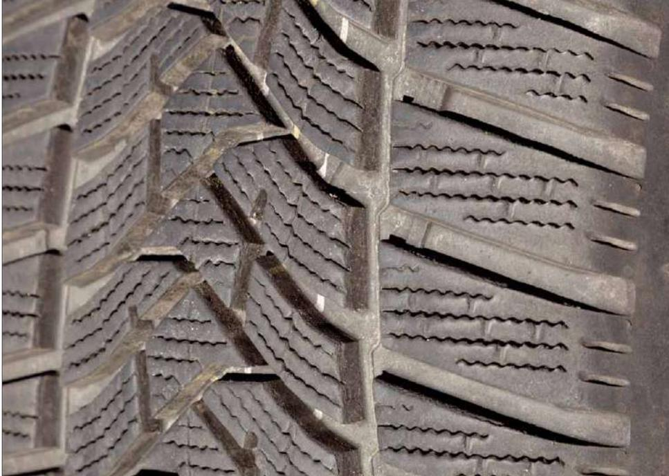
So soll es aussehen: Der Verschleiß ist über die gesamte Reifenbreite gleichmäßig. Die kleinen Stege zwischen den Profilblöcken sind Verschleißanzeiger. Wenn sie eine Höhe mit der Lauffläche bilden, ist die gesetzliche Mindestprofiltiefe von 1,6 mm erreicht. Winterräder sollten jedoch früher getauscht werden. Allgemein empfohlen werden 4 mm Restprofil
