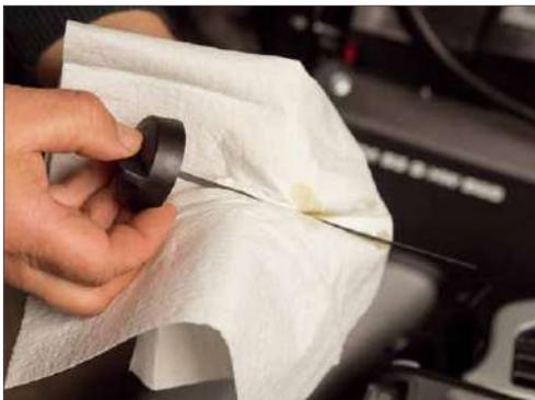
Bei den neuen EXI-Motoren genügt eine Kontrolle des Ölstands
