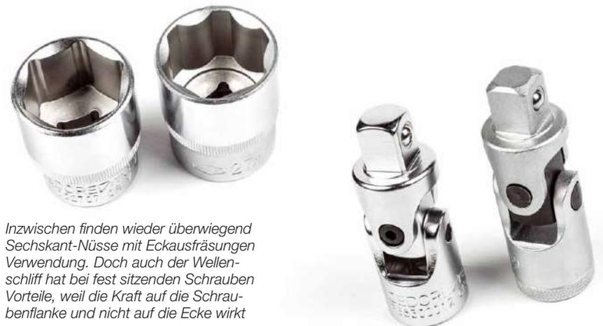
Inzwischen finden wieder überwiegend Sechskant-Nüsse mit Eckausfräsungen Verwendung. Doch auch der Wellenschliff hat bei fest sitzenden Schrauben Vorteile, weil die Kraft auf die Schraubenflanke und nicht auf die Ecke wirkt
