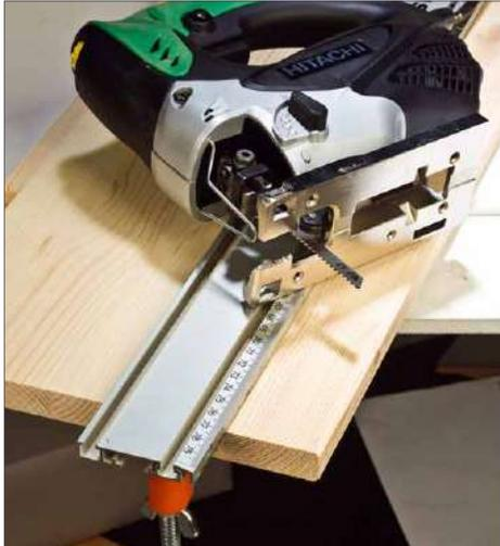
Mit einer an einem Anschlag geführten Stichsäge lassen sich die Bretter bequem kürzen
