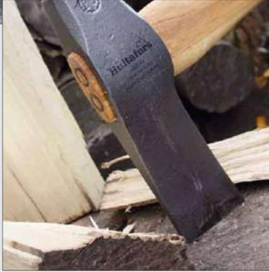
Kettensäge oder, sicherer, mit einer Wippsäge. Das Spalten in Scheite geschieht entweder sportlich mit Spaltaxt (hier ein schönes Exemplar von Hultafors) oder Spalthammer oder komfortabel mit einem hydraulischen Holzspalter.
