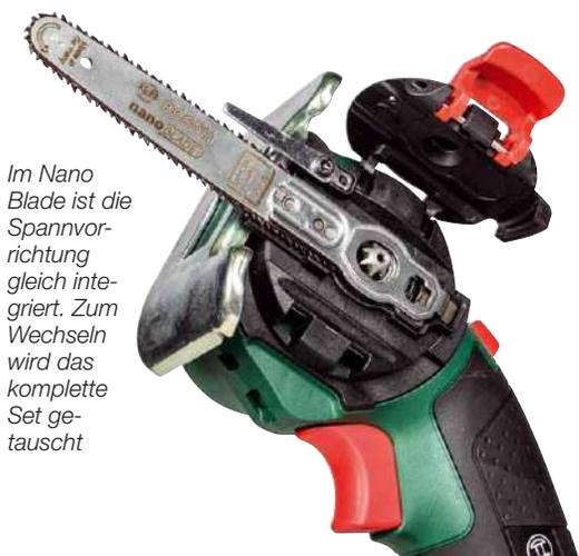
Im Nano Blade ist die Spannvorrichtung gleich integriert. Zum Wechseln wird das komplette Set getauscht
