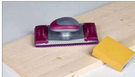
Nachdem das Holz getrocknet ist, wird es mit 180er-Schmirgelpapier vorgeschliffen
