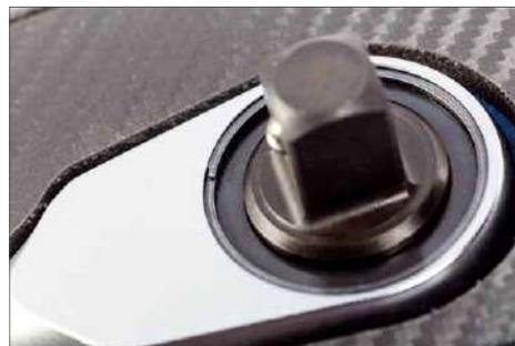
Zum Fetten oder zur Reparatur kann die Ratsche nach dem Entfernen des Sicherungsringes zerlegt werden
