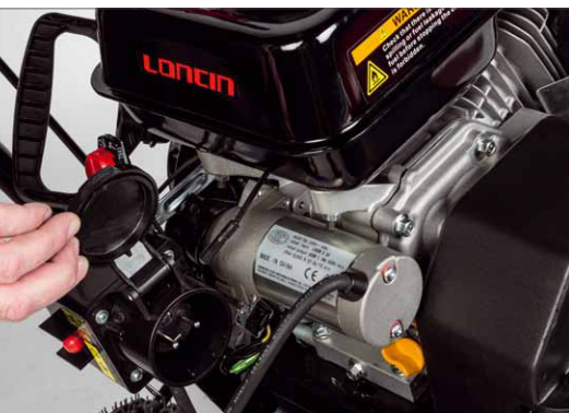
Neben dem Seilstarter kann die Maschine auch mit Netzspannung gestartet werden
