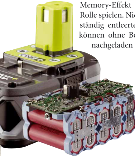
Der Ryobi-Akku verfügt im Inneren über sehr fortschrittliche Technik. Äußerlich hat er mit seinem Mittelzapfen eine eher ältere Bauform
