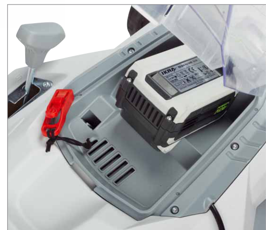
Mit dem roten Sicherheitsstecker wird das Gerät ein- und ausgeschaltet
