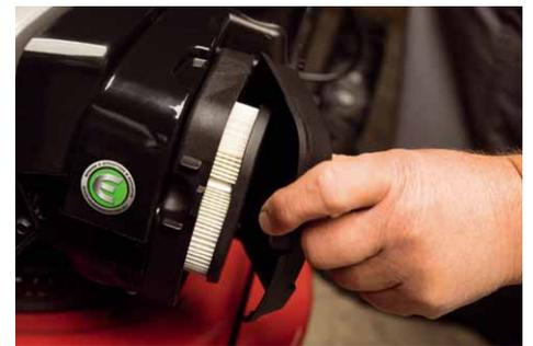
Die Kontrolle des Luftfilters gehört zu den wenigen Wartungsarbeiten, die man bei den neuen Briggs & Stratton Motoren noch beachten sollte
