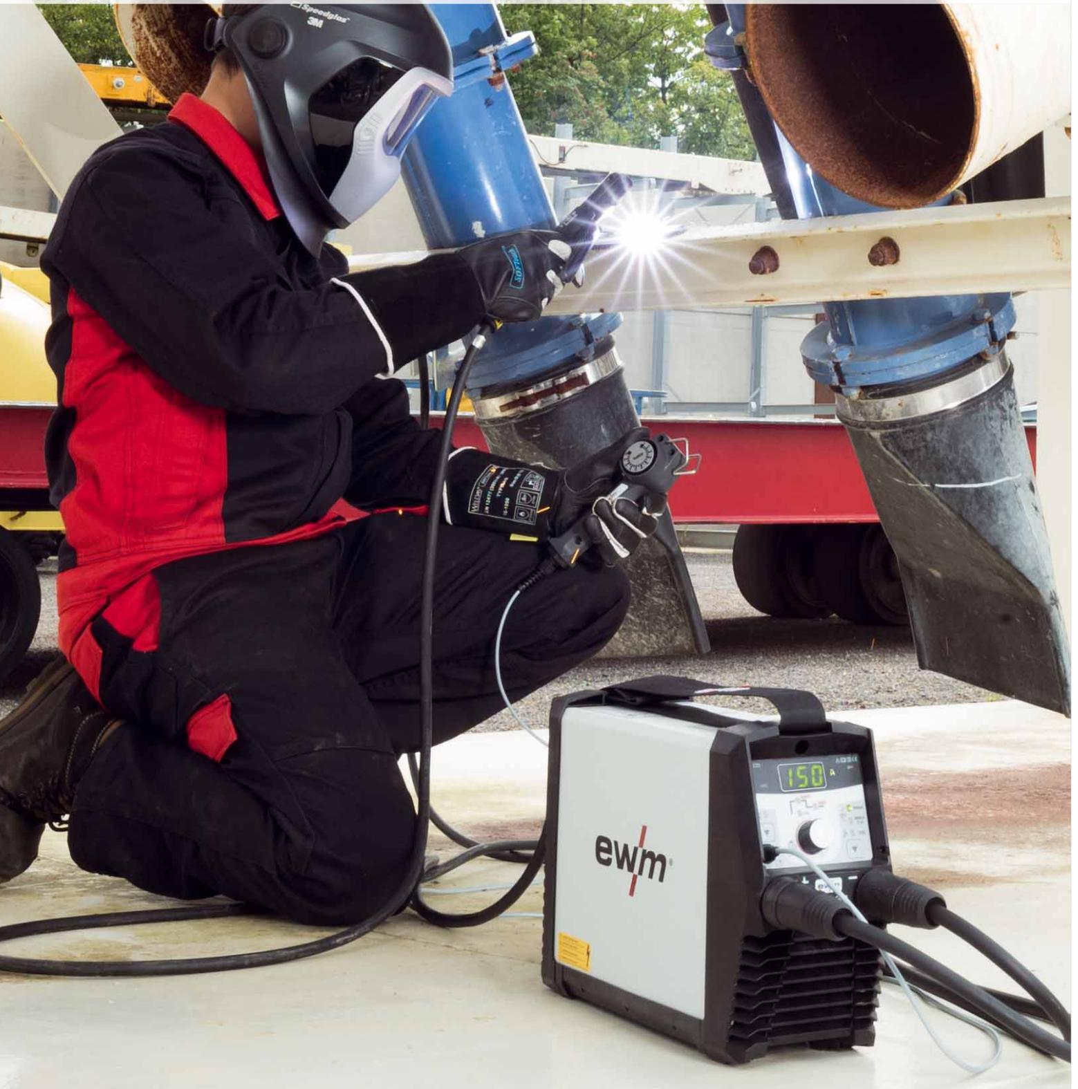
WIG-Schweißmaschinen, die in der Werkstatt und/oder Produktion eingesetzt werden, sind oft groß und verfügen über umfangreiche Programme zum Schweißen sowie große Ausdauer im Dauerbetrieb. Mobile Geräte sollen vor allem leicht sein und kommen meist mit einfachen Schweißprogrammen aus.
