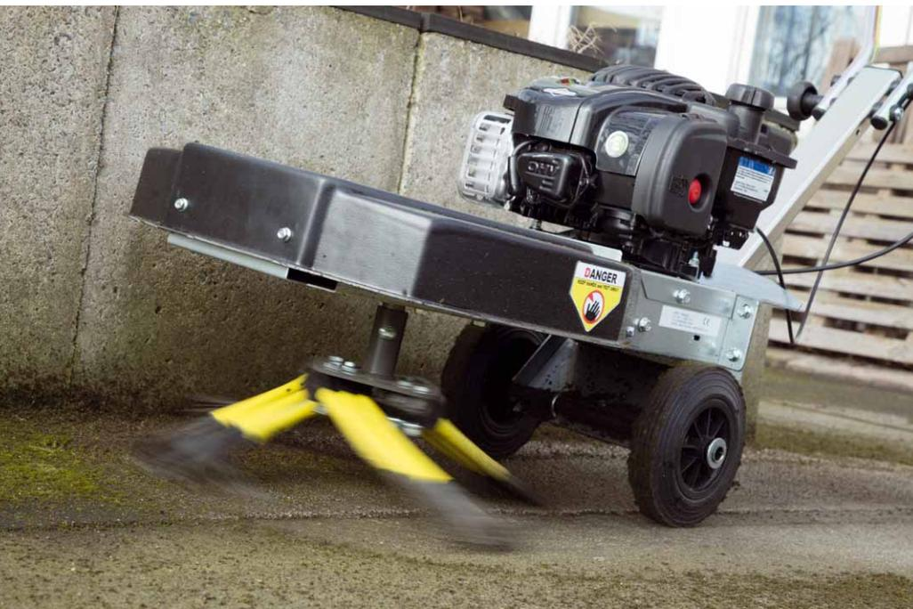
Gute Alternativen zur chemischen Wildkrautbeseitigung sind das mechanische Entfernen des sprießenden Grüns mithilfe von rotierenden Stahlbürsten sowie die thermische Bekämpfung der Pflanzen mit Flammen oder heißem Wasser. Wer sich mit der Praxis auseinandergesetzt hat,
