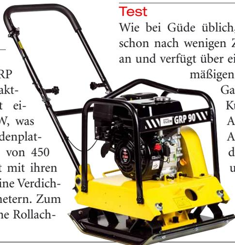
se für den Transport und eine Kunststoffmatte, um Steine mit empfindlicher Oberfläche zu rütteln.
