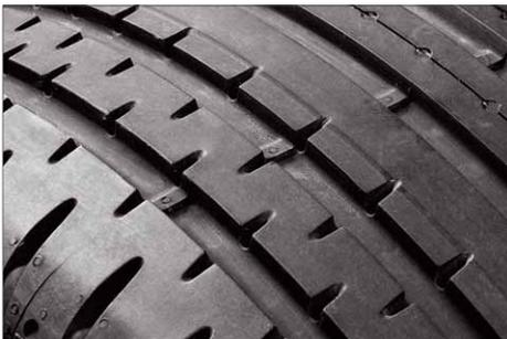
Mindestens 6 Mal finden sich auf dem Umfang verteilt diese quer verlaufenden Stege. Sie heißen „TWI“ (Tread Wear Indicator) auf Deutsch: Verschleißanzeiger. Wenn Quersteg und Lauffläche eine Ebene bilden, ist die gesetzliche Mindestprofiltiefe von 1,6 mm erreicht. Jetzt ist der Weg zum Reifenhändler fällig
