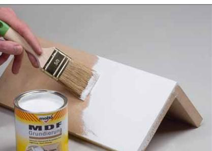
Auch für die Grundierung von MDF gibt es spezielle Materialien, die die Besonderheiten des Werkstoffs berücksichtigen und eine optimale Basis für den Lack bilden
