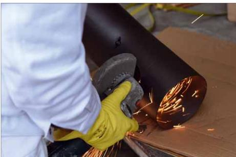
11 Anschließend werden die Rohre passend zugeschnitten
