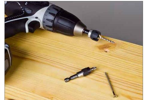
Um zu verhindern, dass das Holz reißt, sollte man vorbohren und die Schraubenköpfe versenken
