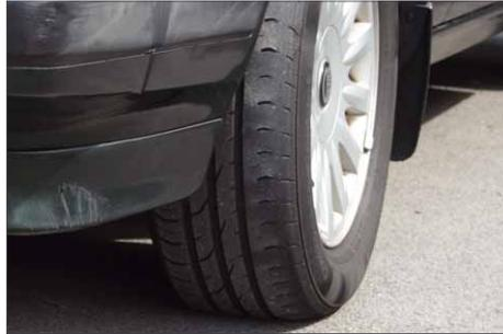
Die äußere Profilirille ist stark abgelaufen. Das kann auf eine fehlerhafte Achseinstellung hinweisen, z.B. nach unsanftem Kontakt mit einer Bordsteinkante. In diesem Fall waren hohe Kurvengeschwindigkeit in Rechtskurven wie Autobahnfahrten die Ursache für den ungleichmäßigen Verschleiß. Das liegt nahe, da die Reifenflanke keine Bordsteinschäden aufweist
