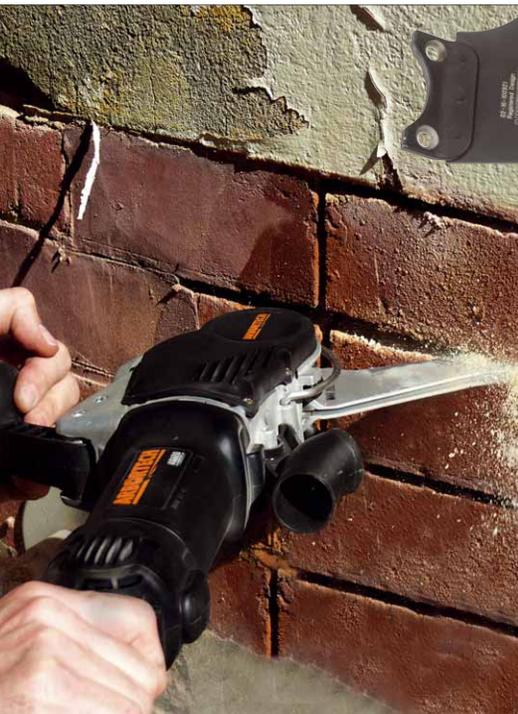
Bei der Fugen- oder Maueranierung ist die AS170 das ideale Werkzeug. Deutlich ist zu erkennen, dass der Staub selbst ohne angeschlossenen Sauger gering bleibt
