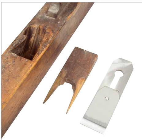
3 Nach einigen Monaten Trockenzeit konnte das Messer durch gezielte, vorsichtige Hammerschläge herausgelöst werden. Gut ist hier auch die bogenförmige Verformung des Hobelkörpers zu erkennen
