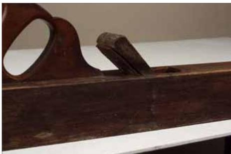
2 Durch Feuchtigkeitseinwirkung sind Hobelkörper, Keil und Hobelmesser zu einer Einheit verquollen
