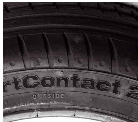
„Outside“ ist wichtig für den Reifenmonteur; weil dieser Reifen eine Felgenschutzleiste hat, ist es wichtig, ihn richtig herum auf der Felge zu montieren. Es gibt auch laufrichtungsgebundene Profile. Die richtige Laufrichtung wird z.B. durch Pfeile gekennzeichnet
