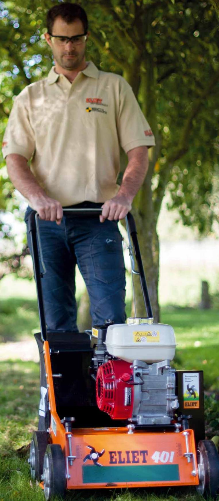
Der beste Zeitpunkt zum Vertikutieren ist nach dem ersten Düngen und den ersten beiden Schnitten. Hierbei sollte der Rasen mindestens eine Länge von 4 cm behalten. Der Vertikutierer wiederum sollte mit maximal 3 mm Schnitttiefe betrieben werden. So wird sichergestellt, dass nur Moose und Mulch ausgekratzt werden und die Wurzeln der Rasenpflanzen unbeschädigt bleiben.
