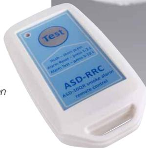
netzt werden. Dazu drückt man den Testknopf eines Melders für ca. 5 Sekunden, bis die Bereitschafts-LED dauerhaft leuchtet. Jetzt hat man zwei Minuten Zeit, die Testknöpfe aller zu vernetzenden Melder kurz zu betätigen. Sie bekommen nun vom ersten Melder einen von 65.535 Codes zugewiesen. Dies verhindert, dass sich verschiedene Rauchmelder-Netze gegenseitig stören. Anschließend werden Melder in die Montageflansche gesetzt. Eine kurze Melodie signa-
