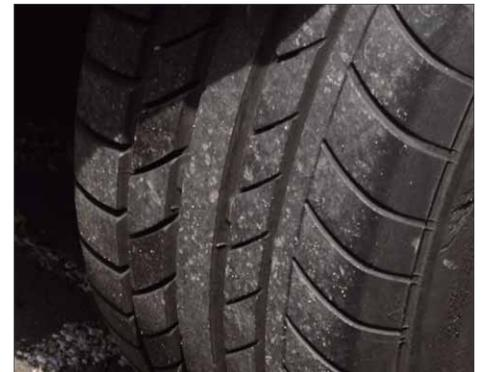
Sägezahnbildung: zu erkennen an hellen und dunklen Profilblöcken. Dieses Phänomen gibt es an den hinteren Reifen fast aller Autos mit Vorderradantrieb. Ursache ist die Schwerpunktverlagerung beim Bremsen und gleichzeitig fehlende Antriebseinflüsse. Werden die Sägezähne stärker, fängt der Reifen an zu brummen. Gegenmaßnahme: jährlicher Wechsel der Reifen zwischen Hinter- und Vorderachse
