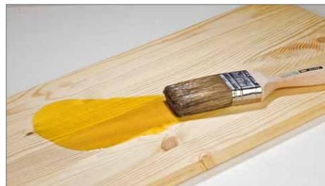
Das Öl wird mit dem Pinsel aufgetragen und zieht vollständig ein. Anderenfalls wird der Überschuss nach etwa einer Stunde mit einem Lappen abgewischt
