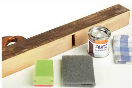
6 Um die Hobelsohle zu schützen und besser gleitfähig zu machen, wurde Leinölfirnis in mehreren Schichten aufgetragen
