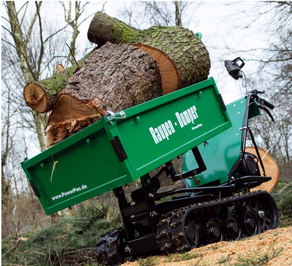
Dumper sind kleine Transportfahrzeuge, die meist mit einer Lademulde versehen sind. Sie verfügen über einen Eigenantrieb, meist ein Verbrennungsmotor, wobei immer mehr Hersteller ihre Dumper mit akkuversorgten Elektroantrieben ausstatten. Je nach Typ bewegen sich diese Maschinen auf Rädern oder Raupenkettensystemen, wobei Letztere bessere Eigenschaften beim „Treppensteigen“ besitzen.
