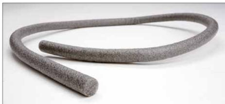
**2** Sanitär-Dichtsnur aus dem Baumarkt (in unterschiedlichen Stärken erhältlich) löst das Problem. Diese wird einfach zwischen Dämmplatte und Sturz geschoben. Schon ist alles dicht.
