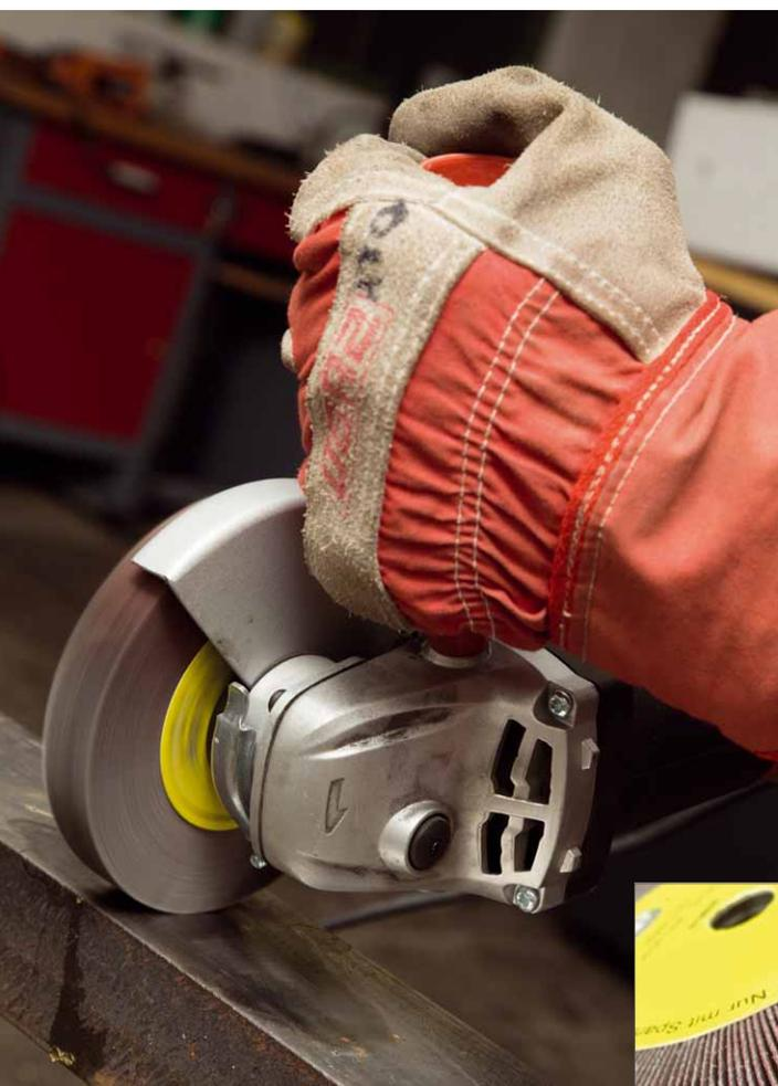
Welle des Winkelschleifers geschraubt wird. So kann es nur in eine Laufrichtung eingebaut werden und Verwechslungen werden verhindert. Ausgelegt ist der Mopp für den Betrieb auf einem klassischen Einhandwinkelschleifer mit maximal 12.200 Umdrehungen.
