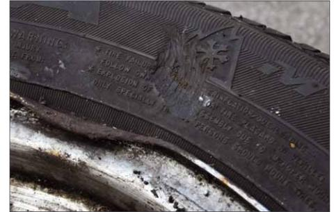
Ein typischer Bordsteinschaden in sehr deutlicher Ausprägung. In diesem Falle bedeutet er das Ende von Reifen und Felge
