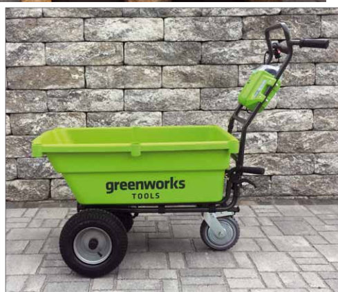
Am Hinterrad befindet sich eine Feststellbremse
