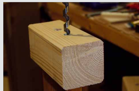
7 + 8 Um Löcher gerade in Stirnholz und/oder Kanten zu bohren, können Bohrschablonen gekauft werden. Oder man bohrt einfach mit der Standbohrmaschine ein passendes Loch in einen Holzrest und benutzt diesen als Führung
