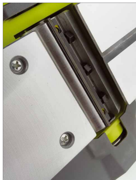
Der preiswerte Ryobi besitzt eine gefräste Stahlsole. Die Halterung der beiden Messer ist funktional jedoch aufwendig zu justieren
