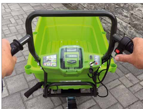
Das Bedienpanel ist ähnlich wie ein Motorradlenker aufgebaut
