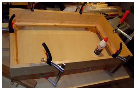
5 Zuerst werden die Rahmen des Staukastens verleimt, anschließend können sie übereinander-gesetzt werden
