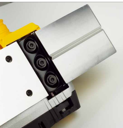
DeWalt hat eine tiefe V-Nut in der Sohle. Die Befestigung der Messer ist sehr massiv
