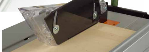
Die Sägeblatt-Haube deckt das Sägeblatt weitgehend ab. Das schützt den Anwender und sorgt für eine effektive Staubabsaugung
