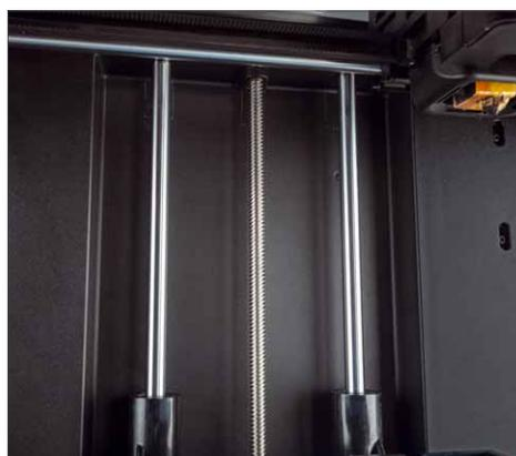
Der Tisch besitzt eine präzise Stangenführung, der Antrieb erfolgt durch eine Spindel
