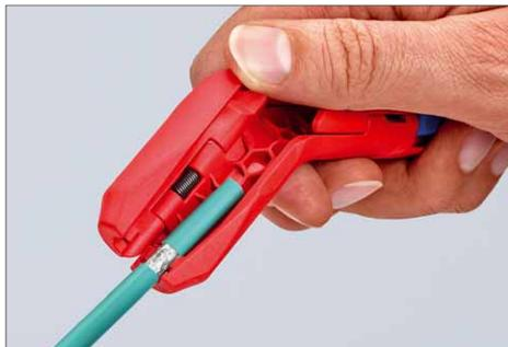
Auch beim Abmanteln von Datenkabeln entstehen keine Schäden an der Abschirmung
