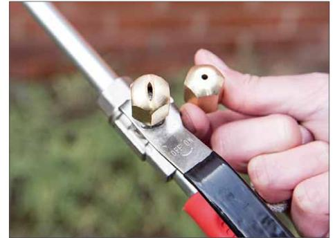
In der „Parkposition“ am Handgriff ist die Sprühstrahldüse für flächiges Arbeiten schnell zur Hand
