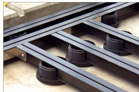
2 Um Bodenunebenheiten auszugleichen, wird die Unterkonstruktion auf höhenverstellbaren Kunststofffüßen aufgebaut. Ob alles gerade liegt, wird einfach mit der Wasserwaage geprüft.
