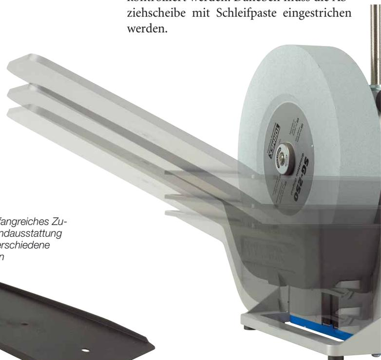
Zum Entleeren und Reinigen kann das Becken herun-tergefahren und abgenommen werden
