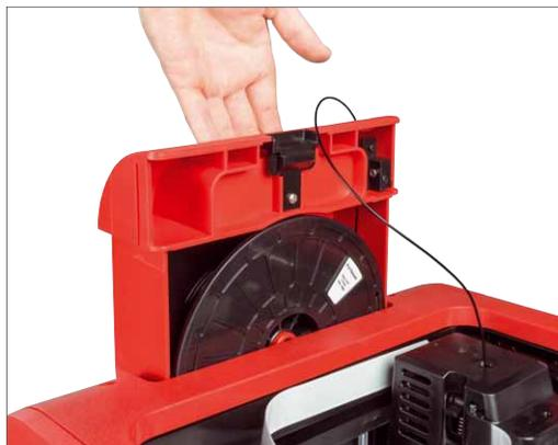
Besonders gut hat uns das lichtdichte Fach für die Filamentrolle gefallen. Filament härtet durch UV-Licht aus und wird so mit der Zeit unbrauchbar
