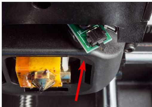
Bei der Nivellierung des Drucktisches wird dieser kleine Endschalter ausgeklappt. Mit seiner Hilfe wird der Abstand zwischen Tisch und Druckkopf genau eingestellt
