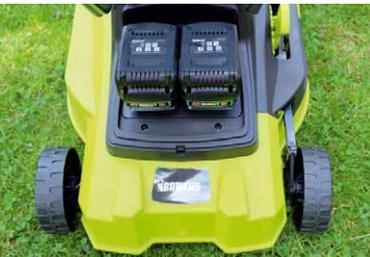
36 Volt Betriebsspannung erzielt der Rasenmäher mithilfe von zwei 18-V-Lithium-Ionen-Akkus
