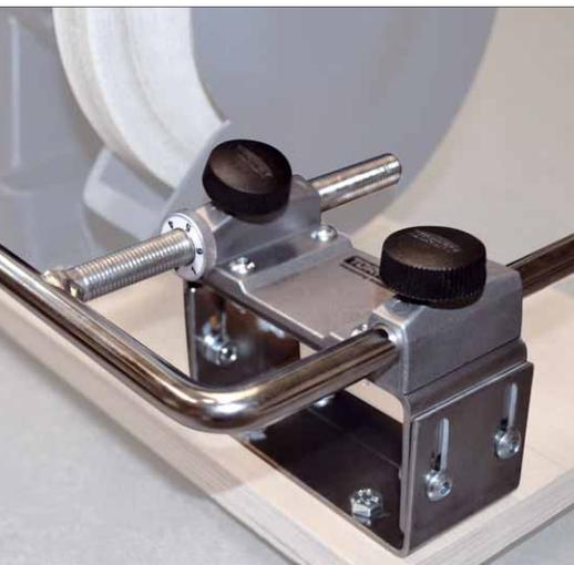
Wenn Klingen ganz neu geschliffen werden müssen, empfiehlt es sich, diese mit dem Montagesatz BGM-100 an einem schnell drehenden Schleifstein vorzuschleifen und erst danach die T8 zu nutzen. So reduziert man den Verschleiß an der T8 deutlich und spart viel Zeit, da der Abtrag des schnell drehenden Steins deutlich größer ist. Dabei sollte das Eisen auf jeden Fall gut gekühlt werden, damit es nicht ausglüht
