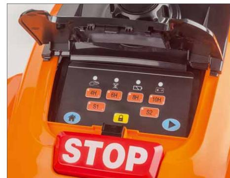
Mit der Taste in der oberen Reihe wird die Mähdauer eingestellt
