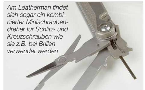
Am Leatherman findet sich sogar ein kombinierter Minischraubendreher für Schlitz- und Kreuzschrauben wie sie z.B. bei Brillen verwendet werden
