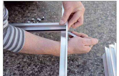
**3** Dank Nutschrauben, die in den Alu-Profilen halten, und exakter Bohrungen benötigt man zum Zusammenbau lediglich einen 10er-Schlüssel
