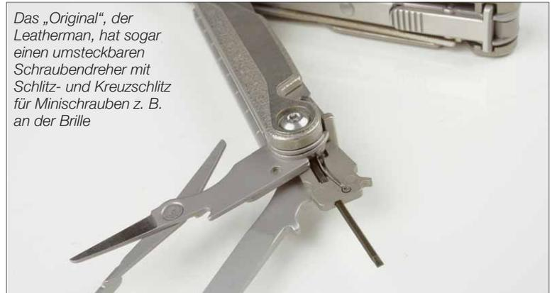
Das „Original“, der Leatherman, hat sogar einen umsteckbaren Schraubendreher mit Schlitz- und Kreuzschlitz für Minischrauben z. B. an der Brille
