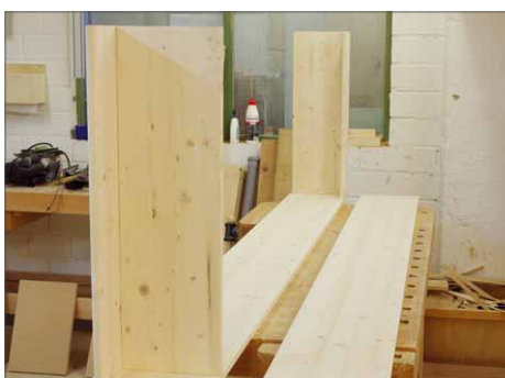
16 Dann werden die Korpusse der Regale zusammengeleimt, indem Boden und Deckel mit den Seitenwänden verleimt werden.
