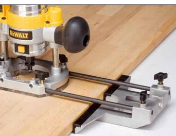
Für anspruchsvolle Holzverbindungen ist eine Oberfräse das richtige Werkzeug. Mit ihr lassen sich beinahe alle Arten von Nuten, Zinken, Zapfen und Passungen herstellen
