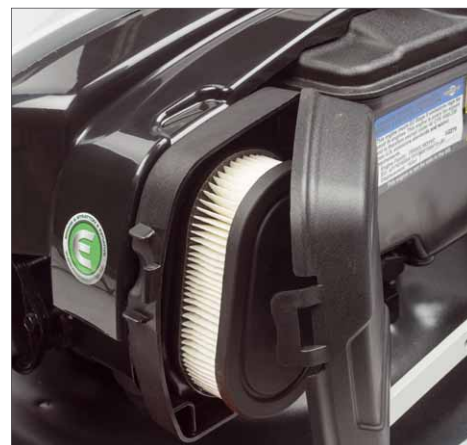
Neben der Zündkerze ist der Luftfilter das einzige Bauteil am Motor, das laut Herstellervorschrift gewechselt werden sollte
