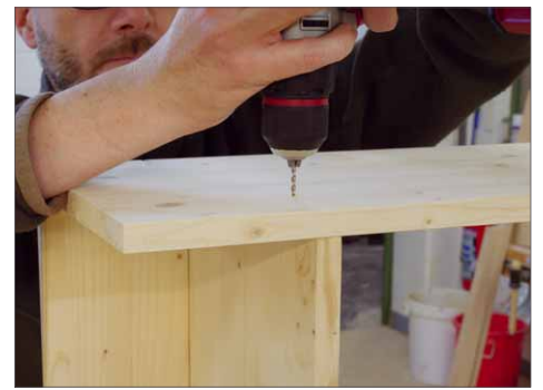
17 Das geschieht mit der gleichen Technik wie eben: In Position bringen, Position anzeichnen, vorbohren, senkbohren, Leim angeben und verschrauben.
