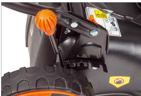
Mit dem großen Hebel am rechten Hinterrad lässt sich die Schnitthöhe bequem in sieben Stufen verstellen
