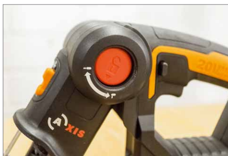
Hybridsäge heißt in diesem Fall, dass aus einer Stichsäge ganz einfach durch Schwenken des Sägekopfes eine Säbelsäge wird
