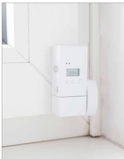
Fenstersensoren warnen, wenn ein Fenster oder eine Tür aufgebrochen wird
