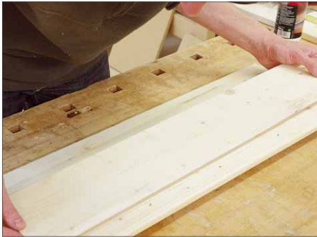
13 ... und die Bretter dann wieder in Position gebracht. Dabei helfen einem die Bleistiftlinie und die Spitzen der Schrauben, die im Idealfall in die vorgebohrten Löcher rutschen.
