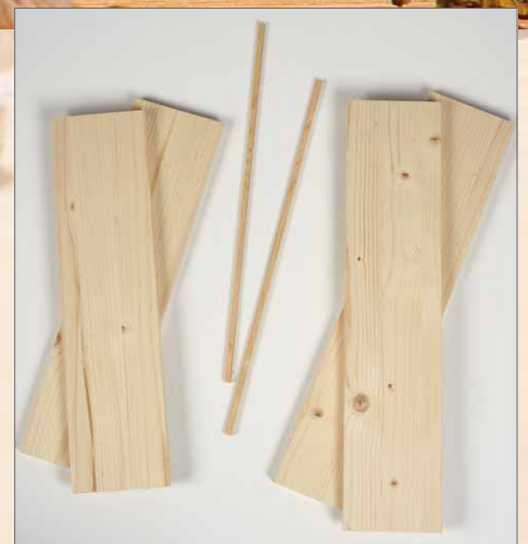
Heimwerker arbeiten heute viel mit Leimholz und Leisten. Leimholz besteht aus Vollholzleisten, die zu einem Brett verleimt werden. Dabei werden die Leisten mit ihrer Wachstumsrichtung gegenseitig verleimt, so dass sich die entstandene Platte kaum verziehen kann
