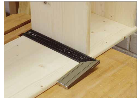
20 Mit dem Tischlerwinkel wird kontrolliert, ob er gerade sitzt. Dann wird die Position angezeichnet. Das macht man am besten gleich für beide Seiten.
