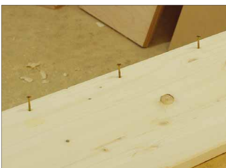
11 Dann werden die Schrauben so weit eingeschraubt, dass die Spitzen soeben aus den Böden herausragen.
