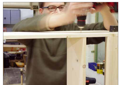
21 Zum Bohren wird die betreffende Seite natürlich nach oben gedreht. Der Teil ist ein bisschen lästig – zum Bohren, Senken Leimen und Schrauben muss das Regal mehrfach gedreht werden
