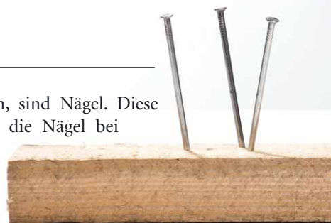
Stehen die Nägel beim Einschlagen schräg zueinander, lassen sich die Bretter später nicht mehr auseinanderziehen
