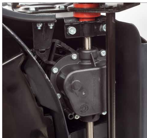
Das stufenlose Getriebe für den Radantrieb stammt aus dem bestens beleumundeten Haus GT
