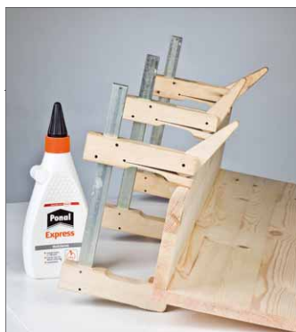
Bis zum Abbinden des Leims sollten die Zwingen die Verbindung zusammenhalten
