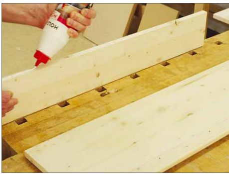
12 Das sieht man erst, wenn man die provisorisch mit dem Zwingen fixierten Bretter wieder abnimmt. Auf die Stirnseiten der Bretter wird Leim gegeben ...
