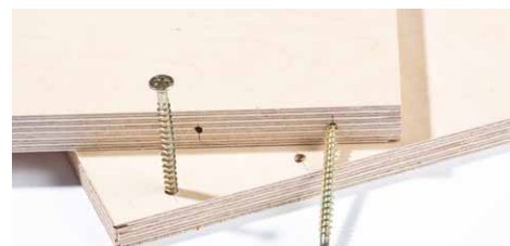
Ein Holz sollte mit dem Schraubendurchmesser durchgebohrt werden, das andere Holz wird klein vorgebohrt, um das Reißen des Holzes zu verhindern
