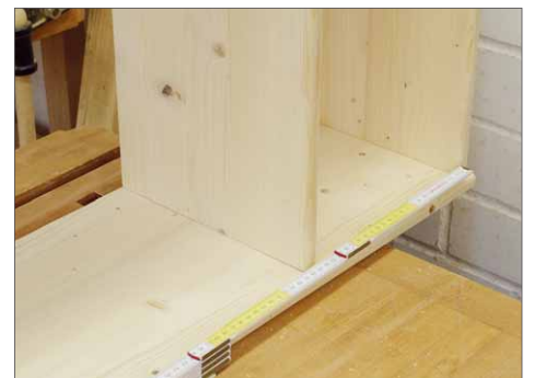
19 Die Böden werden in der gleichen Technik eingesetzt. Zuerst wird die Position ausgemessen und der Boden „trocken“ an seine Position gesteckt.
