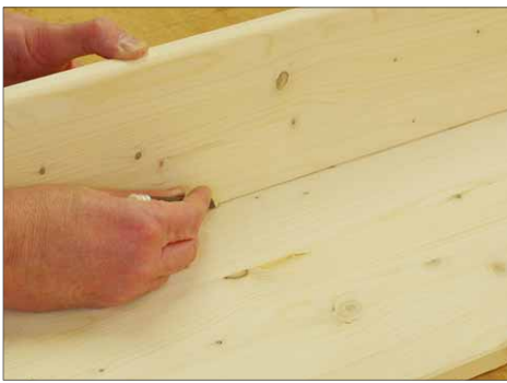
7 Die Position des Bretts wird mit einem Bleistift angezeichnet.
