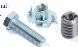
Um die Zugfestigkeit von Einschlag- und Eindrehhülsen zu erhöhen, werden diese von hinten eingesetzt, so dass sie sich bei Zug im Holz „abstützen“ können
