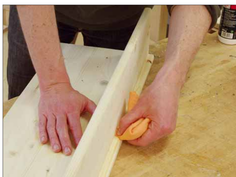
15 Herausquellender Leim wird sofort feucht abgewischt
