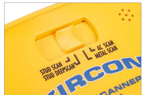
Seine amerikanische Herkunft zeigt der Zircon durch die Möglichkeit des Tiefenscans für Balkenkonstruktionen
