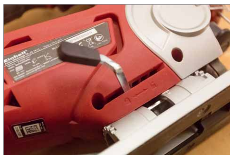
Durch den Schnellverschluss lässt sich der Sägeschuh sehr einfach verstellen
