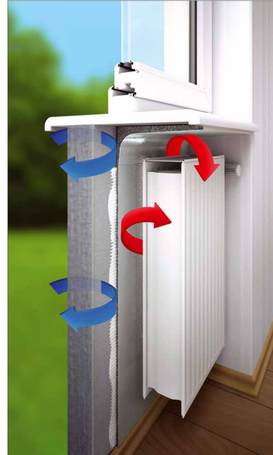
Gerade bei älteren Gebäuden mit nachgerüsteter oder modernisierter Heizung ein Thema: die Isolierung der Heizkörpernischen
