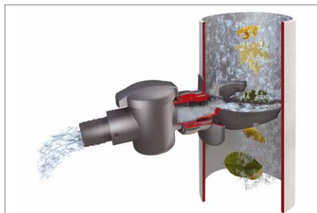
Mit nur drei einfachen Arbeitsschritten wird das Fallrohr angezapft. Schon kann das Regenwasser zum Gießen genutzt werden. Die Funktionsskizze zeigt das Prinzip
