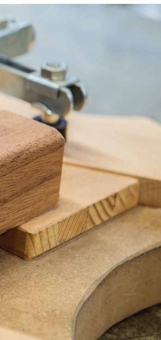
Auch beim Verleimen sind Schnellspanner eine große Hilfe
