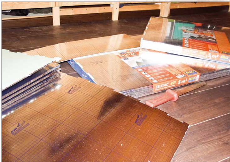
15 Die Trittschalldämmung SELITAC wird als ausfaltbare Plattenware geliefert
