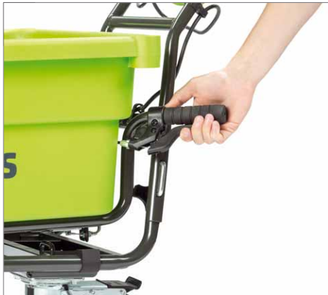
Mit dem Hebel an der linken Seite lässt sich die Mulde kippen
