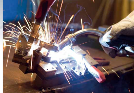
Beim Schweißen wird die Kunststoffkappe einfach weggelassen, damit sie nicht schmilzt
