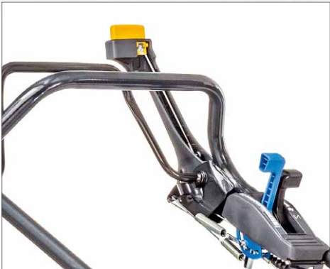
Hebelwerk: Der Hebel mit dem gelben Knopf öffnet oder schließt die Messerkupplung. Der Bügelgriff schaltet den Radantrieb zu. Die beiden Schieberegler regeln die Motordrehzahl (schwarzer Hebel) und die Fahrgeschwindigkeit (blauer Hebel)
