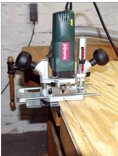
13 ... oder mit der am Parallelanschlag geführten Oberfräse
