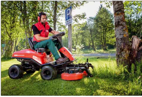
Die Kombination aus Frontmähwerk und Hecklenkung macht das Gerät sehr wendig. Rund um Bäume und Büsche bleibt kaum etwas stehen
