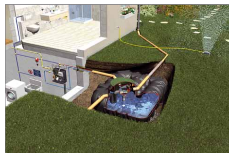
Der Aufwand ist überschaubar, der Nutzen riesig. Regenwassernutzung bietet auch für den häuslichen Bereich ein hohes Sparpotenzial. Die Tanks sind natürlich mit Schmutzfiltern vor Verunreinigungen geschützt
