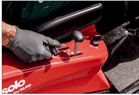
Die Motorsteuerung erfolgt über zwei Hebel und ein Zündschloss, einfacher geht es kaum
