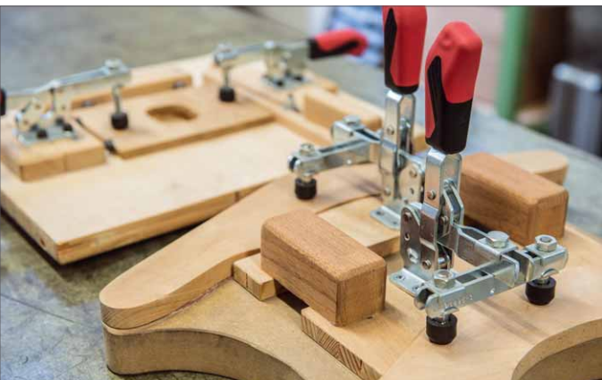
Auch beim Verleimen sind Schnellspanner eine große Hilfe
