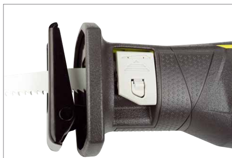
In den Lösehebel für das Sägeblatt haben die Ryobi-Techniker einen federbelasteten Zusatzhebel integriert. Der arretiert die Blatt-Verriegelung in geöffnetem Zustand. Das macht den Blattwechsel äußerst bequem
