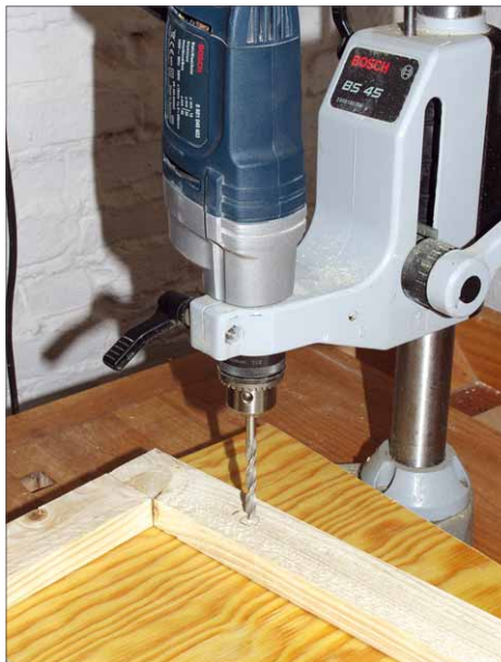
15 Da die Bohrungen für die Gewindestangen möglichst rechtwinklig durch die Holme führen sollen, ist eine Bohrschneide im Bohrstand oder eine Säulenbohrmaschine das Mittel der Wahl
