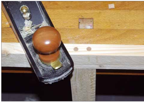
11 Die Kür: Mit dem Hobel kann man auch den letzten Überstand der Dübel oder die Spuren vom Absägen der Dübel beseitigen – muss man aber nicht.
