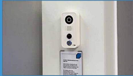
Die Kamera zeichnet auf, wer vor der Tür steht, und sendet das Foto direkt ans Smartphone des Bewohners – egal, wo sich dieser gerade aufhält
