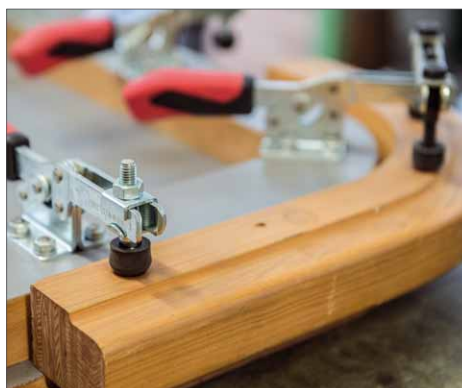
Schnellspanner halten Werkstücke beim Bearbeiten zuverlässig fest ...
