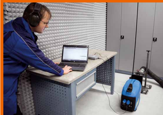
Hier kann die Leistung von Verbrennungsmotoren und deren Abgasverhalten geprüft werden
