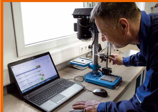
Immer wieder werden Maschinen einer Stichprobenkontrolle unterzogen. Hier wird beispielsweise das seitliche Spiel der Spindel einer Tischbohrmaschine geprüft
