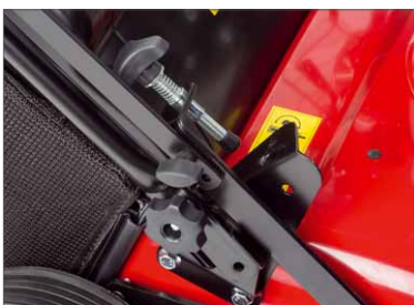
Solo setzt auf eine stufenlose Höhenverstellung per Drehrad
