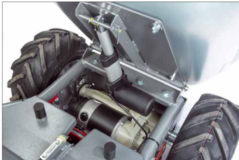
Sowohl der Linearmotor der Kippmechanik als auch der riesige Antriebsmotor mit Differenzial-getriebe hinterlassen einen sehr soliden Eindruck
