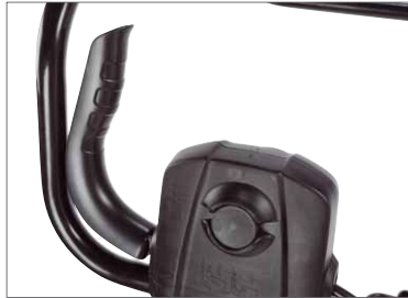
Wie fast alle Testgeräte wird auch der Scheppach per Griffhebel mit Sicherheitsknopf gestartet
