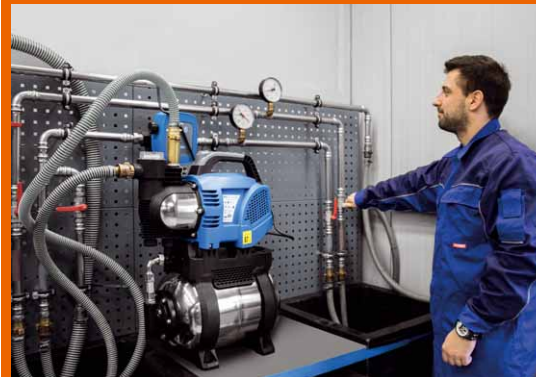
Auch die verschiedenen Pumpentypen werden umfangreichen Prüfungen unterzogen. Saugleistung, Förderleistung und Trockenlaufschutz sind nur einige der Prüfpunkte
