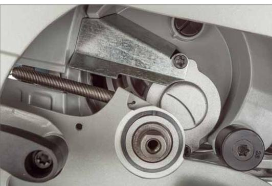
Gut 10 mm hat Bosch die Sägeblattaufnahme nach unten versetzt. Damit sind Schnitttiefen möglich, die sonst deutlich größere Blattdurchmesser erfordern
