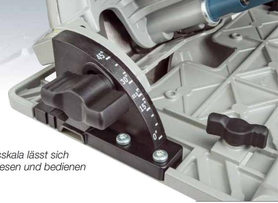
Bei Handkreissägen greifen Handwerker gerne auf kompakte Modelle zurück, die jedoch nur eine geringe Schnitttiefe aufweisen. Bosch hat bei seinen beiden neuen Sägen den Sägeblattflansch per Getriebe tiefer gelegt, so dass mit einem 165er-Sägeblatt Schnittleistungen erzielt werden können, die sonst nur mit deutlich größeren Sägeblättern möglich sind.
