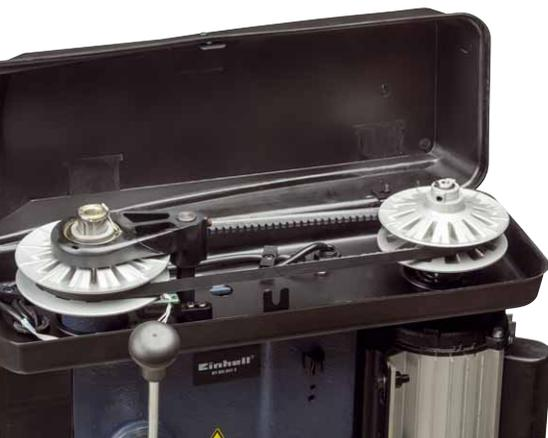
Die stufenlose Drehzahlregulierung wird mithilfe zweier im Durchmesser veränderlichen Treibscheiben realisiert
