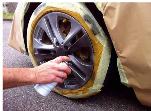
Wie bei allen Lackierarbeiten ist sorgfältiges Abkleben der umgebenden Teile einfacher als späteres mühsames Entfernen des Sprühnebels
