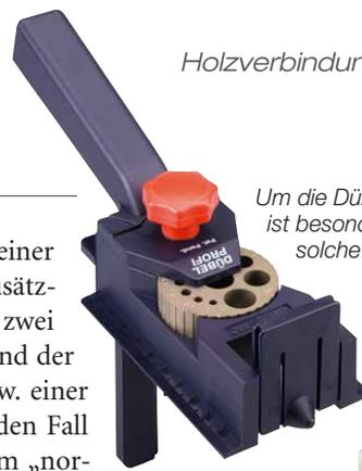
Um die Dübellöcher wirklich gerade zu bohren, ist besonders an den Stirnseiten der Böden eine solche Dübellehre von großem Nutzen
