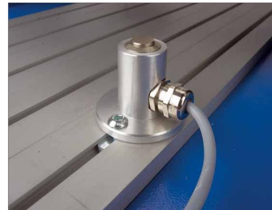
Unser Testmodell war mit einem Taster zum Tasten der Werkzeuglänge versehen. Das ist praktisch, wenn bei einem Werkstück Arbeitsgänge mit verschiedenen Werkzeugen erforderlich sind. So muss nur einmal die Arbeitshöhe (Nullpunkt der Z-Achse) eingerichtet werden
