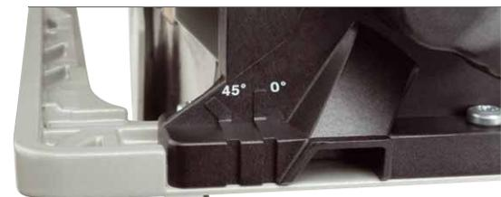
Zwei Markierungen für 90° und 45° Schnittwinkel sorgen für passende Schnitt-Ansatzpunkte
