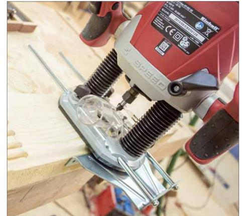
Bis auf zwei Oberklassemaschinen hatten alle Geräte im Test eine 8 Millimeter Spannzange
