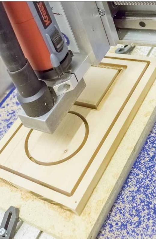
Damit der Nutentisch nicht beschädigt wird, legt man beim Fräsen eine Opferplatte unter. Der von Cut2D generierte G-Code zur Maschinensteuerung wird in die Steuersoftware geladen, die Maschine referenziert und der Nullpunkt auf dem Werkzeug angefahren. Den genauen Vorgang erklärt die Bedienungsanleitung. Dann heißt es nur noch „Start“ anzuklicken und zu staunen
