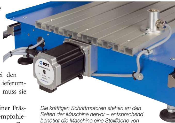
Die kräftigen Schrittmotoren stehen an den Seiten der Maschine hervor – entsprechend benötigt die Maschine eine Stellfläche von 620 x 640 mm
