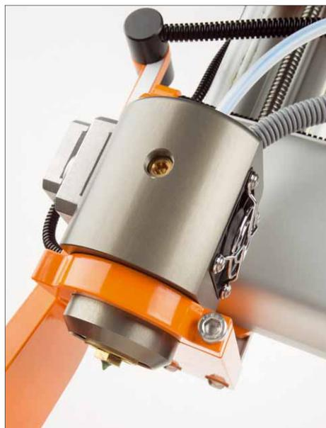
Der Druckkopf kann gegen einen Fräsaufsatz getauscht werden
