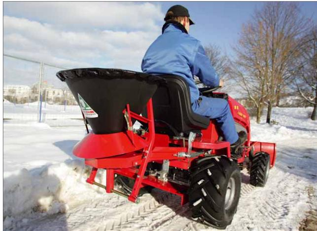
Der Rasentraktor Echotrak A-218KAWA-4WD (getestet in HWP 2/2012), kombiniert mit Schneeräumhilfe und Rotationsstreuer, ist ein robustes Arbeitsgerät für den Winterdienst
