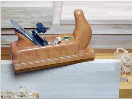
**1** Die Kanten der Bretter zeigen häufig noch Spuren der Zuschnittsäge. Deshalb habe ich sie mit einem Putzhobel abgezogen. Auch Brandspuren die entstehen, wenn das Sägeblatt stumpf ist oder der Mann an der Säge zu langsam gesägt hat, lassen sich weghobeln.
