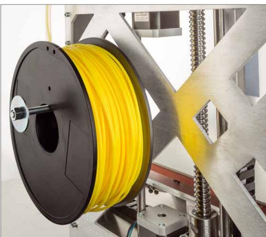
Der Filamentträger ist sehr einfach, eine Schraube und ein Silikonschlauch dienen zur Führung des Filamentdrahtes
