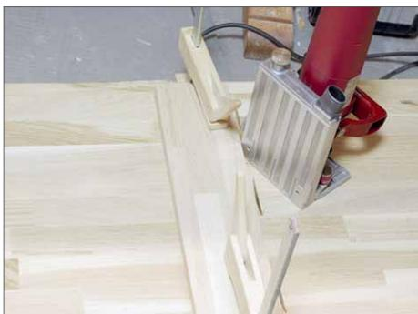
**10** Ich nehme in diesem Fall nach Möglichkeit immer die Fußplatte der Flachdübelfräse als Anschlag für die Fräsungen.
