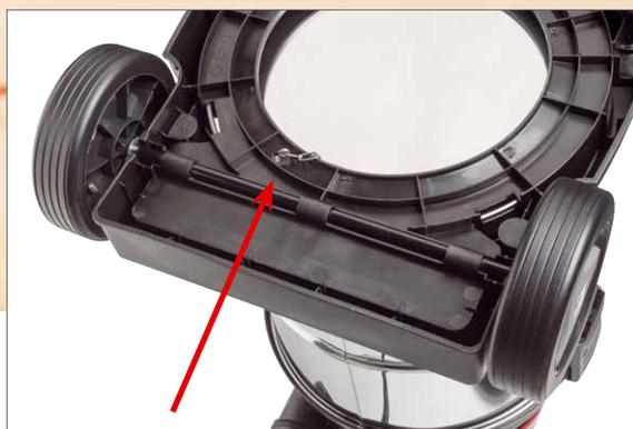
Bei einigen Saugern mit Edelstahl-Saugbehälter hängt unter dem Gerät ein kleines Kettchen. Das soll eventuell auftretende statische Ladung ableiten
