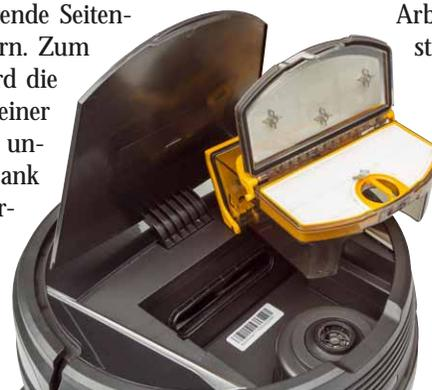
*Der aufgesaugte Staub landet im großen Schmutzbehälter. Zum Leeren wird einfach die gelbe Klappe auf der Vorderseite geöffnet*
