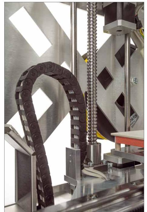
Die Spindeln für die Z-Achse besitzen präzise Führungen, so dass der Druck ebenfalls sehr präzise wird
