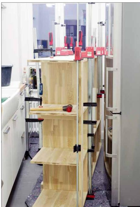
**16** Der vorletzte Schritt beim Verleimen ist das Aufleimen der zweiten Seitenwand.
