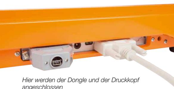
Hier werden der Dongle und der Druckkopf angeschlossen
