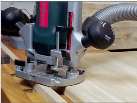
**3** Die Längstkanten werden ebenfalls abgerundet. Damit man bei langen Stücken nicht mit der Fräse abkippt, kann man auf der freien Seite ein Restholz unterlegen.
