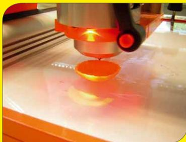
Tropfen für Tropfen wird das Werkstück aufgebaut, ...
