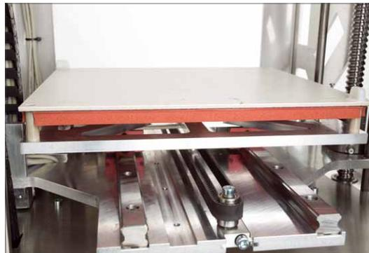
Der Tisch wird durch Heizelemente bis auf 100 °C erwärmt
