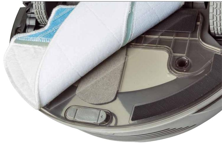
gesteckt – fertig. Der Tank fasst ca. 60 ml. Reinigungsflüssigkeit. Im Test hat das für eine 10 m<sup>2</sup> große Küche gereicht. Da der Roboter die Fläche nach dem Zufallsprinzip reinigt, überfährt die Maschine bereits gereinigte Flächen mehrfach. Dabei können je nach Bodenbelag Fahrspuren zurückbleiben. Trotz dieses kleinen Mankos ist es erstaunlich, wie gründlich die Reinigung ist.
