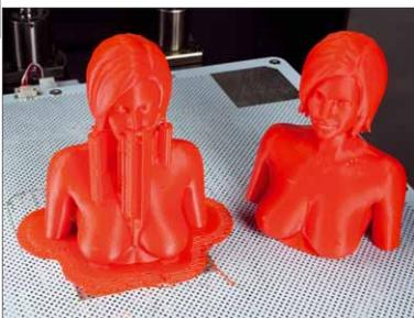
Nach dem Druck sind noch ein paar Handgriffe nötig, um die Figur fertigzustellen. Hauptsächlich müssen der Sockel und die Stützen entfernt werden, dann kann die Figur weiterbearbeitet (zum Beispiel bemalt) werden
