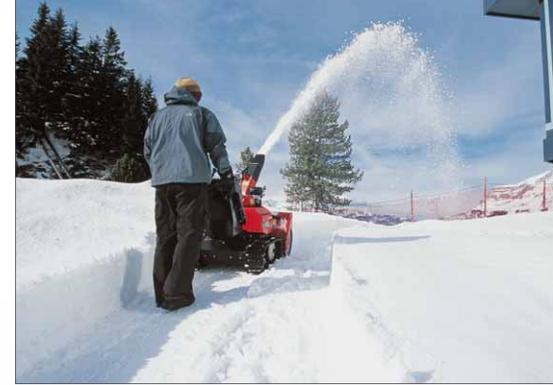
Honda HSM 1590i ZE, eine Schneefräse mit Hybridtechnik: Fräse und Raupen werden getrennt angetrieben. Auch kommerzieller Einsatz ist dieser Fräse nicht fremd
