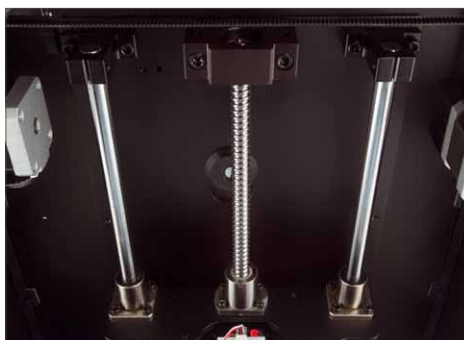
Dank der doppelten Führung und der durch Schrittmotoren gesteuerten Spindel lassen sich bis zu 1,5 µm kleine Schritte realisieren
