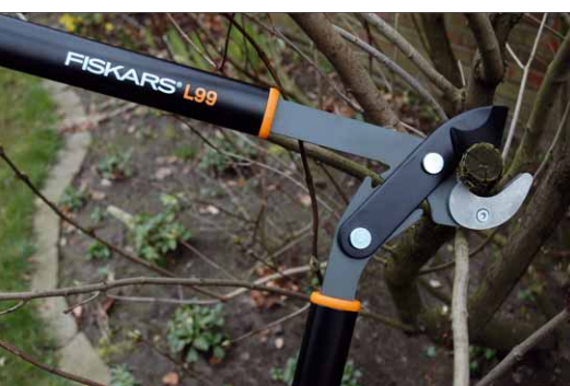
Ambossscheren sind besonders gut für den Rückschnitt von Totholz geeignet. Bypassscheren verwendet man dagegen bei frischen Ästen und Trieben
