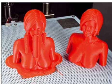
Es ist etwas schwierig, das Model vom Tisch zu trennen, da das Filament in die Lücken läuft und so gut auf dem Tisch haftet
