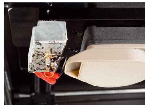
Beim Aufwärmen des Gerätes tritt aus der Düse etwas Filament aus. Dies braucht jedoch nicht entfernt zu werden, da die Maschine zuerst eine Grundplatte druckt
