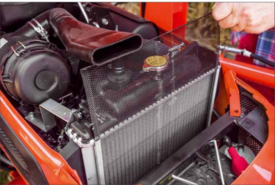
Den Kühler schützt ein einfaches Gitter. Zu Reinigungszwecken kann es leicht herausgezogen werden
