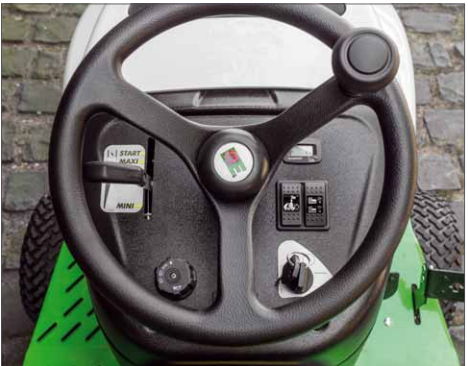
Zur Instrumententafel gehören: Zündschloss, Bedienhebel für die Motordrehzahl, Mähwerkaktivierung, Lichtschalter, Stundenzähler, Freigabeumschalter „Mäher im Rückwärtsgang“ und Hupe
