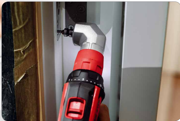
Der Winkelschraubvorsatz ermöglicht es auch an schwer zugänglichen Stellen die Schraube präzise anzusetzen und oberflächenbündig einzudrehen
