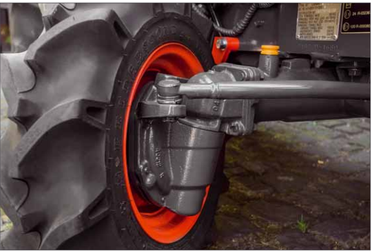
Die Portalachskonstruktion an der Vorderachse ermöglicht Allradantrieb und große Bodenfreiheit
