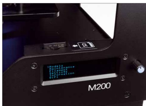
Die Bedienelemente beschränken sich auf den SD-Kartensteckplatz, ein Textdisplay und einen Dreh-Druckschalter
