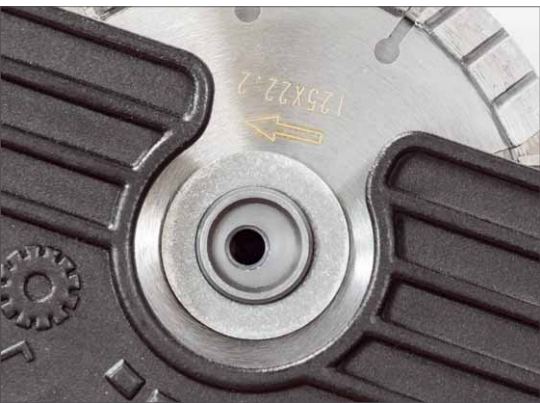
Die Sicherungsschraube der Trennscheiben ist nicht mittig platziert und besitzt ein Linksgewinde. So wird sichergestellt, dass sich diese Schraube nicht „losrappeln“ kann
