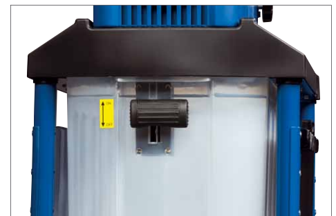
Um einen Eingriff von unten in die laufende Schneidwalze zu verhindern, werden die Fangboxen mit einem Kontaktschalter ausgestattet
