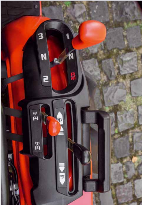
Mit dem vorderen Hebel werden die drei Vorwärtsgänge und der Rückwärtsgang geschaltet. Die beiden anderen Hebel steuern das Heben und Senken des Heckanbaugerätes und den zuschaltbaren Allradantrieb
