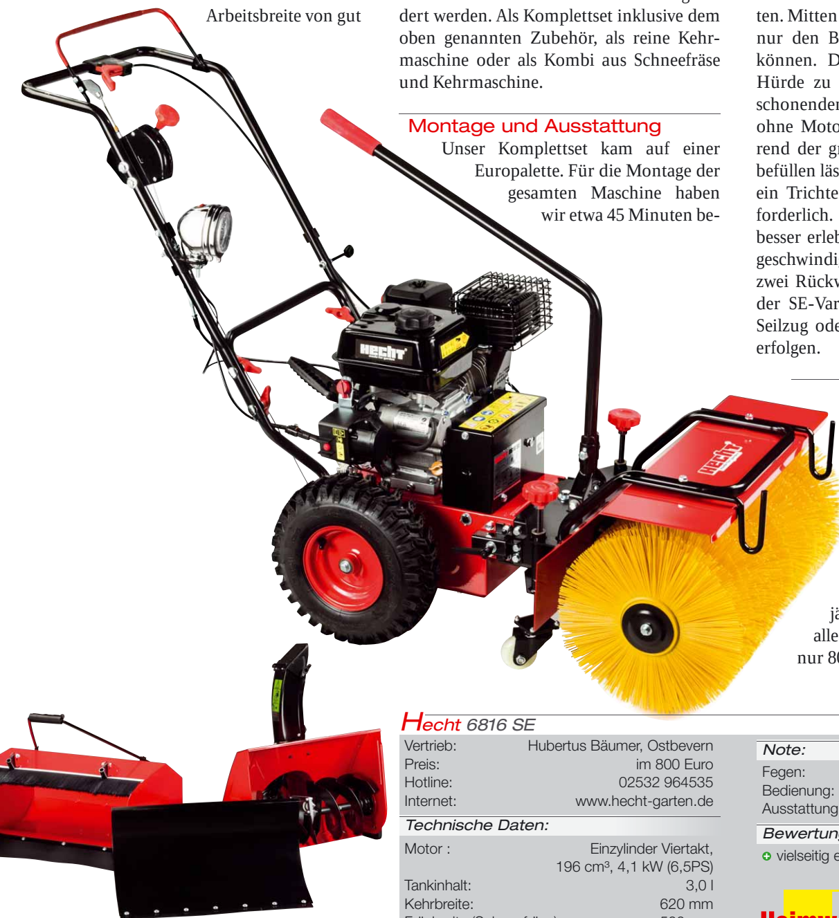
Mit dem Zubehör Schneeschild, Schneefräse und Sammelbox ist die Maschine das ganze Jahr einsetzbar
