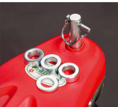
Die Schnitthöhenverstellung am Vorderrad erfolgt durch Umstecken der 10 mm dicken Beilagscheiben
