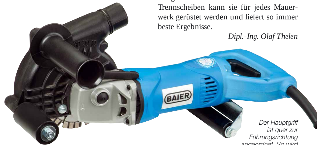
Die Sicherungsschraube der Trennscheiben ist nicht mittig platziert und besitzt ein Linksgewinde. So wird sichergestellt, dass sich diese Schraube nicht „losrappeln“ kann
