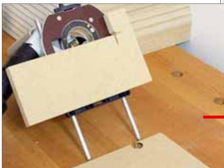
**5** Um die Töpfe, in die später die Verbindungsbeschläge eingepresst werden, präzise immer an den gleichen Stellen in die Böden zu fräsen, haben wir uns einen Anschlag gebaut und unter dem Tisch der Oberfräse befestigt
