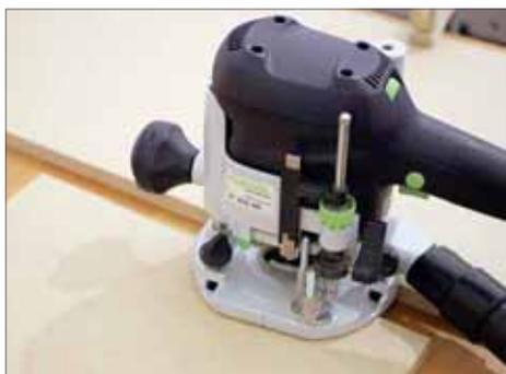
**3** Anschließend werden mit dem gleichen Abrundfräser die Kanten der Sichtseiten der Böden abgerundet
