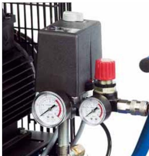
Der Druckregler stammt von Condor und ist recht hochwertig. Das große Manometer zeigt den Kesseldruck, das kleine den geregelten Abgabedruck an
