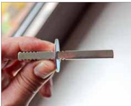
**3** Wenn sich potenzielle Einbrecher sicher fühlen, werden Fensterrahmen teilweise von außen angebohrt, der Vierkant nach außen durchgezogen und das Fenster dann mit einem Schraubendreher geöffnet.
