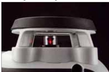
Unter dem runden „Deckel“ sitzt ein Kegel, der den horizontalen Strahl auf 360° projiziert
