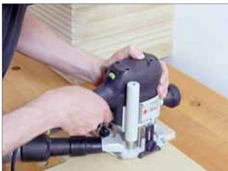
**6** Da er aus dem gleichen 16-mm-MDF besteht wie die Böden, verhindert er gleichzeitig, dass die Maschine wegkippt, wenn man den Fräser ins Material drückt
