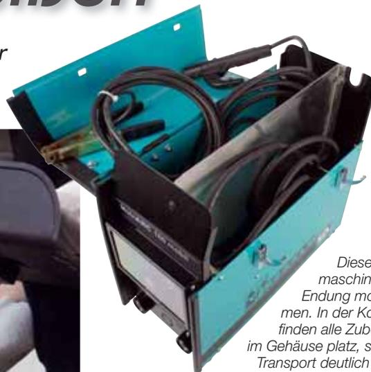
Diese Schweißmaschine trägt die Endung mobil im Namen. In der Konsequenz finden alle Zubehörartikel im Gehäuse platz, so wird der Transport deutlich erleichtert
