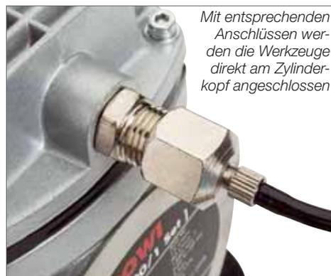
Mit entsprechenden Anschlüssen werden die Werkzeuge direkt am Zylinderkopf angeschlossen
