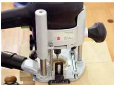
**7** Die gleiche Schablone hilft auch, die Bohrungen für die Dübel, in die die Exzenterverbinder später greifen, an den den Töpfen exakt gegenüberliegenden Stellen in die Wangen zu bohren
