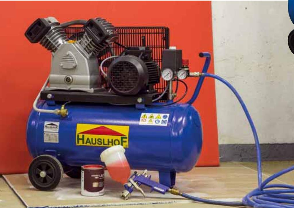
Der Kompressor ist mit einem Zweizylinder-Aggregat in V-Form ausgestattet. Es wird per Riementrieb von einem 2,2 kW starken 400-V-Motor angetrieben. Als Ansaugleistung gibt der Hersteller 400 l/min, als Abgabeleistung 265 l/min an. An Stellfläche benötigt der Kompressor ca. 0,5 Quadratmeter. Für die Luftentnahme steht ein geregelter Abgang zur Verfügung. Der Maximaldruck liegt bei 10 bar.
