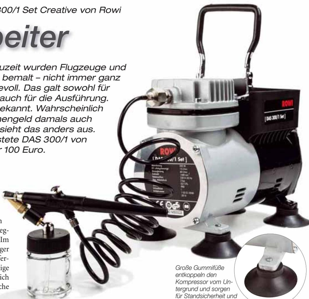
Große GummifüÙe entkoppeln den Kompressor vom Untergrund und sorgen für Standsicherheit und Vibrationsarmut
