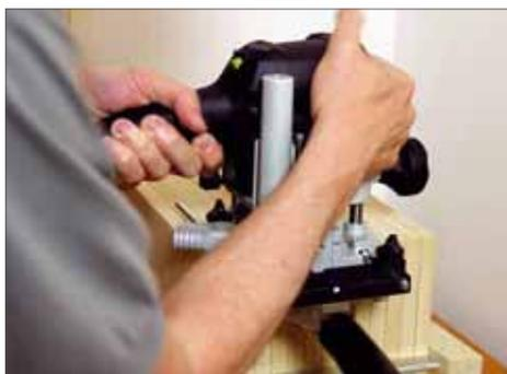
**2** Damit die Anschlüsse zwischen Böden und Wangen gut aussehen, haben wir die Ecken der Böden abgerundet. Dazu haben wir die Böden mit einer Zwinde zusammengespannt und sind die Kanten mit einem Abrundfräser mit Anlaufkugellager entlanggegangen
