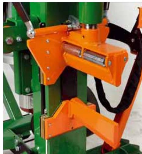
*Mit dem trennbaren Spaltkeil lässt sich der Stammabschnitt sicher fixieren. Die Rollen am Spaltkeil verhindern effektiv das Klemmen des Spaltguts am Spaltkeil*
