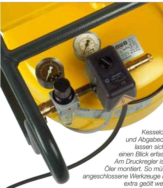
Kesseldruck und Abgabedruck lassen sich auf einen Blick erfassen. Am Druckregler ist ein Öl montiert. So müssen angeschlossene Werkzeuge nicht extra geölt werden
