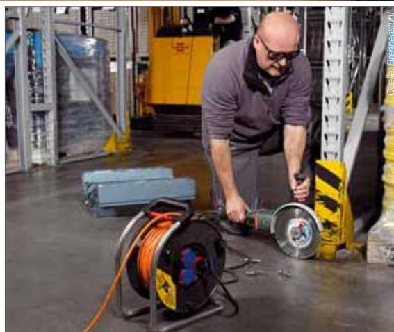
Ebenfalls von Brennenstuhl ist diese Kabeltrommel. Gerade bei der Benutzung leistungsstarker Maschinen sollte die Trommel immer ganz abgerollt werden, um die unnötige Erwärmung des Kabels zu vermeiden
