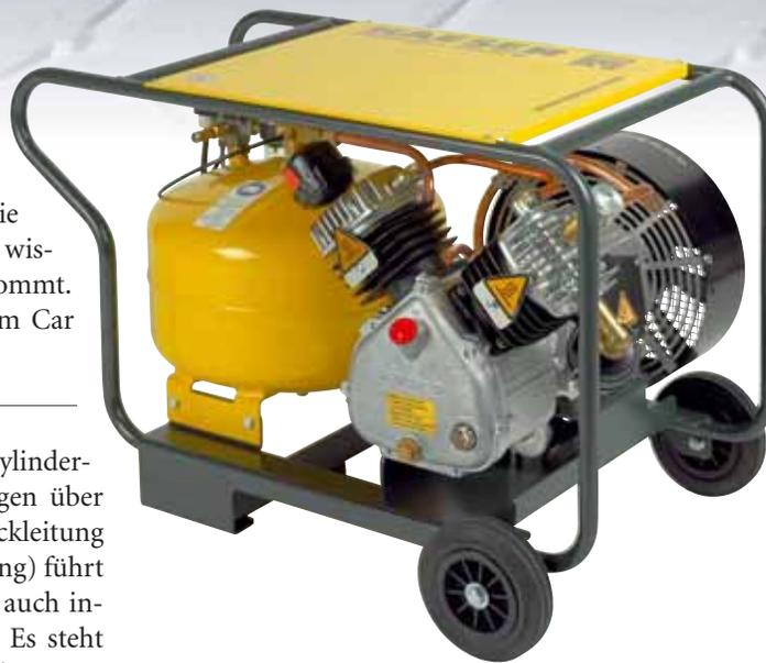
Gut geschützt und trotzdem wartungsfreundlich. Der Umlaufende Stahlrahmen und die obere Abdeckung schützen die Maschine gut gegen um- oder herabfallende Dinge
