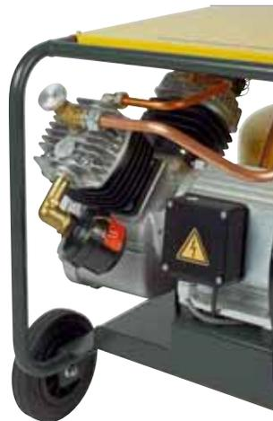
Noch mehr Kühlung: Groß dimensionierte Kupferleitungen geben die entstehende Wärme an die Umgebung ab
