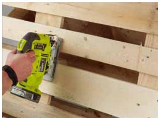
**5** Je nach Zwingenbestand werden am Schluss noch ein paar Stege herausgeschnitten. Vergessen Sie die Idee, mit dem Nageleisen komplette Bretter herauszunehmen. Paletten sind mit speziellen Nägeln vernagelt, die sich kaum zerstörungsfrei herausziehen lassen. Da die Paletten-Oberflächen sehr rau sind, empfiehlt es sich, den Wagen vor dem Einsatz zu schleifen.
