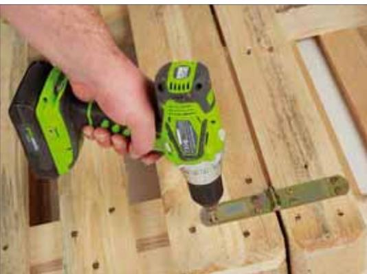
**1** Zuerst werden die drei Paletten mit den Scharnieren verbunden. Die beiden Paletten, die später die Zwingen tragen, werden dafür rechts und links der „Bodenpalette“ mit der Oberseite nach unten gelegt.
