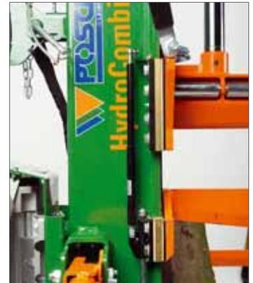
Damit die untere Spaltkeilhälfte nicht einfach herunterfällt, wird sie von einem Hydraulikdämpfer geführt
