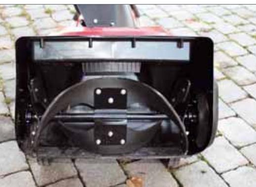
Die Gummischaufeln hinterlassen auch auf empfindlichem Pflaster keine Spuren
