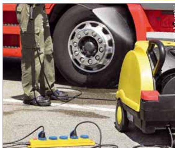
Gerade beim Betrieb von Geräten an Mehrfachsteckern sollte immer die maximale Leistungsfähigkeit der Leiste bedacht werden
