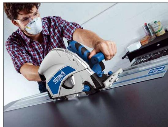
Beim Zuschnitt von Arbeitsplatten und/oder Regalböden kann eine gute Handkreissäge mit Führungsschiene eine stationäre Tischkreissäge ersetzen
