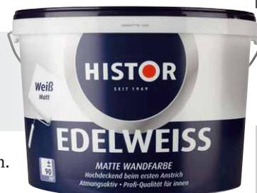
**Ausstattung** Edelweiss hat die Deckkraftklasse 1. Beim Nassabrieb werden die Anforderungen der Klasse 2 erfüllt. Die Reichweite ist mit angegebenen 90 m<sup>2</sup> die größte im Testfeld. Zwischen zwei Anstrichen sollte die Farbe 4 Stunden trocknen.
