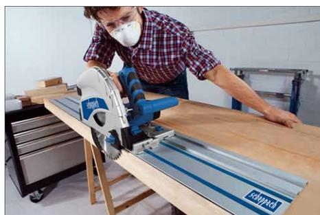
Gerade bei langen Schnitten mit Führungsschiene sind Handkreissägen in ihrem Element
