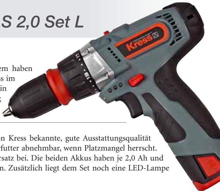
Der Kress macht sich klein, wenn es eng wird, lässt sich das Bohrfutter abnehmen. Auch beim häufigen Wechsel zwischen Bohren und Schrauben ist das hilfreich, denn ein Bit kann auch bei aufgesetztem Bohrfutter in der Spindel bleiben
