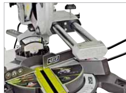
Um die Maschine möglichst klein zu halten, wurde die Doppelholmführung seitlich am Maschinenkopf platziert
