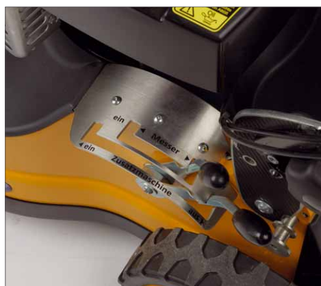
Über den seitlichen Schalthebel wird das Mähmesser ab- und der Nebenantrieb zugeschaltet
