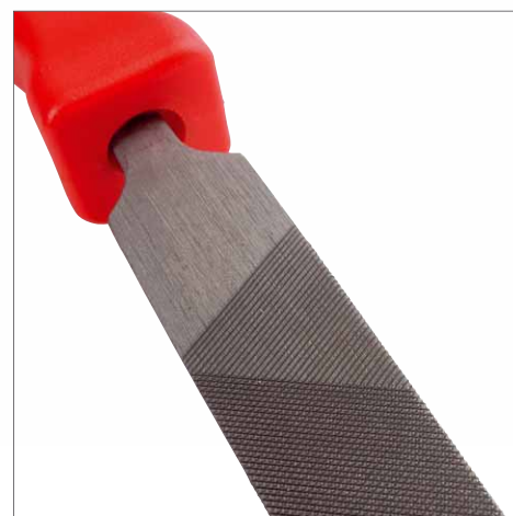
Am oberen Ende der 200 mm langen Arbeitsfläche kann man gut die beiden über Kreuz geschlagenen Hiebe erkennen
