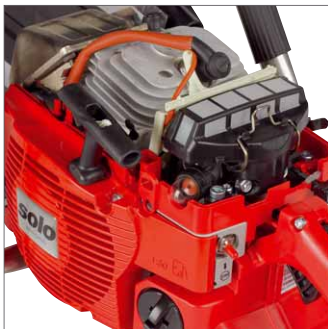
Auch bei der Solo sind Luftfilter und Kerze optimal erreichbar. Im Vordergrund ist noch das Dekompressionsventil im Zylinderkopf sichtbar
