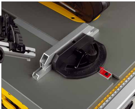
Der Queranschlag ist etwas klein ausgefallen, außerdem fehlt eine Arretierung für den Nullwert und die gängigsten Winkel
