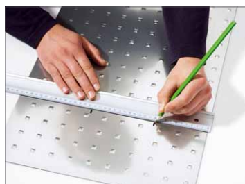
4 ... auf der Dekorplatte angezeichnet und ausgeschnitten
