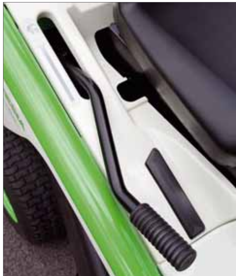
Der Fangkorb wird mit Hand durch den Hebel entleert
