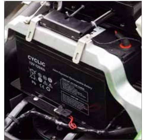
Um an die Batterien zu kommen, wird einfach die Abdeckung im Fußraum entfernt
