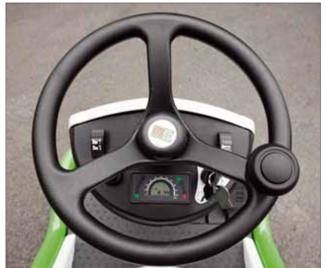
Zur Instrumententafel gehören: Zündschloss, Multifunktionsanzeige, Tempomat, Mähwerkaktivierung und Hupe
