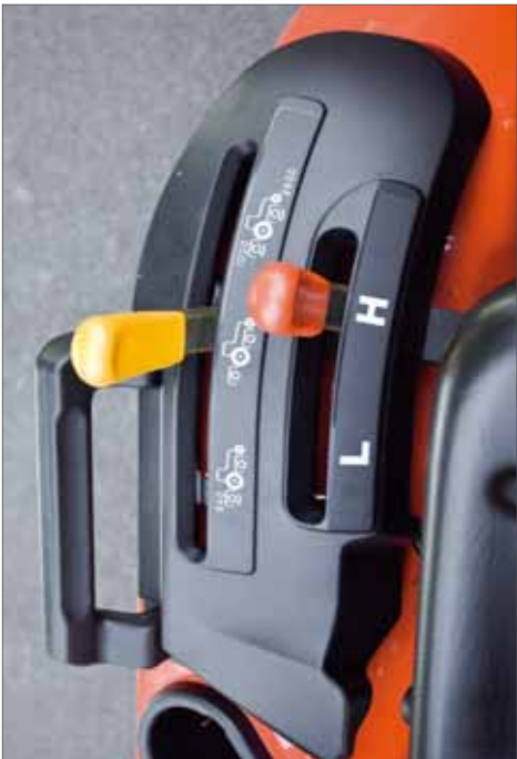
Die Zapfwelle kann mit zwei Geschwindigkeiten betrieben werden, einmal mit 540 und mit 1000 Umdrehungen pro Minute
