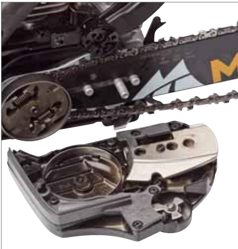
Bei der McCulloch sitzt die Fliehkraftkupplung außen. Dadurch wird die Montage von Schwert und Kette etwas frickelig. Die McCulloch ist die einzige Säge im Testfeld, bei der die Abdeckung werkzeuglos geöffnet werden kann
