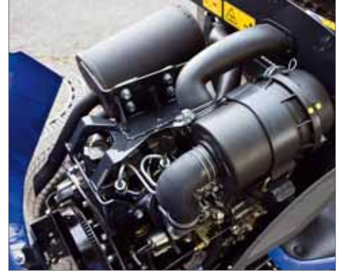
Der 4-Takt-Dieselmotor leistet 11 kW, das entspricht ca. 15 PS
