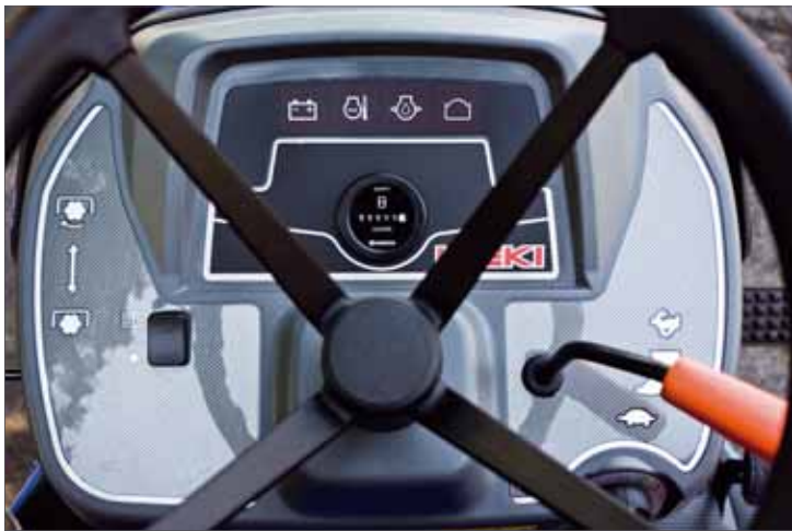
Auf der Instrumententafel sind alle Anzeigen auch bei starker Sonneneinstrahlung gut zu erkennen
