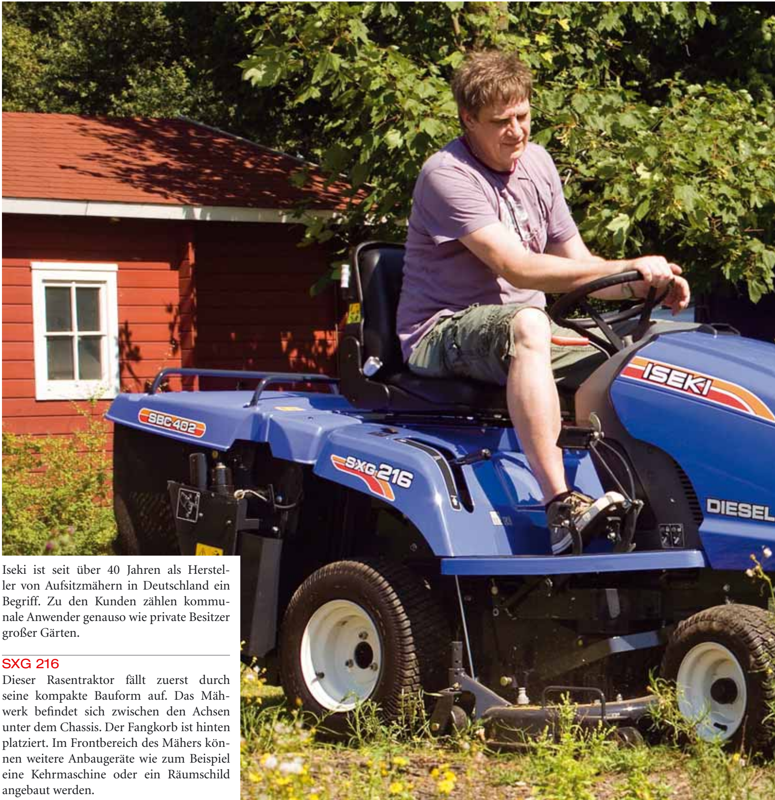
Der 4-Takt-Dieselmotor leistet 11 kW, das entspricht ca. 15 PS
