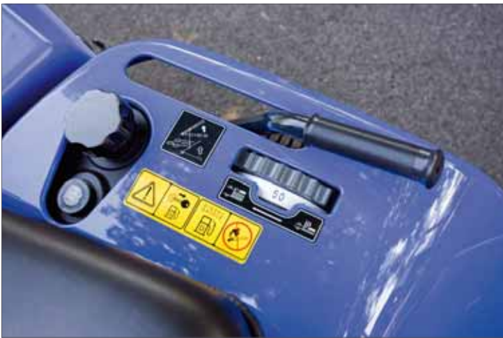
Mit sieben Stufen kann die Schnitthöhe zwischen 30 und 120 Millimetern eingestellt werden
