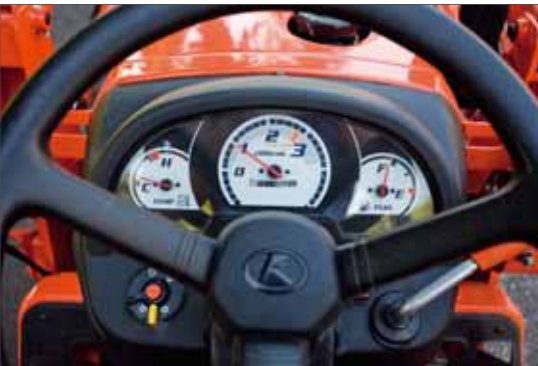
Selbsterklärend ist die Instrumententafel des Traktors. Wie viele Arbeitsmaschinen verfügt auch er über einen zusätzlichen Handgashebel
