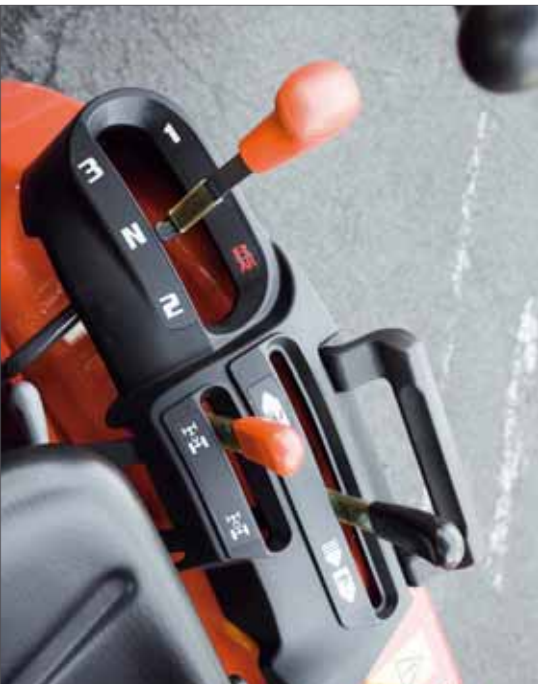
Nicht gerade eine H-Schaltung, doch sehr einfach zu handhaben. Jeder Gang kann noch einmal unteretzt werden. So kommt der Traktor auf sechs Vorwärts- und zwei Rückwärtsgänge
