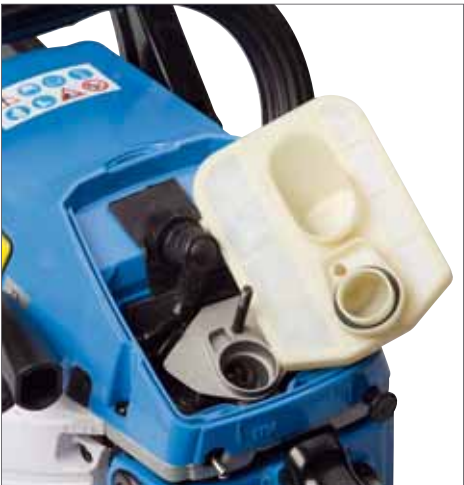
Der Luftfilter von Motorsägen sollte regelmäßig gereinigt werden. Der der Güde ist groß und leicht zugänglich
