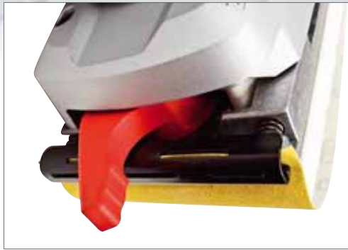
Das neuartige Papierspannsystem sorgt auch bei Papier ohne Klettverbindung für den perfekten Sitz des Schleifpapiers
