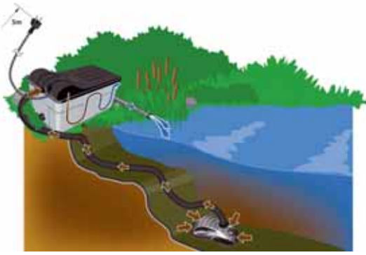
Die Systemzeichnung veranschaulicht das einfache Funktionsprinzip des Durchlauffilters mit der Teichpumpe
