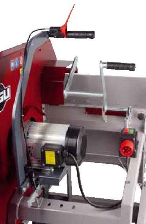
Die Motorwippe wird durch eine Sperrklinke gesichert. Der rote Zusatzgriff am Handhebel löst die Klinke über einen Bowdenzug
