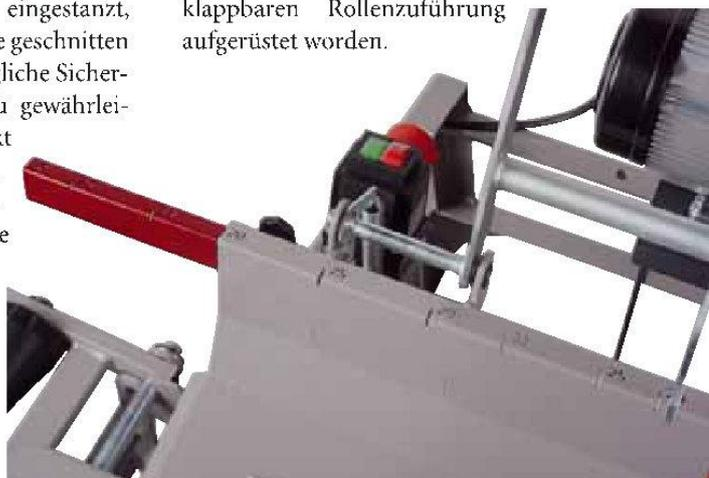
Die komplette Säge ist sauber verarbeitet. Die verarbeiteten Stahlbleche sind ordentlich entgratet und lackiert. Der Hebelarm der Motorwippe findet in zwei großen gekapselten Lagern Aufnahme. Für lange Lebensdauer verfügen diese Lager über Schmiernippel.
