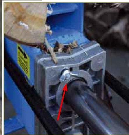
*Kleines, aber wichtiges Detail. Vor der Arbeit ist die Entlüfterschraube des Zylinders ein bis zwei Umdrehungen zu öffnen, damit der Zylinder wieder in seine Ausgangsposition zurückgleiten kann*
