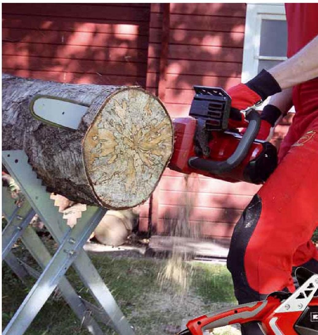
Die neue Ausrichtung des Motors spart ein Umlenkgetriebe und soll der Säge zu stärkerem Durchzug verhelfen.
