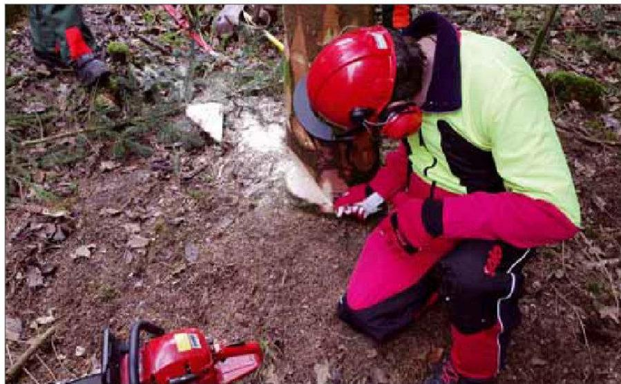
Kopfarbeit: Fällkerb, Bruchleiste und Fällschnitt müssen genau berechnet und angezeichnet werden
