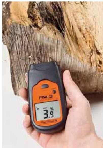
Laut Hersteller misst das Gerät mit einer Toleranz von +/- 1 % in einem Messbereich zwischen 3 und 40 % Restfeuchte. Die Messung erfolgt über 4 Messspitzen, die in das zu prüfende Holz gestochen werden. Über die Hold-Taste kann der Messwert fixiert werden, so dass auch hinten im Holzlager gemessen werden kann.
