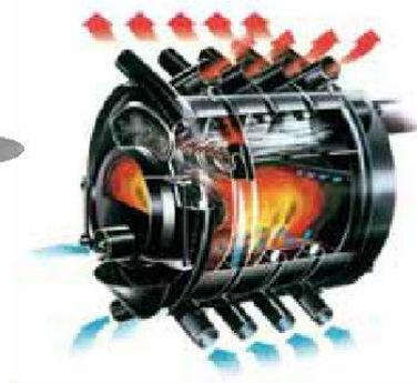
*Kalte Luft strömt unten in die Rohre, wird beim umströmen der Brennkammer erwärmt und tritt oben wieder aus. So erwärmt der Ofen schnell die Raumluft (Energetec)*
