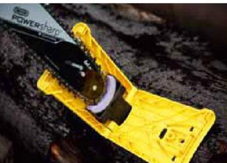
Im Schärfergerät wird die laufende Kette gegen den Schärffstein gedrückt
