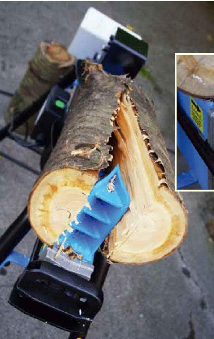
aufzubauen. Dabei kommt er mit einem 230-V-Anschluss aus. Das Spaltgut darf bis zu 25 cm dick und maximal 52 cm lang sein. Für einfachen Transport verfügt der Spalter über ein Fahrgestell.
