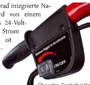
Über den Gashebel lässt sich die Fahrgeschwindigkeit stufenlos von 0 – 3,5 km/h regeln
