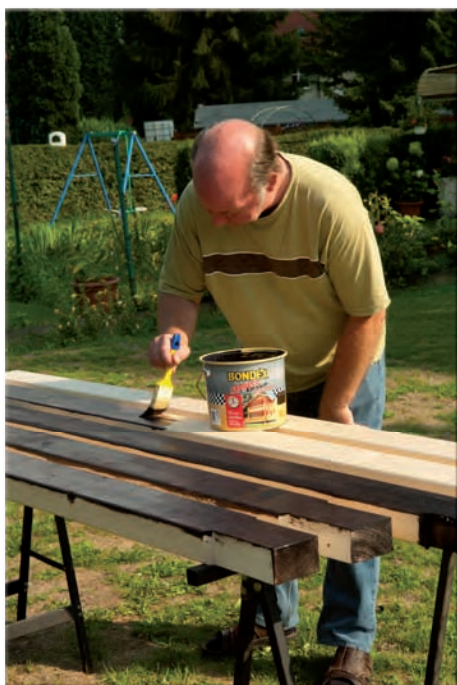
Da wir preiswertes Fichte-/Tannenholz für den Aufbau des Regals gewählt haben, ist ein guter Wetterschutz sehr wichtig. Wir wählten die Expresslasur von Bondex in Palisander
