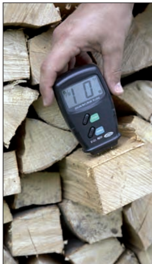
Bevor das Holz „reif“ für den Kamin ist, sollte die Restfeuchte unter 20 % liegen
