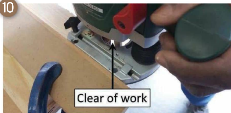
Trimming an edge
