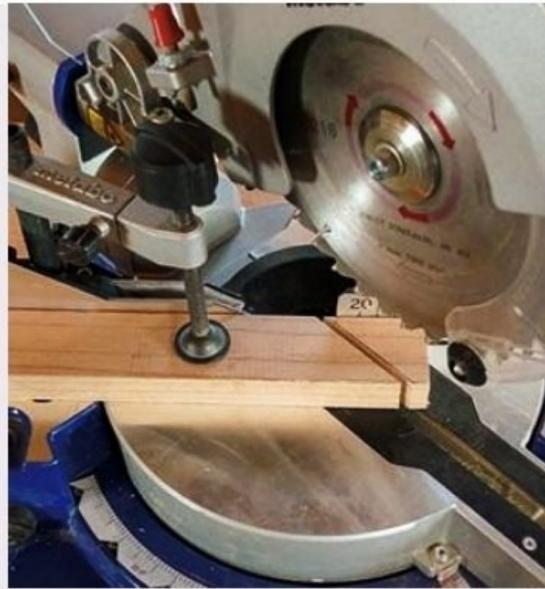
**2** Coupez les extrémités des tasseaux à 45° à l'aide d'une scie à onglet. Veillez à ce que la rainure soit toujours placée contre la table de la machine.
