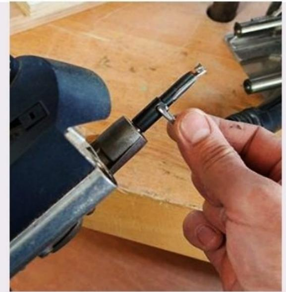
**3** Montez une fraise de 6 mm sur la fraiseuse domino. Réglez la profondeur à 20 mm, puis remettez en place le guide frontal de la fraiseuse.
