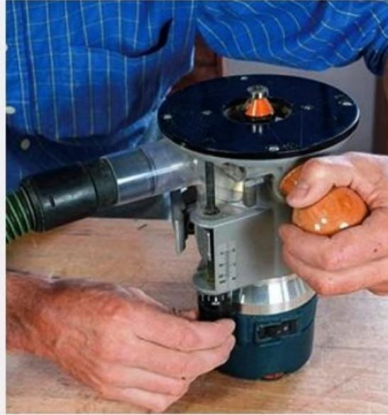
**7** Montez une fraise pilote à chanfreiner à 30° sur une défonceuse. Vous pouvez opter pour une moulure ou un quart-de-rond.
