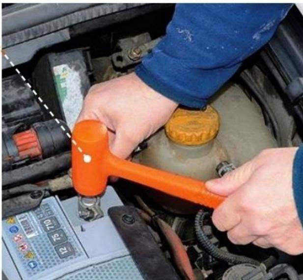
**Le maillet** possède une tête cylindrique en matière tendre (bois, plastique ou caoutchouc), avec deux tables symétriques. Il est utile pour frapper des matières plus dures sans risque de les abîmer. Il s'utilise pour placer le carrelage, ajuster les assemblages en menuiserie... Son utilisation est fréquente dans de nombreuses activités de bricolage.
