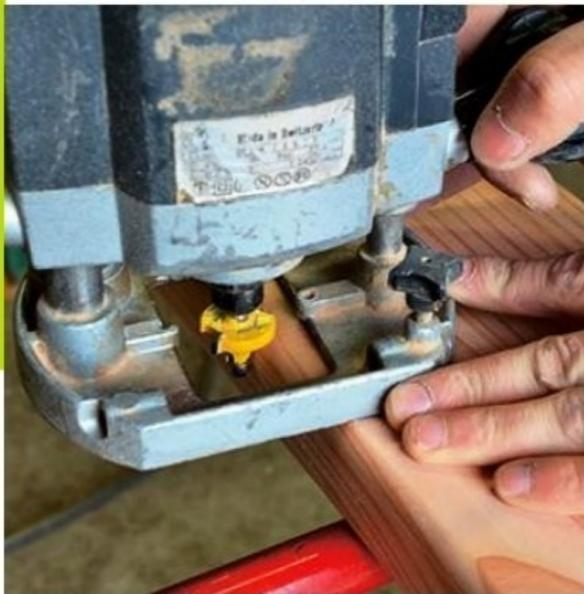
**5/** Cassez les arêtes (côté utilisateur) à l'aide d'une défonceuse équipée d'une fraise à arrondir. Répétez cette opération sur les trois planches (dont celle du dossier).
