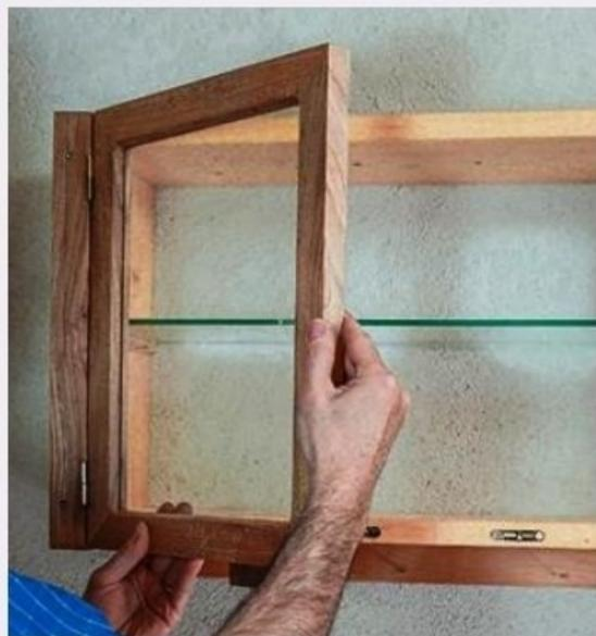
**20** Mettez en place les portes sur les paumelles. Vérifiez l'ouverture et la fermeture des portes. Déposez les portes pour appliquer un produit de protection sur les caissons.
