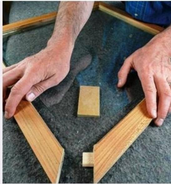
**16** Faites découper à dimension des vitres claires de 4 mm. Démontez les cadres, puis remontez-les autour des vitres posées sur cales.
