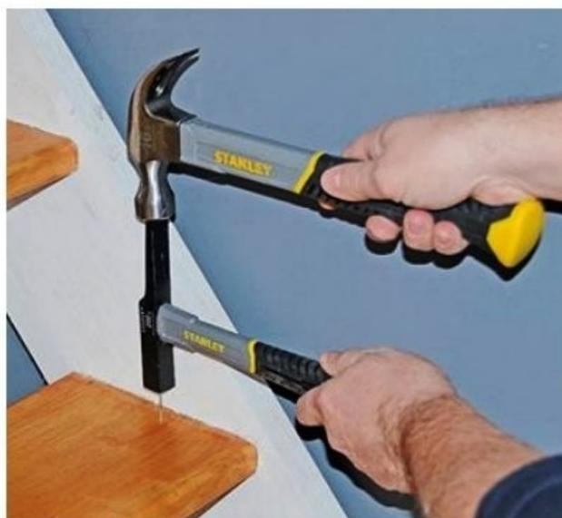
**Utilisez deux marteaux l'un sur l'autre** dans les endroits peu accessibles pour éviter d'abîmer les surfaces proches du point d'impact : le second transmet au clou le choc du premier.
