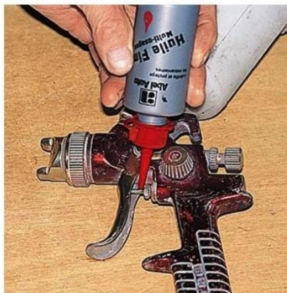
**6/** Déposez quelques gouttes d'huile de vaseline à l'aide d'une burette au niveau de l'axe de la gâchette et de l'aiguille. Leur mouvement doit être souple pour ne pas fatiguer la main.
