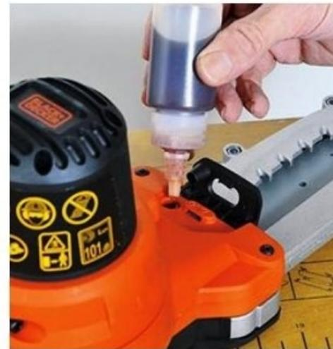
Un réservoir à lubrifiant permet le graissage automatique de la chaîne. Il se remplit via un petit orifice situé sur le côté gauche de la machine.
