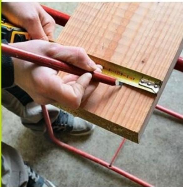
**3/** Dans deux planches (L 110 x ép. 5 cm), tracez sur la largeur un trait de coupe à 15 cm (assise). Répétez l'opération pour le dossier à 30 cm. Délignez les planches à la scie circulaire.
