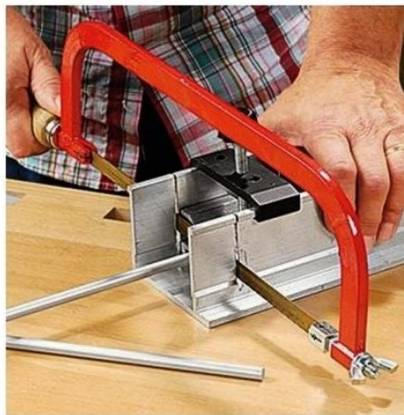
**6/** Coupez trois sections de tube en aluminium d'une longueur de 42 cm. Pour faciliter la mise en œuvre, ébavurez les extrémités de tube avec de la toile émeri grain 80.
