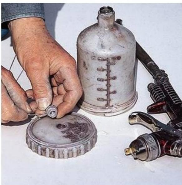
**5/** Le couvercle du godet comporte un bouchon muni de deux petits trous (prise d'air). Ils ne doivent jamais être obstrués. Si c'est le cas, débouchez-les avec un fil de fer.
