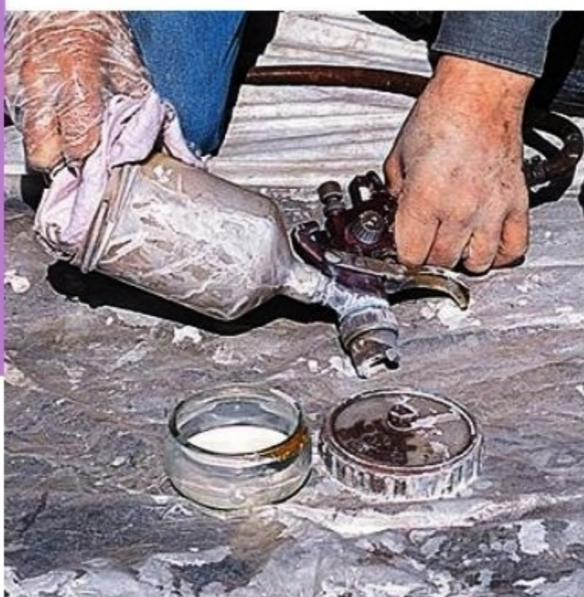
**3/** Aussitôt après usage, nettoyez la surface du godet avec un chiffon imbibé de diluant. Récurvez soigneusement l'intérieur du couvercle, en insistant sur la partie qui se visse.
