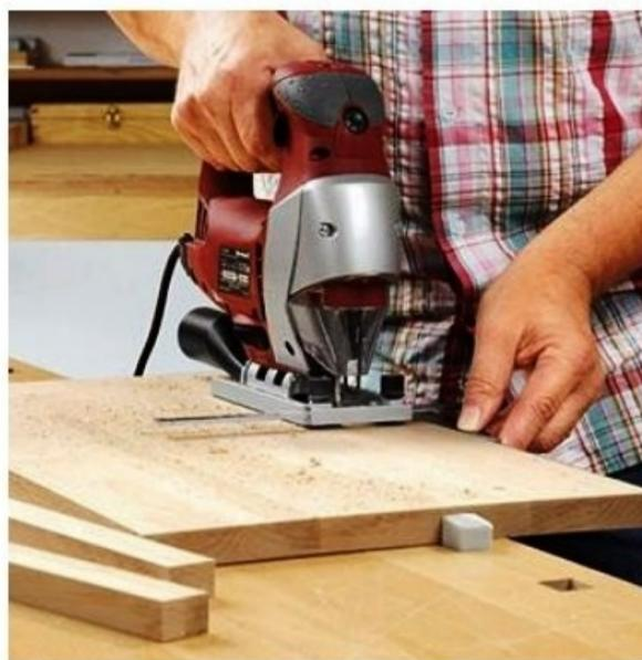
**1/** Découpez des tasseaux de 50 mm de large dans une chute. Utilisez une scie sauteuse pour réaliser les montants. Maintenez fermement la planche sur un établi.
