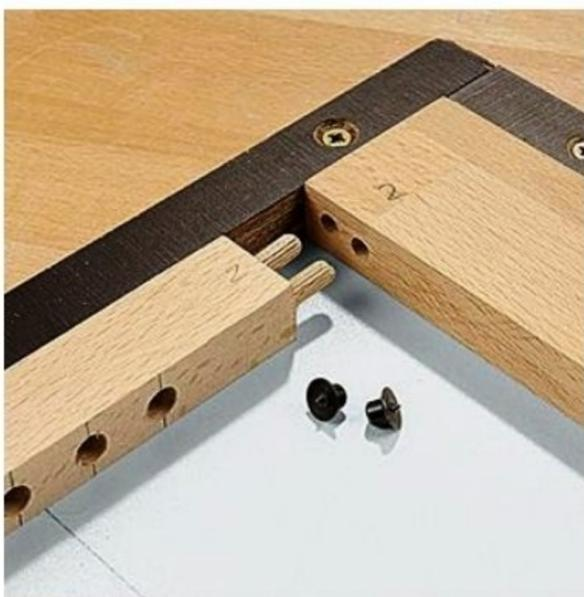
**7/** Placez des centreurs dans les trous des traverses et appliquez-les sur les chants des montants. Percez les montants puis insérez les tourillons avec un filet de colle à bois.
