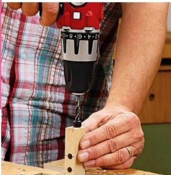
**5/** Pour percer l'emplacement des tourillons dans l'axe des traverses, utilisez une perceuse avec une mèche Ø 6 mm et une bague de butée. Tenez fermement la pièce lors du perçage.
