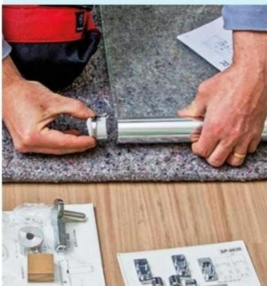
**7** En bas du montant de la porte, placez le pivot permettant la rotation de la porte sur son axe. Attention au sens d'ouverture.
