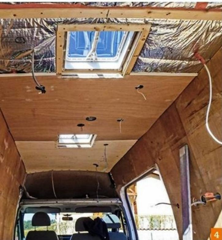
4. Au plafond, l'isolant tient grâce à des liteaux vissés à la structure du fourgon. Ils permettent de récupérer la différence de niveau créée par la mise en place des lanternes. Les panneaux sont en contreplaqué de 5 mm d'épaisseur. 5. En quelques jours, l'espace est totalement métamorphosé. Le sol est en PVC à haute résistance au passage et aux chocs. 6. Place à l'agencement. Si quelques éléments sont achetés sur un site
