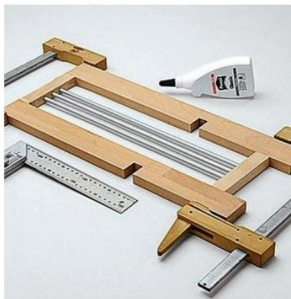
**8/** Assemblez chaque module, mais attention au sens des entailles qui doivent être en opposition. Serrez l'ensemble à l'aide de serre-joints. Puis assemblez les modules entre eux.
