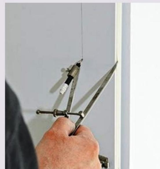
**17** Tracez les axes d'alignement des taquets d'étagère (deux par niveau): soit au trusquin, soit avec un compas, en partant du chant avant des côtés.
