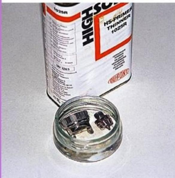
**1/** Pour démonter la tête de pulvérisation, retirez le chapeau en dévissant la bague, puis ôtez la buse avec une clé spéciale. Faites tremper plusieurs heures dans le diluant.
