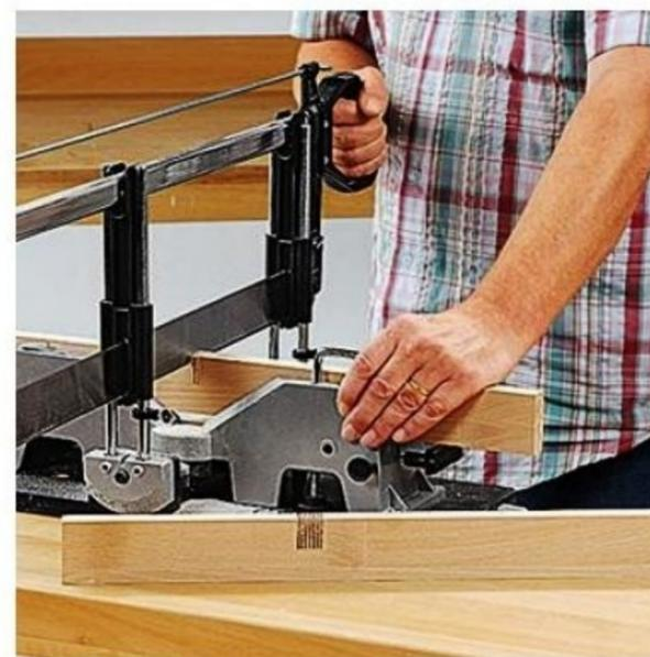
**2/** Réalisez les entailles dans les montants en utilisant une scie à onglet sur support métal. Réglez la butée de coupe à 25 mm et pratiquez des coupes en peigne tous les 3 mm.
