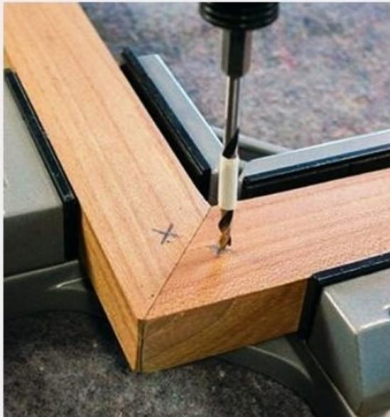
**9** Percez ( $\varnothing$  3 mm) la face arrière des cadres dans l'axe des dominos. Pour ne pas déboucher en façade, repérez la profondeur de perçage en entourant le foret d'un adhésif.
