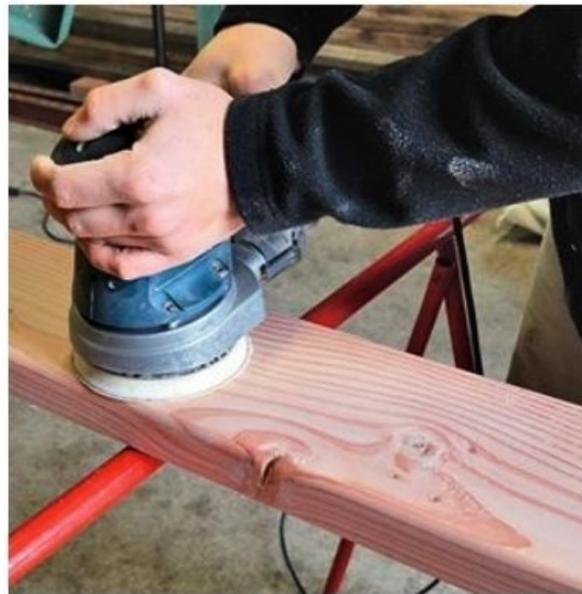
**6/** Poncez intégralement les planches à l'aide d'une ponceuse excentrique ou vibrante (grain moyen à fin). Travaillez toujours dans le sens des fibres de bois.
