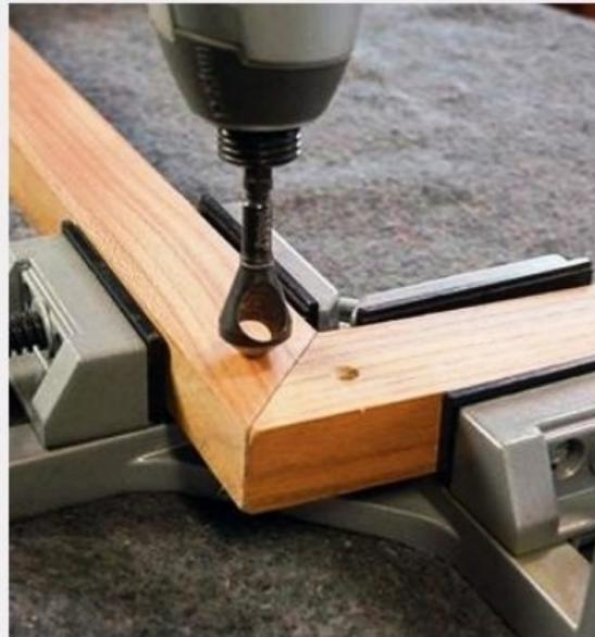
**10** Fraisez les perçages de façon à ce que les têtes de vis affleurent, puis vissez à travers les dominos (vis à bois de 4 x 20 mm).
