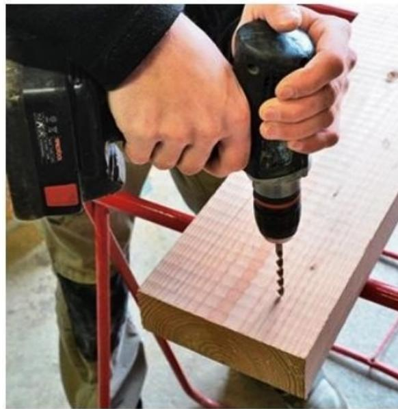
**4/** Sur les deux planches de l'assise, percez à 5 cm du bord et à 6 cm de l'extrémité. Percez également le dossier à 15 cm du bord et 6 cm de l'extrémité.
