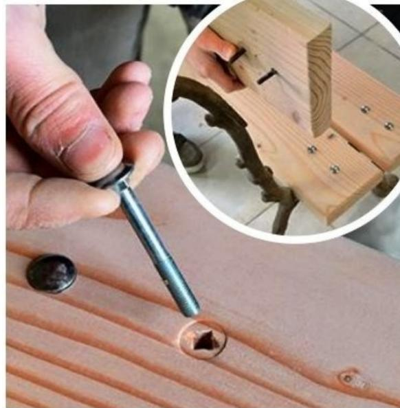
**8/** Insérez dans les perçages des boulons en acier zingué à collet carré (TRCC) Ø 6 x 60 mm. Positionnez les planches sur le piétement. Vissez les écrous, également en acier zingué.
