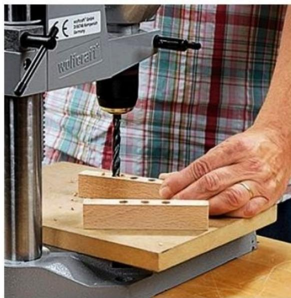
**4/** Percez les traverses haute et basse pour l'emplacement des tubes de métal. Utilisez une mèche à bois Ø 8 mm et réglez la butée pour une profondeur de 5 mm (perçages non débouchants).
