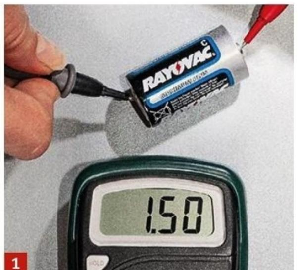
1 Placez le sélecteur en mode V---, la pointe noire sur le pôle - et la pointe rouge sur le pôle +. La tension (en V) affichée doit être supérieure ou égale à celle de la pile.
