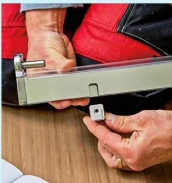
**4** Insérez les pièces ainsi assemblées dans les logements prévus du montant. Des détrompeurs facilitent leur mise en place.
