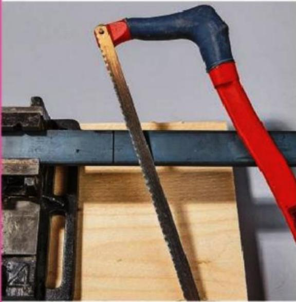
**3/** Serrez la barre en métal dans un étau d'établi. Coupez deux longueurs de 50 cm à la scie à métaux ou utilisez une meuleuse d'angle équipée d'un disque à tronçonner.
