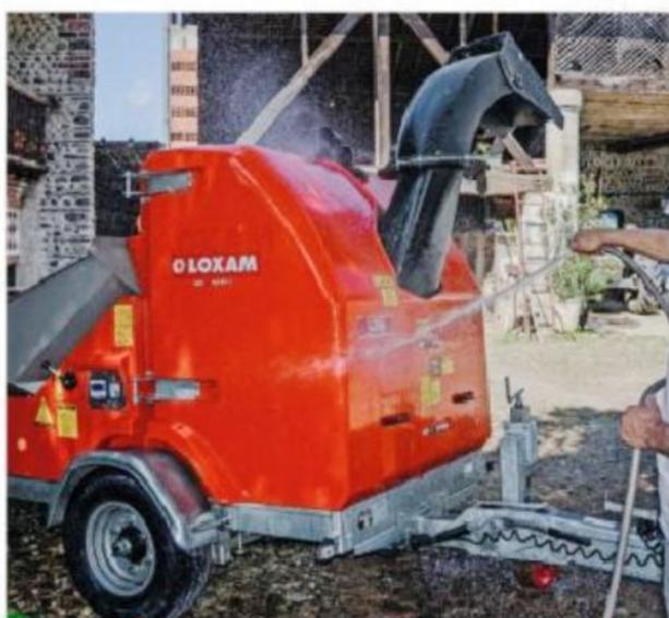
**Le nettoyage de la machine** peut s'effectuer au jet d'eau ou au nettoyeur haute pression. Évitez de laver le moteur pour ne pas détériorer les éléments électriques, électroniques et les durites.
