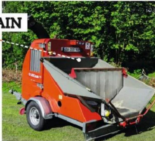
**Une molette placée sous la trémie** permet de régler la vitesse d'avancement, en fonction du diamètre des branches à broyer. Plus l'élément est gros, plus le tapis doit avancer lentement afin que le rotor de broyage travaille efficacement. En général, le réglage d'usine est adapté à toutes les situations.
