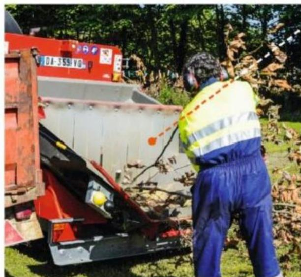
**L'éjection des déchets** peut s'effectuer vers une benne de remorque. Commencez par remplir l'avant de la benne, puis déplacez-la au fur et à mesure du remplissage. Attention de ne pas introduire de corps étrangers, métal, pierre, pour ne pas endommager la machine et éviter tout risque de projection dangereuse.
