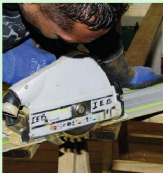
**13** La lame étant trop large pour utiliser une boîte à onglet, tracez votre découpe, puis réalisez-la à l'aide d'une scie plongeante sur rail de guidage.
