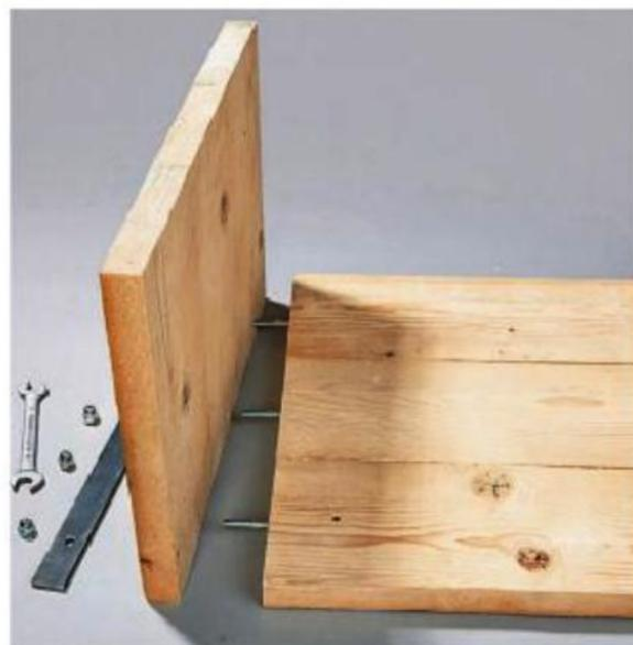
**8/** Laissez dépasser les vis à double filet de 4,5 cm. Assemblez les éléments (le pied et la barre de métal), puis serrez les écrous tête ronde.
