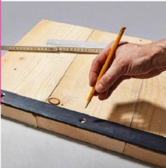
**5/** Fraisez les trous, limez les extrémités du métal et dégraissez les deux barres avec du dégraissant à métaux. Placez les barres sur les pieds de table et repérez les perçages.
