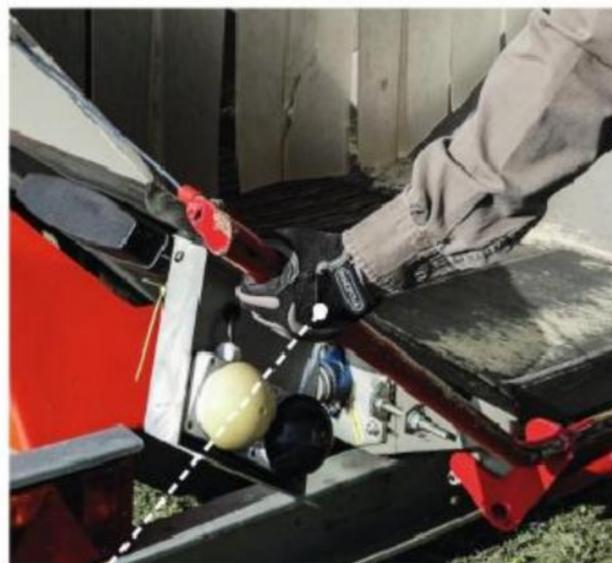
**Avant de couper le contact**, repoussez le guidon pour stopper l'avancement de l'ensemble tapis/rouleau. Laissez tourner le moteur et le rotor environ 30 secondes pour faire partir un maximum de broyat, afin de ne pas avoir une mauvaise surprise au prochain démarrage. Ramenez la commande d'accélérateur au ralenti avant de couper le contact.
