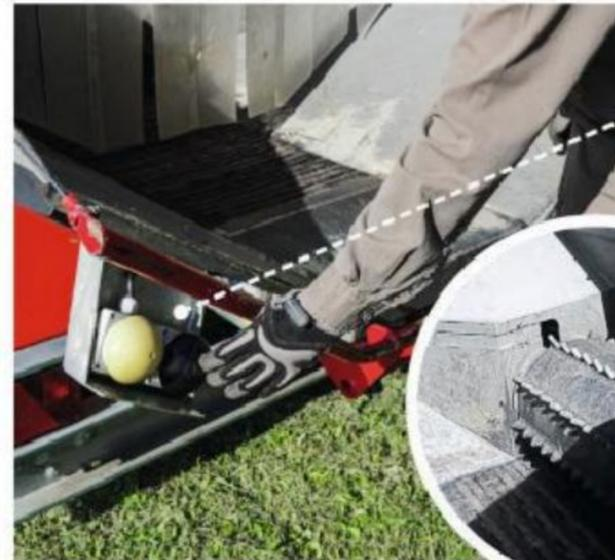
**Deux poussoirs de couleur** se trouvent à l'arrière de la trémie. Ils servent à mettre en marche le tapis et le rouleau ameneur qui entraînent les végétaux vers le rotor de broyage. En cas de blocage, le sens de rotation peut être inversé.
