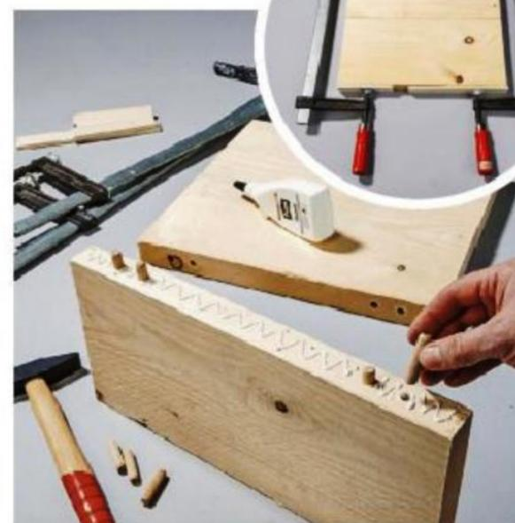
**2/** Pour l'assemblage, percez les chants et placez des tourillons 8 x 40 mm. Vérifiez l'ajustement des perçages avant de coller. Serrez l'ensemble à l'aide de serre-joints.
