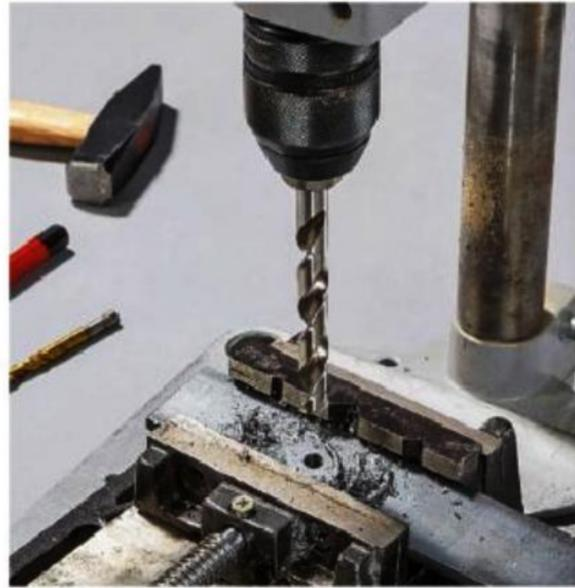
**4/** Percez trois trous  $\varnothing$  10 mm sur les barres de métal. Utilisez un pointeau pour marquer les perçages. Augmentez progressivement le diamètre des mèches (4 / 6 / 10 mm).
