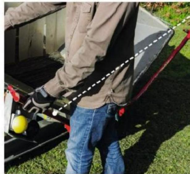
**Un guidon**, situé à l'arrière de la trémie, permet de stopper l'ensemble tapis/rouleau en cas de danger. Pour les remettre en route, il suffit de tirer le guidon vers l'arrière et d'appuyer sur le bouton jaune...
