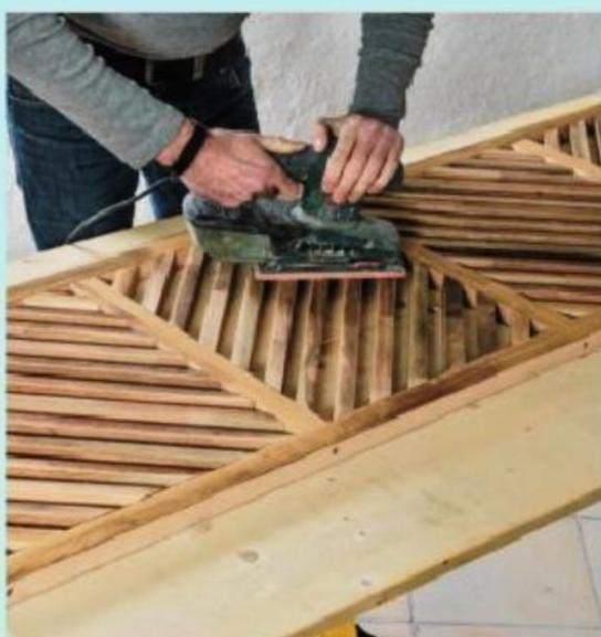
**4** Poncez (en principe toujours dans le sens du fil) et éliminez les éventuelles bavures de colle. Utilisez une ponceuse vibrante et un abrasif grain moyen à fin (n° 120 à 280).
