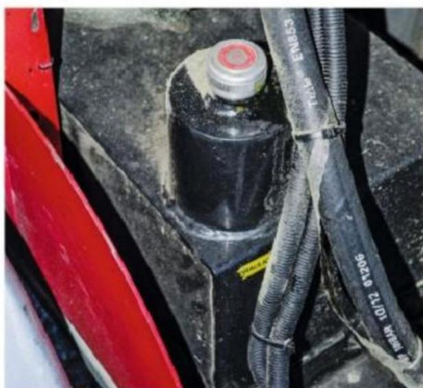
**Vérifiez le niveau d'huile moteur** avant chaque utilisation, mais aussi le niveau d'huile du système hydraulique. Le bouchon fait office de jauge. Faites l'appoint si besoin avec de l'huile spéciale système hydraulique et surtout pas avec de l'huile pour moteur.
