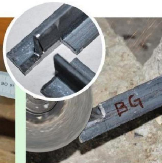
**7** À mesure du façonnage des profilés, il est préférable de les repérer, en utilisant des initiales: BG (bas à gauche), BD (bas à droite). Puis chanfreinez les découpes à la meuleuse.
