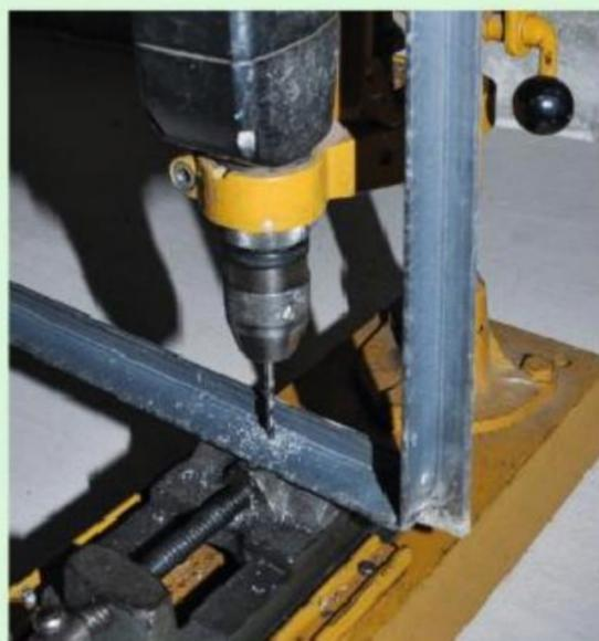
**12** Tous les 30 cm, prépercez des avant-trous Ø 5 mm nécessaires aux vis. Percez-les en série. Fraisez ensuite les avant-trous.
