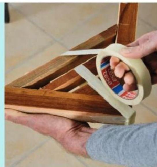
**3** Les tasseaux sont simplement collés au niveau des extrémités. Un ruban adhésif de peintre permet ici de les maintenir en place pendant le temps de séchage de la colle.
