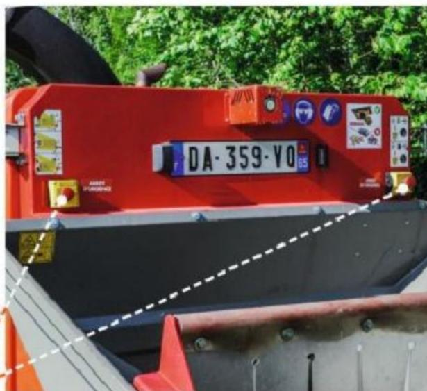
**Deux arrêts d'urgence « coup de poing »**, situés de chaque côté au-dessus de la trémie, permettent d'arrêter le moteur. Pour remettre la machine en route, il faut tirer le bouton qui a été enfoncé. Par précaution, il est en plus déconseillé d'utiliser seul cette machine... et rigoureusement interdit de mettre ses mains dans les parties mécaniques avant que le moteur ne soit à l'arrêt.
