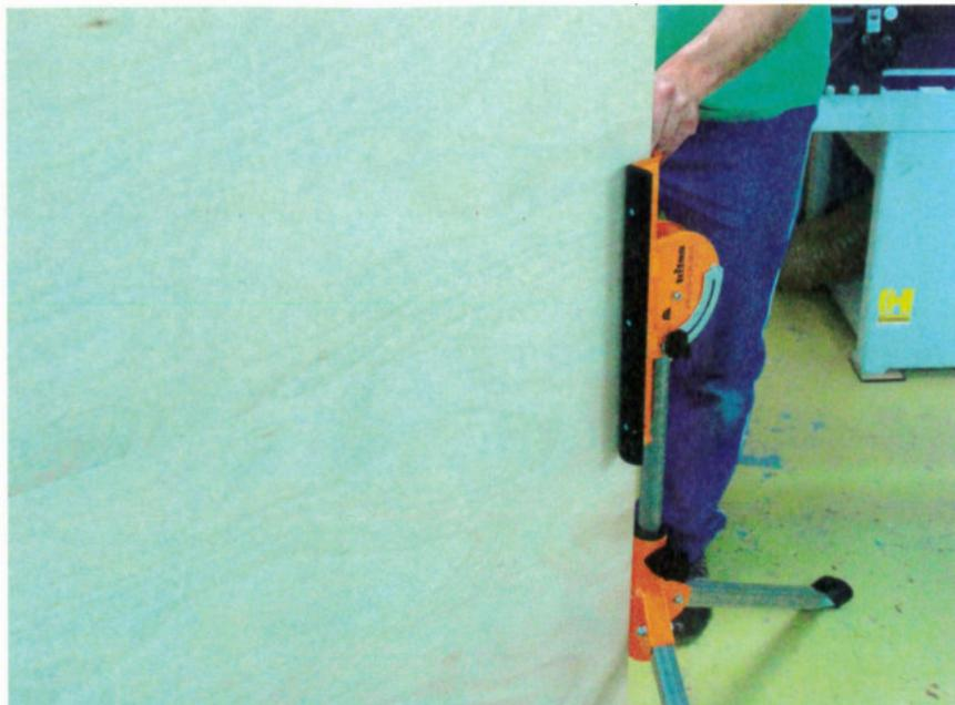
Le réglage en position verticale permet d'usiner notamment les chants de panneaux.
