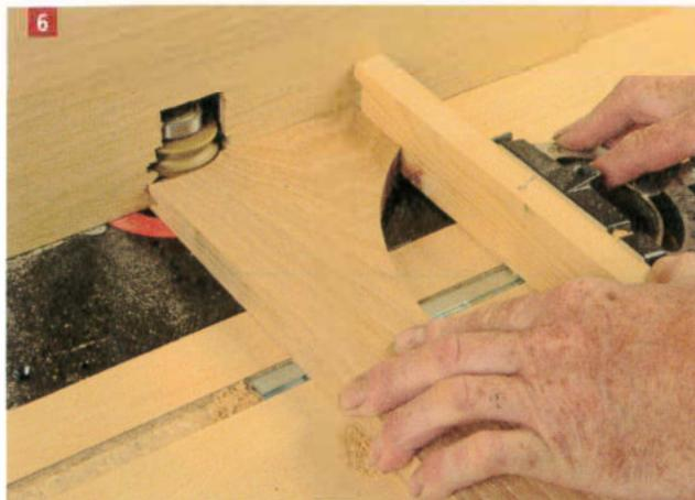
Répétez l'opération sur la traverse supérieure déjà mise en forme à l'aide du guide à coupe d'onglet qui permet de pousser la pièce proprement.
