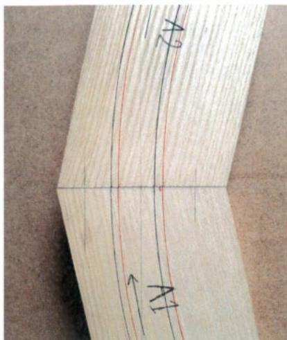
Repérage des positions des courbes de la face supérieure (lignes noires) et de la face inférieure (lignes rouges) sur la face supérieure.
