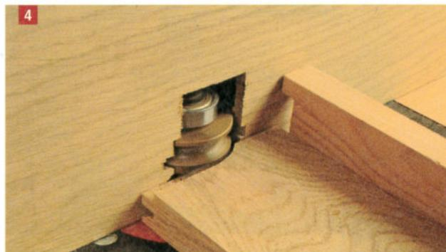
Faites une coupe de test avec une chute. Notez la présence d'une cale martyr en sortie de coupe pour éviter que le bois éclate.
