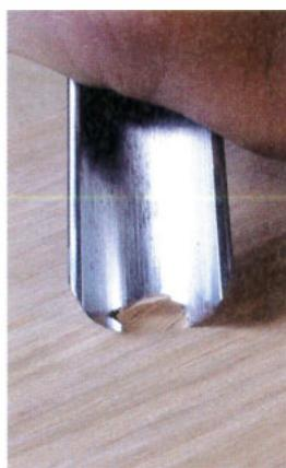
La coupe en mouvement rotatif permet d'utiliser la lame sur sa longueur. Il s'agit plus de trancher que de forcer la coupe pour obtenir un bel état de surface.
