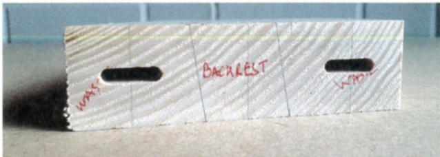
Positionnement des mortaises sur les zones à nettoyer pour la mise en forme du dossier.
