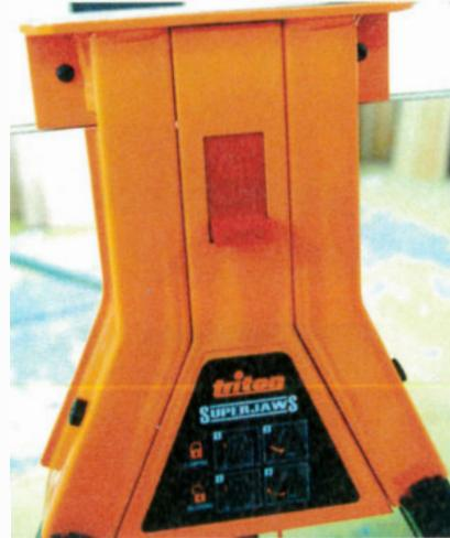
L'interrupteur de serrage permet de sécuriser le serrage ou de serrer les mâchoires.
