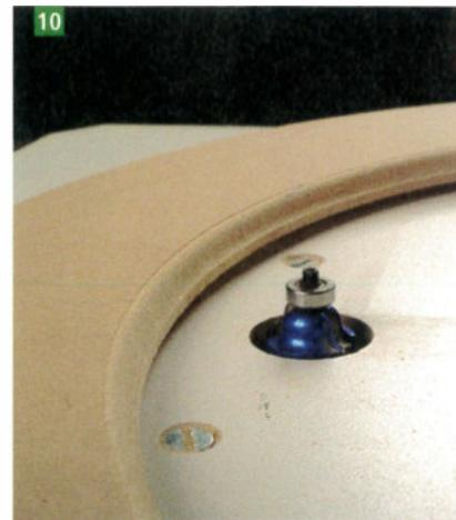
Faites bien attention au choix de la dimension de votre fraise et à la réduction de la profondeur de la rainure afin de laisser suffisamment de place pour le roulement.
