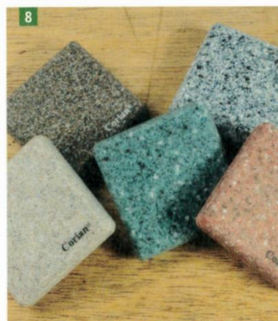
La densité du Corian™ nécessite d'utiliser des fraises adaptées pour ne pas les abîmer lors de l'usinage.
