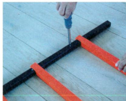
Le réglage de hauteur des tubes de portée se fait à l'aide d'une simple vis.
