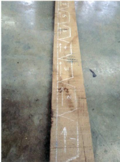
Repérage des éléments trapézoïdaux sur chaque planche pour assurer la continuité du fil sur l'arrière du dossier.
