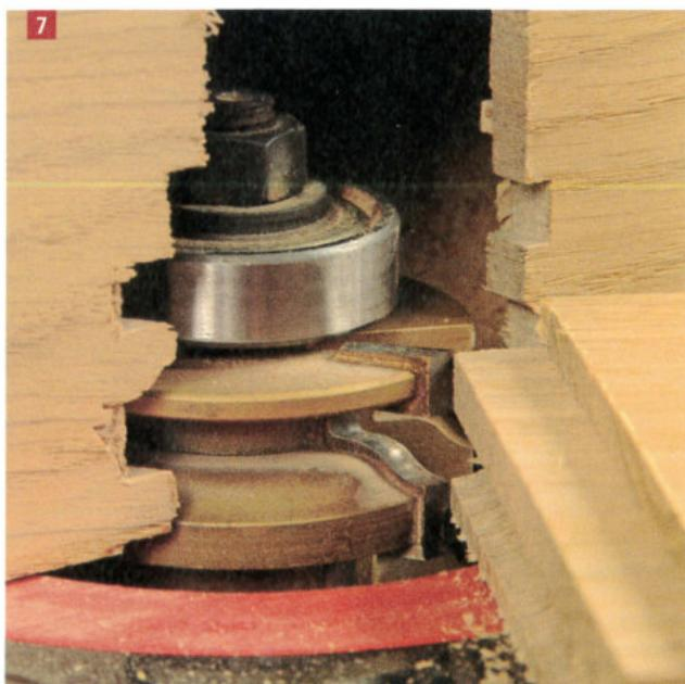
Faites la moulure décorative en alignant les éléments en miroir avec ceux de la moulure d'assemblage.
