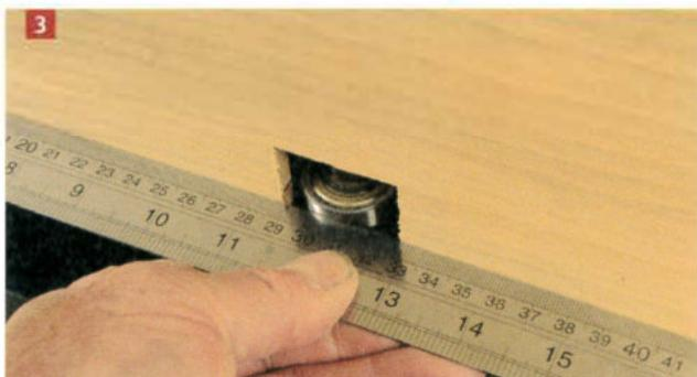
Vérifiez que le roulement de guidage est bien à niveau avec le guide martyr et reprenez votre réglage jusqu'à ce que la fraise présente l'alignement qui correspond avec votre extrémité de pièce.
