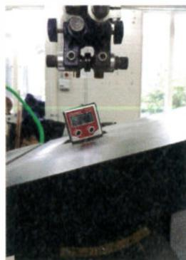
Réglage de l'inclinaison de la lame de la scie à ruban à l'aide d'un inclinomètre à lecture numérique. La première étape de la mise en forme consiste à dégrossir la courbe à la scie à ruban. Cela implique d'effectuer trois coupes selon des angles différents sur la face avant et sur la face arrière du dossier.
