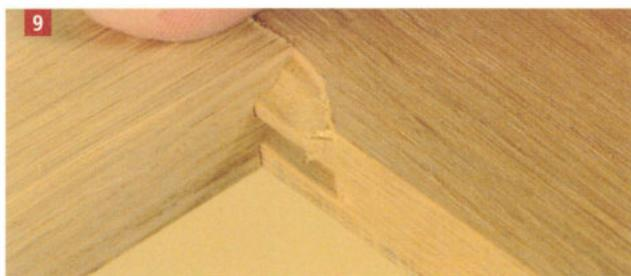
Faites une passe de test et vérifiez que l'assemblage est à fleur.
