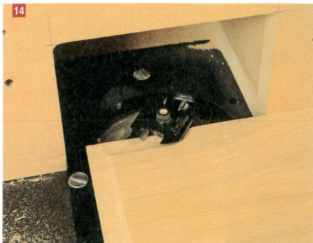
14 Usinage des bords droits du panneau central avec la face visible tournée vers la table.
