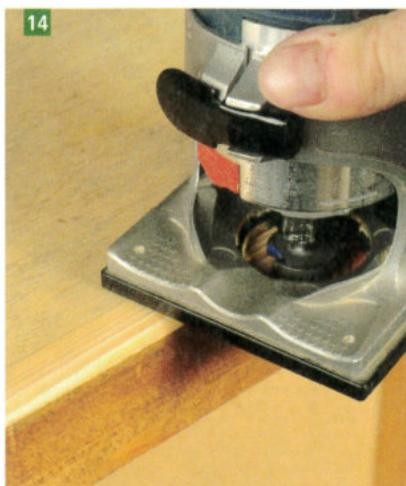
N'importe quelle défonceuse peut être utilisée, comme ici avec cette affleureuse pour un travail à une main.
