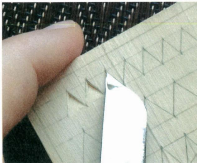
Poussez la lame vers la pointe supérieure du triangle pour dégager le copeau des pans droits.
