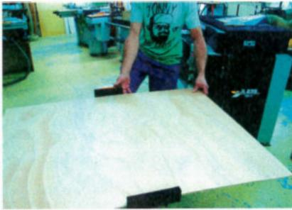
L'ouverture des mâchoires permet de serrer des matériaux jusqu'à 955 mm de large.
