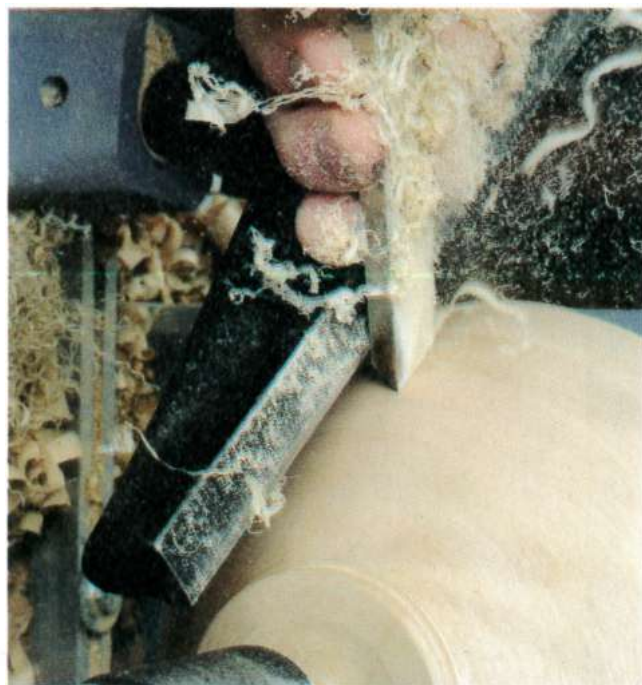
Un ciseau à racler droit travaillant un fond plat sur l'extérieur d'un bol.
