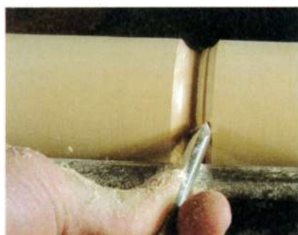
Gouge à profiler travaillant sur un chandelier.
