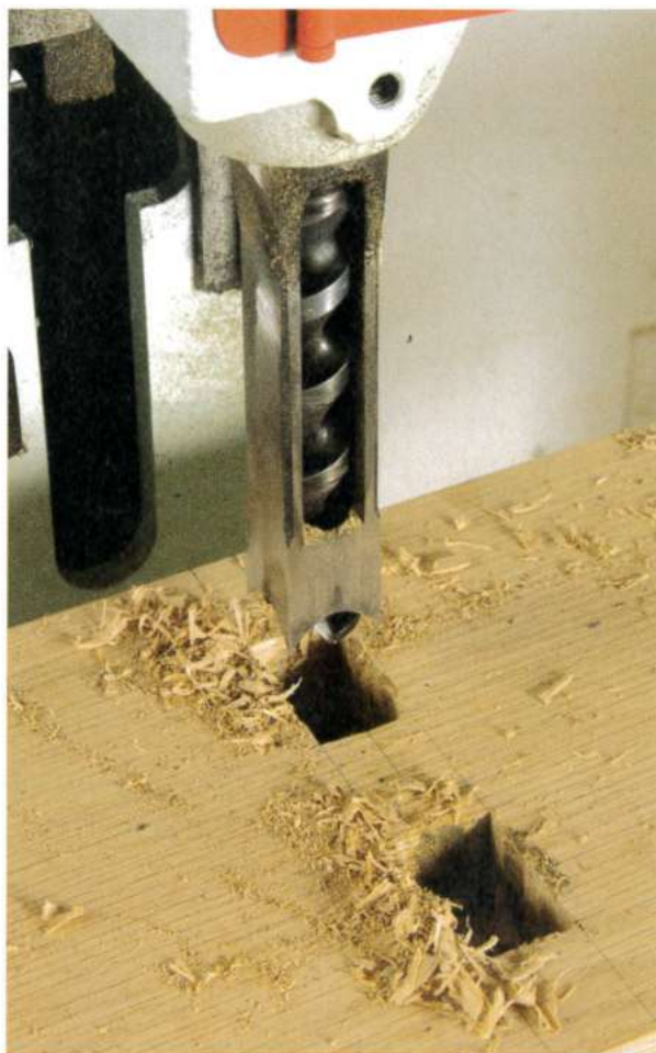
L'avantage de la mortaiseuse à bédane est de produire des trous vraiment carrés.
