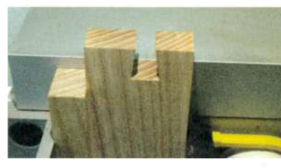
Réglage de la base du profil de la fraise par rapport à la surface de référence du WoodRat.
