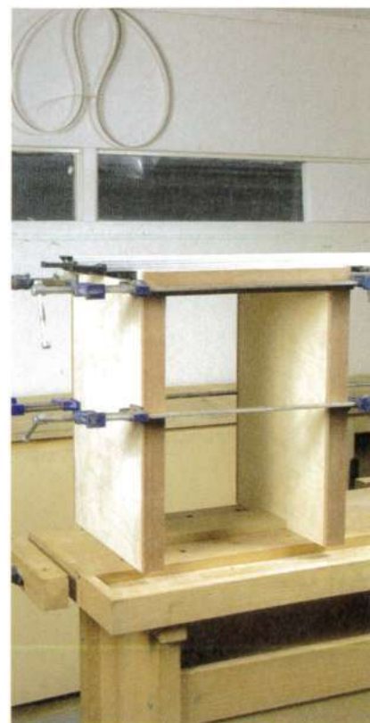
L'assemblage final demande beaucoup de serre-joints et de presses, une bonne vitesse d'exécution et beaucoup de soin.
