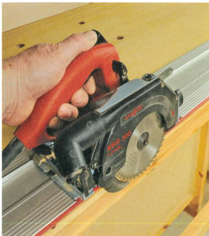
Scie à règle de guidage spécialement conçue pour cette utilisation.
