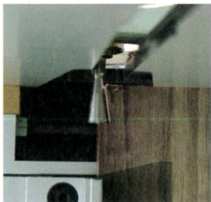
Usinage de l'épaulement de la joue.
