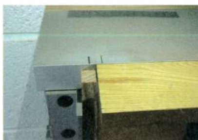
Alignement du gabarit pour la coupe des épaulements des joues.
