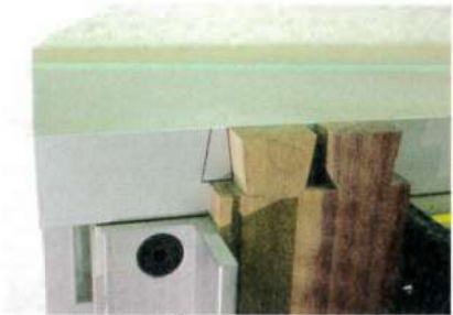
Alignement de la queue par rapport au profil de la fraise dans le poste de copiage.
