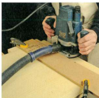
Si l'état de coupe n'est pas bon, reprenez le bord du panneau en finition à la défonceuse.
