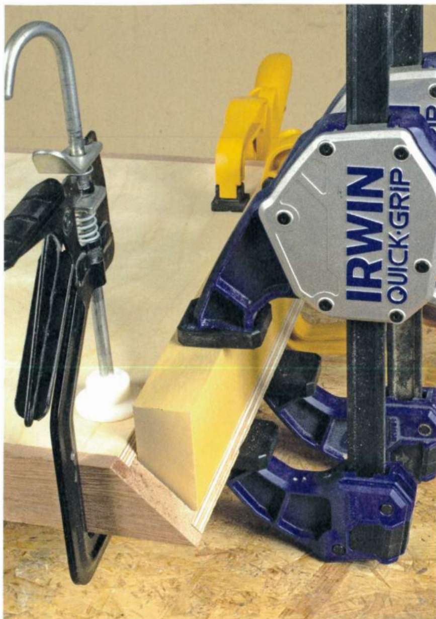
Collez d'abord une première partie de la cale d'assemblage afin de faciliter les opérations pour l'assemblage final.
