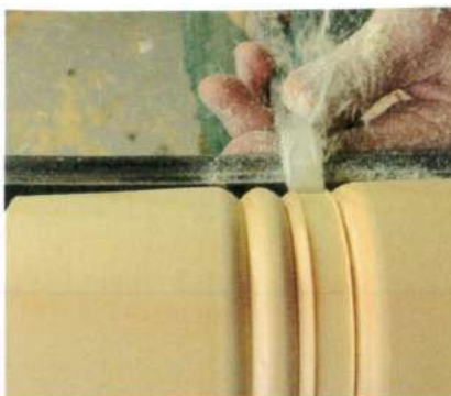
Grain d'orge en train de profiler une plate-bande.
