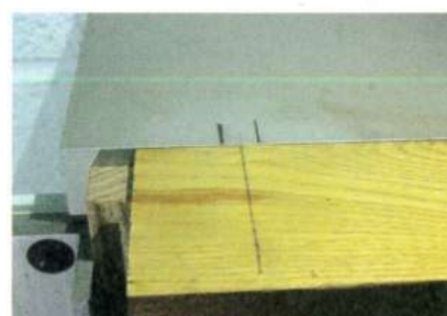
Alignement du gabarit pour l'usinage central.
