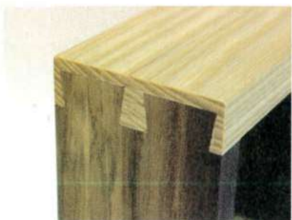
Les queues-d'aronde recouvertes une fois terminées...
