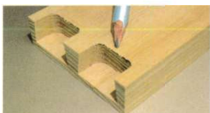
Le crayon montre la limite entre la zone à nettoyer et la ligne de repère.
