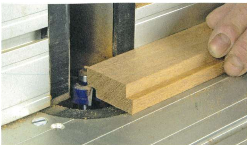
Les baguettes utilisées pour la « table-boîte » sont feuilurées sur les deux faces en opposition.
