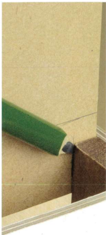
Traçage des repères de coupe pour les encoches des coins d'assemblage du panneau de fond.
