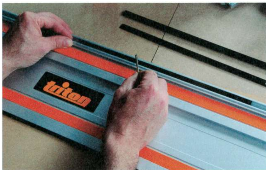
Une fois assemblés les deux éléments forment un rail parfaitement rectiligne.
