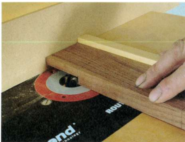
Une fraise à tenonner est aussi très efficace pour faire des feuillures bien propres.
