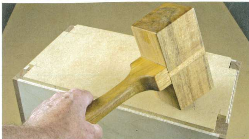
Le panneau de fond est délicatement frappé en position une fois encollé.
