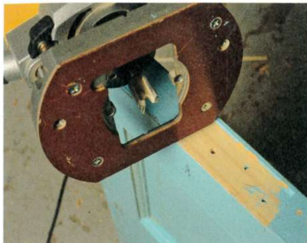
Une fraise à mortaiser pour charnière est un excellent choix pour faire de belles rainures peu profondes.
