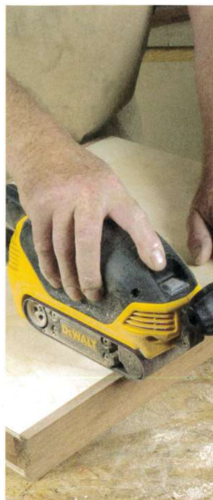
Utilisez la ponceuse à bande pour dresser les arêtes du contreplaqué.
