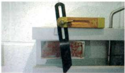
Réglage du biais de l'angle de la queue-d'aronde.
