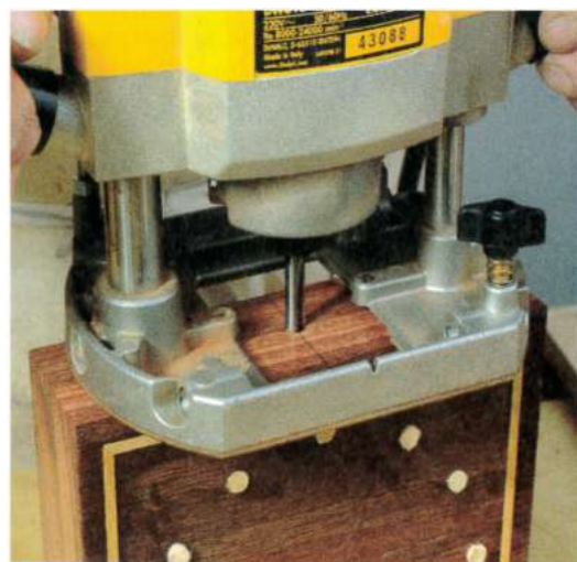
Une fraise longue de 6,4 mm de diamètre est un choix qui mérite d'être envisagé pour plusieurs raisons.
