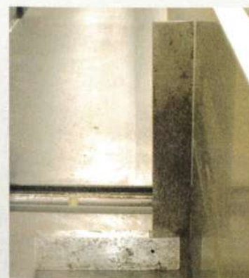
L'écartement visible sur la photo montre bien que le guide n'est pas parfaitement d'équerre.
