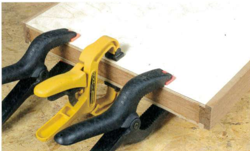
Collage et serrage de la baguette de renfort des pieds.
