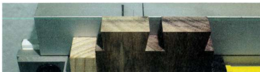
Alignement de la planche en noyer pour le nettoyage de la planche en frêne.
