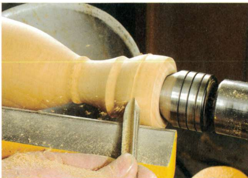
Gouge à profiler creusant un profil complexe.
