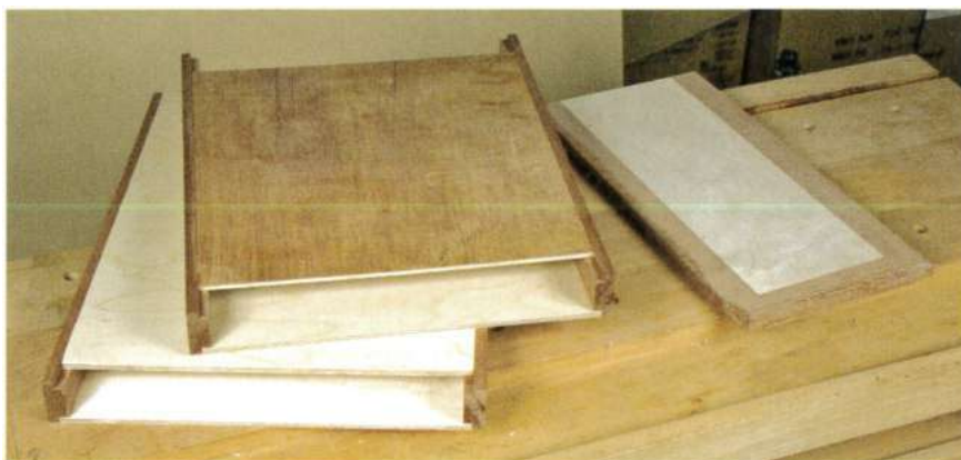
Les différents éléments pour la « table-boîte » : un pied avec le contreplaqué de bouleau (en bas), le plateau avec le contreplaqué standard (sur le dessus), et le panneau de façade (à droite).
