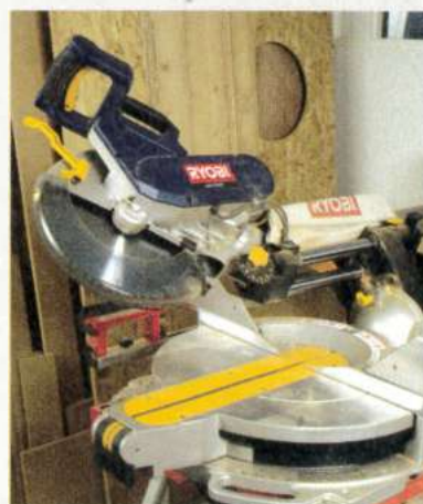
Le choix de la qualité de la machine et la finesse de ses réglages est essentiel pour obtenir les coupes d'onglet les plus précises qu'il est possible.
