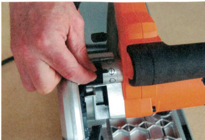
Trois modes d'utilisation sont disponibles : démontage de lame, coupe plongeante totale, et incision à 2,5 mm.
