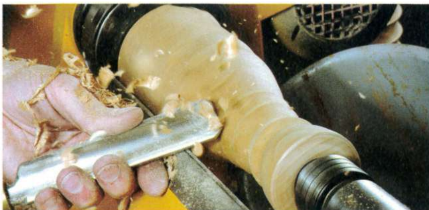
Gouge à dégrossir servant à la mise en forme d'un balustre.
