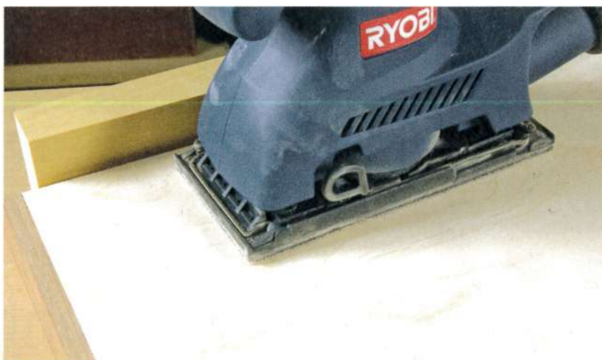
Appliquez un ponçage soigneux et fin avant de passer à la finition.
