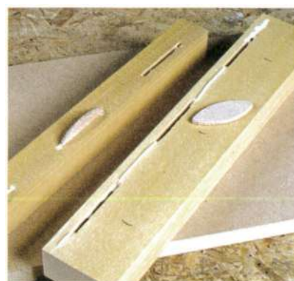
Notez bien les zones d'encollage sur chaque partie de l'assemblage.
