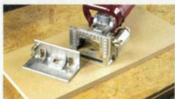
L'élément le plus important ici est la planche de MDF sur laquelle repose la fraiseuse à lamelle. C'est elle qui va servir de gabarit de position de référence pour l'usinage des rainures.
