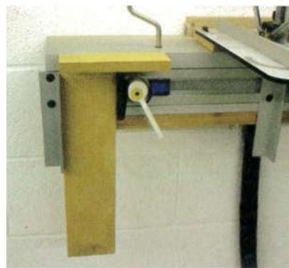
Gabarit pour le report de mesure dans le poste de copiage.
