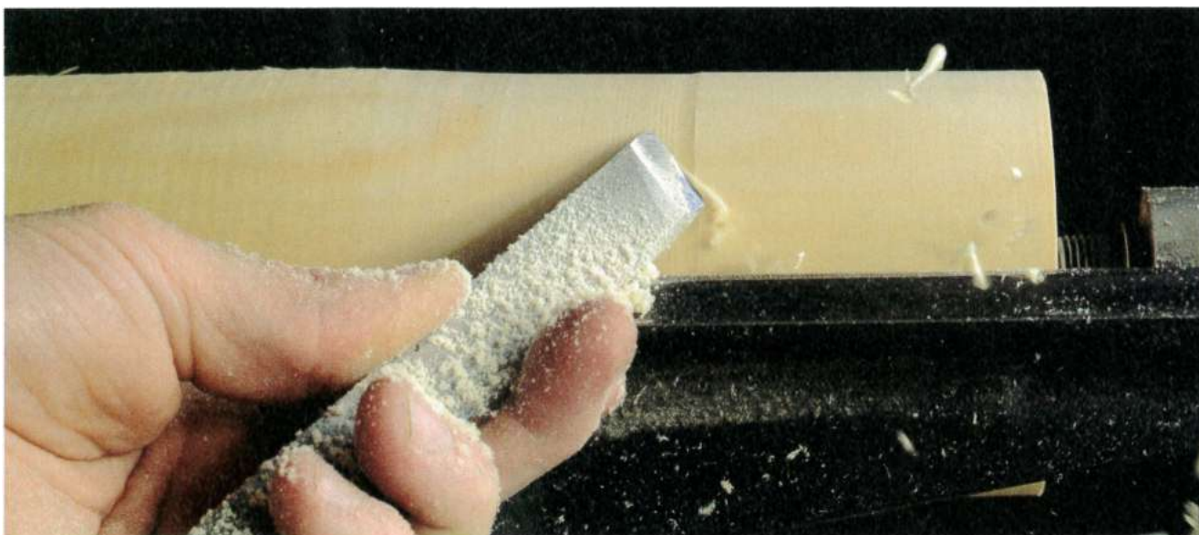
La plane permet d'obtenir un bel état de surface en sortie de coupe.
