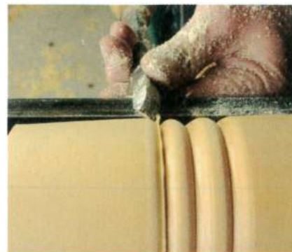
Creusage d'une série de têtes (ou boudins) avec le grain d'orge.
