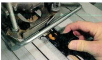
Réglage de la butée sur plaque de centrage.
