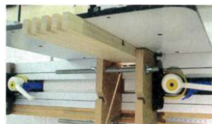
Planche en frêne placée à l'horizontal dans la boîte de coupe d'onglet.
