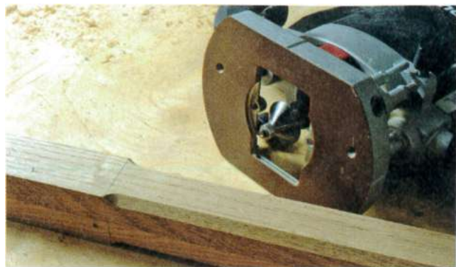
La fraise à chanfreiner peut servir dans de nombreux cas d'usinage pour différents effets.
