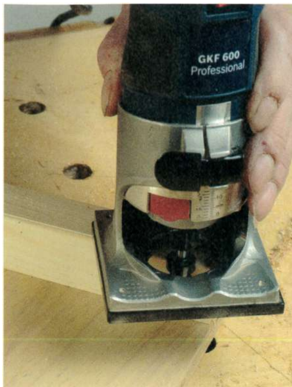
Un quart-de-rond en 6,4 mm sera, quant à lui, plus intéressant pour un travail plus important sur les arêtes.
