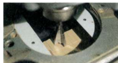
Alignement de la fraise sur la ligne tracée sur la planche en frêne.
