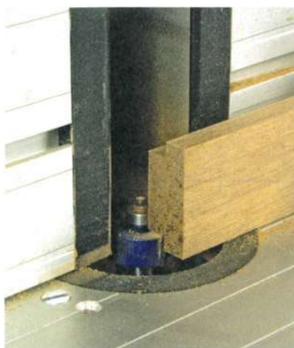
Usinage des feuilures pour les baguettes de façade.
