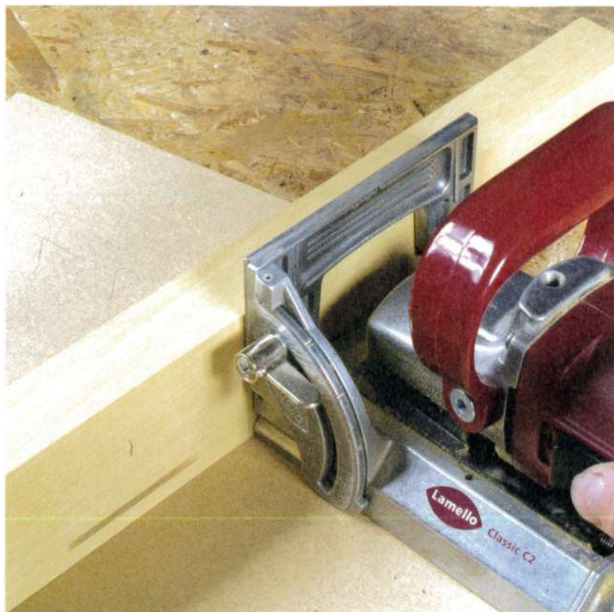
Rainurage à l'aide d'un gabarit de positionnement placé sous la lamelleuse.
