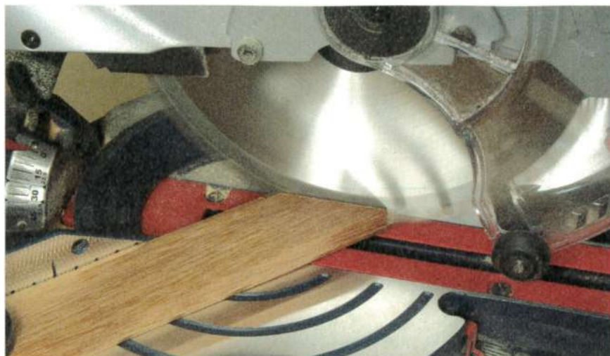
Réalisation d'une coupe d'onglet sur la scie radiale.
