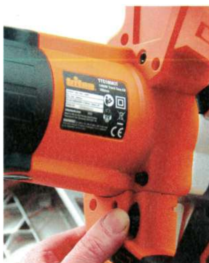
La molette du régulateur de vitesse est, quant à elle, facilement accessible.
