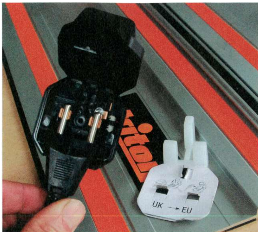
La machine est livrée avec la prise électrique anglo-saxonne d'origine qui est heureusement démontable.
