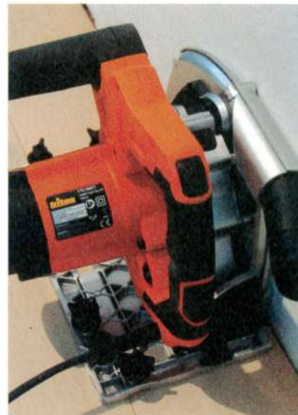
Le carter plat permet une coupe au plus près des murs (15 mm).
