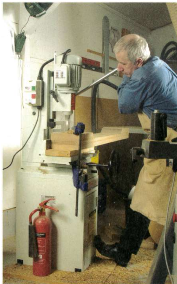
Le présence de l'extincteur n'est pas pour la blague ! Le ciseau peut vraiment devenir brûlant lorsqu'on travaille dans du chêne très épais.
