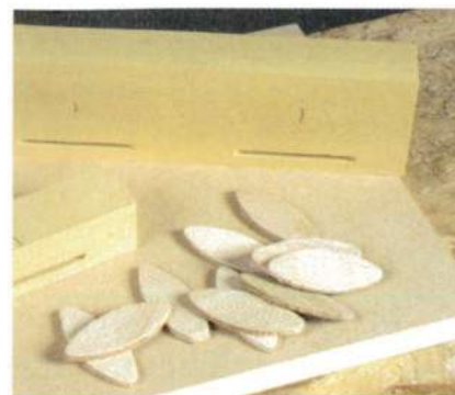
La hauteur de position des lamelles n'est pas déterminante.
