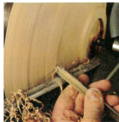
Gouge à creuser utilisée pour la mise en forme extérieure d'un bol.
