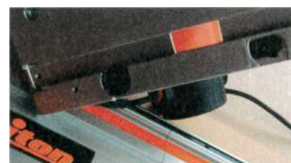
La semelle de la scie est montée sur le guide parallèle à l'aide d'une came de verrouillage et équipée d'un système anti-recul.
