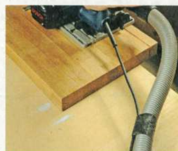
Gardez le fil électrique et l'aspiration bien dégagée de la zone de coupe.
