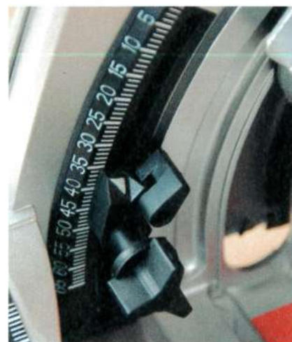
Le réglage de la profondeur de coupe s'effectue tout simplement par le déplacement d'une butée sur un index.
