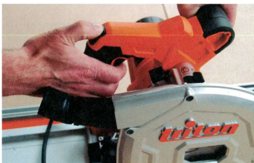
Les poignées, recouvertes par du caoutchouc surmoulé, offrent une bonne prise en main.
