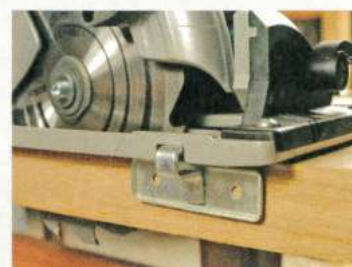
Dans la mesure du possible utilisez un guide parallèle ou une règle de guidage.
