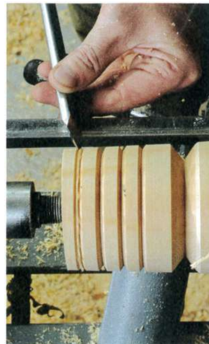
Plane utilisée pour faire une rainure en « V ».
