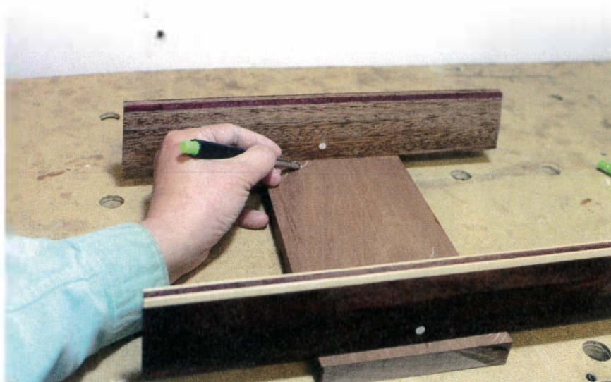
Gardez la première règle comme point de repère et déplacez la seconde d'avant en arrière pour trouver les autres points hauts.
