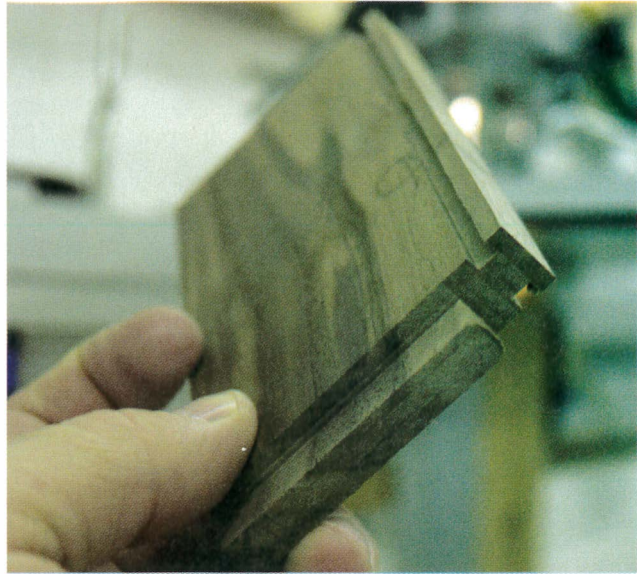
Les deux rainures pour les fonds de boîte sur la cloison en noyer.
