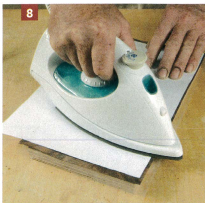
Les feuilles de placage thermofusibles facilitent un peu le travail mais demandent beaucoup d'attention et de soin.
