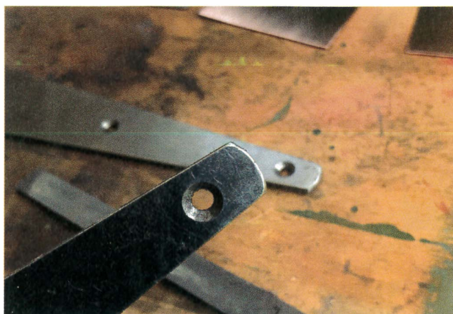
Retirez toutes les bavures autour des trous et des bords fraisés.
