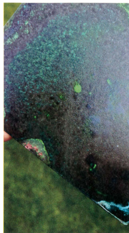
La patine vert bronze (Tiffany Green) peut être utilisée pour créer des effets de couleurs vives. Vous pouvez remarquer que sur la plaque, il y a deux zones qui ont été tenues à mains nues après le dégraissage mais avant l'application de la patine et qui n'ont pas pris la teinte comme le reste.
