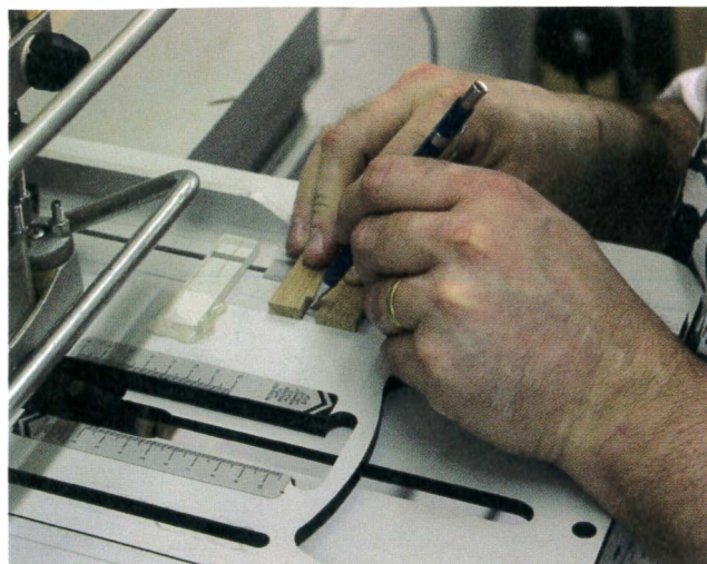
Traçage du profil de la fraise à partir du gabarit sur le rail de guidage.
