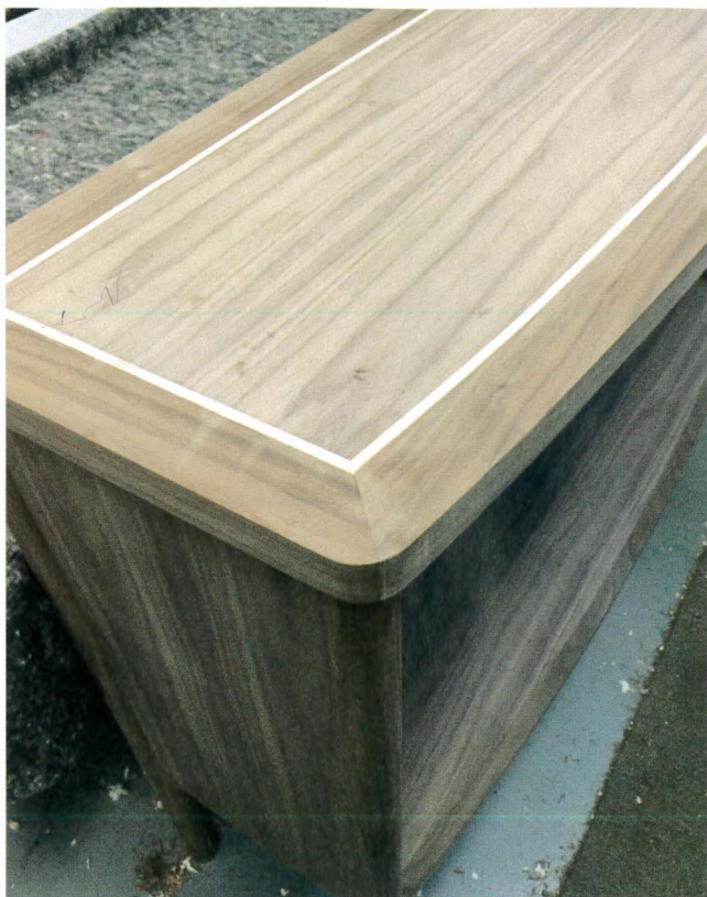
Les baguettes sont incrustées sur la ligne de jonction de la ceinture avec le panneau du plateau supérieur.
