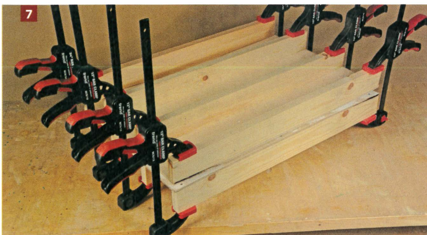
Une fois les presses installées, les cales appliquent une pression qui part du centre et qui se déploie vers l'extérieur de la planche.
