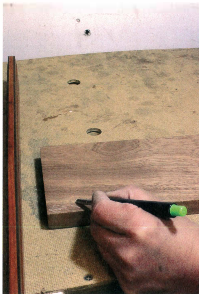
Repérez le premier coin haut puis celui dans la diagonale opposée qui est aussi un point haut.
