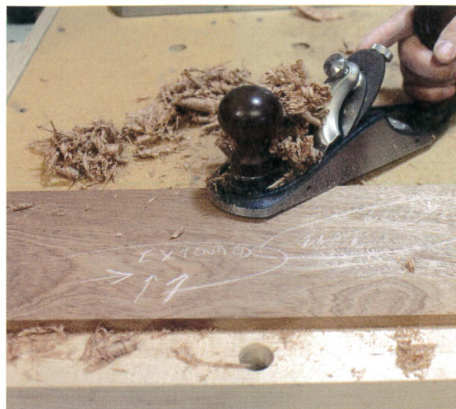
Dégagez les plats en opérant des passes croisées en biais à partir des bords vers le centre de la planche pour éviter les risques d'arrachement de matière.
