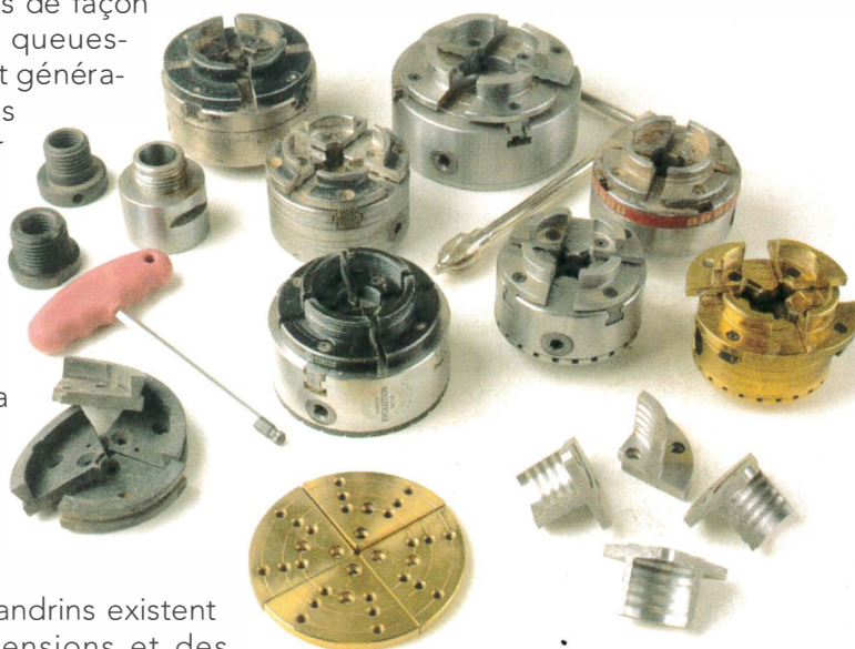
Les mandrins possèdent des formes et des dimensions très variées, de même que les mors qui vont avec.
