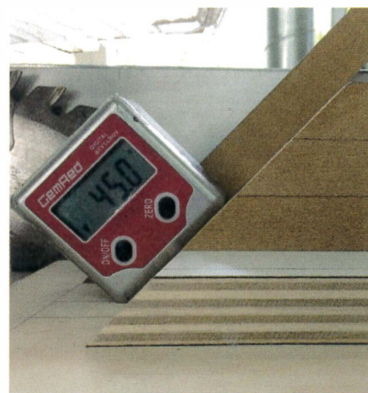
Utilisation d'un inclinomètre pour vérifier que l'angle du gabarit est correct.
