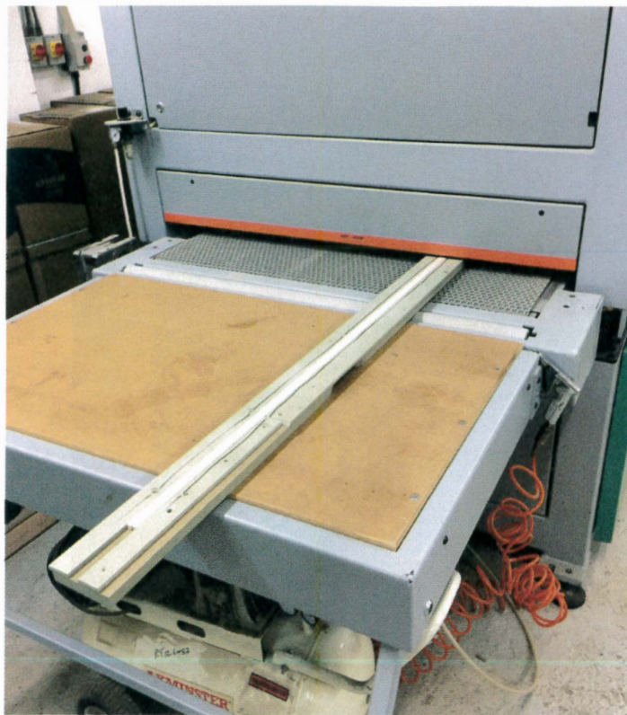
Il a fallu recourir à un chariot de secours pour soutenir le montage avec les baguettes d'érable pour pouvoir les passer correctement dans la ponceuse calibreuse.
