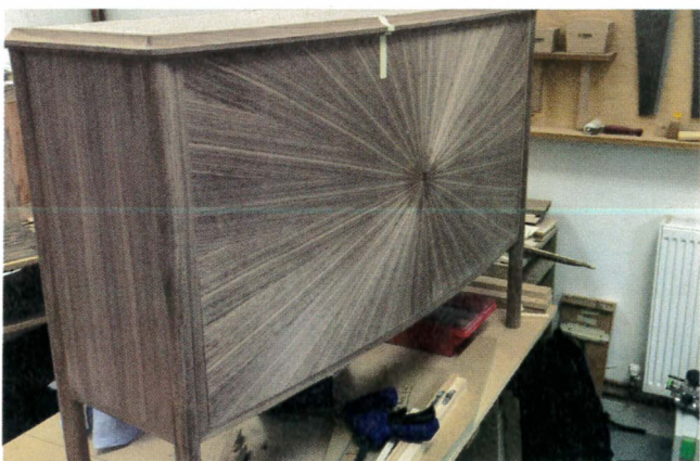
Avant la pose des charnières invisibles, les portes sont reprises au rabot de façon à offrir le jour le plus fin entre la porte et la structure.
