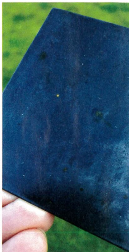
Il est possible que de la rouille vienne piquer la surface des métaux ferreux après application de la patine.
