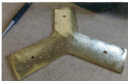
Les plaques de laiton sont griffées et poinçonnées en vue du collage.
