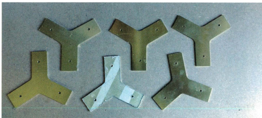
Vous devez obtenir, au final, six plaques identiques en laiton.
