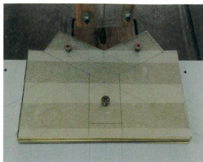
Dessin du patron, report du tracé puis fixation des feuilles de laiton sur le gabarit.
