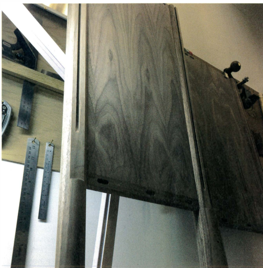
Les lignes d'épaulement avec la partie inférieure des côtés et du fond.
