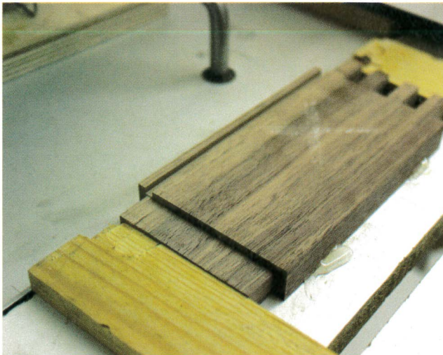
Les pièces les plus courtes sont tenues sur une table horizontale avec des cales de serrage sur les côtés.
