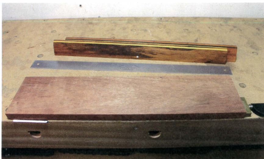
Si la planche est trop large pour être bloquée dans un étau, je la serre sur l'établi en plaçant une ou des cales sous le point haut.
