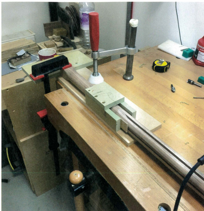
Un gabarit de butée d'usinage a été utilisé pour conserver l'épaulement bien plan lors du passage à la toupie.
