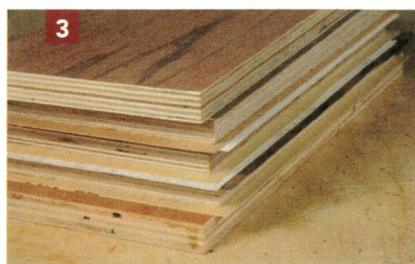
Le pressage par empilement est parfait pour coller plusieurs petites planches.
