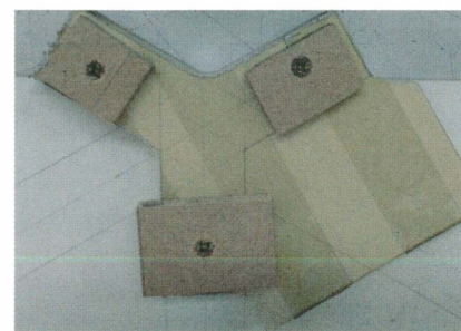
L'usinage des plaques de laiton implique un dégrossissage à la scie à ruban, un fraisage à la défonceuse, puis la rotation des feuilles dans le gabarit avant de recommencer la ligne d'opérations.
