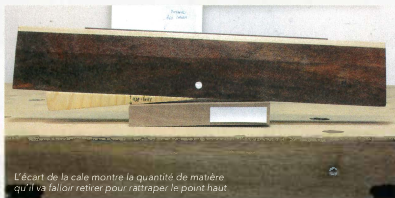
Repérez le premier coin haut puis celui dans la diagonale opposée qui est aussi un point haut.
