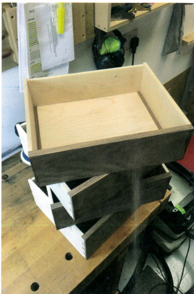
Les éléments à l'intérieur du meuble reçoivent une finition à l'huile puis une couche de cire.
