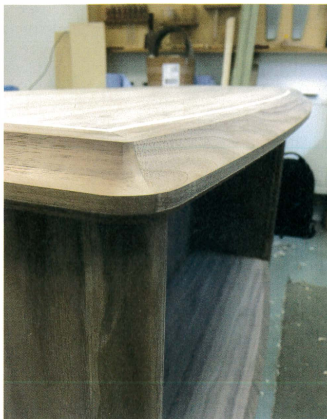
La moulure de la ceinture n'a pu être usinée qu'une fois l'incrustation terminée et reprise au rabot.
