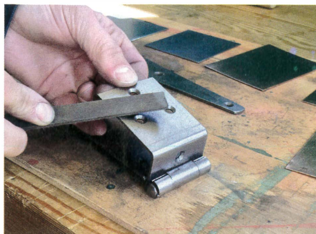
Nettoyez les surfaces et les arêtes à l'aide d'une lime et d'abrasif à grain fin pour en vieillir un peu l'aspect général.
