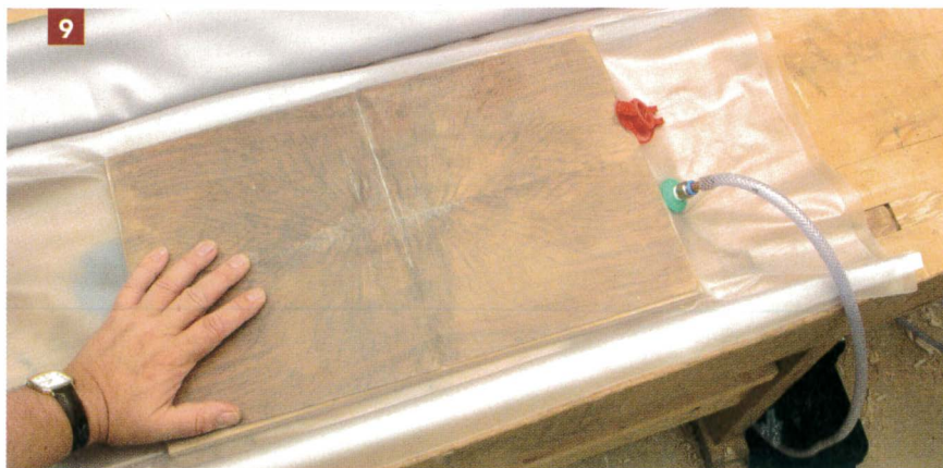
Pour ceux qui en ont la possibilité et les moyens, les systèmes de presse sous vide sont vraiment très efficaces.
