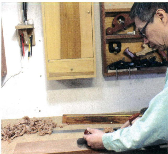
Pour finir les opérations de rabotage, relâchez la planche et faites les dernières passes au rabot en suivant le fil du bois.
