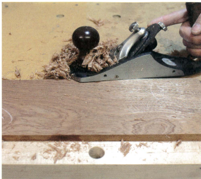
Rabotez les deux points hauts de la diagonale et vérifiez très fréquemment votre progression pour ne pas enlever trop de matière sur ces zones.
