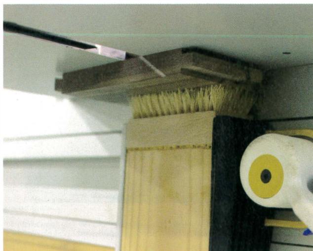
La brosse à poils durs sert de système de blocage pour l'usinage des rainures des fonds de boîte.
