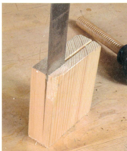
Séparez les morceaux et résistez à la tentation du sciage.
