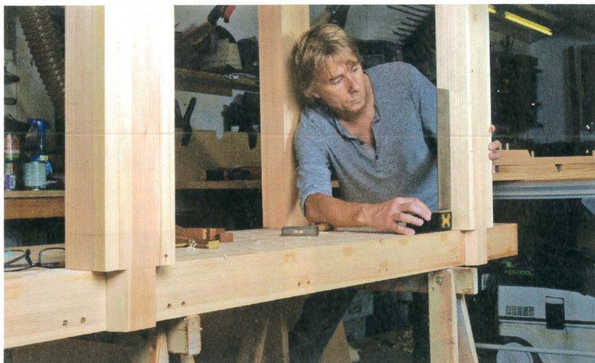
Une fois les pieds en position, vérifiez l'équerrage de l'ensemble.
