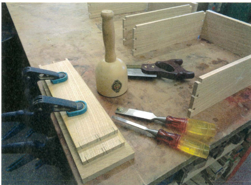
Découpe des queues-d'aronde dans les éléments des tiroirs.
