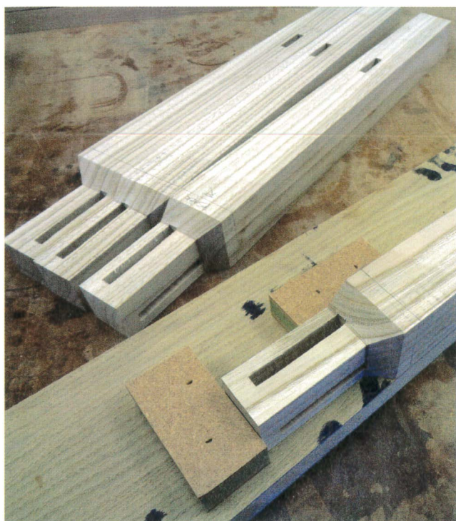
Utilisation d'un guide pour biseauter les pieds.
