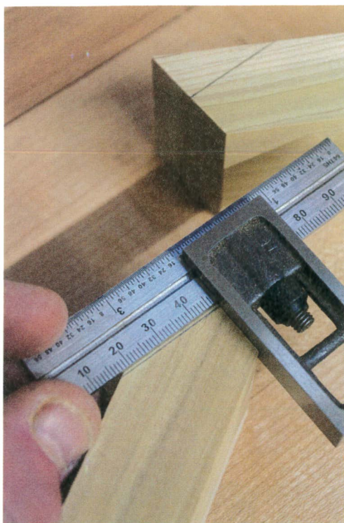
La pression doit être appliquée selon des angles droits par rapport aux lignes d'épaulement.
