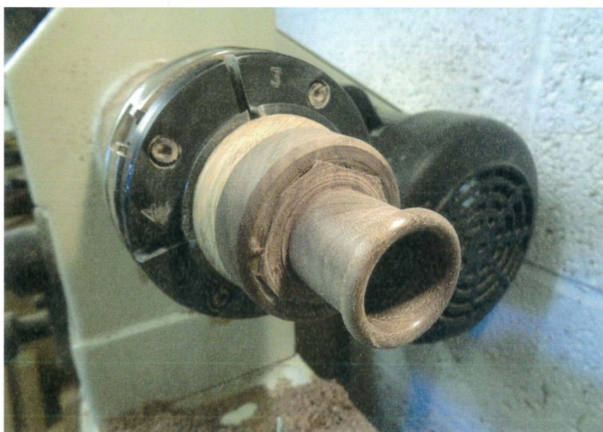
Ne creusez pas trop profondément, de façon à laisser la surface de collage des deux pièces intacte.
