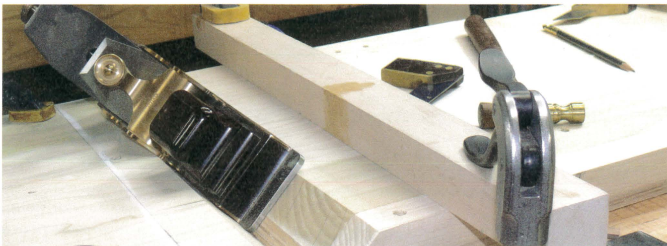
Nettoyage des coupes d'onglet au rabot.
