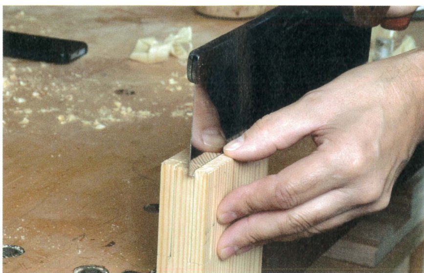
Poussez la face de votre lame de scie à dos vers l'intérieur de votre coupe.
