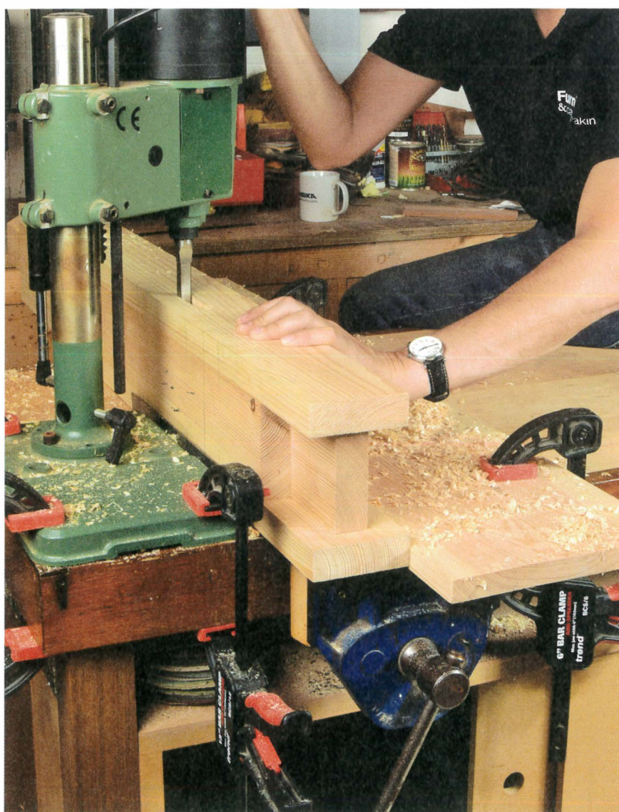
Gagnez un peu de place en décalant la tête hors de la base.
