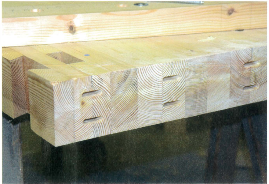
Des faux tenons sur du bois scié sur quartier restent la solution la plus stable.
