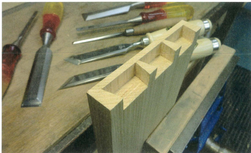
Une bonne paire de ciseaux à coupe biaisée facilite le travail de nettoyage dans les coins des mortaises.
