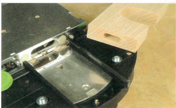
Il est possible d'usiner de petits éléments à l'aide d'un accessoire qui vient se visser sur la machine.
