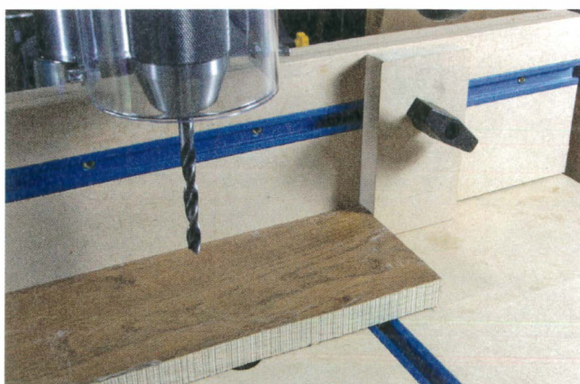
Un presseur et une cale empêchent la pièce de se décaler.
