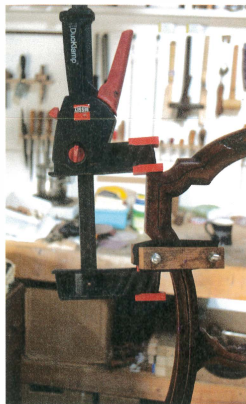
Les formes les plus atypiques utiliseront des cales de serrage temporaires adaptées. Ici, les cales sont bloquées à l'aide de boulons et les éléments protégés par des morceaux de chambre à air.
