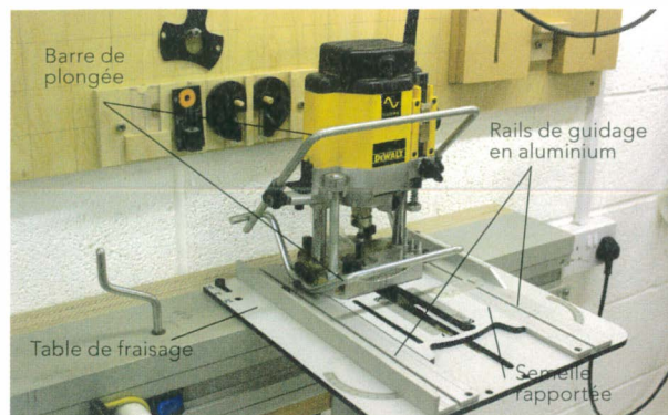
Défonceuse installée sur la table de fraisage.
