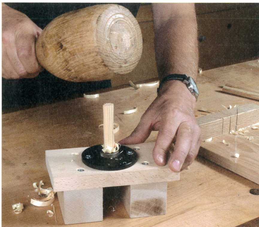
Utilisez une plaque à tourillons en descendant progressivement la dimension du trou pour nettoyer les coins des chevilles.
