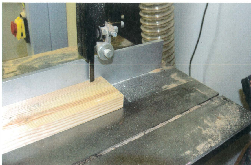
Il est possible d'usiner des coupes étroites à la scie à ruban sans dévier du tracé.
