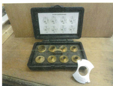
Un bon kit de bagues vous permet de décupler vos capacités d'usinage de gabarit.
