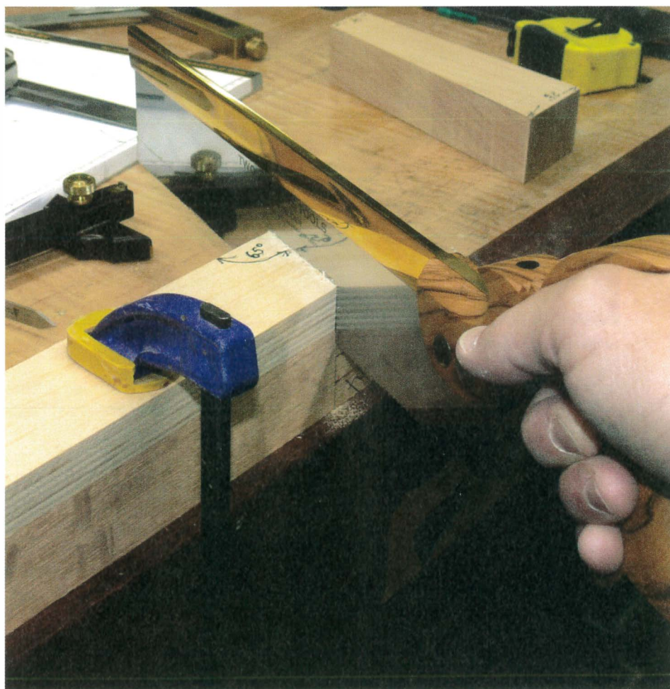
Coupe de test pour l'assemblage par enfourchement simple.
