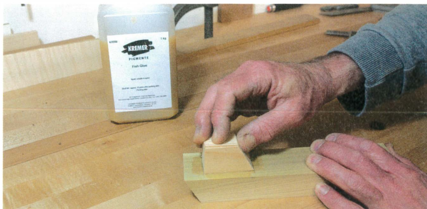
Les cales de serrage peuvent être fixées temporairement à l'aide d'une colle animale et de la technique de collage par friction.
