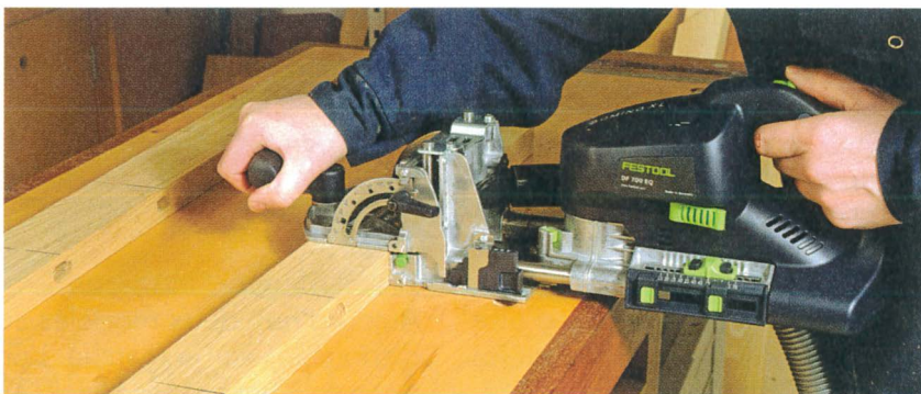
Le modèle XL DF700, beaucoup plus gros, est destiné aux travaux de menuiserie plus lourds.
