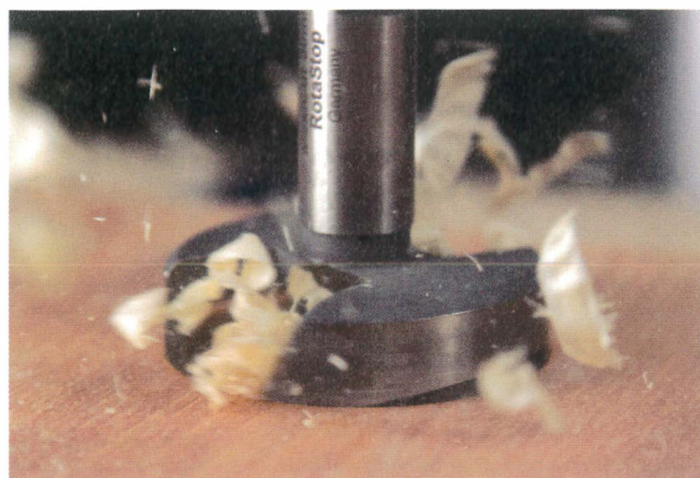
Utilisez des mèches Forstner de bonne qualité pour les usinages les plus larges.
