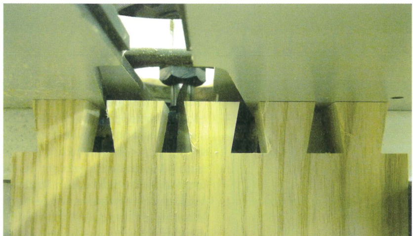
Exemple de queues-d'aronde débouchantes usinées sur le WoodRat.
