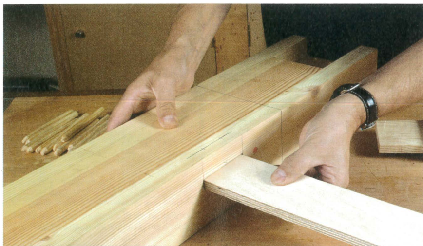
Protégez la face intérieure de la mortaise avec une chute de bois au moment de percer l'emplacement du passage du tourillon.
