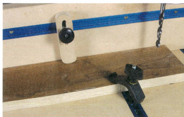
Une butée de réglage permet de répéter une opération plus facilement et plus précisément.
