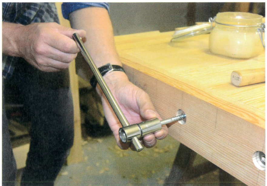
Placez la rondelle dans le trou pour la tête hexagonale avant de commencer à serrer la vis.
