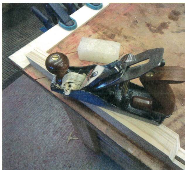
Nettoyage des traces d'usinage au rabot Stanley n° 4.
