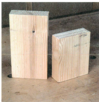
Les chutes qui présentent des défauts dans le fil du bois sont systématiquement rejetées.
