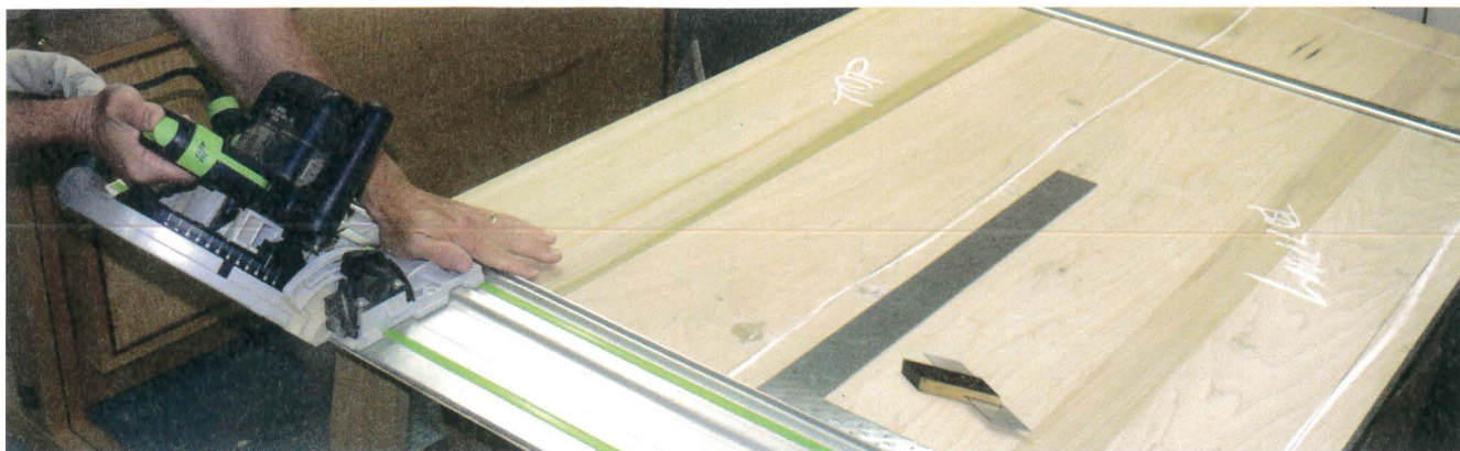
Les coupes d'onglet sont faites à la scie plongeante.
