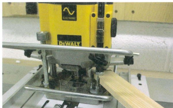
La profondeur de plongée est réglée à l'aide de la pièce de travail.
