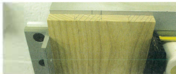
Le gabarit est ensuite déplacé de façon à ce que le repère de la fraise soit positionné sur la partie à droite de la zone à usiner.
