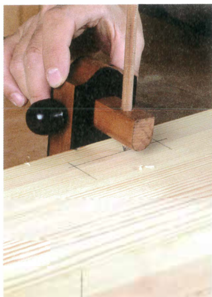
Pour les mortaises les plus grosses, un crayon est largement suffisant, il n'y a pas besoin de tracer tous les repères.
