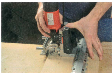
Le gabarit de tourillonnage de panneaux permet de réaliser des montages précis rapidement.
