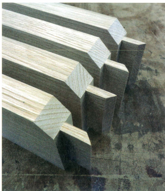
Éléments de ceinture tenonnés à coupe d'onglet.
