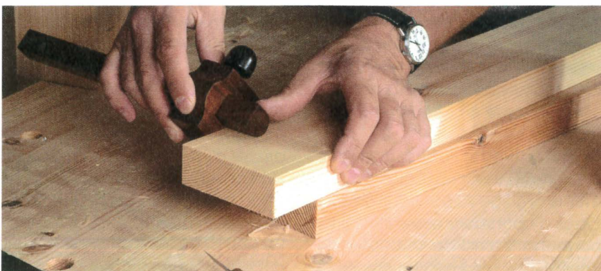
tracez les repères des tenons avec un trusquin à pointe.
