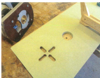
Alignement du gabarit à l'aide du tourillon de centrage.
