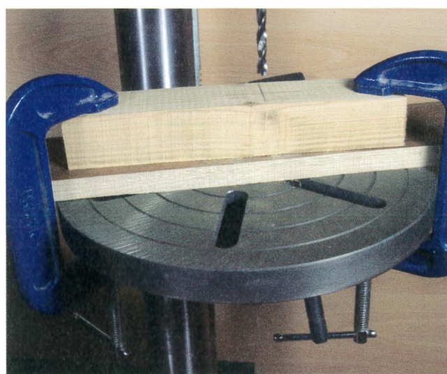
Un usinage débouchant doit se faire dans une planche martyr et non pas dans l'acier de la table.
