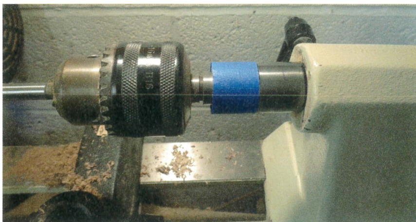
Mise en place du repère de profondeur sur le mandrin pour le creusage du trou.
