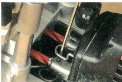
Changement de l'embout de perçage pour passer sur une autre dimension.
