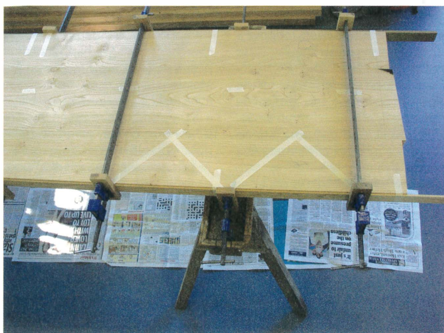
N'oubliez pas de prendre en compte la façon dont le serrage répartit la pression lorsque vous vous décidez pour le nombre de serre-joints et leur écartement.
