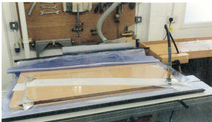
Les feuilles de placage sont collées au plateau de MDF puis mises sous presse à vide dans une poche dédiée.
