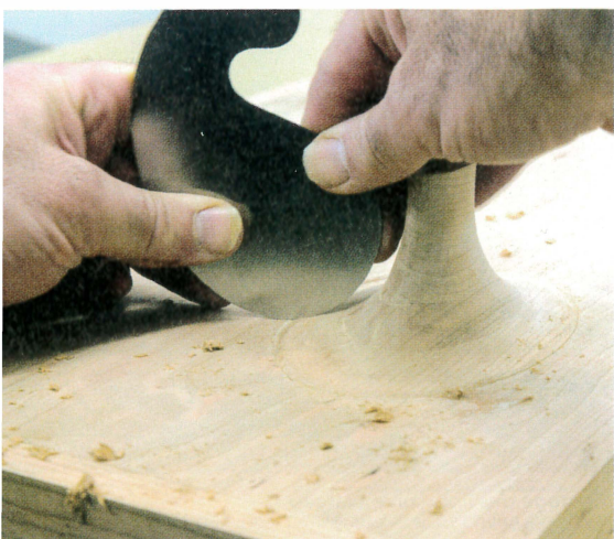
Reprise au rabloir courbe de la base des îlots pour l'intégration dans le plateau.
