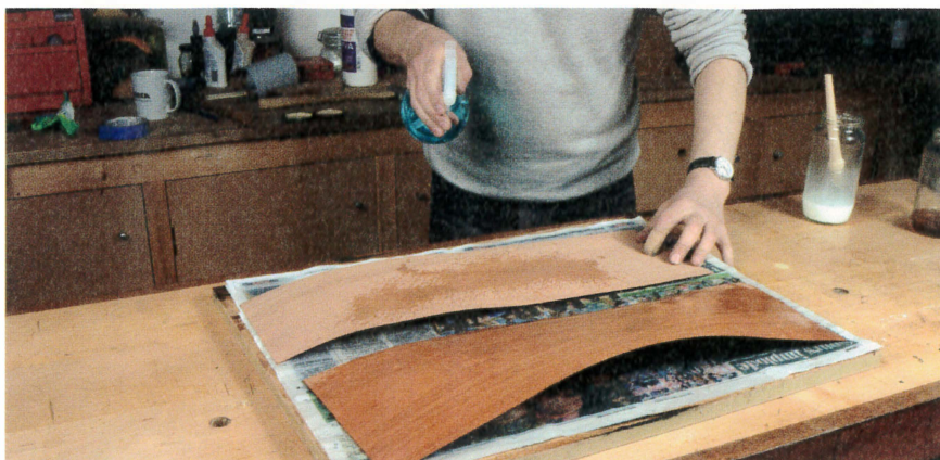
Vaporisez de l'eau sur une des faces de la feuille de placage.
