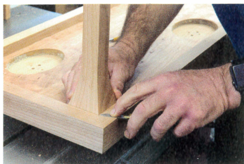
Marquage des limites d'épaulement de l'assemblage des pieds dans le plateau.
