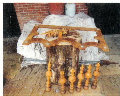
Résultat après fumage des éléments. On peut voir des zones grises qui représentent les endroits non exposés au fumage lorsque les éléments sont assemblés.
