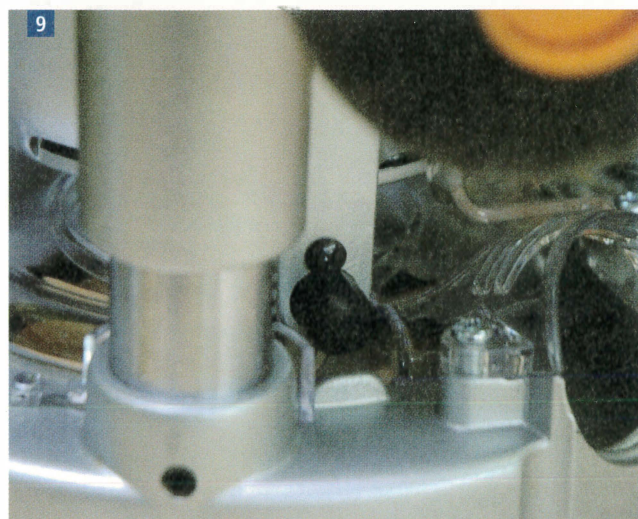
Autre petite « trouvaille » intéressante : le blocage d'arbre automatique pour le changement de fraise. Remarquez au centre de la photo le petit levier noir... il reste libre en position de travail.
