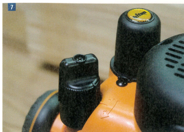
Le bouton de réglage micrométrique, à utiliser lorsque le bouton est en position on (enfoncé), est lui aussi généreusement dimensionné et facilement accessible. Lors d'un montage de la défonceuse sous table, il faudra enlever le ressort de rappel. Pour ce faire, il suffira d'enlever le ressort de rappel maintenu sous le cache visible à l'arrière de cette photo.
