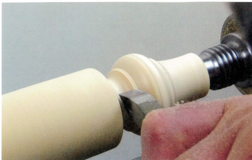
Mon tronquoir me convient parfaitement pour tourner les filets de finition, voire pour les reprendre s'ils ont été abîmés.
