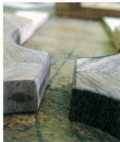
Les angles avant et après l'usinage du chanfrein.
