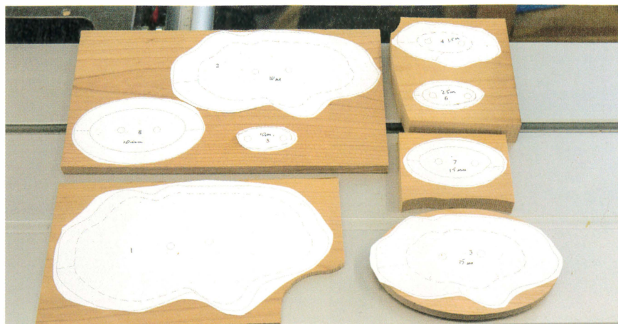
Les gabarits de découpe sont collés sur les morceaux d'un des îlots avant d'être dégrossis à la scie à ruban.
