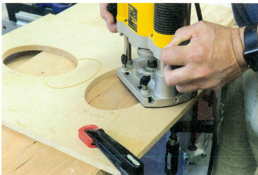
Détail de l'usinage à la défonceuse.
