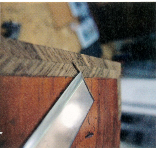
Le nouveau filet à motif plume une fois installé est suffisamment épais pour permettre de le reprendre avec un ciseau droit afin de le mettre à niveau avec le placage.
