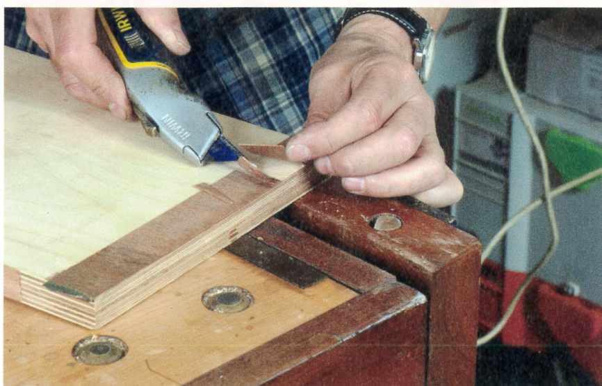
Retirez les chutes et passez la zone au fer à repasser pour finir le collage.
