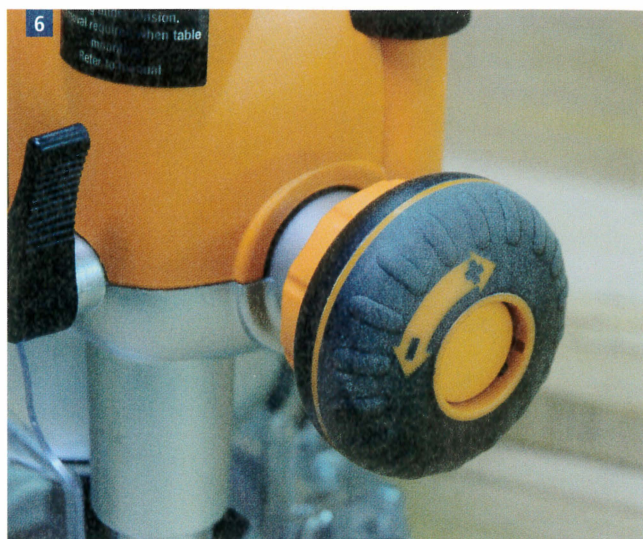
Bouton enfoncé, je suis en position de réglage micrométrique et/ou travail sur table à poste fixe.
