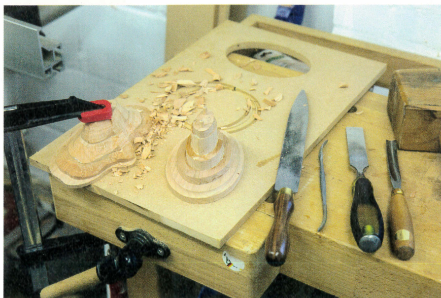
Moitié inférieure d'un îlot préparé pour la mise en forme.
