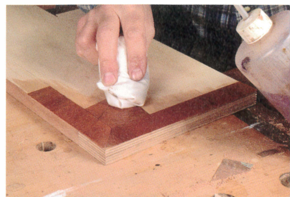
Tamponnez la zone au méthanol pour vérifier la tenue de votre couche de colle.
