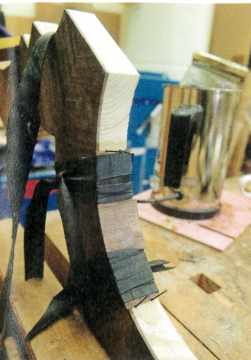
Placage des chants à l'aide de bandes de caoutchouc et de pointes de placage.
