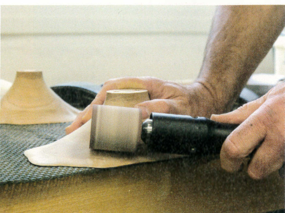
Finition des parties supérieures des îlots à l'aide d'un outil à cylindre de ponçage monté sur flexible.
