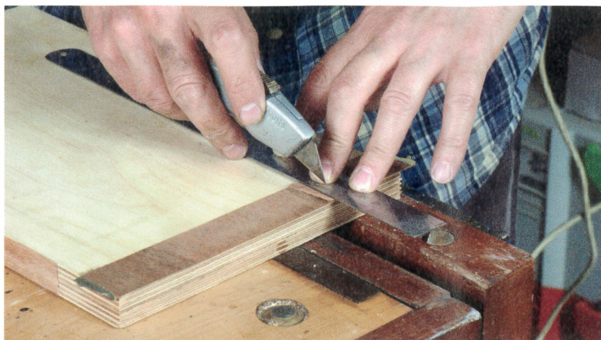
Posez votre deuxième morceau de placage directement sur le premier et découpez les deux en même temps pour créer le raccord.
