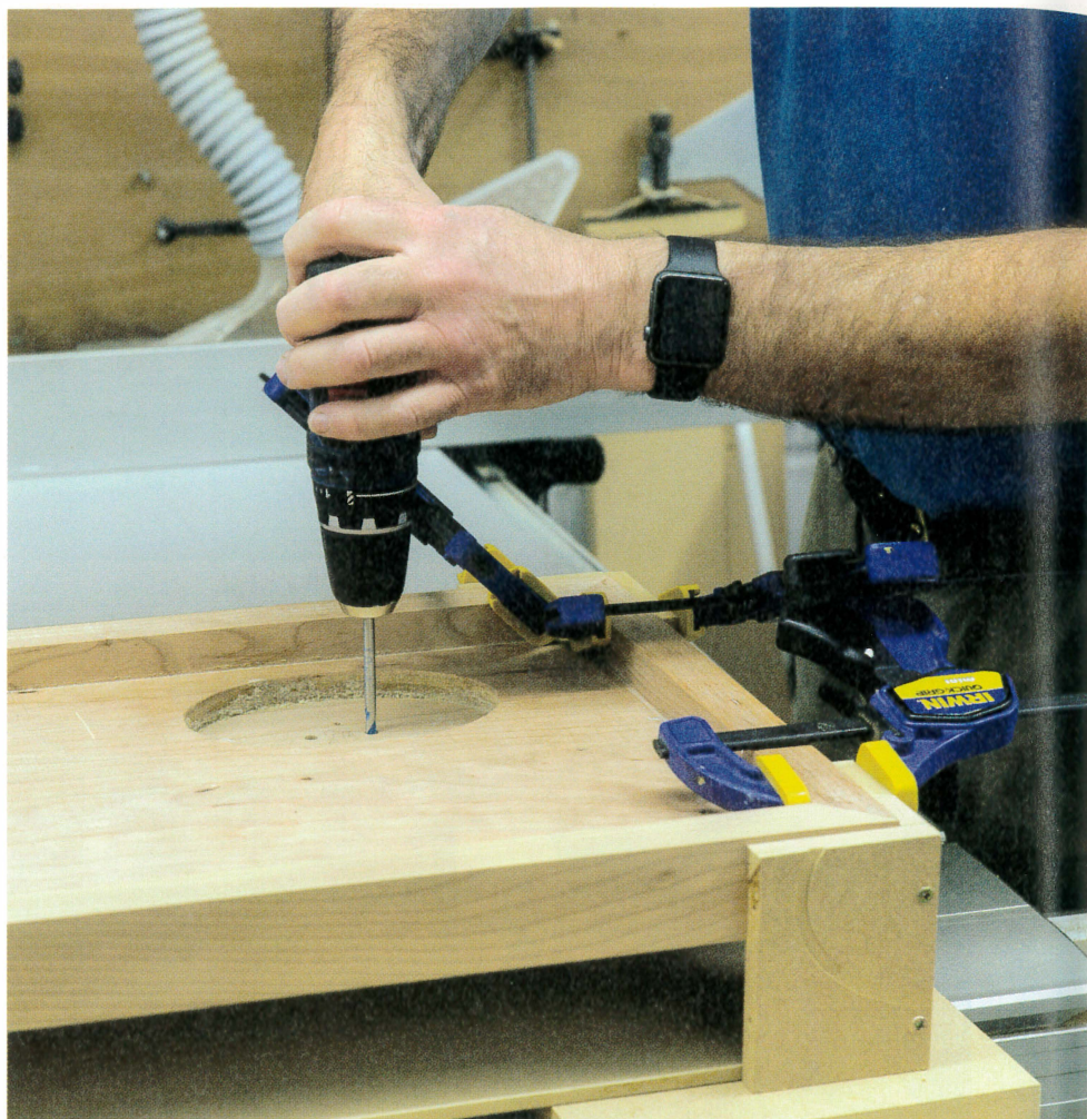
Marquage et perçage du gabarit de découpe et de façonnage du plateau en verre avec les trous de positionnement des îlots.
