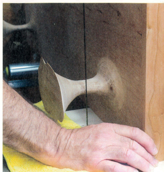
Séparation de la partie supérieure des îlots pour intégrer le plateau en verre.
