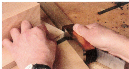
Utilisez un gabarit et un rabot à recaler pour obtenir de belles coupes d'onglet pour les languettes.
