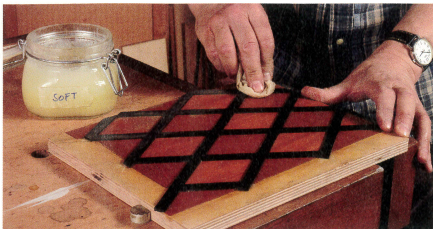
La finition des languettes est faite à la cire d'abeille, ce qui est un peu inhabituel mais assez pertinent pour une essence de bois sombre comme le chêne des marais.
