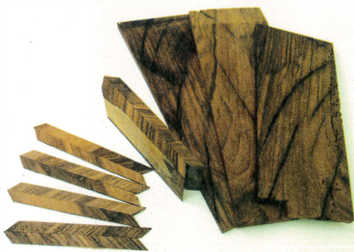
Les filets de reprise sont préparés en sections courtes à partir d'un morceau de noyer.
