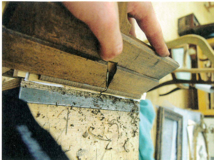
Mise en forme des baguettes avec un rabot à moulurer.
