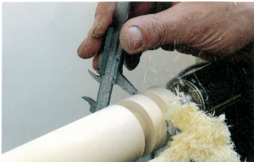
Le tournage de l'ébauche est réalisé à l'aide d'un tronquoir et d'un pied à coulisse.
