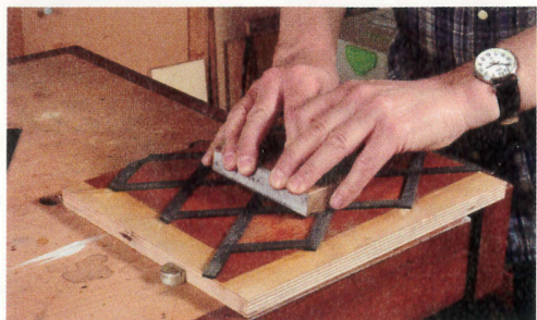
Utilisez une cale de ponçage bien large pour poncer les languettes de façon à ne pas venir endommager le fond du panneau qui est déjà fini.
