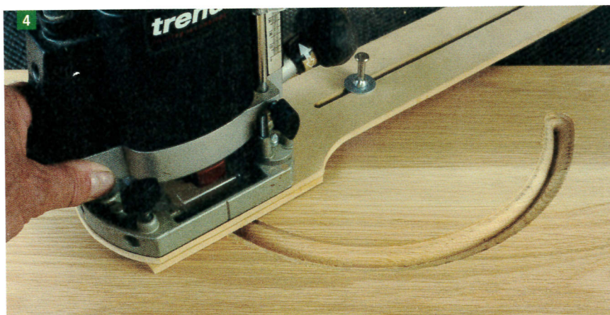
4 N'oubliez pas de faire une dernière passe pour nettoyer les traces de brûlures.
