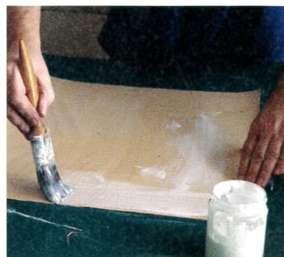
La colle est appliquée sur la face arrière de chaque feuille afin d'éviter de tuer les feuilles de façon trop marquée.
