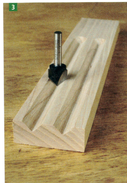
3 Une coupe arrêtée est facilement réalisable à l'aide d'une cale de butée que vous pouvez bloquer contre le rail de guidage en utilisation sous table.
