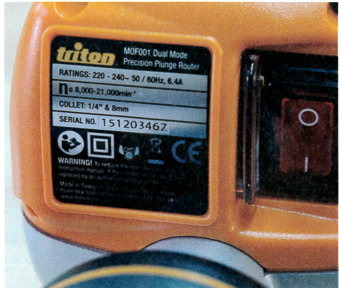
Une puissance de 1 400 W, mais uniquement des fraises de 8 mm (système métrique) et 1/4 (cote en pouces)... C'est dommage !
