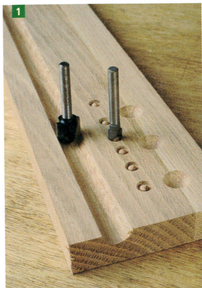
1 La fraise à gorge peut être utilisée soit en coupe longue, soit en plongée. La fraise à plaquettes, en raison de son profil, ne peut être que plongée.
