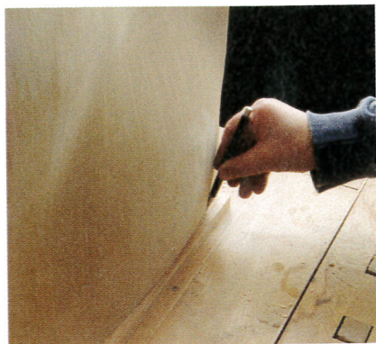
Les courbes du panneau sont reportées au crayon sur les éléments du cadre qui seront ensuite dégrossis à la scie à ruban.
