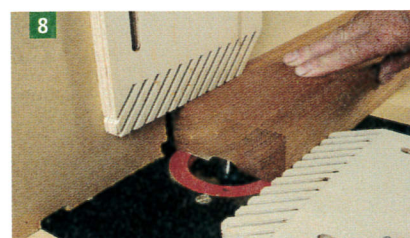
Une fraise de moulage génère des louvoiements qui peuvent être empêchés par l'adjonction de pressoirs peignes.
