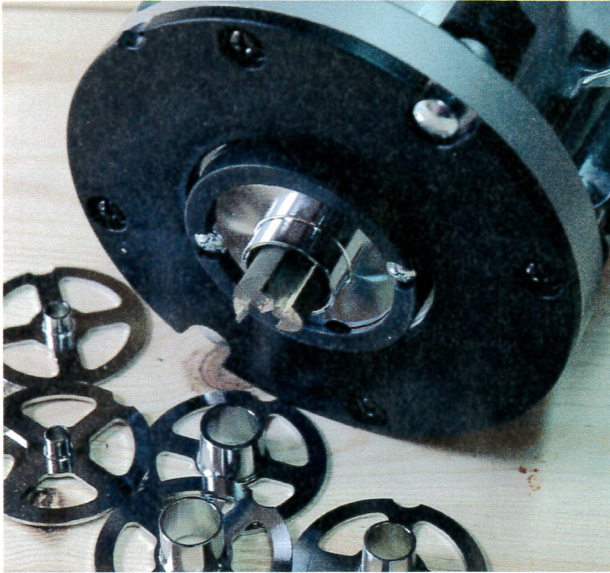
Le fabricant propose en option un impressionnant jeu de bagues de copiage.
