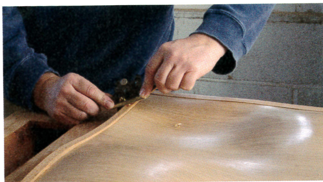
Les bordures du cadre sont ensuite finies à l'aide d'un wastringue afin d'en retirer les traces d'usinage et de chanfreiner légèrement les arêtes.
