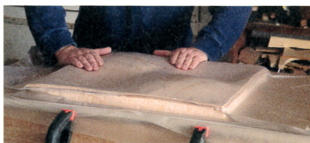
Pendant la dépression de la poche, les feuilles de placage sont pressées manuellement contre le moule pour éviter la formation d'ondulations.
