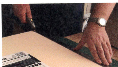
Une plaque de mousse polyuréthane convient parfaitement pour faire un moule.
