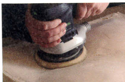
Le moule est travaillé avec une meuleuse et une ponceuse.
