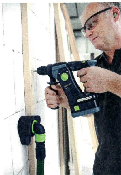
Le CT Wings offre une bonne tenue, même à la verticale, sur des matériaux poreux ou inégaux.
