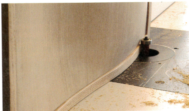
Une fraise droite équipée d'un roulement de guidage plus large permet d'usiner le cadre au plus près de la courbe du panneau.
