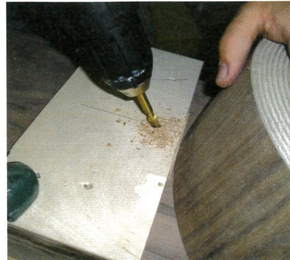
▲ Perçage en angle pour la pose des tourillons de blocage.
