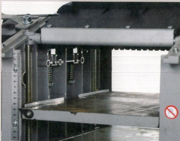
Sur les plus petites machines, ce sont quatre colonnes de levage (disposées à chaque coin) qui assurent la montée et la descente de la table de rabotage.
