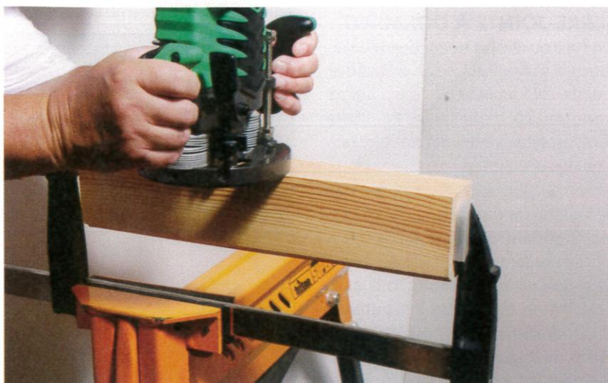
▲ Une presse à vis bloquée dans un étau permet d'usiner de grandes pièces.
