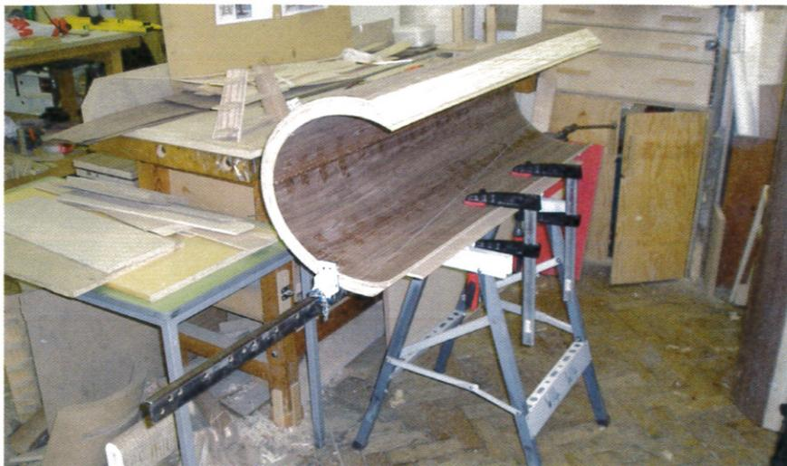
de 15 mm d'épaisseur au moins, de façon à ce que le gabarit résiste bien pendant les étapes de mise en forme. Cet élément doit avoir la forme très précise du profil du moule, car c'est celui-ci qui va permettre de former tous les éléments du moule.
