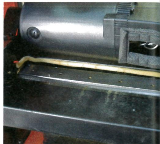
Vous remarquerez, sur chaque face qui reçoit l'outil de coupe, deux ergots de positionnement des fers et des contre-fers, un de chaque côté de l'arbre, c'est l'assurance d'un bon positionnement des fers et des contre-fers et d'un parfait alignement des arêtes de coupe.
