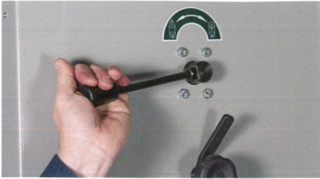
Les nouvelles générations de scies à ruban sont équipées de levier de tension à came.
