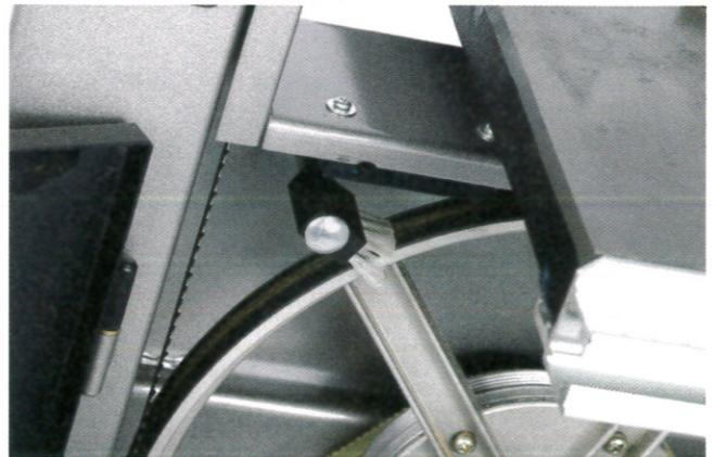
► Il est important de vérifier fréquemment les balais des volants inférieurs.
