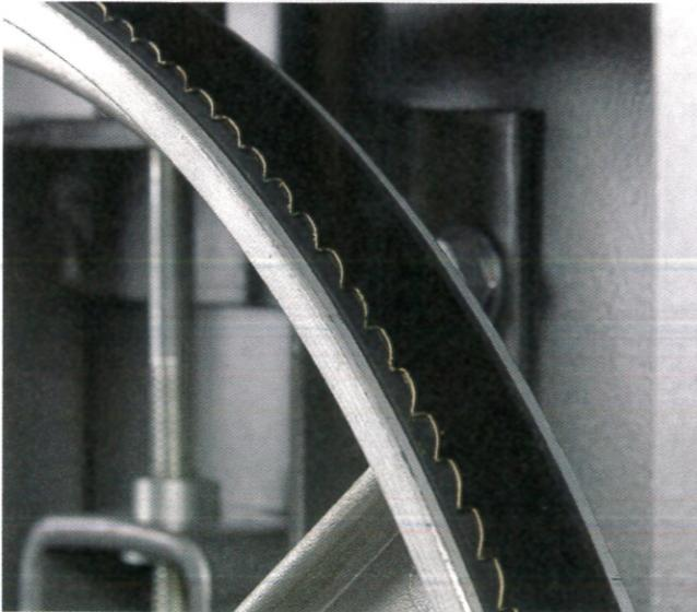
Le centrage s'opère en basculant le volant supérieur vers l'avant ou vers l'arrière jusqu'à ce que la lame se trouve à la bonne position.
