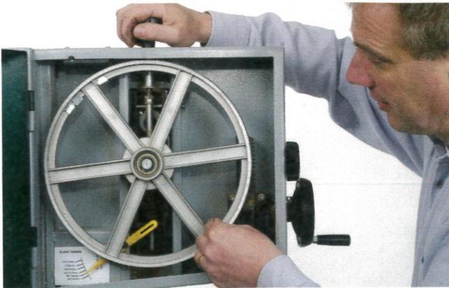
Une surtension peut entraîner des dommages au niveau du mécanisme de réglage et raccourcir la durée de vie de la lame. Montez en tension progressivement pendant que vous faites tourner le volant manuellement.
