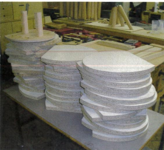
Les panneaux d'aggloméré pour le moule sont prêts à être montés sur les tiges filetées.
