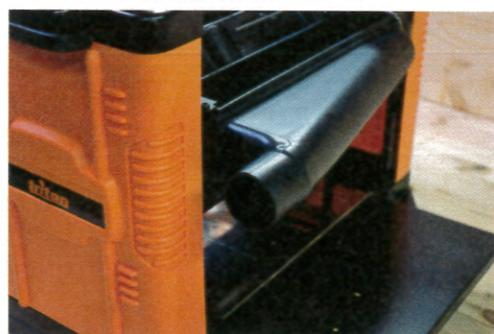
Le carter d'évacuation des copeaux se raccorde en standard.
