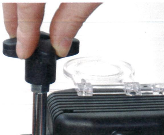
Clé à tube permettant le réglage micrométrique.
