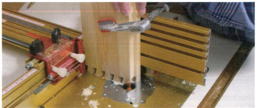
▲ Cette presse à vis permet de maintenir un gabarit pour usinage de plan de travail de cuisine.
