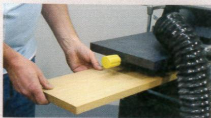
Puis la mise à l'épaisseur est opérée par le poste de rabotage accessible sous le bloc de coupe.
