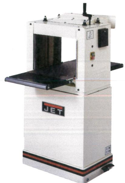
Une raboteuse à grande capacité permet de finir le travail fourni par la dégauchisseuse.
