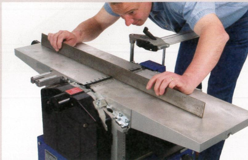
Une simple vérification avec une règle droite permet de repérer un défaut d'alignement des tables.
