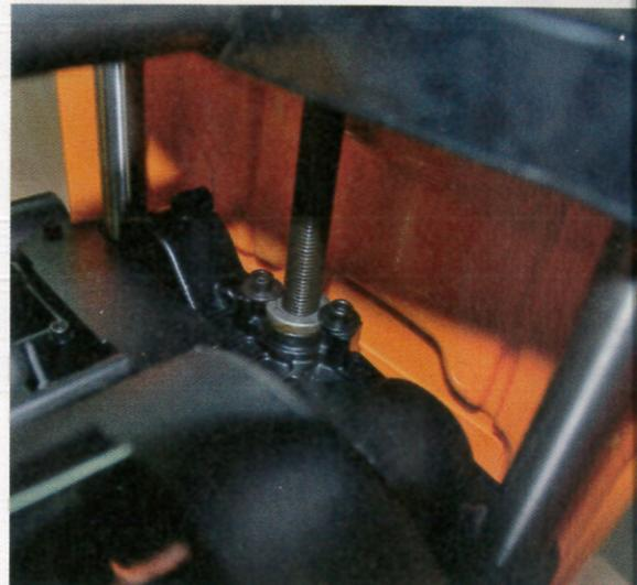
Le mouvement de montée/descente de la table est assuré par une vis de petit diamètre à pas trapézoïdal. De chaque côté, deux coulisseaux assurent le guidage. Pour garder une parfaite souplesse de fonctionnement, il est indispensable de nettoyer et graisser régulièrement aussi bien les coulisseaux de guidage que la vis de mouvement.
