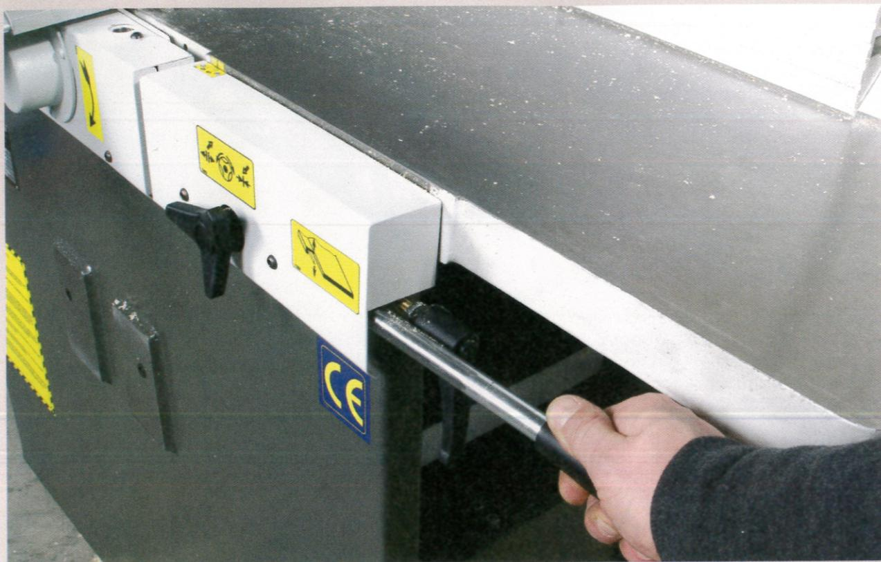
La montée et la descente sont assurées par un levier ou un volant sur un des côtés de la machine.
