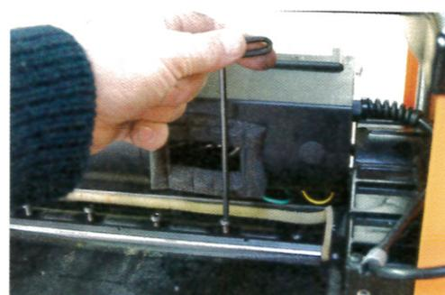
Autant pour le démontage des vis de maintien, il est conseillé de changer de clef Allen, autant pour le serrage, il est indispensable d'utiliser la clef fournie ; sa souplesse fait en quelque sorte fonction de clef dynamométrique.
