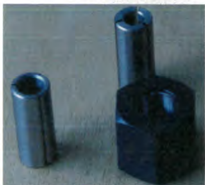
Pince pour queue de 12 mm et adaptation pour fraise en queue de 6 et 8 mm.
