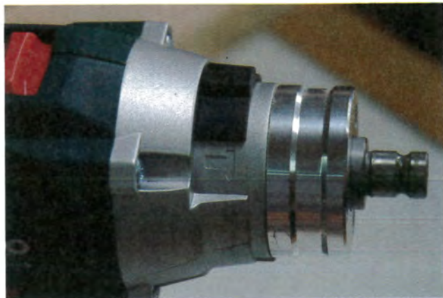
Lorsque la machine est en sélection percussion, elle se transforme en clé à choc.
