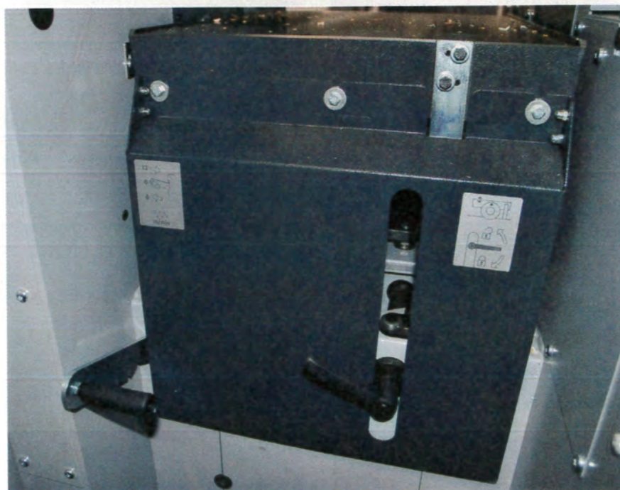
Deux vitesses de réglage de défilement des bois : 6 et 12 m/minute et un blocage de hauteur de table efficace qu'il ne faut pas oublier de desserrer avant tout mouvement.
