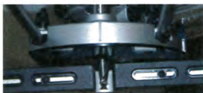
Les joues du guide parallèle coulissent pour s'approcher au plus près de la fraise.
