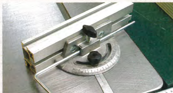
Le guide de coupe d'onglet vous permet de faire les coupes angulaires en toute sécurité.
