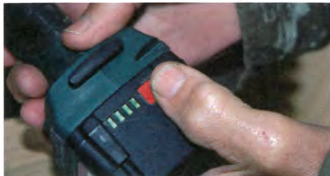
Un témoin de charge de la batterie n'est peut-être pas indispensable, mais c'est un plus appréciable.
