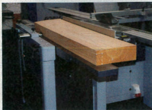
Des rallonges de tables de dégauchissage et de rabotage en fonte, efficaces et d'un montage instantané.
