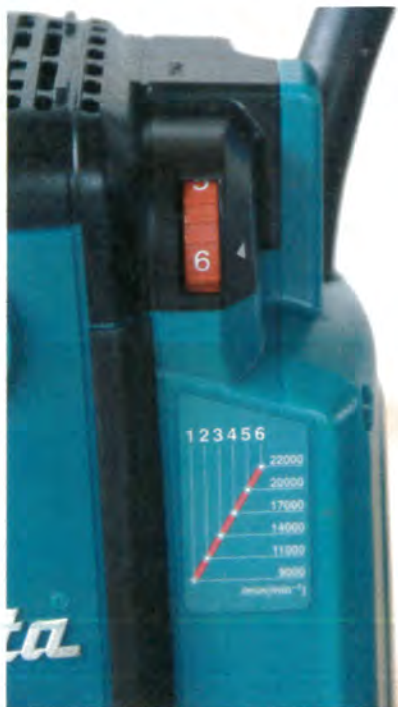
Réglage de la vitesse de coupe par molette et tableau de correspondance.
