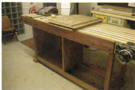
Les caissons sont mis en place et, une fois les panneaux de fond montés, ils donnent une bonne rigidité à l'ensemble de la structure.
