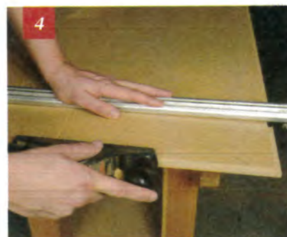
▲ Les montants n'étant pas exactement identiques, il a fallu passer un coup de rabot.
