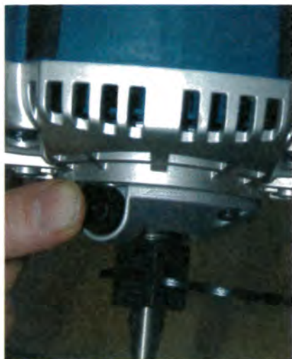
Un blocage d'arbre facilite le montage de la fraise.
