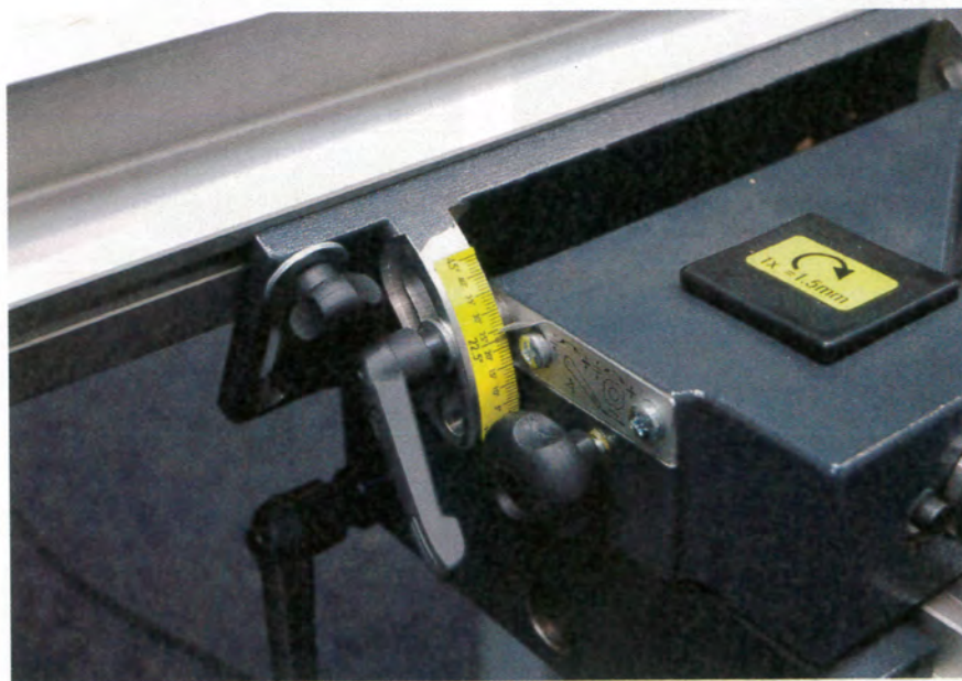
La règle d'équerrage est parfaitement tenue sur un sabot en fonte, mais son inclinaison n'est pas des plus pratiques.
