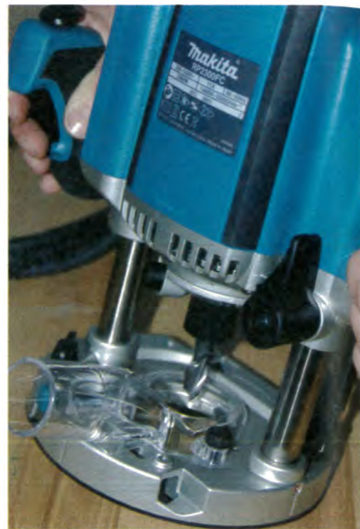
La cape d'aspiration se visse sur la semelle.
