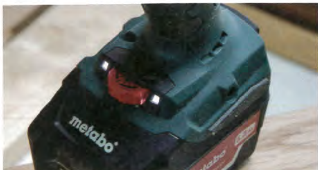
Variateur de vitesse et 2 LED à détecteur de mouvements, surprenant au premier abord, mais efficace.
