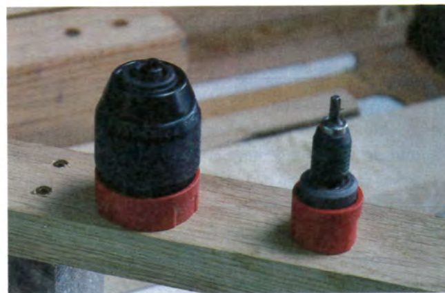
Au choix peut être monté un mandrin porte-mèche ou porte-embout.
