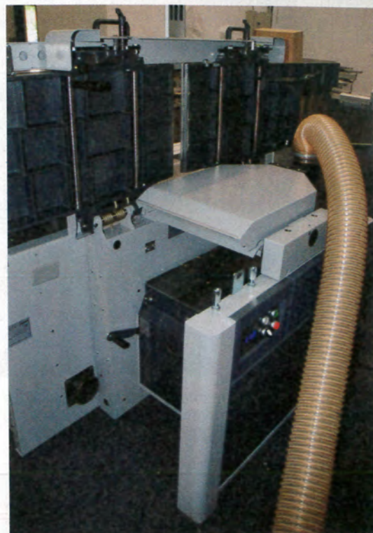
Les tables en fonte se relèvent vers l'intérieur avec une grande facilité et dégagent un vaste poste de travail.
