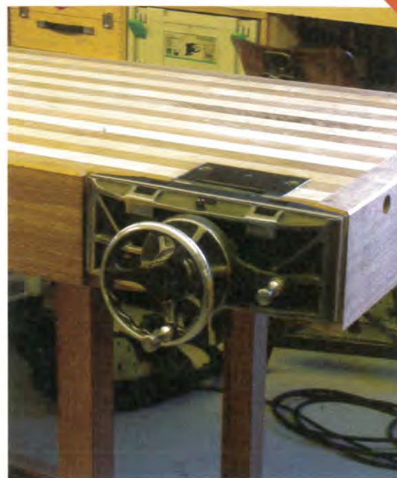
Mise en forme finale de la ceinture avant pour accueillir l'étau de modelleur. Une mise en forme équivalente doit aussi être effectuée sur la ceinture latérale qui est vissée au plateau de l'établi. La presse à vis double de l'autre côté est un peu moins compliquée à mettre en place.
