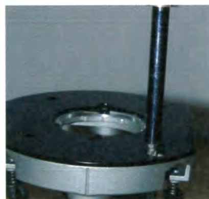
Une astucieuse longue vis traversant la semelle permet un léger réglage de profondeur lors de l'utilisation sous table.
