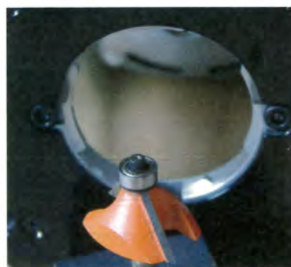
Une lumière de 60 mm de diamètre permet le passage de grosses fraises.
