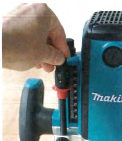
La butée de profondeur : une tige filetée munie d'un excellent réglage micrométrique. Le réglage se fait par un bouton moleté gradué en dixièmes de mm, avec une couronne servant d'index permettant une mise à zéro.
