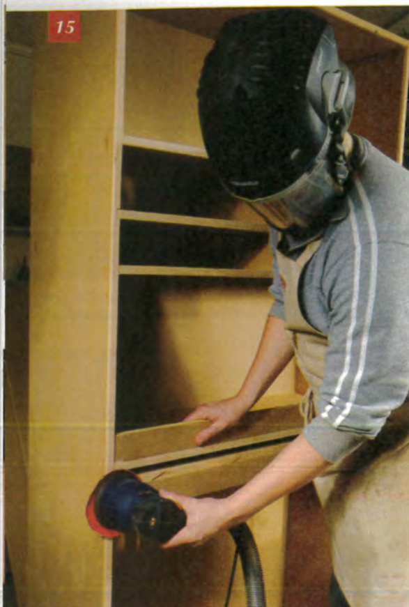
Poncez la face avant une fois que le mastic est sec.
