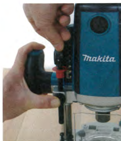
La butée de profondeur se bloque par un écrou et se libère par pression sur un bouton pour une avance rapide. Une colerette rouge sert d'index de profondeur.
