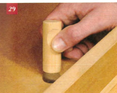
Un tourillon de 25 mm permet de bloquer la table dans la structure.
