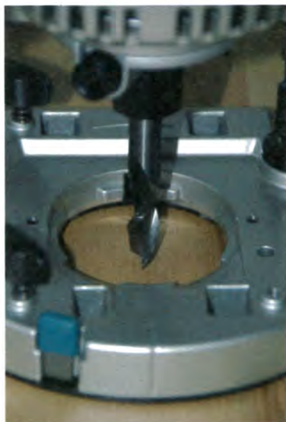
▲ La plongée de 70 mm permet l'accueil de grandes fraises.
