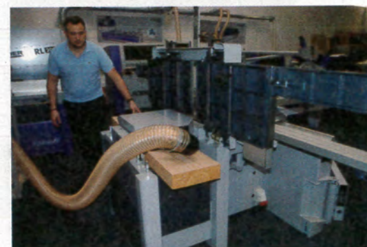
L'aspiration est remarquablement efficace et la puissance de rabotage (4 mm maximum de hauteur de passe) jamais prise en défaut.
