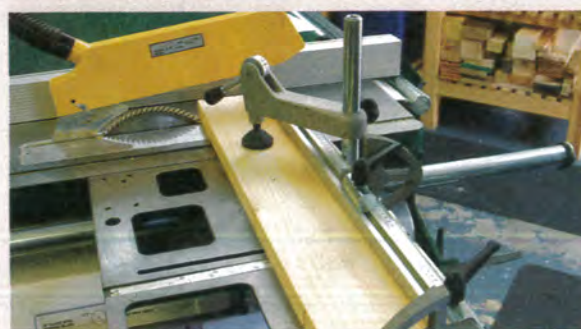
Une table coulissante offre un meilleur support et permet de régler les mises à la longueur.
