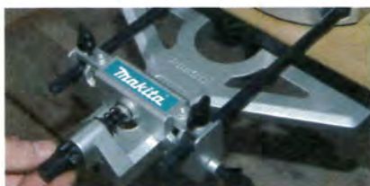
Un guide parallèle très rigide avec réglage micrométrique.
