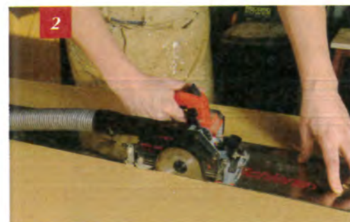
Une scie circulaire équipée d'un rail de guidage permet de faire un travail rapide et précis.
