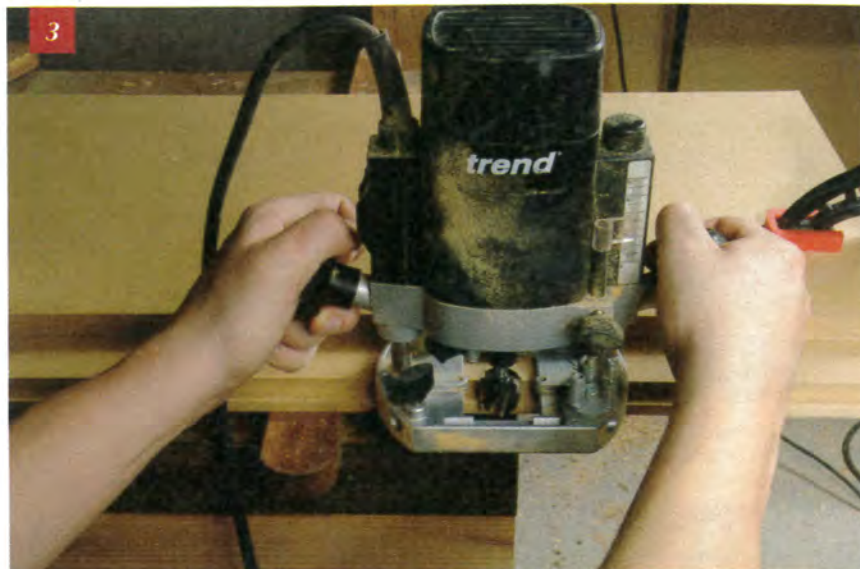
Fraisez les rainures qui accueilleront le panneau arrière sur l'arrière de la structure.
