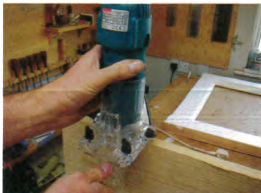
Cette petite affleureuse est suffisamment stable pour travailler correctement sur la tranche du panneau.
