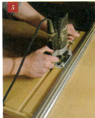
Fraisez les rainures qui accueilleront le panneau arrière sur l'arrière de la structure.
