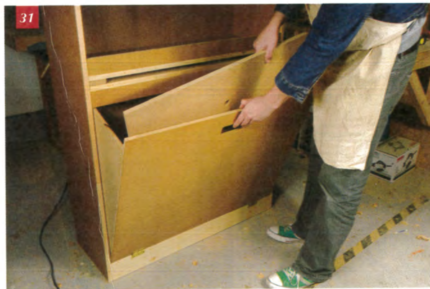
La table se range facilement dans le tiroir. Vous voudrez peut-être installer une séparation pour pouvoir y accéder facilement, même quand le tiroir est rempli avec les gabarits.
