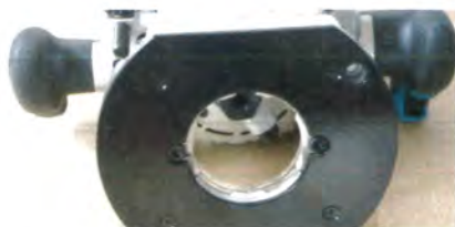
Les joues du guide parallèle coulissent pour s'approcher au plus près de la fraise.
