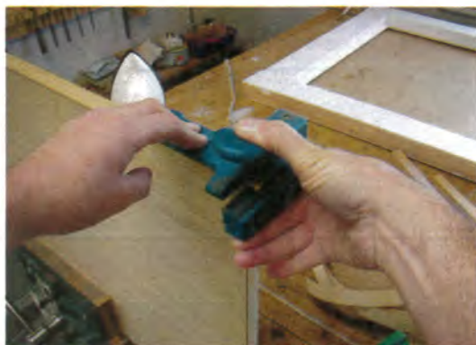
Un araseur de chant coupe en bout peut s'avérer être un investissement judicieux si vous avez de multiples éléments à préparer.
