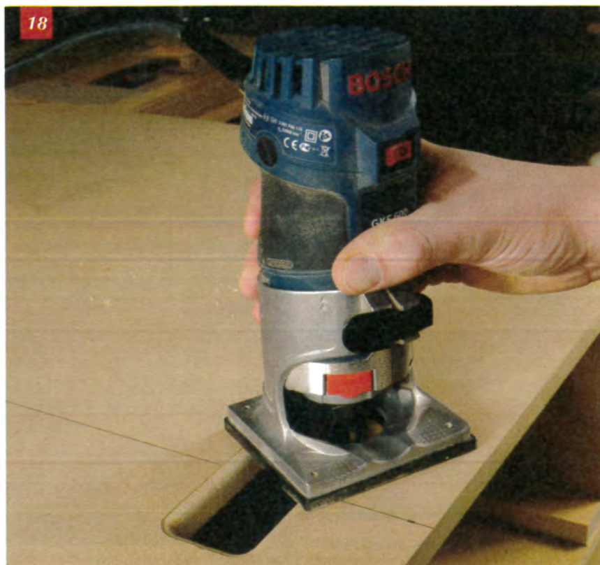
Les angles sont adoucis à l'aide d'une fraise quart-de-rond à roulement de guidage.
