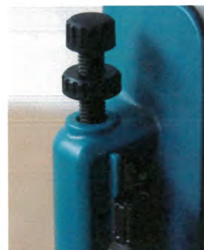
Un écrou nylon permet de limiter la hauteur de remontée : gain de temps appréciable lors des passes successives.
