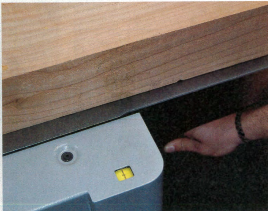
Une hauteur maximale de dégauchissage de 4 mm avec réglage de hauteur de table par parallélogramme déformable. Le système est efficace et précis, mais le levier de manœuvre est d'un accès peu confortable.
