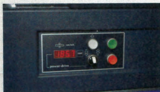
Montée de table électrique avec réglage final micrométrique et affichage digital.
