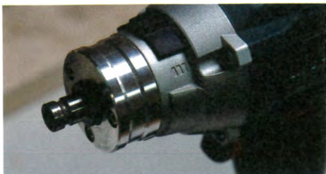
L'arbre de sortie permet le montage rapide des mandrins « Quick ».
