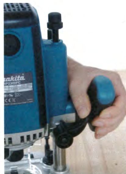
Le blocage en hauteur s'effectue avec un levier à rappel.
