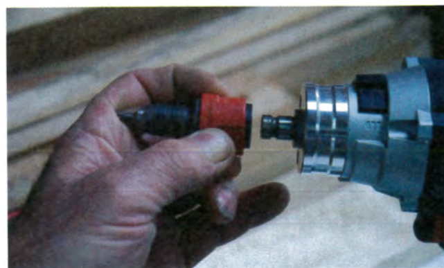
... il suffit de présenter l'embout devant la sortie d'arbre et de pousser un coup sec.
