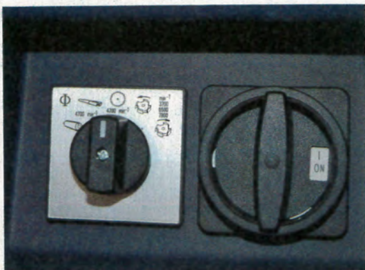
Un sélecteur de fonction avec vitesse spécifique pour le mortaisage, et double sens de rotation.
