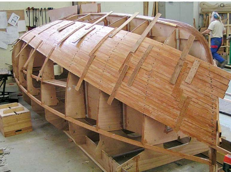
Pour une coque large, on préfère commencer au niveau du bouchain et progresser vers le haut et vers le bas. Les lattes souples agrafées sur le bordé servent à bien aligner les lattes entre-elles
