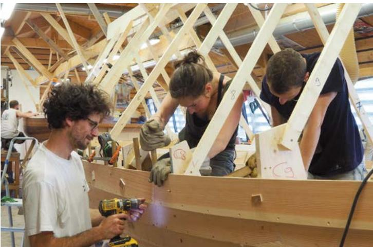
Pendant que deux personnes maintiennent fermement la membrure à l'intérieur, on perce la membrure par l'extérieur. Percer un peu en-dessous du diamètre du rivet, pour que cela tienne le temps de poser la contre-rivure. Le rivet est inséré juste après
