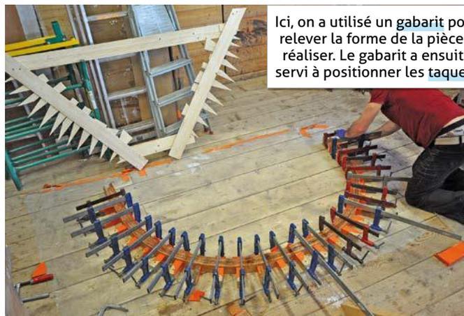
Ici, on a utilisé un gabarit pour relever la forme de la pièce à réaliser. Le gabarit a ensuite servi à positionner les taquets
