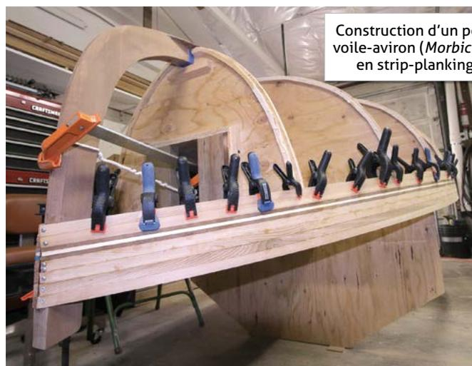
Construction d'un petit voile-aviron (Morbic 11) en strip-planking
