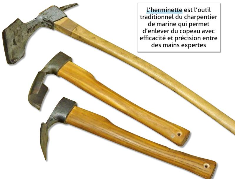
L'herminette est l'outil traditionnel du charpentier de marine qui permet d'enlever du copeau avec efficacité et précision entre des mains expertes
