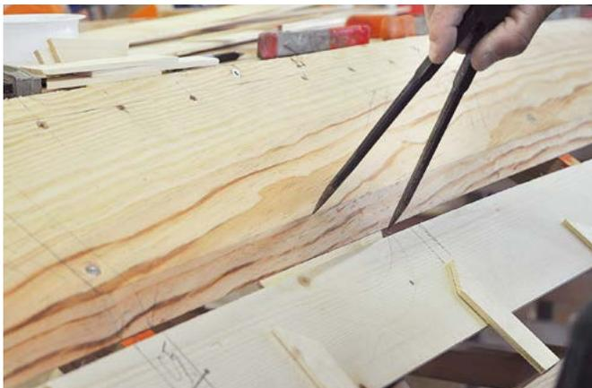
Le brochetage commence par la pose d'un assemblage de bandes souples à l'emplacement du bordage à tracer. On trace des cercles sur le gabarit à partir du chant du bordé à découper
