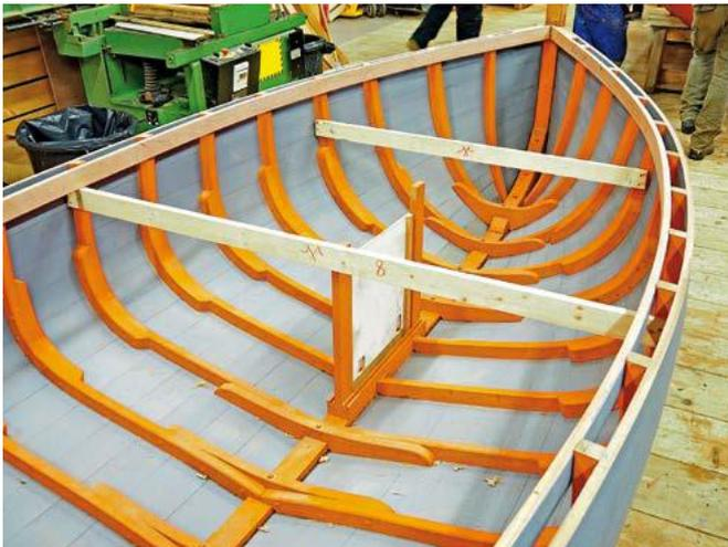
Un autre bateau après pose du bordé. Remarquez que les varangues sont sur l'avant des couples dans la moitié arrière du bateau et sur l'arrière des couples dans la moitié avant. La transition est au premier plan
