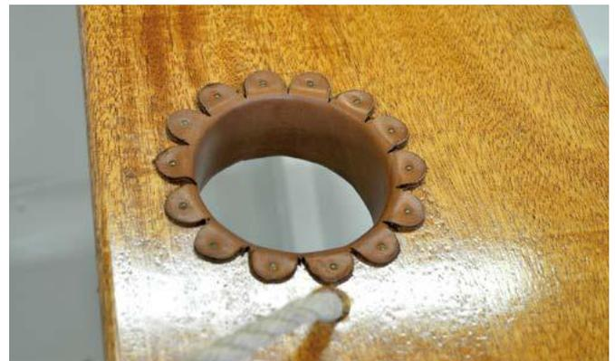
Banc de mât avec le cuir de protection et le trou au premier plan pour un cordage de voile (étarquage de bôme). Le trou de godille est muni d'un cuir sur le même principe
