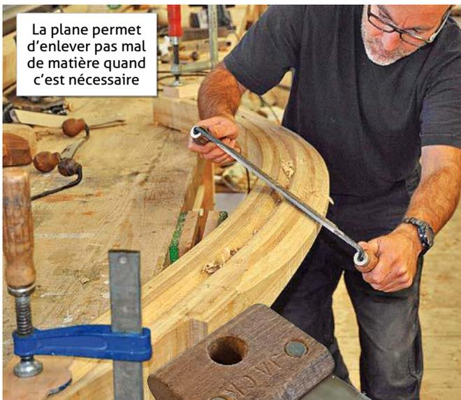
La plane permet d'enlever pas mal de matière quand c'est nécessaire
