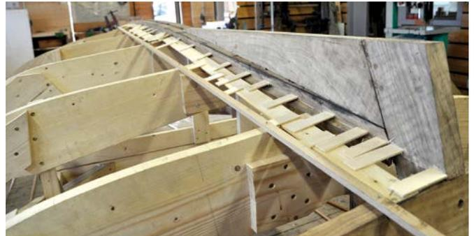
Brochetage du galbord sur un canot, en utilisant la technique des planchettes transversales avec colle thermofusible
