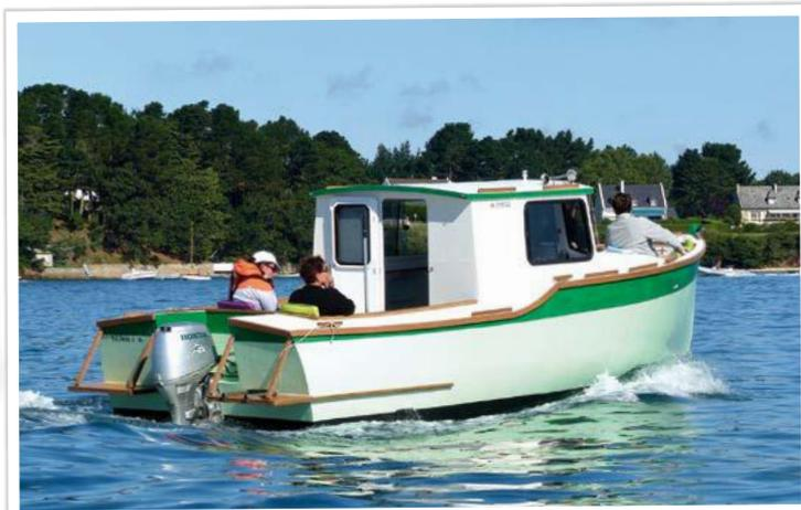
*Koulmig 23*, construction amateur avec un bordé à bouchain et bois moulé de contreplaqué de bouleau.
