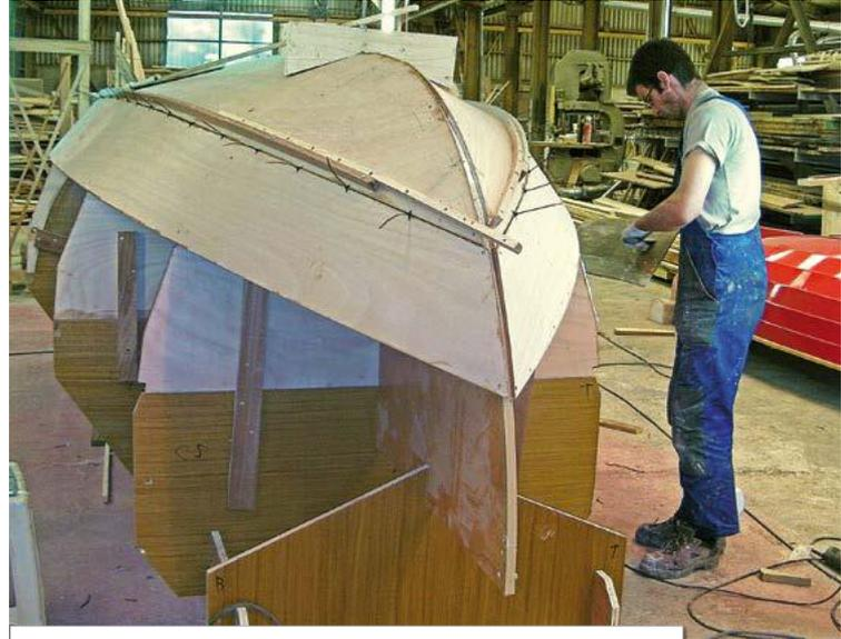
Réalisation d'un Lilou. Des lattes provisoires ont été vissées pour un meilleur lissage de courbure
