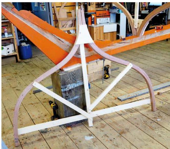
La membrure complète est assemblée avec au moins une traverse de maintien temporaire, plus pour des membrures assez grandes. C'est d'ailleurs une façon de compenser le relâchement des pièces et, bien souvent, de ne pas s'en préoccuper.
