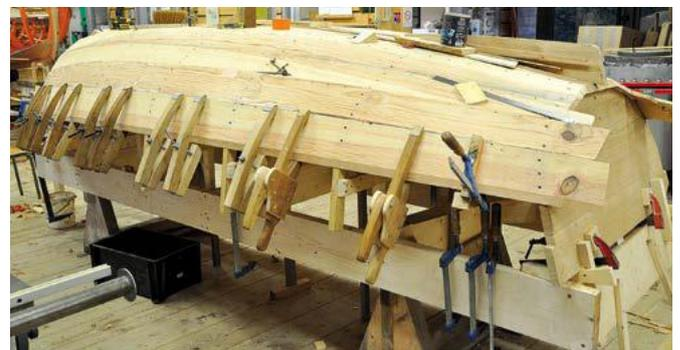
Les canaps sont un outil essentiel lors d'une construction à clin pour maintenir le joint serré pendant la pose des rivets
