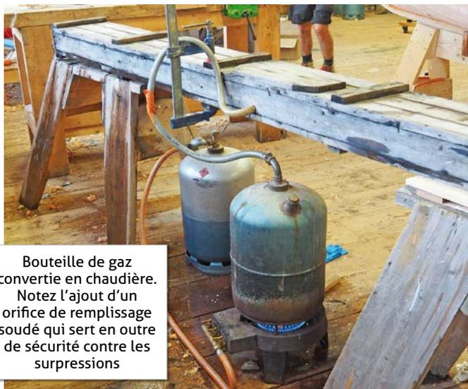
Bouteille de gaz convertie en chaudière. Notez l'ajout d'un orifice de remplissage soudé qui sert en outre de sécurité contre les surpressions
