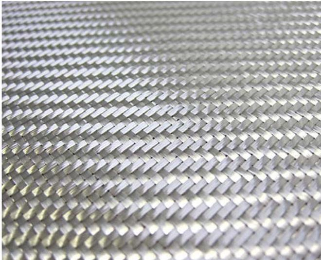
Les tissus de verre pour stratification (ici un **sergé**) sont conçus pour se déformer facilement et épouser les formes d'une coque de bateau. Tout le contraire d'un tissu à voile qui doit être aussi indéformable que possible !
