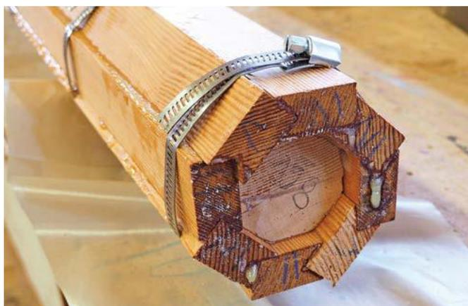
La meilleure technique pour réaliser un mât creux est celle du « bec d'oiseau ». Chaque latte, de largeur variable, est travaillée à la toupie pour réaliser le profil qui ressemble à un bec d'oiseau bien ouvert
