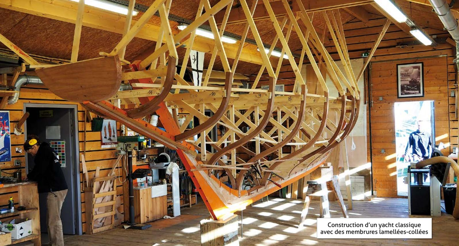
Construction d'un yacht classique avec des membrures lamellées-collées
