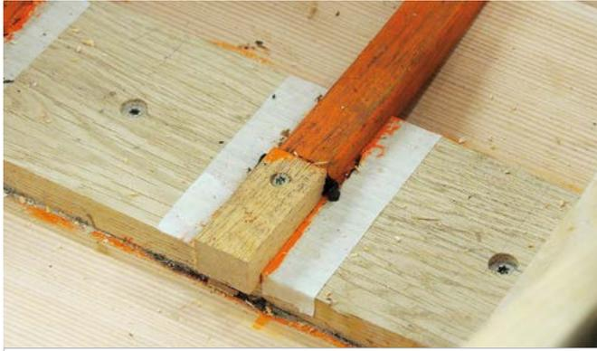
Une butée provisoire est vissée pour poser la première demi-membrure. Noter qu'il reste un petit espace sous la membrure, le long de la quille, qu'on appelle anguillier, qui permet à l'eau de circuler dans les fonds
