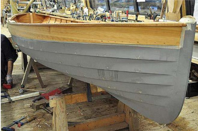
À l'aboutissement sur l'étrave, la surface extérieure des bordés doit se retrouver dans le même plan
