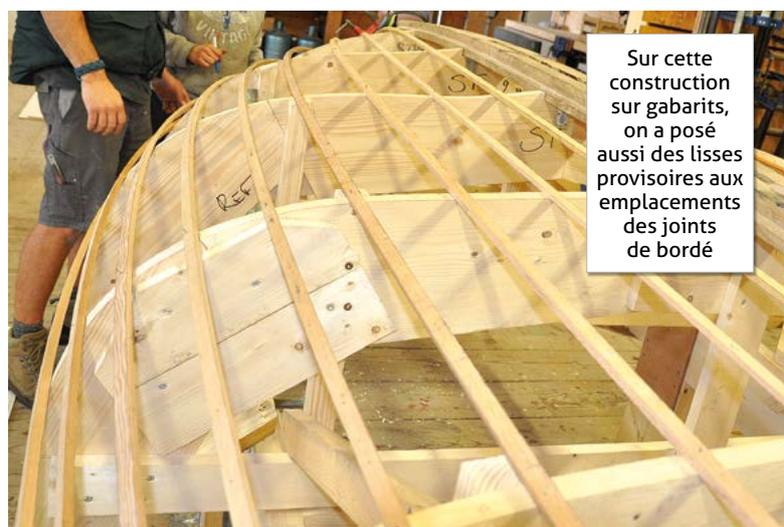
Sur cette construction sur gabarits, on a posé aussi des lisses provisoires aux emplacements des joints de bordé
