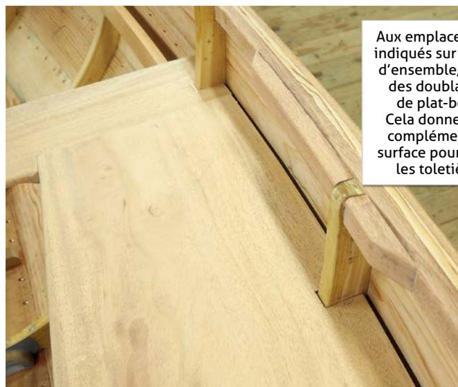
Aux emplacements indiqués sur le plan d'ensemble, poser des doublantes de plat-bord. Cela donnera un complément de surface pour poser les toletières
