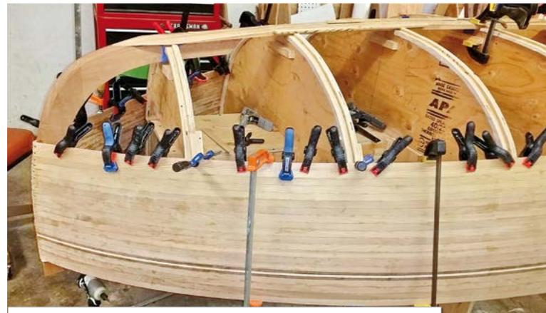
L'alignement des lattes est ici assuré par des pinces à ressort, tandis que le serrage est fait avec des longs serre-joints
