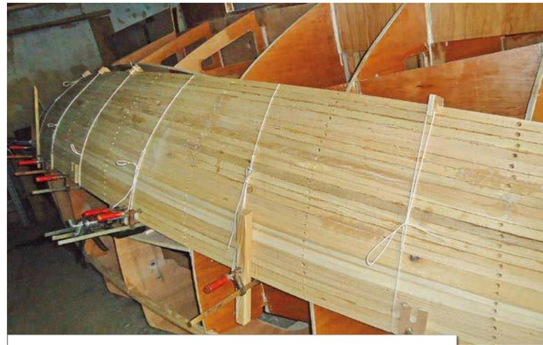
Avant l'apparition des époxy, on clouait les lattes sur chant dans la précédente. On peut maintenant s'en dispenser à condition de trouver une méthode alternative pour serrer les lattes : simples ficelles, sangles à cliquet, sandows pour coques légères...
