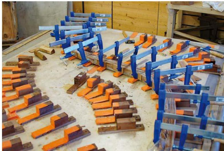
Les taquets sont eux-mêmes vissés à des lattes plus minces pour éviter le contact direct avec le panneau support. Il peut aussi être nécessaire d'ajouter quelques serre-joints pour bien plaquer le faisceau de lames contre le support et/ou aligner les lames
