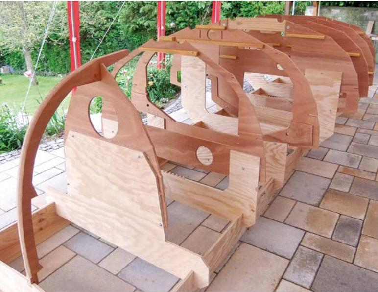
*Jewell*, plan de ma création, en construction à partir d'un kit. Le bordé à clin sera posé sur une structure croisée de cloisons longitudinales et transversales. Le chantier support fait partie du kit et permet de monter l'ensemble sans sortir son mètre !
