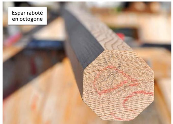
Le reste se fait à l'œil sans tracé : passer à un polygone à 16 côtés, puis faire disparaître les facettes. On gagne du temps en utilisant un rabot électrique. De toute façon, les phases finales se font au rabot manuel, de préférence de bonne longueur (varlope) puis au papier abrasif en travaillant transversalement si on veut une finition bien ronde (tenir le papier par les deux bouts en faisant un demi-tour sur l'espar), puis longitudinalement.
