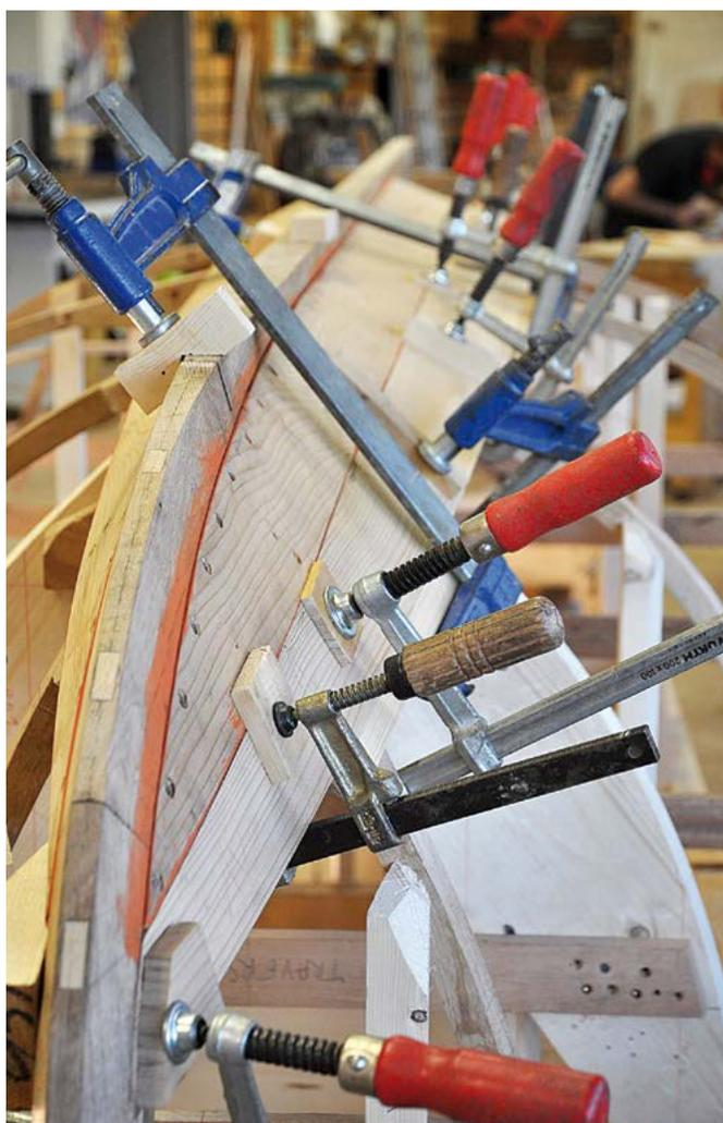
Le bordage est maintenu en place provisoirement par des serre-joints, contre les membrures d'une part, contre le bordage précédent d'autre part
