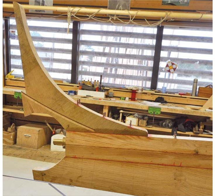
Les bateaux à moteur fixe imposent de prévoir une découpe, dite « cage », pour l'hélice et un passage pour le tube de ligne d'arbre. Ici, la ligne d'arbre est prise en sandwich entre deux pièces de bois qui ont été creusées, ce qui évite de faire un long perçage délicat
