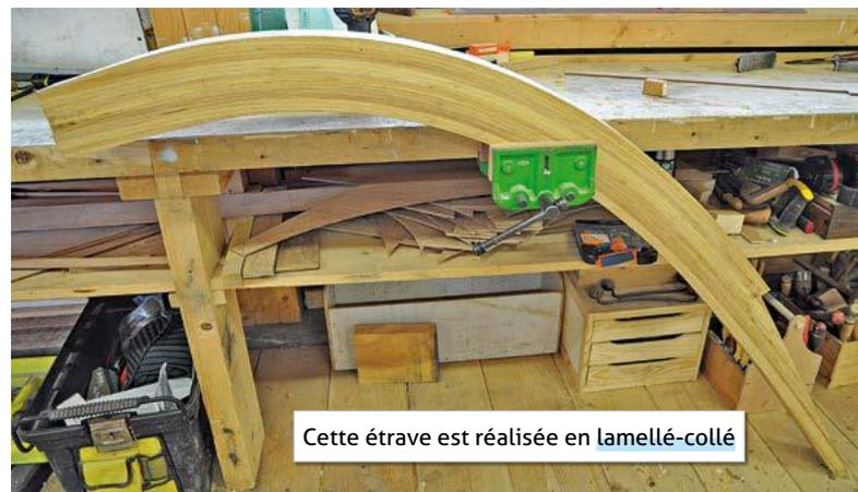
Cette étrave est réalisée en lamellé-collé
