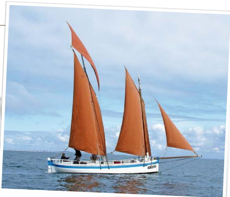
*Jeanne-J*, réplique d'une chaloupe de Noirmoutier, construite en 2008 par le Chantier des Ileaux en construction traditionnelle, mais avec utilisation d'un tracé numérique sur calque polyester des principales pièces de charpente.
