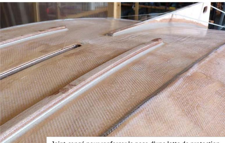
Joint-congé pour renforcer la pose d'une latte de protection en bois massif. À l'intérieur du bateau, de tels joints facilitent le nettoyage du bateau (photo Arwen Marine)
