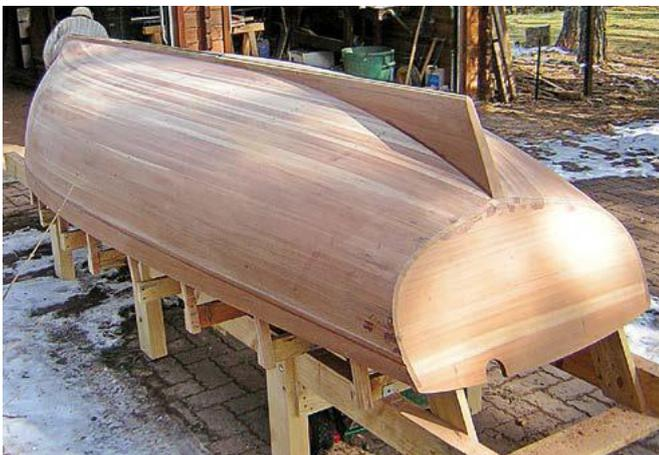
En général, on pose le bordé sur une structure totalement intérieure. Les éléments extérieurs, fausse-étrave, fausse-quille, talon, sont ajoutés après et éventuellement lamellés-collés in-situ
