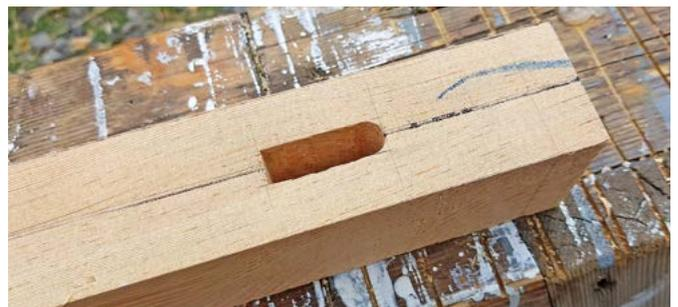
Il faut souvent une mortaise en tête de mât ou de bout-dehors pour un réa (la roue qui permet la rotation du cordage ou du câble dans une poulie ou dans un espar). C'est plus facile à faire s'il y a un joint de collage à l'axe
