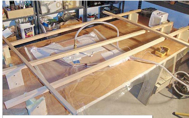
Des techniques de collage sous vide permettent une meilleure application des panneaux de grande dimension
