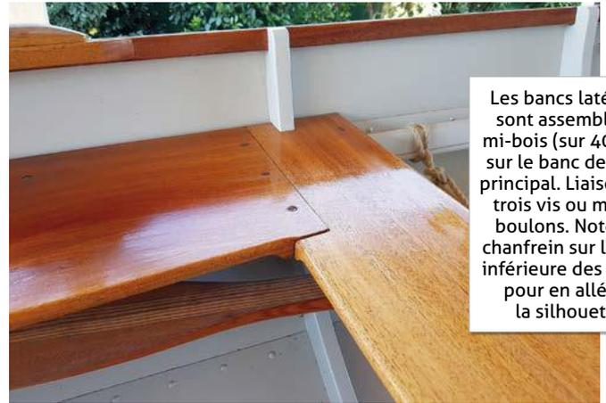
Les bancs latéraux sont assemblés à mi-bois (sur 40 mm) sur le banc de nage principal. Liaison par trois vis ou même boulons. Noter le chanfrein sur la face inférieure des bancs pour en alléger la silhouette
