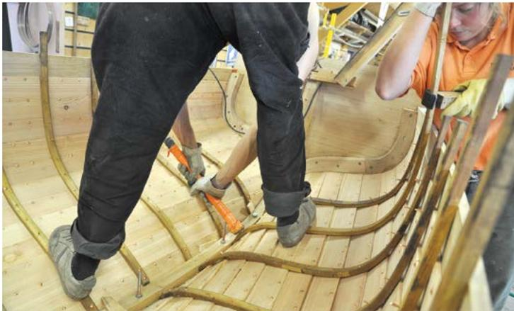
Le charpentier qui est à l'intérieur force la membrure contre la quille. L'autre charpentier utilise un outil pour bien plaquer la membrure contre le bordé
