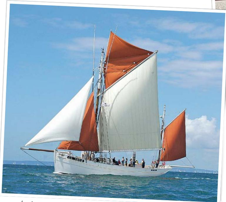
*Biche*, dernier thonier de l'île de Groix, totalement reconstruit par le chantier du Guip en 2009-2010. La charpente était en très mauvais état, au point que le bateau était fortement déformé. Un relevé des formes par photogrammétrie et des mesures de détails de charpente ont permis de reconstituer les formes originales.
