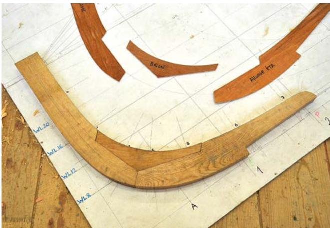
Quand le brion (zone de transition entre quille et étrave) est assez doux, comme sur ce canot, il faut multiplier les pièces de charpente axiale
