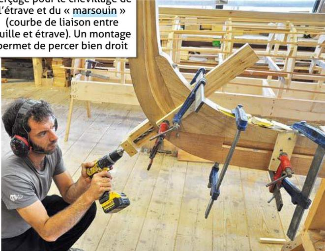
Rassurez-vous : *Mesker*, le bateau que nous allons construire pas-à-pas, n'a pas de quille ! Elle est remplacée par une *sole*, c'est-à-dire un fond plat, plus facile à réaliser et qui facilite aussi les mises à l'eau. Il n'a pas non plus de râblure mais un simple chanfrein sur l'étrave (une fausse-étrave rapportée venant couvrir l'extrémité des bordés).
