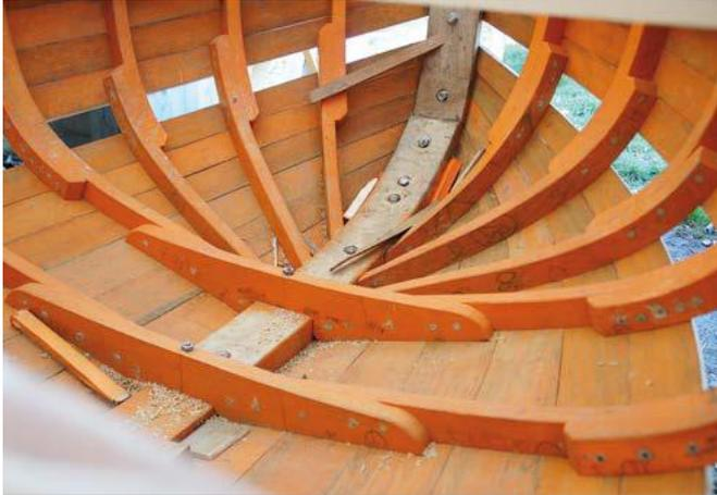
À l'avant, on est souvent amené à monter des membrures dévoyées de façon à être dans un plan à peu près perpendiculaire au bordé
