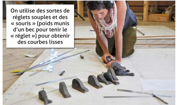
On utilise des sortes de réglets souples et des « souris » (poids munis d'un bec pour tenir le « réglet ») pour obtenir des courbes lisses
