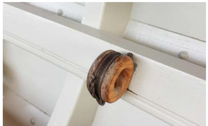
Un margouillet de chaque bord sert à l'écoute de foc. Il est ligaturé à la serre des bancs pour permettre de modifier sa position (donc ne pas percer la serre comme sur cet exemple!). Voir Plan 09 pour sa position
