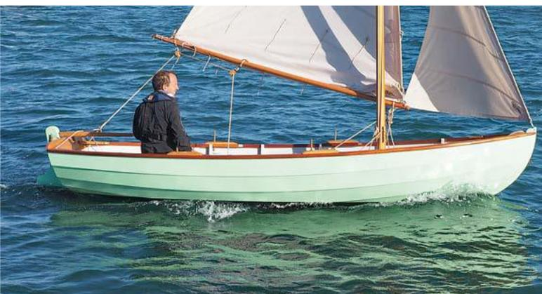
Une extrémité de l'écoute de grand-voile coulisse sur la pantoire (cordage reliant les deux courbes de tableau). Elle revient ensuite aux pieds du barreur, avec un taquet coinçant sur platine orientable, non visible bien sûr.
