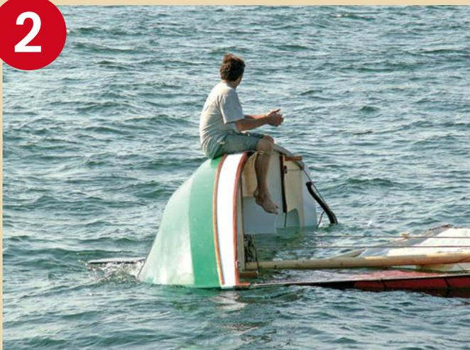
Avec de la chance, votre bateau a une dérive métallique verrouillable en position basse, un mât creux et il reste à l'horizontale. Il faut vraiment essayer d'enfoncer le mât dans l'eau avant de conclure que le bateau n'ira pas plus loin. Le redressement est alors assez facile
