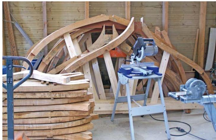
Membrures de *Jeanne J*, réplique d'une chaloupe de Noirmoutier (Chantier des Ileaux). Les membrures sont tracées, découpées, équerrées puis assemblées de façon très précise à partir du tracé du bateau
