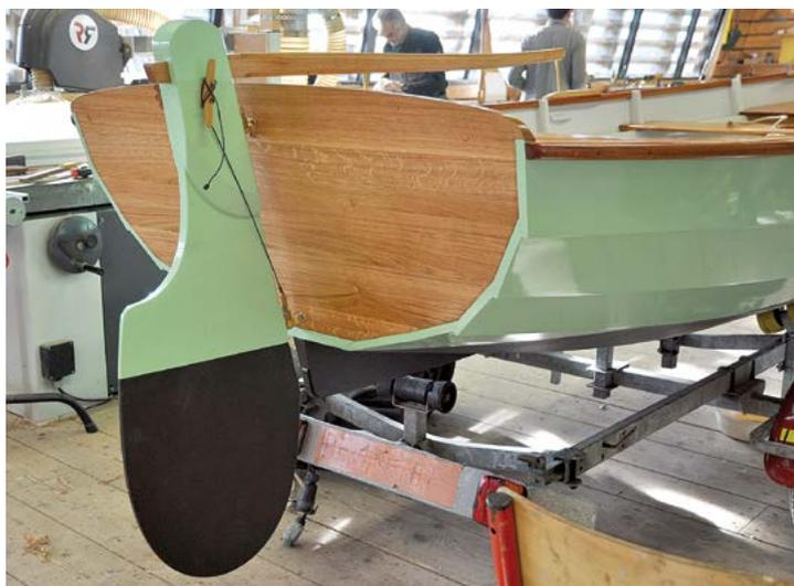
Le petit cordage traverse le fémelot inférieur (partie femelle de la ferrure d'un gouvernail) pour guider le gouvernail dans l'aiguillot inférieur. Il se tourne sur le taquet, ce qui l'empêche de sortir. Pensez à libérer le cordage lors d'une arrivée de plage
