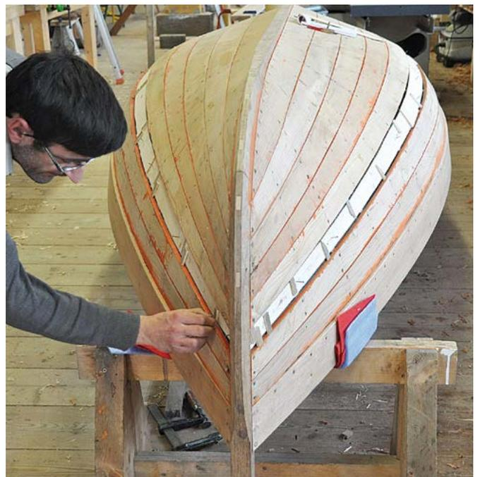
Brochetage de la clore sur cette jolie coque à franc-bord. Le contour du bordage est matérialisé par des planchettes transversales. Dans le cas de la clore, le brochetage se fait sur la face externe, l'équerrage étant alors en maigre
