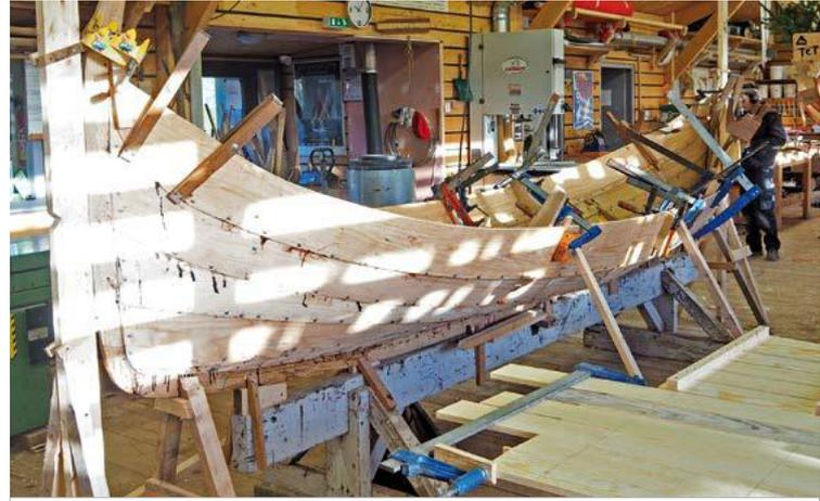
Ce faering de Bindal (Norvège) est construit par l'école de construction navale Skol ar Mor selon la technique nordique traditionnelle, à l'endroit et bordé d'abord. Une poutre au-dessus permet de placer les accores pour contraindre la forme du bordé
