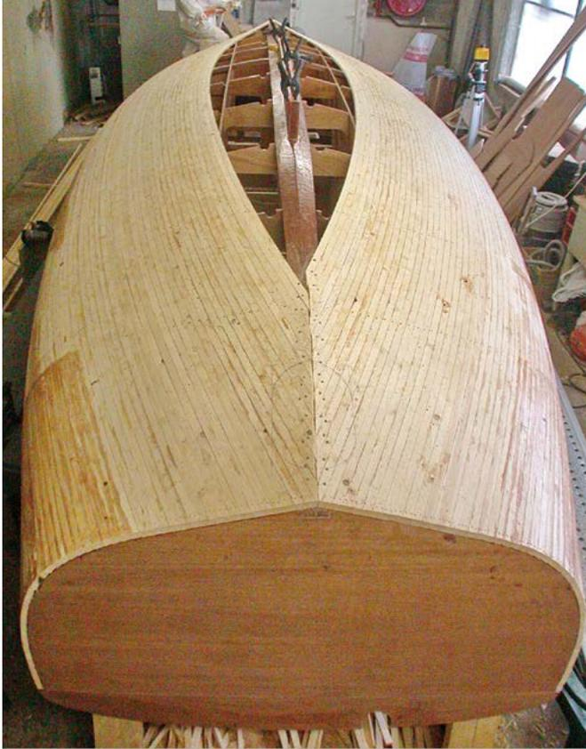
Sur une coque de largeur modérée, on pose les lattes à partir du plat-bord et on comble à la fin l'espace en fuseau le long de la quille. Cela permet une jolie finition vernie de la coque, surtout si on a commencé par poser une vraie préceinte de forme traditionnelle qui donne une base rigide pour poser les lattes
