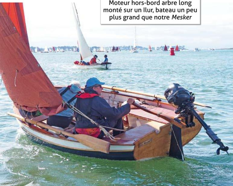
Une très petite puissance suffit, c'est-à-dire un moteur d'annexe de 2 à 3 ch. Si le moteur est utilisé de façon fréquente, on peut monter à 4 voire 5 ch, mais les moteurs de 5 ch pèsent déjà plus de 25 kg et sont de maintenance délicate. Mercury-Tohatsu fait un moteur de 3,5 ch qui est un bon compromis. Il est aussi possible d'utiliser un moteur électrique, le meilleur étant à mon sens le « Travel » de Torqeedo.
