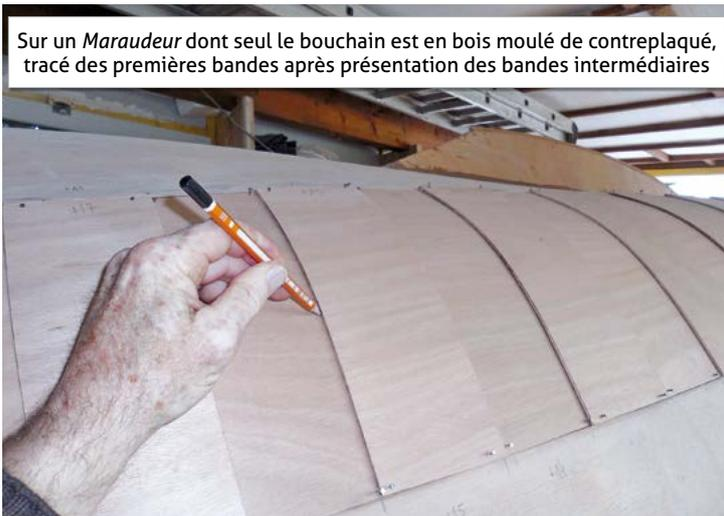
La structure du bateau, en général en cloisons de contreplaqué, reçoit des lisses en bois massif de section carré qui vont servir de moule pour les bandes de contreplaqué. Au point de transition entre bordé de fond et les hauts en bois-moulé, on pose une lisse de largeur double.
