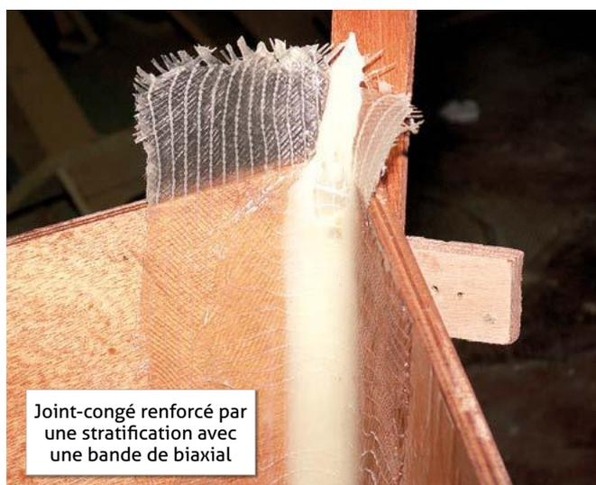
Joint-congé renforcé par une stratification avec une bande de biaxial
