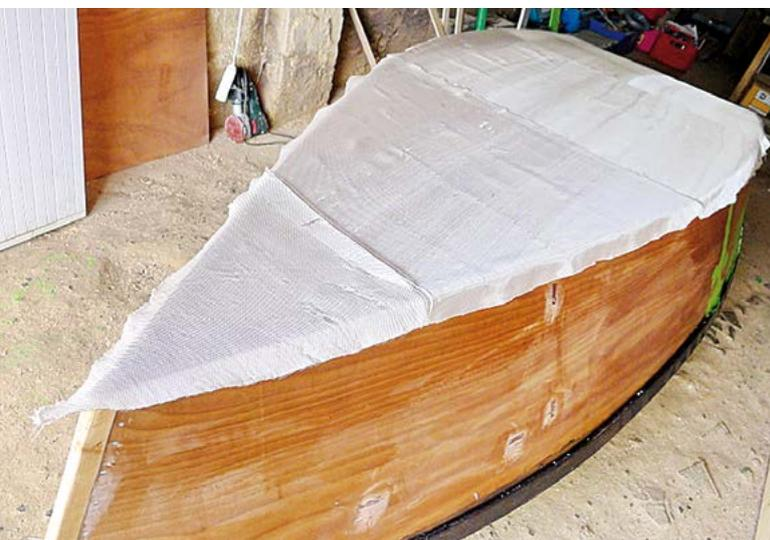
Plusieurs pièces de tissus sont ici juxtaposées, avec un petit recouvrement en écaille de poisson, pour stratifier les fonds de cette plate
