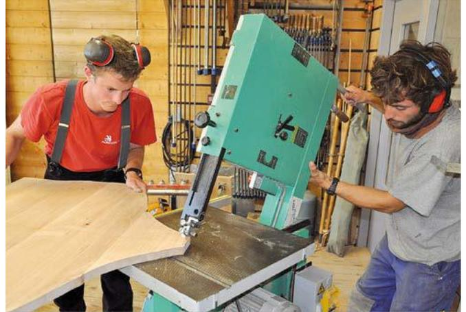
La scie à ruban à plateau inclinable est l'outil quasi indispensable pour découper les membrures franches comme d'autres pièces, ici un tableau. Autrefois on utilisait une scie à chantourner, ayant une lame de faible largeur
