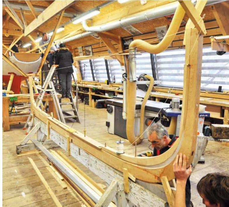
Charpente axiale d'un voilier ouvert, d'abord assemblée à plat sur le sol, puis dressée sur le chantier. Notez la découpe pour le passage de la dérive
