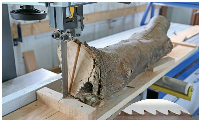
Si vous ne pouvez pas profiter de telles lames sur votre machine, je vous propose une solution : supprimer des dents. Oui, car cela va permettre une meilleure évacuation des copeaux et donc limiter l'échauffement, et c'est tout à fait possible, à la meule ! Sur la photo ci-contre, j'en ai supprimé 2 sur 3, pour garder l'avoyage (inclinaison alternative des dents). Ainsi modifiée, cette lame triple sa capacité de coupe !
