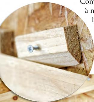
Comme pour les outils à main, ces montages d'usinage sont rangés les uns à côté des autres en utilisant des *french cleats*. Cependant, ceux-ci sont beaucoup plus simples. La plupart du temps, il s'agit d'un simple tasseau coupé à 45° recevant tantôt un domino rallongé tantôt une simple vis.
