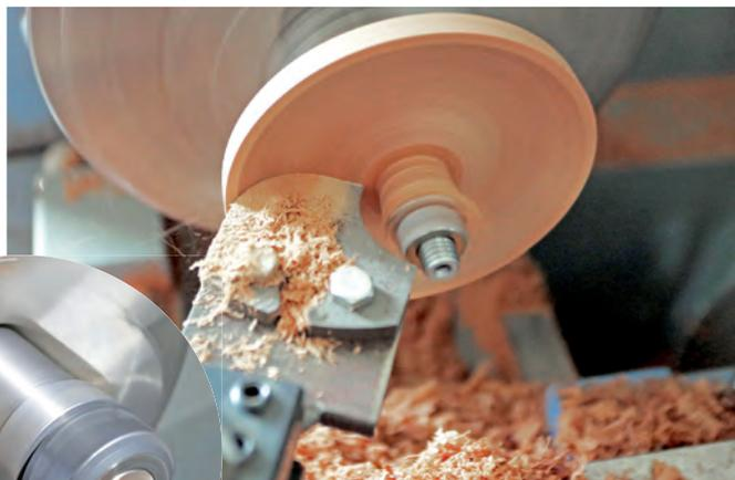
Je vous ai dit que j'étais passionné de la lutherie et que mon tour me servait dans ce domaine : la photo suivante montre le perçage du passage de la vis du bouton de serrage d'un archet baroque. La baguette doit passer au travers de la broche. Pour cet usinage, j'ai dû tourner un mandrin spécifique, qui reçoit des pinces ER32.
