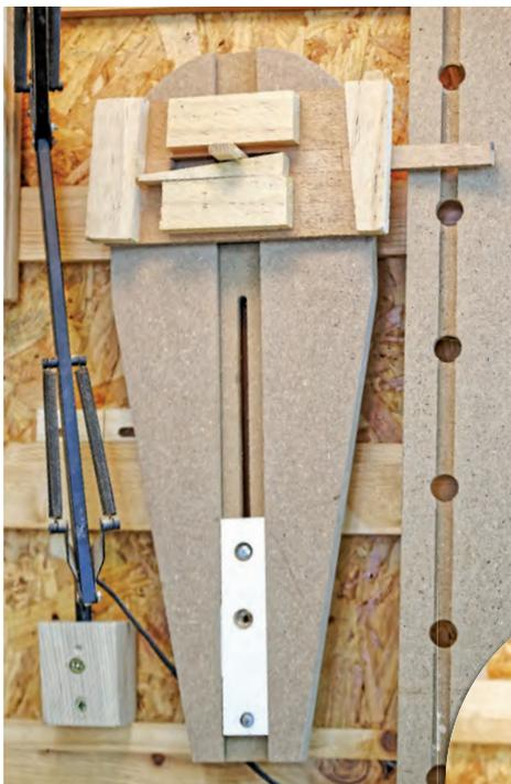
Les serre-joints spécifiques, dédiés à l'immobilisation des montages d'usinage sont également rangés sur ce pan de mur.
