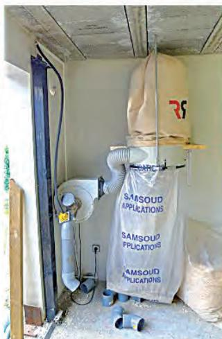
On pourrait consacrer un livre entier au dimensionnement du réseau d'aspiration, les longueurs, les coudes, les réductions de diamètre, l'état de surface des tuyaux... Tous ces éléments engendrent des pertes de charge et donc une diminution d'efficacité. C'est un sujet complexe ! malgré mon cursus scientifique, ici, je n'ai pas cherché à faire des calculs, mais simplement appliqué quelques principes de bon sens :
