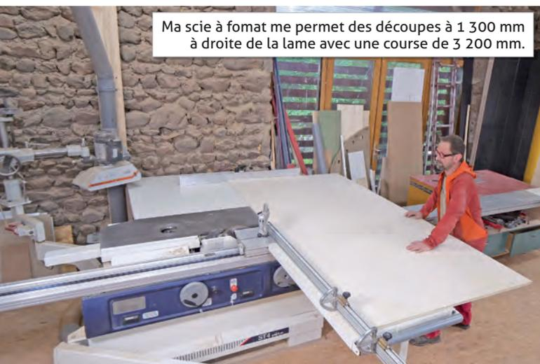
Ma scie à format me permet des découpes à 1 300 mm à droite de la lame avec une course de 3 200 mm.
