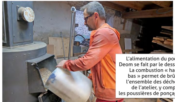
L'alimentation du poêle Deom se fait par le dessus. La combustion « haut-bas » permet de brûler l'ensemble des déchets de l'atelier, y compris les poussières de ponçage.
