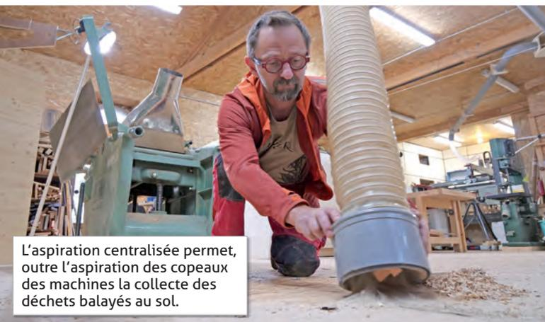
L'aspiration centralisée permet, outre l'aspiration des copeaux des machines la collecte des déchets balayés au sol.
