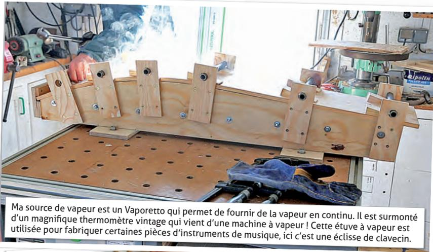
Ma source de vapeur est un Vaporetto qui permet de fournir de la vapeur en continu. Il est surmonté d'un magnifique thermomètre vintage qui vient d'une machine à vapeur ! Cette étuve à vapeur est utilisée pour fabriquer certaines pièces d'instruments de musique, ici c'est une éclisse de clavecin.
