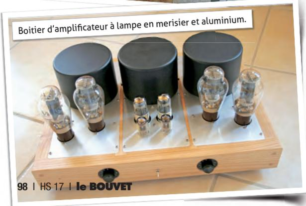
Boîtier d'amplificateur à lampe en merisier et aluminium.
