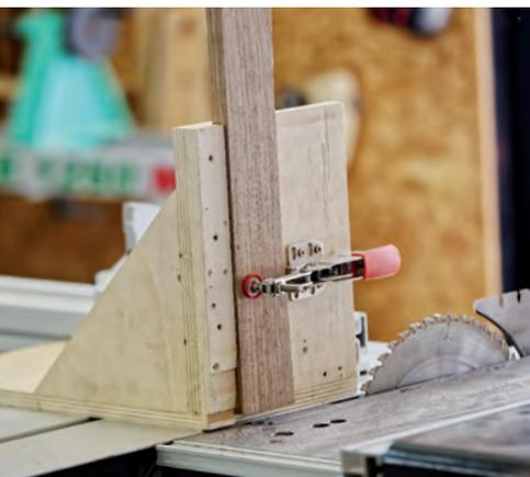
Prenons également un temps pour détailler certains accessoires dont je ne saurais plus me passer. Le premier est directement inspiré des Anglo-Saxons, il s'agit d'un montage fixé sur le chariot de la scie permettant de maintenir une pièce à la verticale. Il se fixe sur le chariot par l'intermédiaire d'un simple lardon glissé dans une rainure en T. Je ne vais
