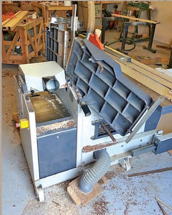
*tables s'ouvrant encore en papillon. Pourtant, elles le font vers l'intérieur, plus besoin de les contourner, ce qui réduit grandement le nombre de kilomètres parcourus à pied durant l'opération de rabotage ! Côté toupie, c'est dans la machine que la différence se fait : une poulie étagée permet de faire varier la vitesse de 2 900 à 7 500 tr/min, ce qui autorise de monter une plus large gamme d'outils.*
