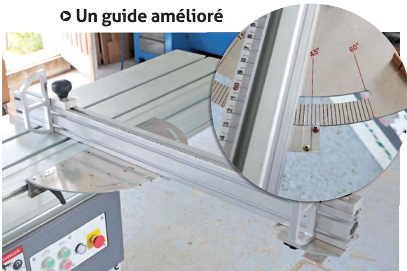
Le guide additionnel d'origine de ma scie circulaire stationnaire ne correspondait pas à ce que j'attends de ce type d'accessoire (comme l'absence de butées). Je m'en suis donc fabriqué un nouveau ! Il est basé sur l'utilisation d'un profilé en aluminium de 40 x 80 mm. Entièrement sortie, la rallonge télescopique permet de mesurer 1 850 mm. Les découpes et les gravures (y compris celles de la règle) ont été faites à la fraiseuse numérique, ce qui en fait un guide extrêmement précis !
