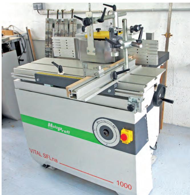
Ma toupie est une Holzprofi qui date d'une quinzaine d'années. Elle n'est plus produite aujourd'hui. C'est une machine de taille moyenne, avec un arbre de Ø 30 mm inclinable, un puits de Ø 180 mm et un carter permettant un passage de 220 mm. Elle est dotée d'un large chariot à billes de 1 000 mm de course à ras de puits. Le guide à barrettes est d'origine, et je lui ai ajouté un entraîneur.
