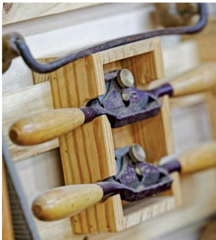
Pour les ciseaux à bois, le support vertical n'est plus utile, un cadre vient compléter le support et assure la fonction d'antibasculement. C'est aussi le cas pour les wastringues.
