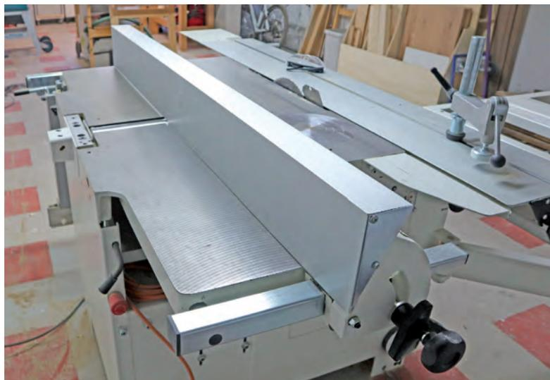
Je n'ai pour l'heure pas réalisé d'amélioration sur ma combinée. Les tables de dégauchisseuse ne sont pas très longues, mais le fait qu'elles soient asymétriques me permet de dégauchir des pièces de 2 m, si elles ne sont pas trop voilées. **J'ai juste surélevé la machine avec des cales pour la mettre à ma taille (1,85 m) et pour éviter que les vibrations ne se transmettent à la dalle et réveillent les enfants pendant leur sieste.**
