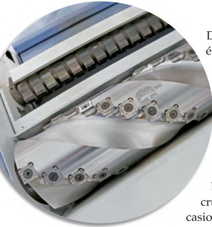
Dernière amélioration en date : j'ai équipé cette machine d'un arbre hélicoïdal à plaquettes carbure, plus précisément d'un modèle à trois spires en pas à droite garni de 51 plaquettes. J'avoue avoir en quelque sorte succombé à une mode, mais je ne le regrette absolument pas !
