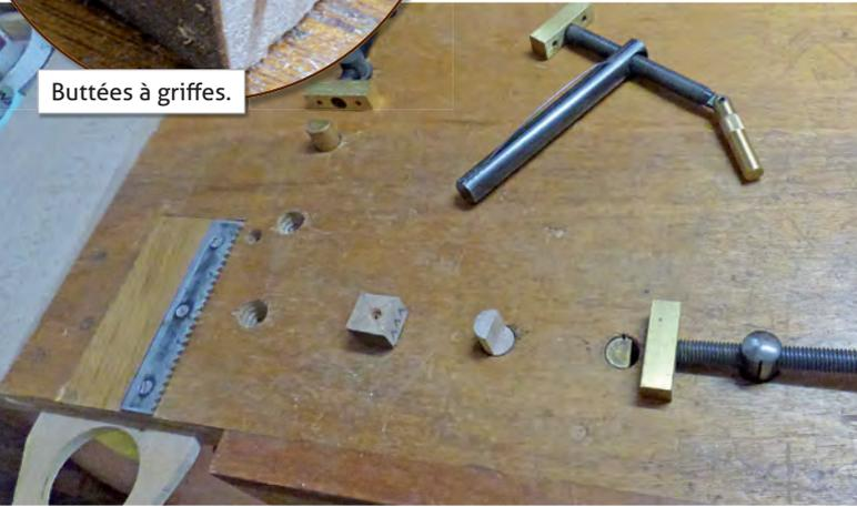
L'indispensable presse avant d'établi trône au milieu de l'établi. La mienne est une Record. Il m'arrive de lui associer deux tasseaux rainurés dotés de cales réglables pour maintenir les panneaux devant être replanis ou poncés.
