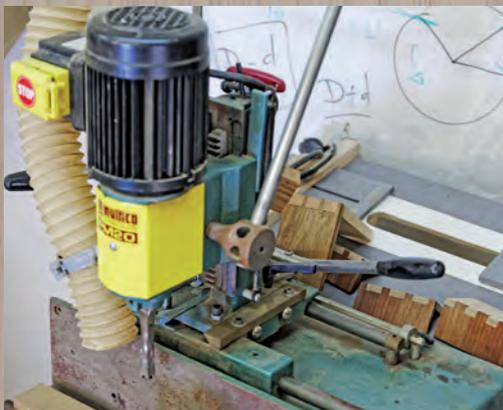
• Contrairement aux mortaiseuses horizontales, l'ergonomie de travail est excellente. Les pièces sont immobilisées suffisamment haut pour avoir une bonne visibilité sur le tracé, les pointes acérées du bédane permettent un ajustement extrêmement précis des butées. D'ailleurs, pour les abouts, il n'est pas forcément nécessaire d'en utiliser, on peut se fier au regard un peu comme on le ferait en travaillant avec des outils à main.
