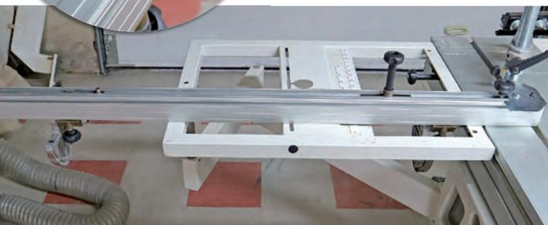
Les angles sont aussi réglés grâce à des butées : j'adore ! Par contre, le guide parallèle dispose de réglage avec un filetage calibré pour corriger une éventuelle erreur d'inclinaison, mais il n'y a rien pour déplacer la règle graduée qui le supporte. Celle-ci est arrivée d'usine décalée de 1,4 mm (énorme selon moi) et il m'a fallu enlever les graduations pour recoller une règle à la bonne place. Dommage...
