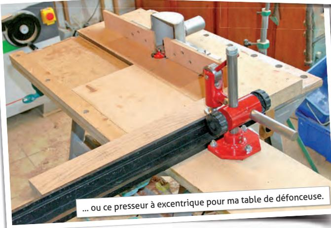
... ou ce presseur à excentrique pour ma table de défonceuse.
