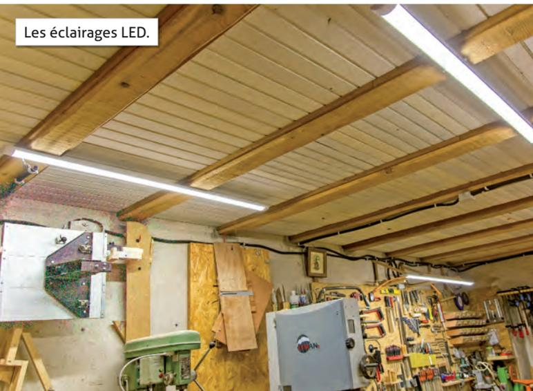
et surtout avec très peu de zones d'ombre. **En matière d'éclairage, des sources lumineuses de grande taille, et plurielles, sont préférable à un seul point de forte intensité, justement afin d'éviter les zones mortes.** Les néons ont un défaut : les consommables (ballast, starter...) sont contraignants. Par la suite, je les ai remplacés par des réglettes LED de même dimension, mais de plus forte intensité, le seul inconvénient étant une lumière très blanche.
