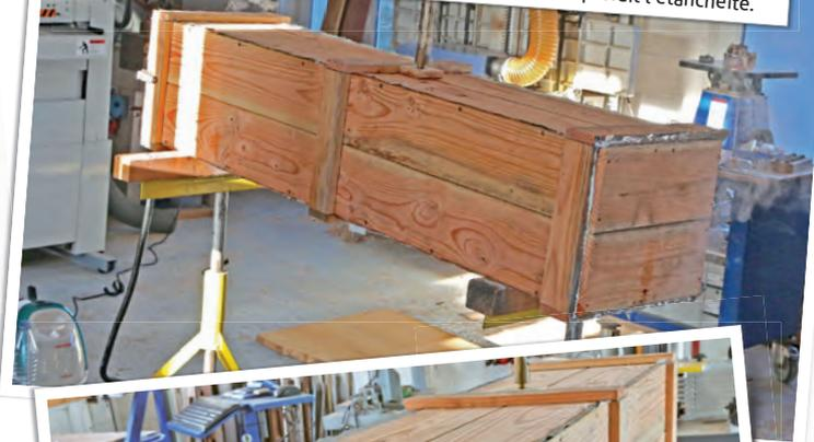
Voici une réalisation avec du bois cette fois. Il s'agit de presses à mords parallèles. Pour les fabriquer, j'ai utilisé des tiges filetées M12 pas à droite et pas à gauche soudées l'une à l'autre.
