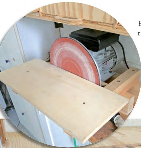
En dessous des placards de rangements, sur la droite j'ai créé un rangement pour mon outillage de toupie et les lames de scie circulaire, en dessous prends place mon lapidaire, fabriquer rapidement à l'aide d'un moteur électrique et de quelques chutes de bois...
