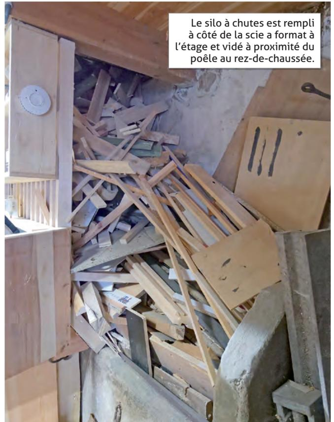
Le silo à chutes est rempli à côté de la scie à format à l'étage et vidé à proximité du poêle au rez-de-chaussée.
