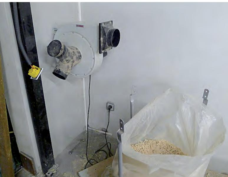
J'ai placé l'aspirateur dans le coin proche de la porte, immédiatement à côté de la combinée. C'est un petit modèle mobile monté sur roulettes, que j'ai démonté et fixé au mur. Le réseau d'aspiration est partagé en deux : une partie aérienne fixée au plafond dessert la toupie et la scie à ruban, tandis que la partie souterraine dessert la scie et la dégauchisseuse.
