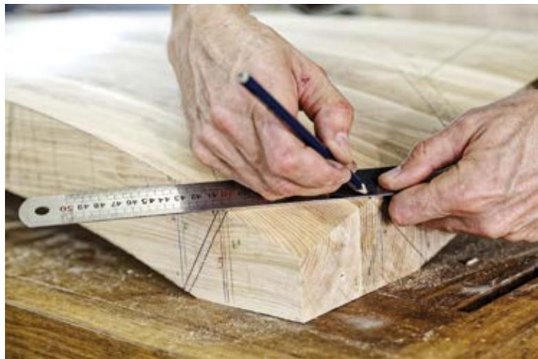
En théorie, l'intersection d'une ligne de niveau avec une génératrice nous donne un point précis. En pratique il suffit que la règle souple utilisée ne soit pas parfaitement plaquée pour que nos lignes aient une légère inflexion ! Il est donc prudent de vérifier tout ce qui peut l'être. Une pige placée verticalement sur le noyau peut par exemple permettre de vérifier que les lignes de niveau sont précises.
