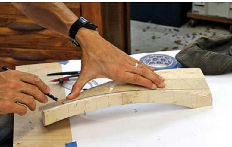
Pour tracer le chant inférieur, nous allons procéder exactement de la même manière que lorsque nous avons tracé l'élévation. Avec un compas, nous allons mesurer sur l'élévation (ou sur le développement), la hauteur de notre pièce le long d'une génératrice. Il suffit ensuite de reporter cette mesure sur les génératrices tracées sur la face convexe. Une fois de plus, vous pouvez vérifier la précision de votre tracé en y plaçant une règle souple.
