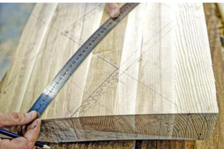
Les entailles de marche et de contremarche étant faites, nous allons exécuter les coupes à crochet. Je ne m'attarde pas sur cette étape, spécifique à mon escalier. Notez par contre que ces coupes sont ajustées en plaçant les différents éléments sur un moule, qui reprend la forme de la vue en plan.
