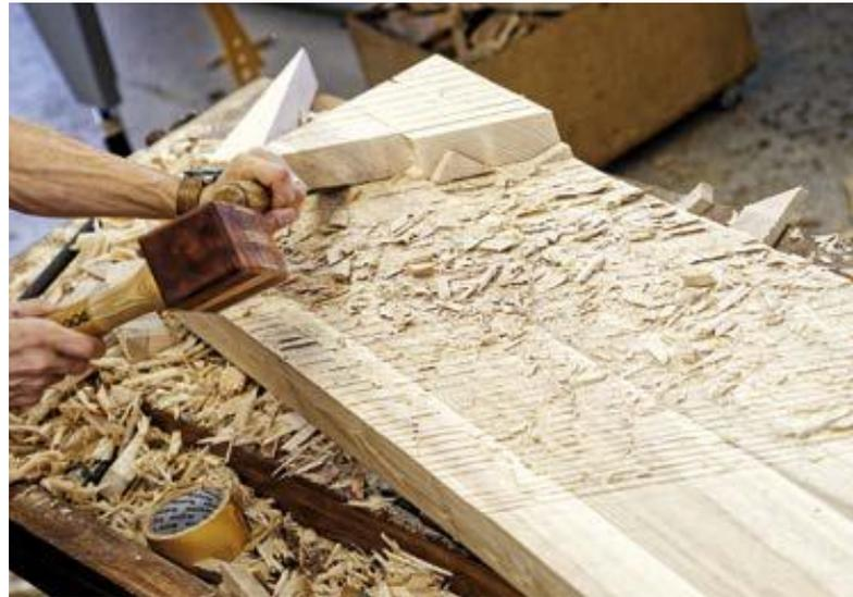
En effet, après avoir dégrossi au ciseau et au maillet, nous pouvons utiliser des rabots standards à semelle plate, dont le rendement est bien supérieur. Ils sont poussés en travers-fil, parallèlement aux génératrices. Dans mon cas, je commence par un rabot de type riflard afin de retirer de gros copeaux et ainsi rapidement m'approcher du tracé.
