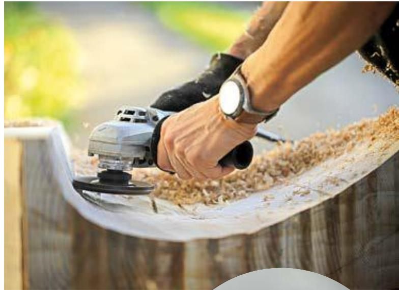
Ce disque est extrêmement pratique, mais ce n'est pas un outil de finition : à un moment ou un autre, il faut donc le poser et sortir les rabots. Or la première face débarrassée est la face concave, il va donc falloir utiliser un rabot à semelle convexe.
