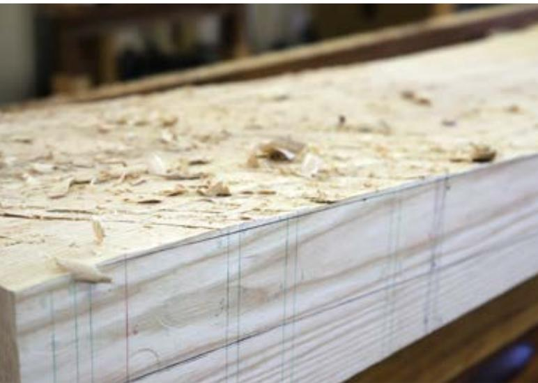
La suite des opérations pourrait se faire avec des outils à main, mais j'ai en ma possession un disque à sculpter qui se monte sur disqueuse (« Turboplane » d'Arbortech). Cela va me permettre de m'approcher à 1 ou 2 mm des lignes et de gagner un temps énorme.
