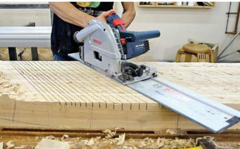
Pour le noyau, la profondeur des entailles à réaliser est tellement importante qu'il n'est pas envisageable d'utiliser la scie plongeante. J'ai donc bricolé un dispositif permettant de limiter la profondeur des passes sur la tronçonneuse. Bien sûr, ce dispositif est moins précis qu'une scie plongeante. Lors de son utilisation, je prends garde de ne pas trop m'approcher des lignes.
