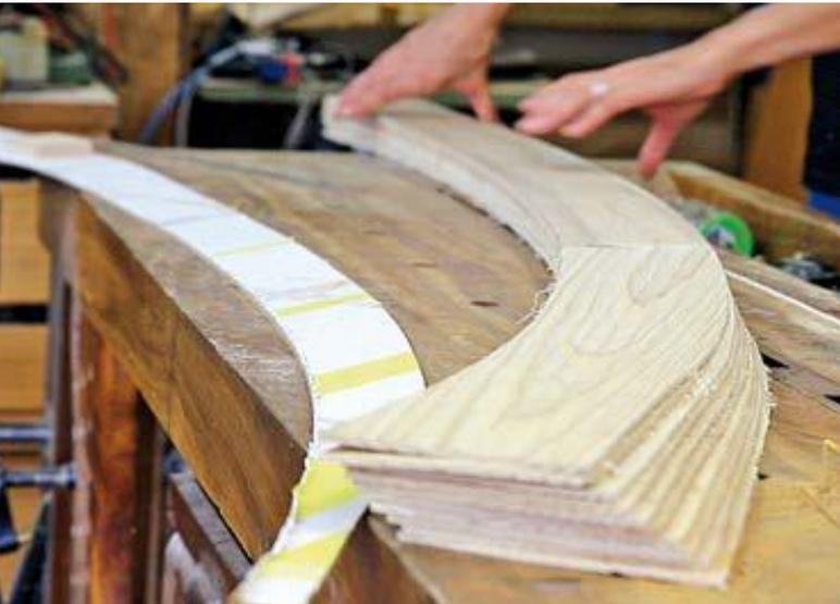
Pour le collage, et la mise en forme des feuilletés, je vais réutiliser le moule qui m'a permis d'assembler les différentes portions de limon. Le serrage va se faire au moyen d'une trentaine de presses « faites maison » : elles sont constituées de deux tasseaux traversés par de la tige filetée. De cette manière, je pourrai utiliser la visseuse à choc pour mettre en pression.
