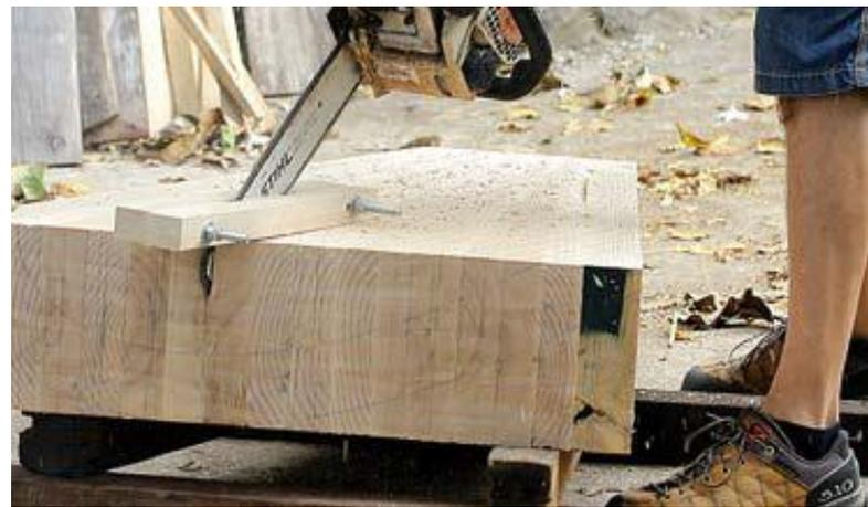
Ce travail préparatoire à la tronçonneuse étant effectué, il faut dégrossir la forme en faisant disparaître les « lamelles » de bois (on dégage le « bois de chute »). Un gros ciseau de charpente et un marteau font très bien l'affaire.
