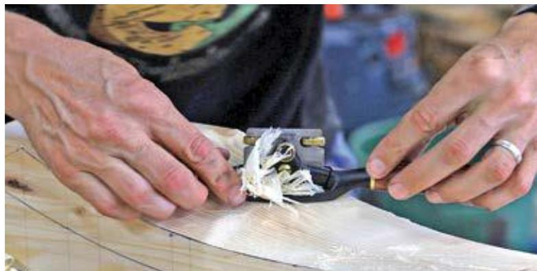
Pour la face convexe, les opérations vont être relativement similaires. Des traits de scie parallèle permettent de dégrossir la forme. Par contre pour la finition, c'est beaucoup plus simple, car il est tout à fait envisageable ici d'utiliser un rabot à semelle plane.
