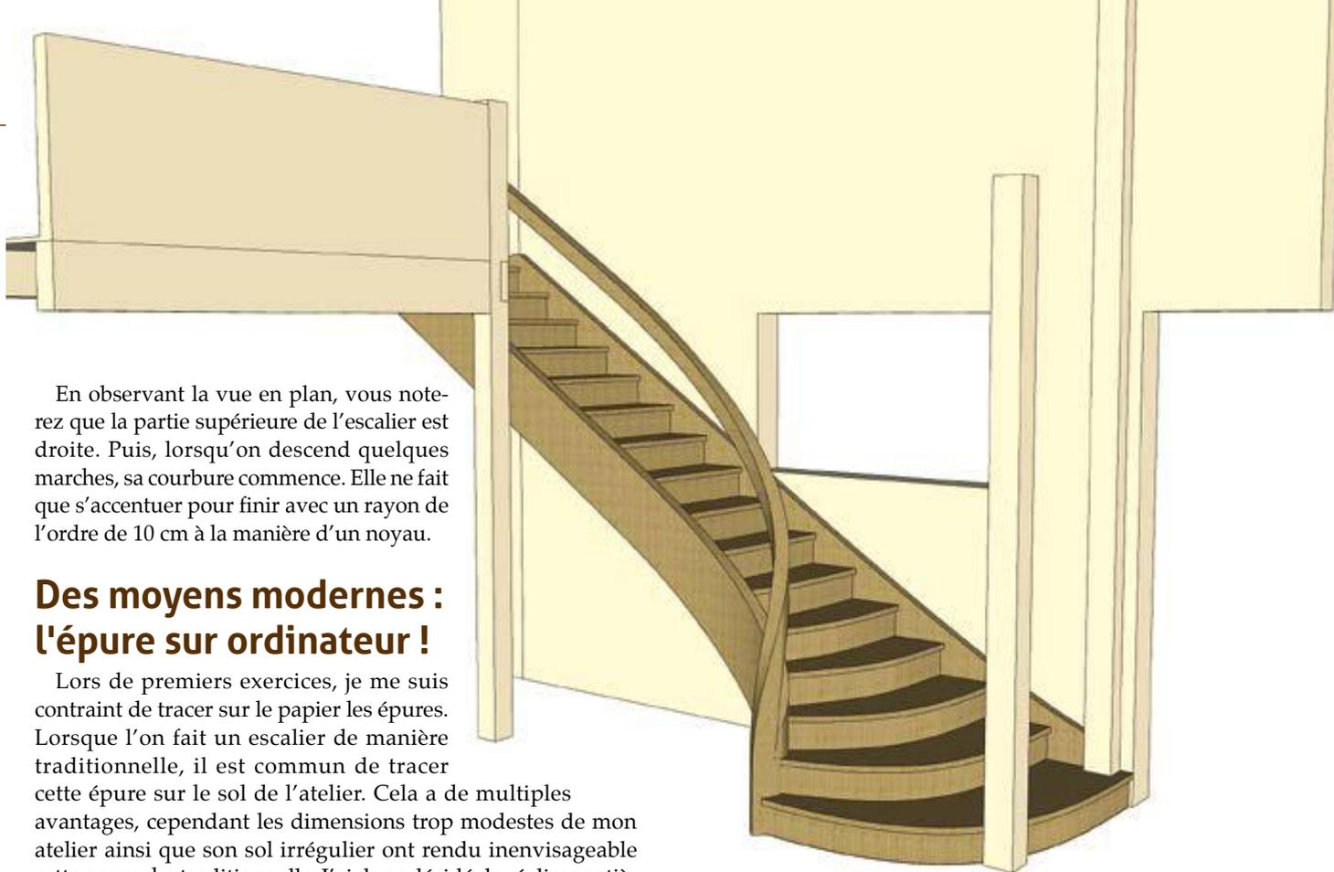
En observant la vue en plan, vous noterez que la partie supérieure de l'escalier est droite. Puis, lorsqu'on descend quelques marches, sa courbure commence. Elle ne fait que s'accroître pour finir avec un rayon de l'ordre de 10 cm à la manière d'un noyau.
