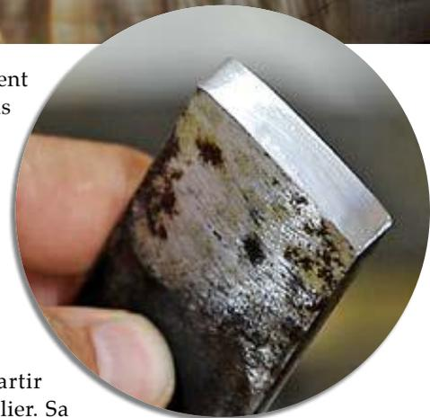
Le mien est réalisé à partir d'un vieux rabot de tonnelier. Sa semelle bombée a simplement été arrondie dans une seconde direction. Notez que la convexité de la semelle de ce rabot est amenée à évoluer au cours du projet afin de s'adapter à la zone travaillée. J'ai donc commencé par m'en servir dans la partie la plus droite du limon courbe et j'ai accentué la convexité de sa semelle au fur et à mesure que je me rapprochais des faibles rayons de courbure du noyau.
